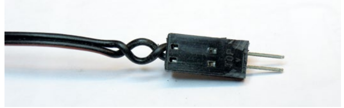
... oder bei einem passenden Stecker die Kontakte entsprechend freilegen
