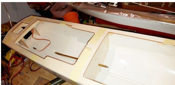
Da die Dampfmaschine nur mit rund 1.200 U/min arbeitet, ist keine aufwändige, kugelgelagerte Welle nötig
