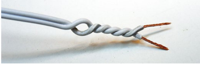
Den Fühler zur Erkennung von eintretendem Wasser kann man aus einem zweiadrigen Kabel selbst bauen ...
