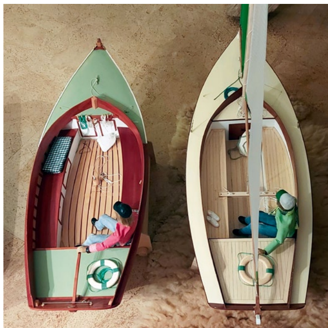
Dieser Vergleich zeigt, warum die Herreshoff 12.5 bei Krängung stärker gefährdet ist als die BULLSEYE – Wasser kann unmittelbarer ins Cockpit gelangen
