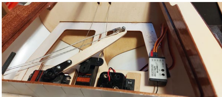
Die Anordnung der RC-Komponenten auf engem Raum ist gut durchdacht. Ruder- und Segelverstellung erfolgen über je ein 20-kg-Servo
