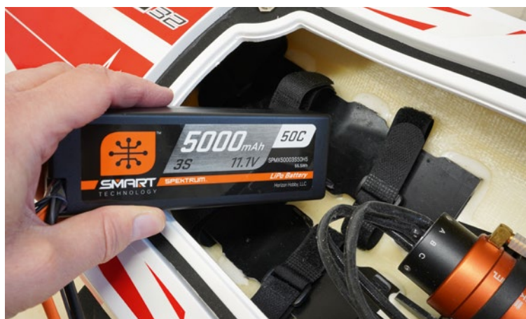
Zwei 3s-LiPos mit hoher C-Rate sorgen für Topspeed. Sicher befestigt werden die Akkus über Klettschlaufen
