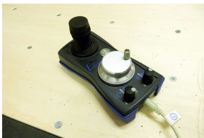
Sehr hilfreich ist das Handrad, das alle drei Achsen auf einmal in unterschiedlichen Geschwindigkeiten ansteuern kann
