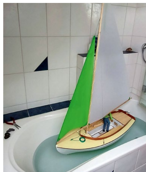
Klassisches Austrimmen mit Bleigewichten in der Badewanne. Da das Gewicht teils entnehmbar sein sollte, sind größere Öffnungen im Rumpf gelassen
