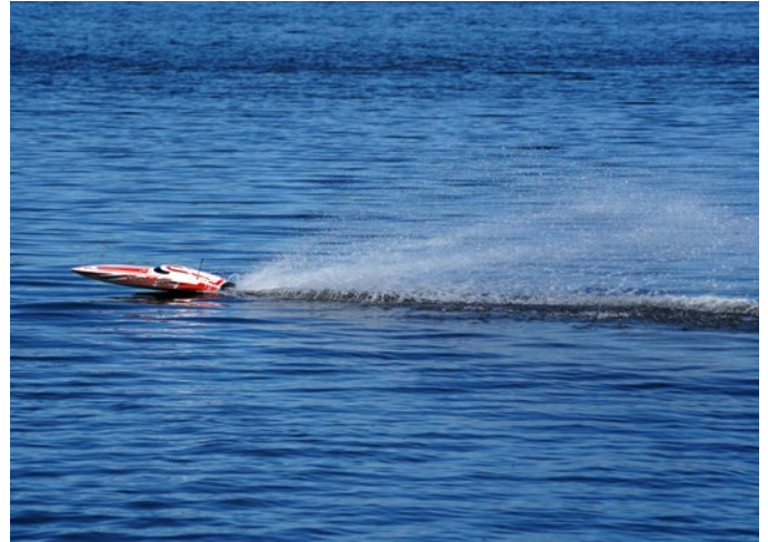
Bei glattem Wasser ist mit mittlerer Akkuposition und auf Tiefe gesetzten Trimmklappen eine hohe Topspeed sicher fahrbar
