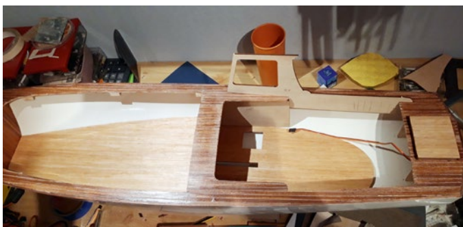
Insgesamt wurden rund 150 m Holzleisten bei der LUISA verbaut
