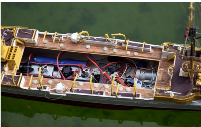
Für jeden Schornstein einen Dampfzeuger, die aus den vier LiFePo-Akkus gespeist werden
