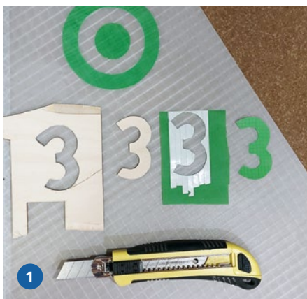
1) Feine Konturen in Spinnaker-Tuch zu schneiden, ist eine Herausforderung, darum wurde mit selbst erstellten Schablonen gearbeitet. 2) Für alle Komponenten, also Servos, Akku und Empfänger, hat aero-naut einen festen Platz im Rumpfskelett vorgesehen
