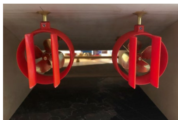
Zwei Propeller mit Kortdüsen sorgen für gute Manövrierbarkeit des über 1,6 m langen Gespanns
