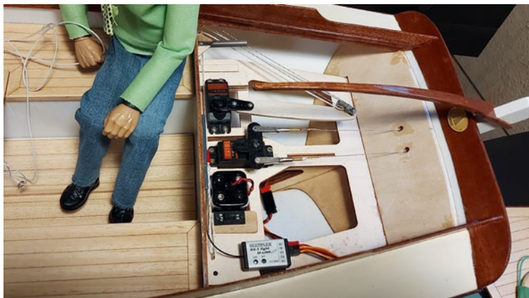
Hier die Ruderanlenkung mit der etwas angepassten Nachstellmöglichkeit
