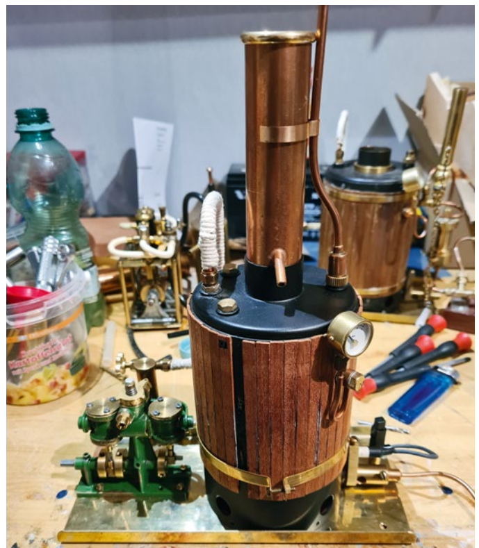
Auch der Dampfkessel wurde renoviert. Die Beplankung war vom Erstbesitzer nur mit Teppichklebeband befestigt worden
