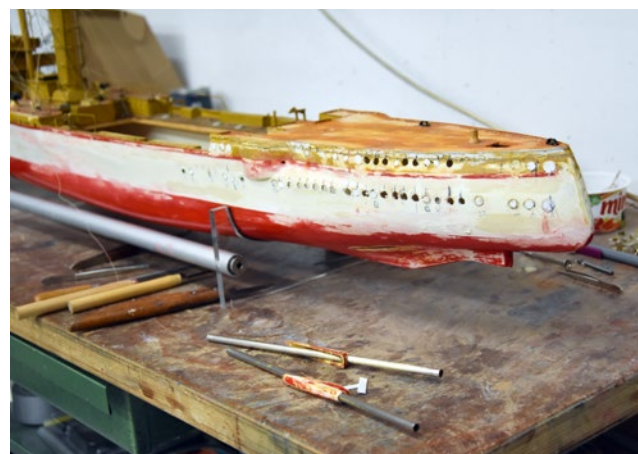
Selbst die Position der Bullaugen musste überarbeitet werden
