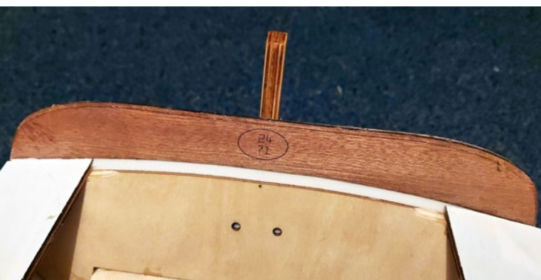
Hier passen die Teile nicht perfekt. Der Heckspiegel muss tiefer gesetzt werden
