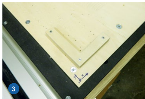
3) Ein Eckanschlag macht das wiederholte Abnullen der X- und Y-Achse unnötig. 4) Ergänzt durch einen Längsanschlag, gehört das Ausrichten des Werkstücks der Vergangenheit an
