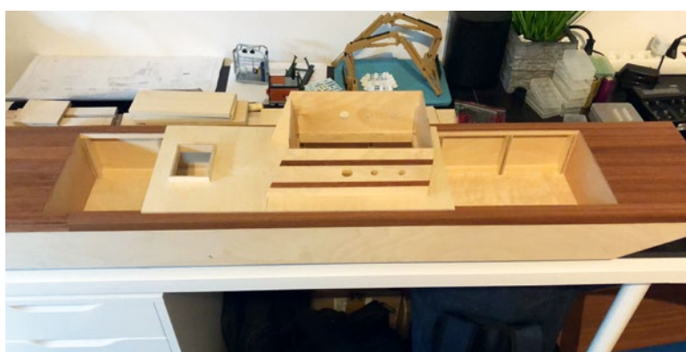
Sowohl Schubboot als auch Leichter wurden teilweise mit Mahagoni beplankt
