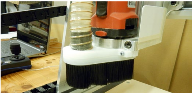
Der Absaugschuh ist unverzichtbar, wenn man an seiner Fräsmaschine lange Freude haben möchte und die Werkstatt nicht nach jeder Fräsaktion grundreinigen möchte
