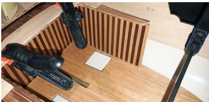
Um die schönen Holzarbeiten vor Feuchtigkeit zu schützen, kamen Schnellschleifgrundierung und Klarlack zum Einsatz
