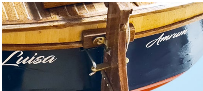
Die Ansteuerung des Ruders erfolgt unauffällig über einen Stahldraht
