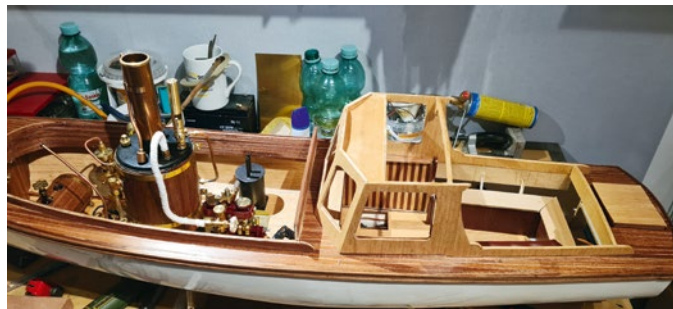
Nachdem die Maschine im Rumpf Platz genommen hatte, ging es an den Bau der Kabine
