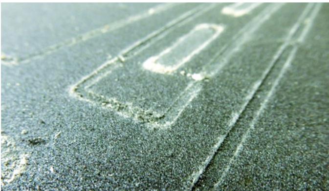
Hier sieht man die Fräsbahnen im Opfermaterial. Ich lasse den Fräser für ein sauberes Fräsergebnis 0,3 mm unterhalb des Werkstückes hervorstehen
