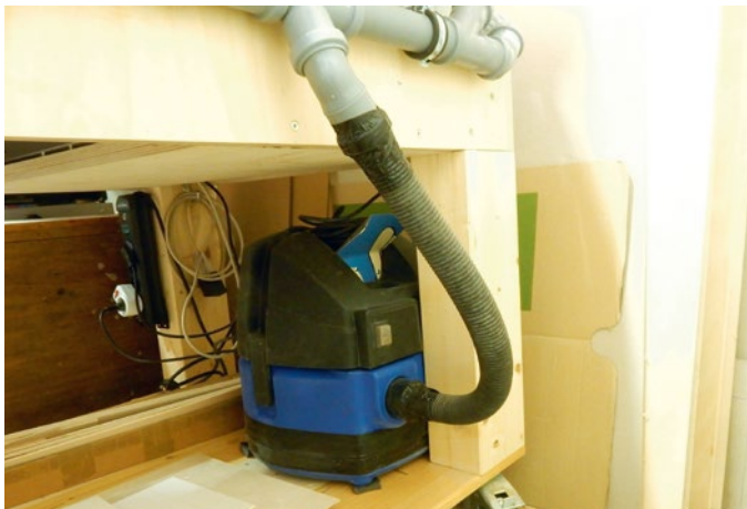
Ein umfunktionierter Staubsauger unter dem Tisch sorgt für den Vakuum-Saugeffekt
