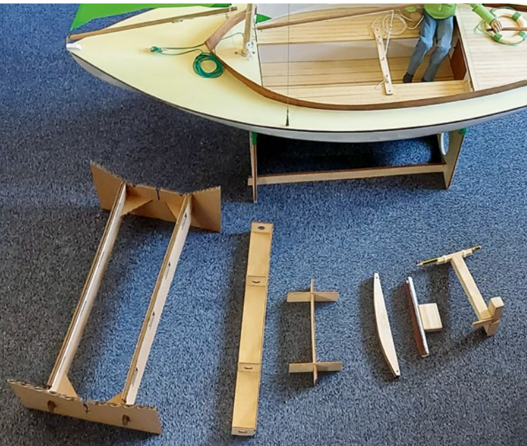
Beim Bau des Modells kommen Hilfsvorrichtungen zum Einsatz (von links nach rechts): Helling, Klebevorrichtung Mast, Ständerunterlage, Formgebung Pinne, Schleifhilfe Mast, Wasserpass-Markierer
