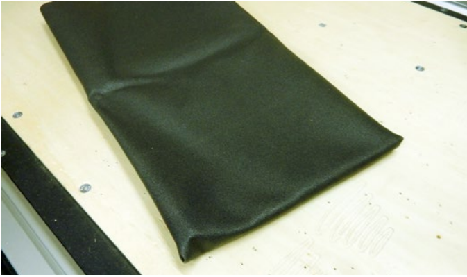
Das Vakuummvlies ist sehr rutschfest und eignet sich hervorragend als Opfermaterial für kleine Frästeile
