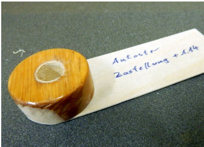
Das Abnullen der Z-Achse erfolgt mit diesem selbst gebauten Helferlein
