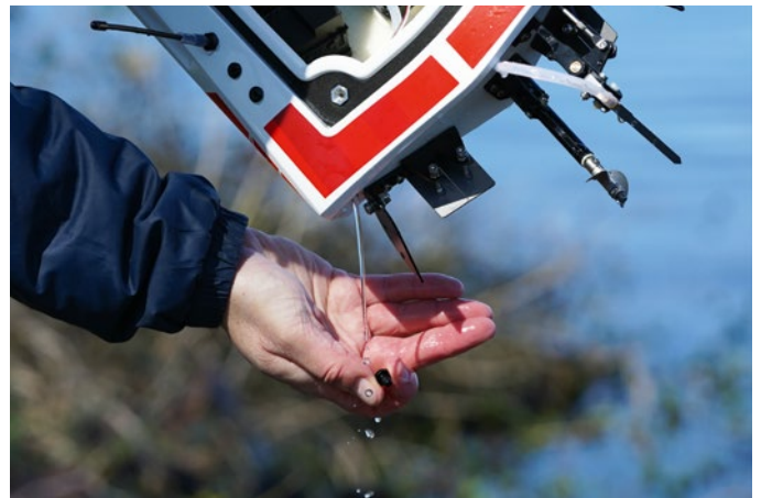
Wasser im Boot nach dem Fahren lässt sich über ein Lenzloch entfernen
