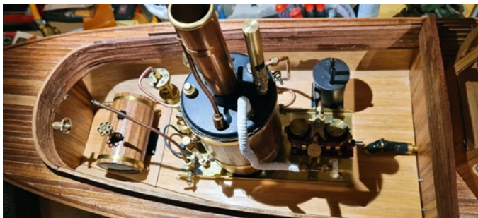
Die Zweizylinder-Dampfmaschine ist fertig in der LUISA eingebaut
