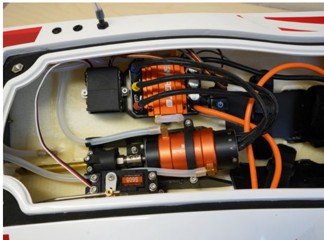
Brushless-Regler und -Motor sind wassergekühlt und werden im Betrieb nicht übermäßig heiß
