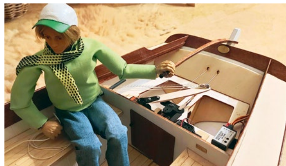
Mit nachgearbeiteten Löchern werden Beschädigungen an den Seilführungen vermieden
