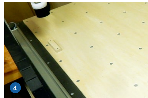
3) Ein Eckanschlag macht das wiederholte Abnullen der X- und Y-Achse unnötig. 4) Ergänzt durch einen Längsanschlag, gehört das Ausrichten des Werkstücks der Vergangenheit an
