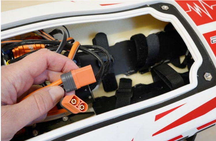
Ab Werk sind hochstromfähige IC5-Stecker mit drittem Kabel zur Telemetrie-Datenerfassung geeigneter Akkus konfektioniert
