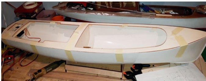
Im ersten Schritt wurden Deck und Spanten mit dem ABS-Rumpf verklebt
