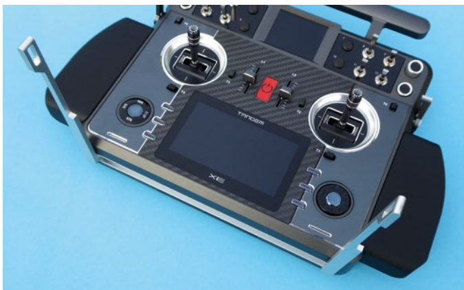
Die Bügel arretieren im ausgeklappten Zustand nicht und sitzen insgesamt etwas zu locker
