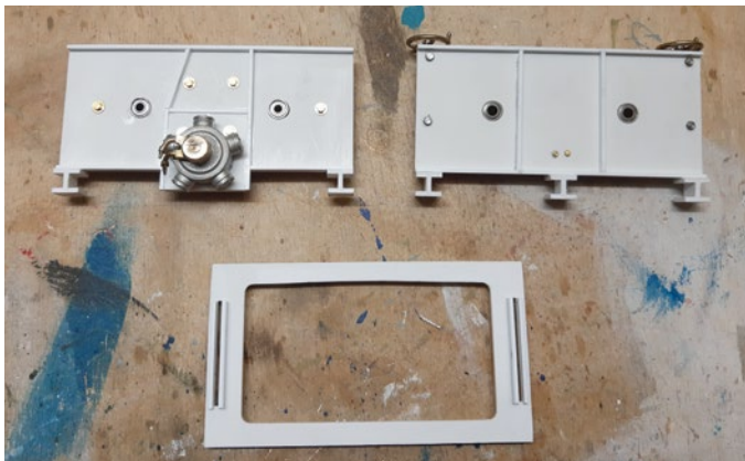
Die Neubauteile aus Polystyrol mit einigen Metallteilen
