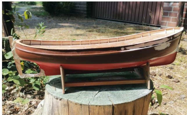
Als Erstes wurde dem Krabbenkutter ein Holzsteven verpasst
