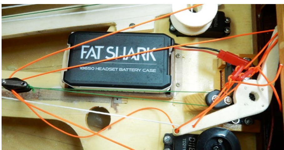
Wird das Servo nach rechts betätigt, zieht es die Backbord-Schot dicht
