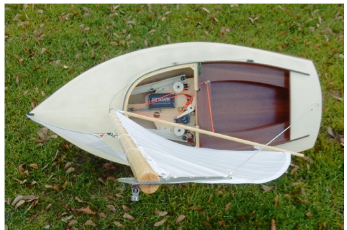
Nimmt man den Traveller nach Lee, reduziert sich der Twist und das Großsegel hat über die ganze Höhe den gleichen Anstellwinkel zum Wind
