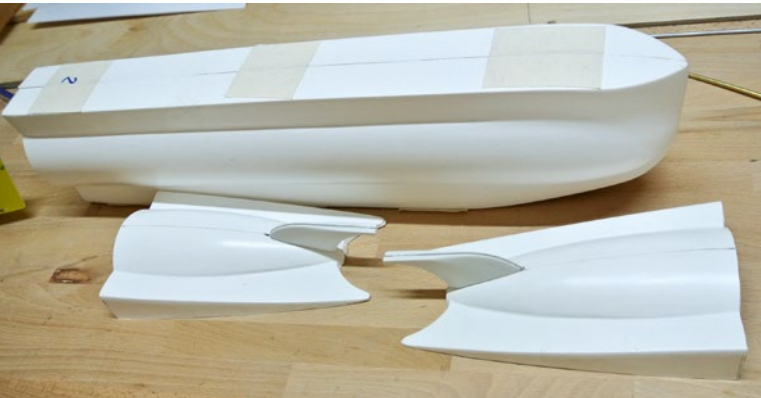
Mit einem beherzten Schnitt wird der GFK-Rumpf in Bug- und Hecksektion geteilt
