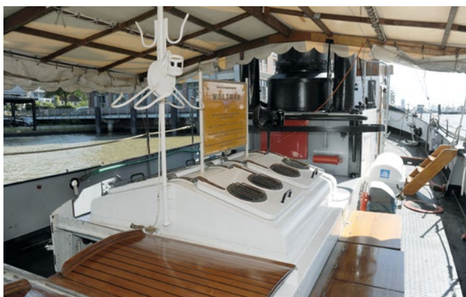
Frischluf für den Maschinenraum: Oberlichter und Abgang nach unten
