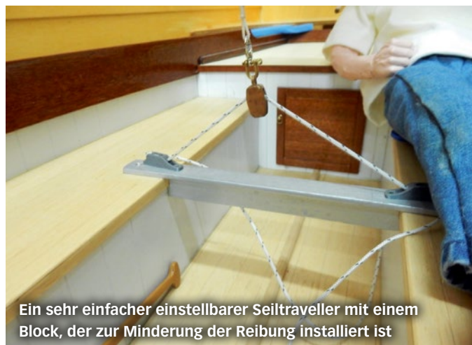
Eine einfache Travellerschiene, auf der die Schot selbstständig nach Luv und Lee rutschen kann
