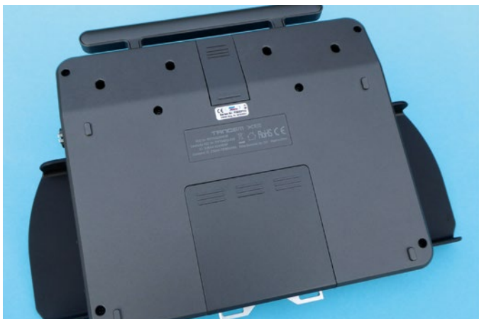
Rückseitig sind das Akkufach und ein Schacht für ein externes HF-Modul untergebracht
