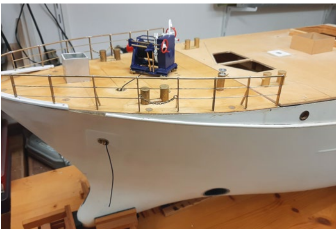
Die Poller sind bereits festgeklebt. Reling und Ankerwinde kommen später
