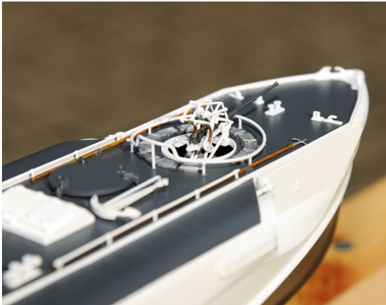
Die vordere Maschinenkanone sitzt am Bug eingegraben, um die Sicht von der Brücke nicht zu verdecken
