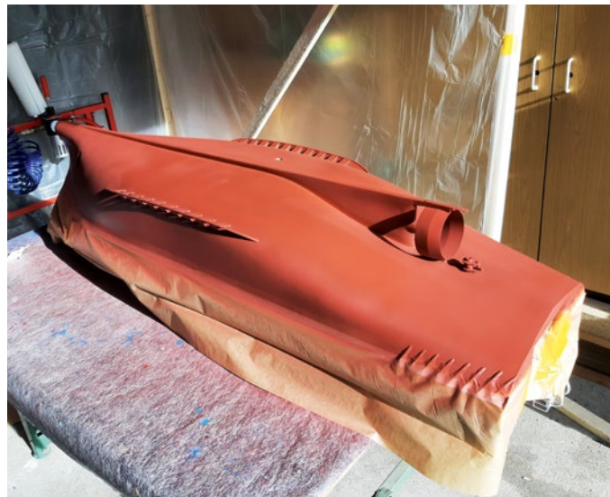
Im Gegensatz dazu kommt beim Unterwasserschiff die Spritzpistole zum Einsatz
