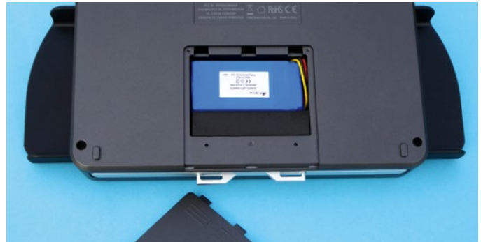
Die Stromversorgung wird durch einen 2S-LiPo mit 4.000 mAh sichergestellt, für den Einsatz größerer Akkus ist genügend Platz vorhanden
