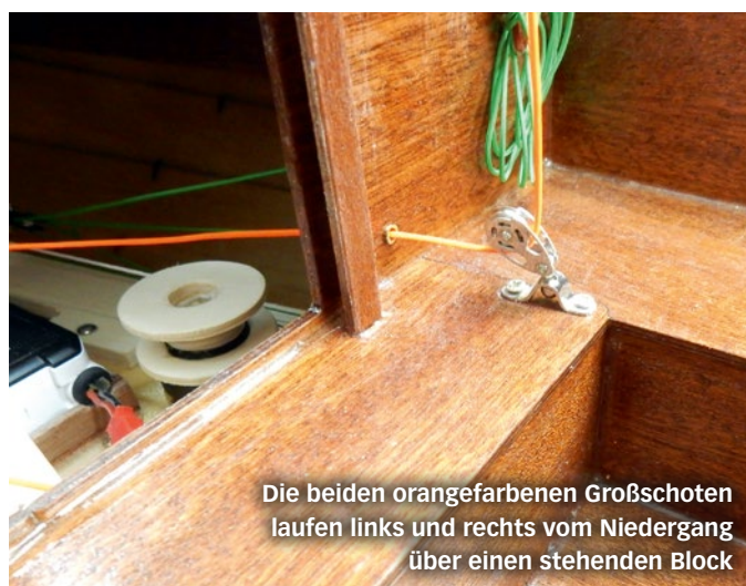
Ein sehr einfacher einstellbarer Seiltraveller mit einem Block, der zur Minderung der Reibung installiert ist
