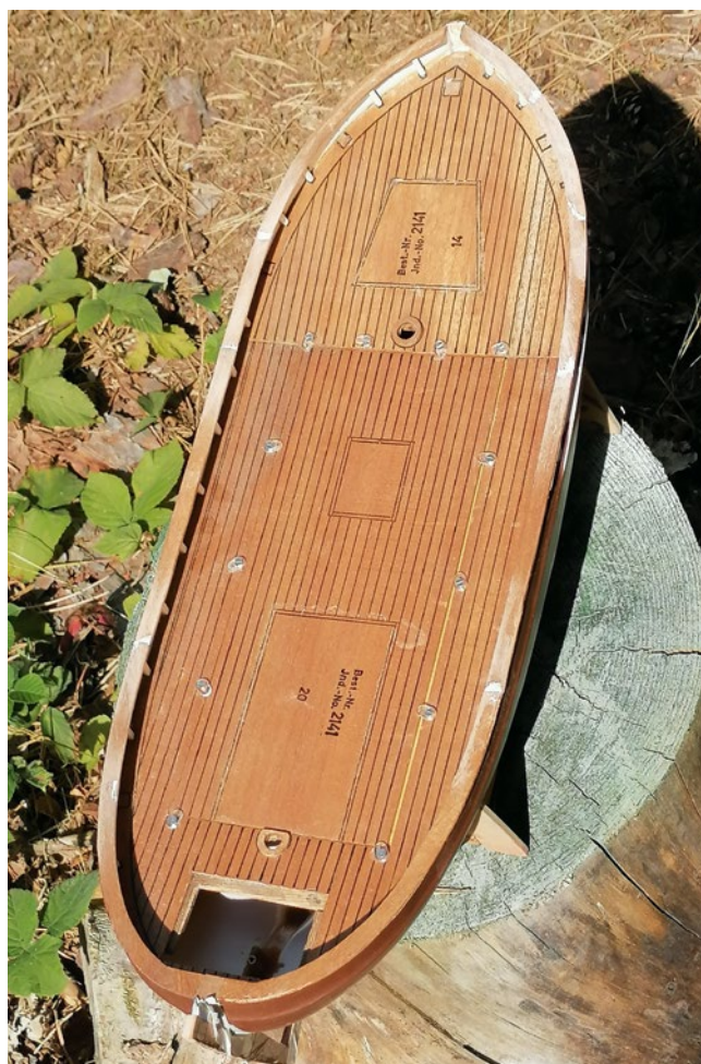
Der Original-Kutter hat ein Deck, dessen Öffnung zum Rumpf zu groß ist
