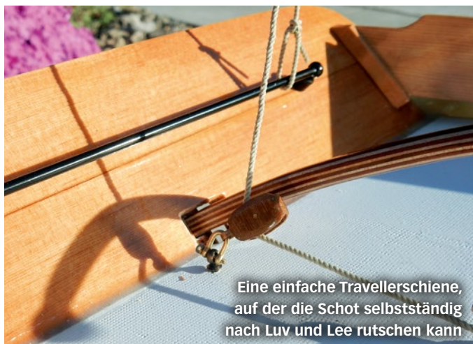
Ein sehr einfacher einstellbarer Seiltraveller mit einem Block, der zur Minderung der Reibung installiert ist
