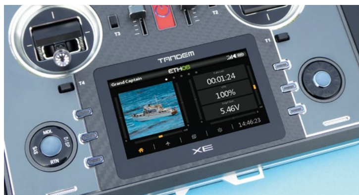
Die Kommunikation mit dem Sender ist sowohl über den Touchscreen als auch über die Bedientasten möglich
