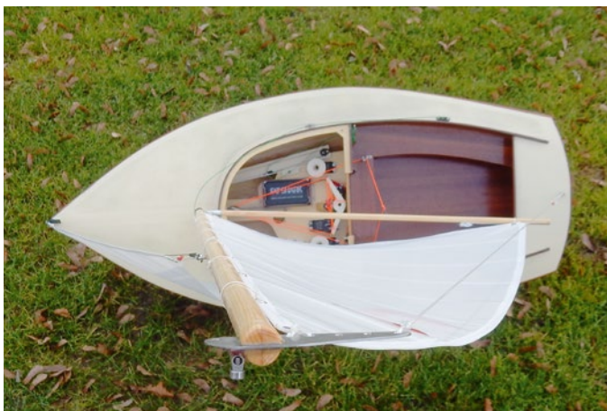
Steht der Traveller in der Mitte, hat das Großsegel einen großen Twist und weht oben aus
