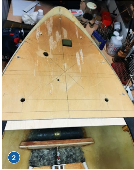
1) Die Abdeckung über der Ruderanlage wird neu gebaut. 2) Zum Schutz des Ankers wird das vordere Drittel des Hauptdecks fest eingeklebt. 3) Die beiden Netzwinden entstehen. Gut zu erkennen ist ein Teil des Schneckengetriebes
