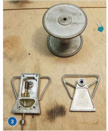
1) Die Abdeckung über der Ruderanlage wird neu gebaut. 2) Zum Schutz des Ankers wird das vordere Drittel des Hauptdecks fest eingeklebt. 3) Die beiden Netzwinden entstehen. Gut zu erkennen ist ein Teil des Schneckengetriebes
