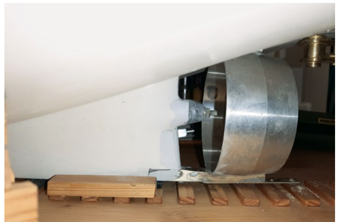
Als Wiederbeginn bekommt der Wellenstummel eine gedruckte Wellenhose
