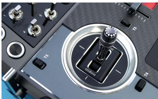
Die kugelgelagerten präzisen Steuerknüppel sind mit Hallsensoren ausgestattet
