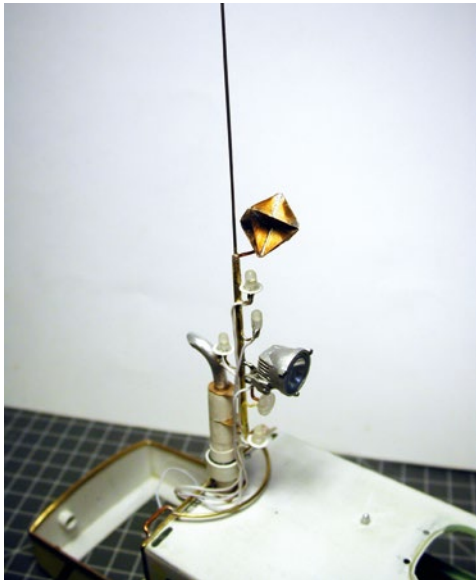
Der komplette Mast mit Suchscheinwerfer, Radarreflektor und offener Verkabelung
