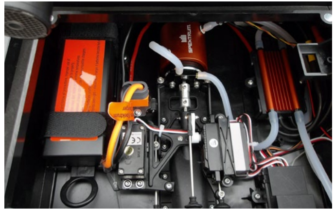
Das Kabel des Akkus ist sehr kurz, es wird in eine fest installierte Buchse eingesteckt
