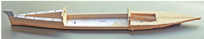
Der Rumpf im Rohbau vor der Seitenbeplankung. Zu erkennen sind auch der Alu-Vorsteven und die Dreiteilung des Innenraums
