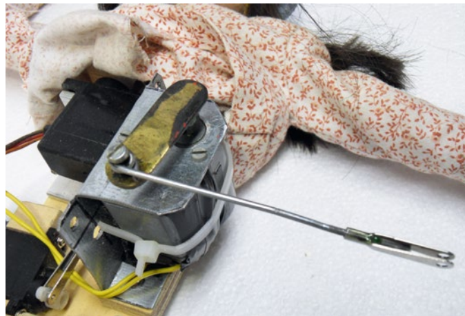
Ein langsam laufender Getriebemotor treibt das Akkordeon an
