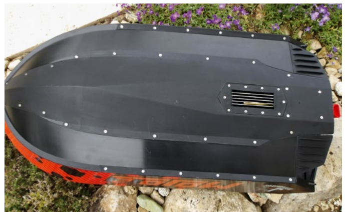
Was durch das enge Einlaufgitter des Jets durchfindet, wird einfach geschreddert
