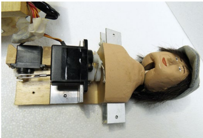
Zwei Servos sind für das Drehen und Nicken der Puppen verantwortlich
