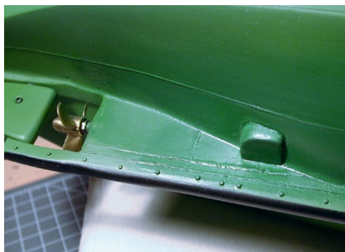
Das Echolot wurde als letztes Beschlagteil angebracht
