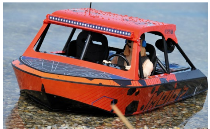
Durch den Jetantrieb kann die MOJO 2 auch in sehr flachem Wasser operieren
