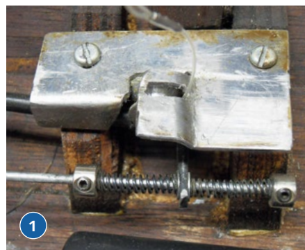
1) Die eingebaute Hebeseilführung und die Antriebsachse mit Schubstange. 2) Die Ruderrollen und die Seilaufnahmen sind fertig montiert
