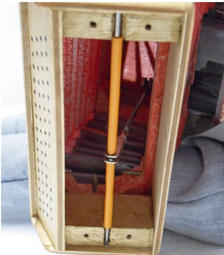
Die Kurbelstangenaufnahme wird von Bowdenzugrohren in der Mitte gehalten
