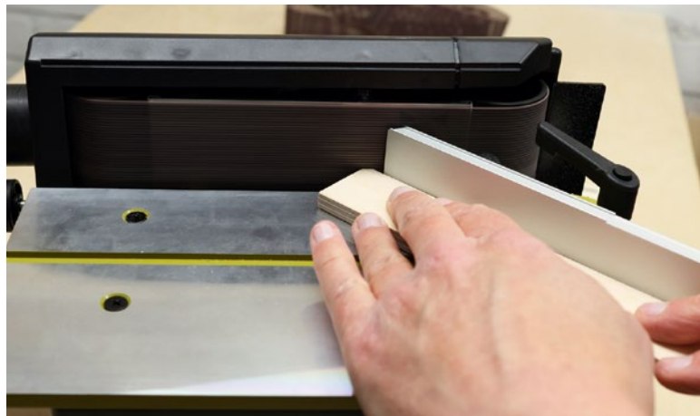
Mit dem Winkelanschlag lassen sich Gehungen schleifen. Allerdings sollte man den eingestellten Wert ergänzend kontrollieren
