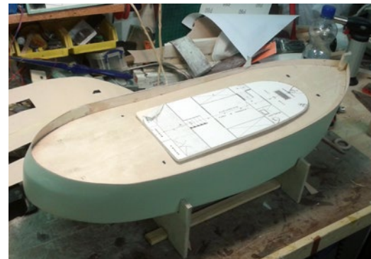
Nachdem der Rumpf mit Glasfaserplatte überzogen ist, geht es an Deck weiter
