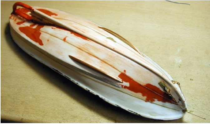
Am Rumpf wurden Schlingerkeile und Schweißnahtimitate angebracht
