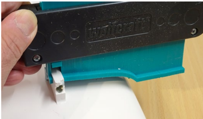
Mit Hilfe einer Konturenlehre lassen sich auch gerundete Rumpfformen abnehmen
