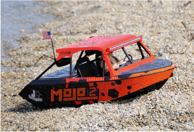
Durch die Armierung am Rumpfboden kann man auch auf den Strand fahren
