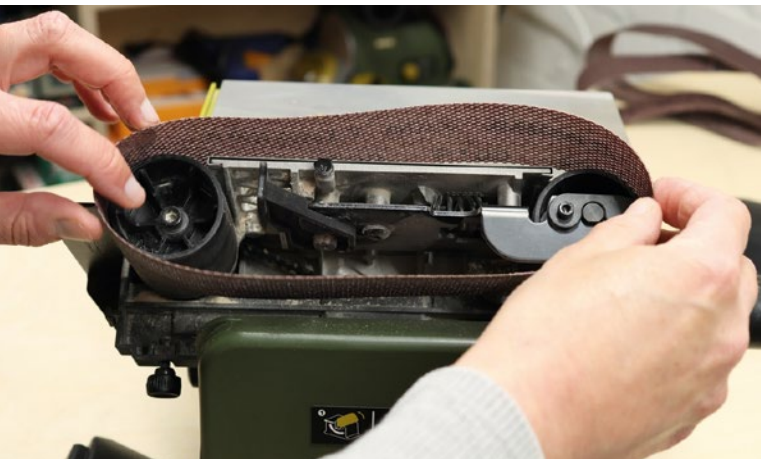
Zum einfachen Schleifbandwechsel sind zwei Kunststoffelemente zu demontieren und ein Spannhebel zu lösen. In welche Richtung man das Band einspannt, spielt keine Rolle
