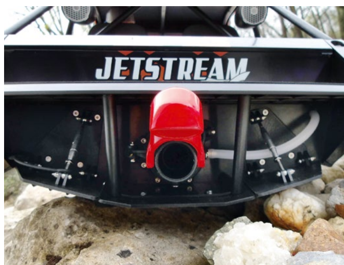
Der Elefantenrüssel ist die Umsteueranlage, hier hochgeklappt für Vorwärtsfahrt
