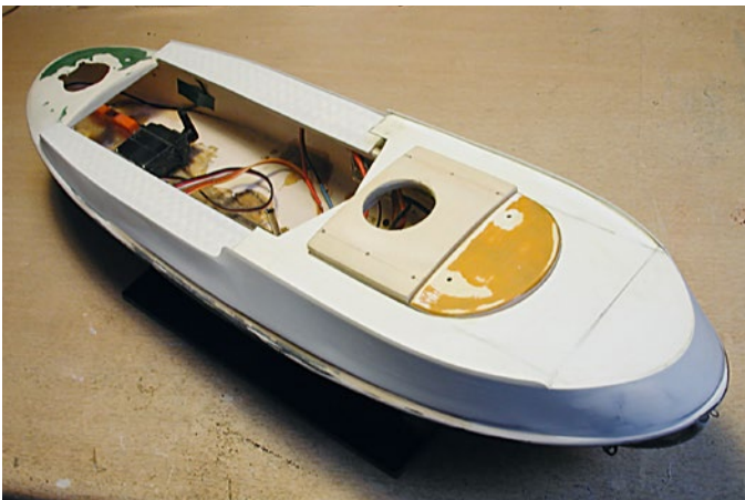
Das neue Vorschiff wurde aus Polystyrol-Formteilen erstellt
