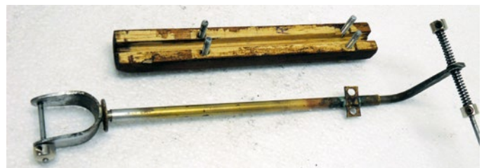
Ruderrolle mit verlöteter Antriebsachse, Abdeckung und Schubstange
