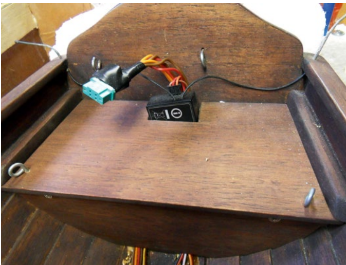
Unter der Hecksitzbank steckt der MPX-Anschluss für den Ruderer
