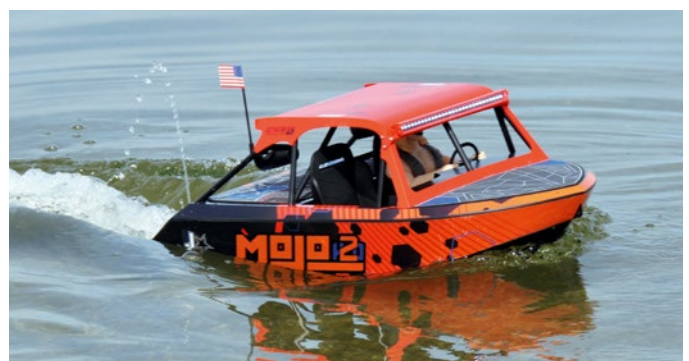
Die kleine Fontaine rechts hinten zeigt an, dass die Wasserkühlung funktioniert
