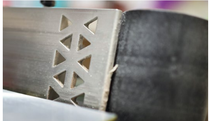
Um Schleifstaub durch das Netzschleifband zu saugen, sind im massiven Rollentisch Löcher eingelassen
