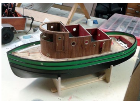
Das Sperrholzgerüst des Deckshauses wurde mit Kaffee-Rührstäbchen beklebt und lasiert
