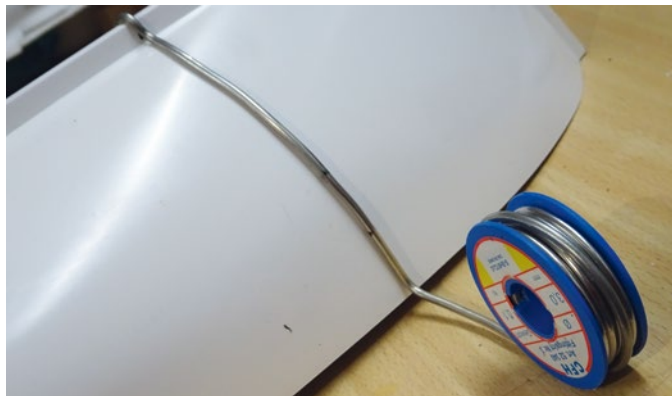
Auch mit etwas dickerem Lötzinn lassen sich runde Konturen erfassen
