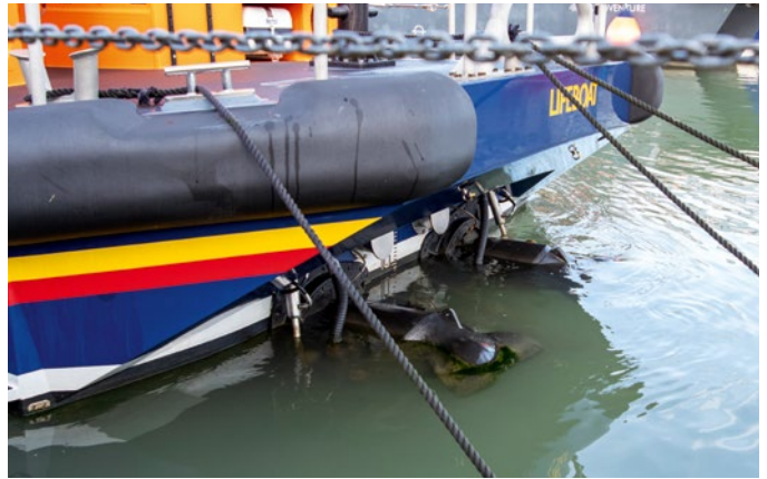
Am Heck sind die beiden Hamilton-Jets montiert
