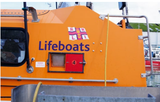
Mit den roten Klappen können die Lüftungsöffnungen manuell geschlossen werden
