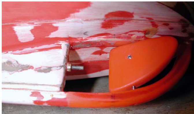
Der Ruderkocker ist 10 mm nach achtern versetzt, um erreichbar zu bleiben
