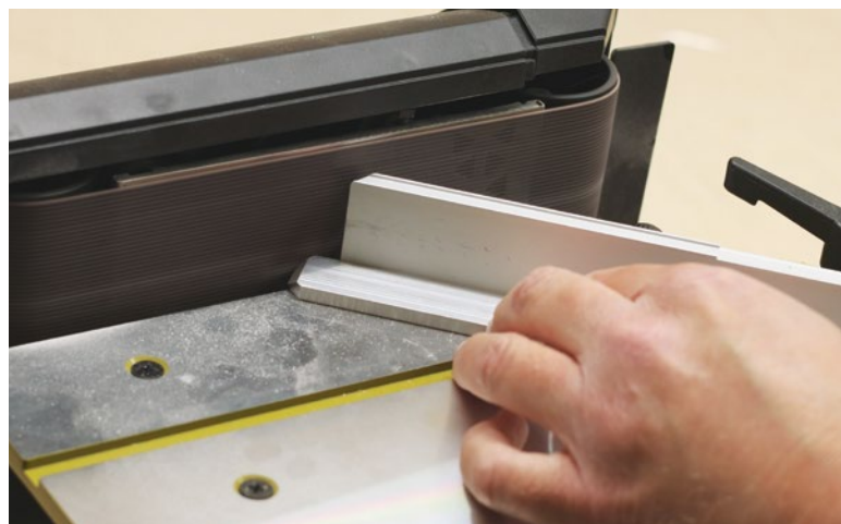
Alu lässt sich genauso gut und mit feinem Schliffbild bearbeiten wie andere Materialien
