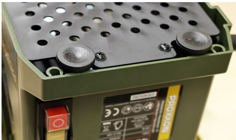
Nicht erfasster Staub kann unten durch die Gehäuseplatte fallen. An vier Punkten lässt sich das sicher stehende Gehäuse zudem mit Schrauben fixieren
