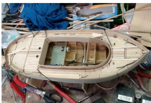
Das Deck wird mit Funierleisten beplankt und mit Tonpapier kalfatert
