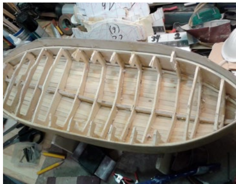
Teilweise werden die Spanten aus dem fertigen Rumpf rausgebrochen
