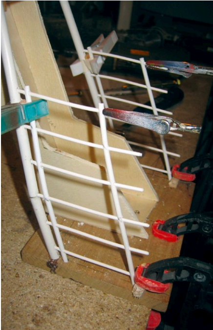
Ähnlich wie bei der Relling entstand auch der Mast im Wesentlichen aus Polystyrolrohren, die von wenigen Messingteilen gestützt werden. Übergänge sind später zu verspachteln
