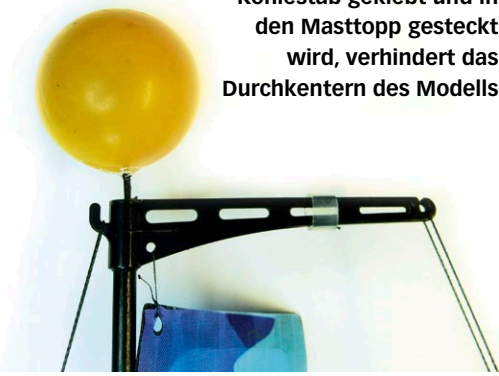
Das Vorliek des Fathead-Großsegels wird am Topp gespannt
