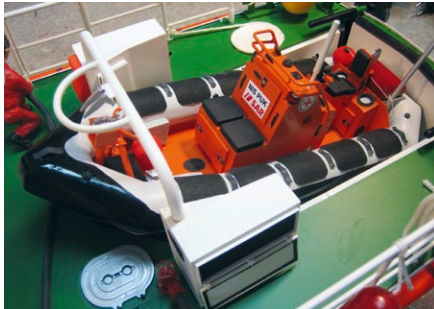
Statt eines klassischen Tochterboots kommen in der 20-Meter-Klasse RIBs, hier die NIS PUK, zur Verwendung
