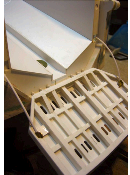
Die detailliert konstruierte Heckklappe lässt sich über zwei Bowdenzüge öffnen und schließen. Im Schlitz in der Heckwanne ist noch die Öffnung für die Rudergarnitur zu sehen
