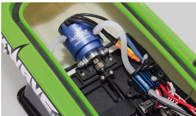
Ab Werk betriebsbereit eingebaut sind ein 2.000-kv-Außenläufer und die Flexwellenanlage
