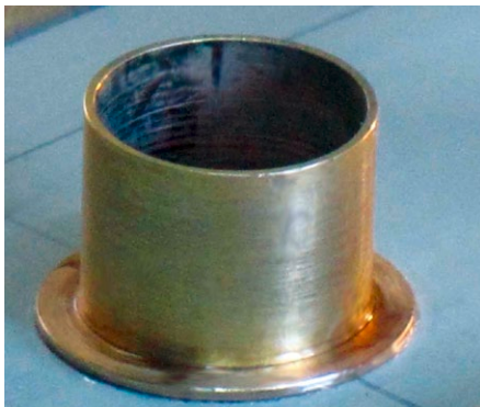
Abbildung 08: Die Buchse steht nur dann in der richtigen Schräglage, wenn der Mast beim Einkleben eingesteckt war
