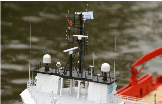
Schornsteine, Masttraverse und Masten mit sämtlichen Details wie Radome, Radar, Strahlern und mehr
