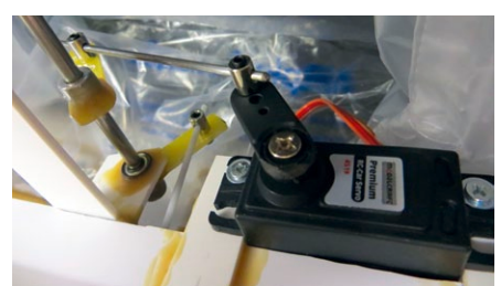
Servomotor für die beiden Klappen auf dem Vordeck neben dem Pool
