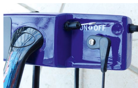
Am Heck des Steuerbordrumpfs befindet sich das Gestänge für den Schalter
