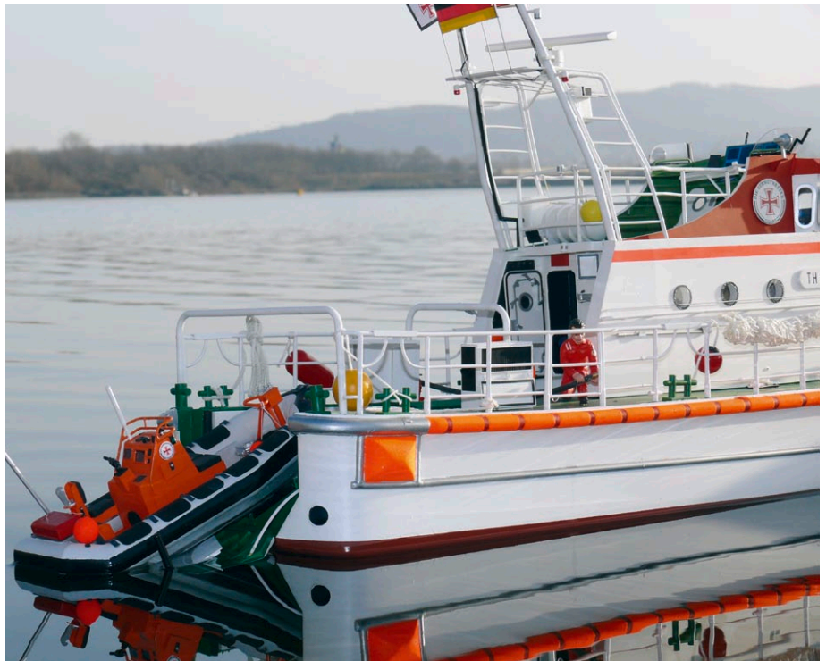
Der Zugangsbereich zur Ruderanlage ist vom Heckwannenschlitten verdeckt. Über ein dünnes Seil lässt sich das daran festgebundene RIB aussetzen und mit einer maximalen Entfernung von 1,5 Meter hinter der THEODOR STORM her ziehen
