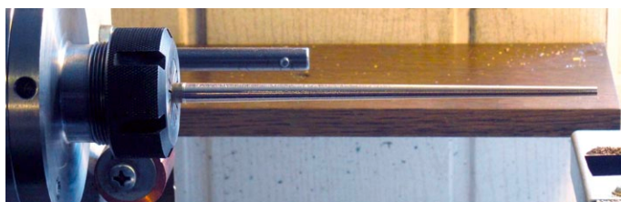
Abbildung 05: Bei den ER-Druck-Spannzangen muss der Spannzapfen – hier das Restmaterialstück in der Zange – für einen exakten Rundlauf immer so lang wie die gesamte Zange sein
