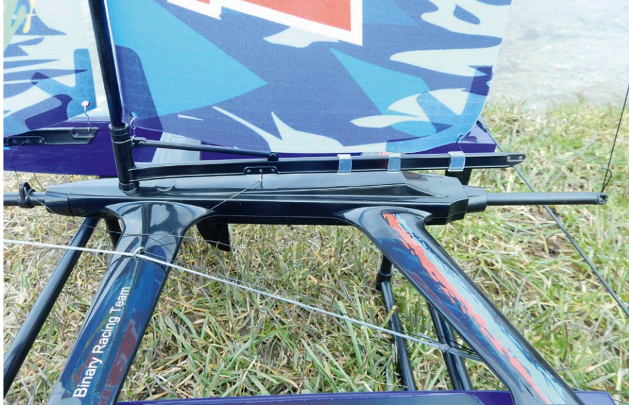
Das Großsegel verfügt über einen trimmbaren Unterliekstrecker. Die Schoten werden an der Zentralschot eingehängt, die über den diagonal geführten Gummi gespannt wird
