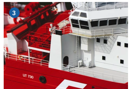
2) Zahlreiche Bauteile wurden erst zum Ende der Bauphase lackiert, andere wiederum zwischendurch. 3) Um beim Lackieren wenig abkleben zu müssen, ist das Modell in Segmenten und Einzelteilen gebaut, die erst später fest miteinander verbunden wurden.
