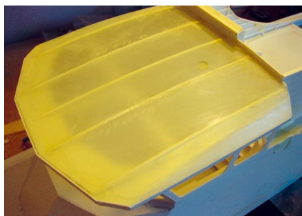
Aus dünnem GFK ist das Kabinendach den vorgegebenen Abwicklungen anzupassen und einzukleben
