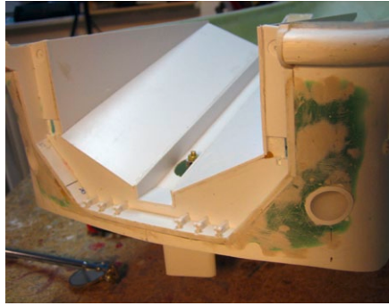
Viel Anpassungs- und Spachtelarbeit erforderte der Einbau von Heckwanne und -klappe
