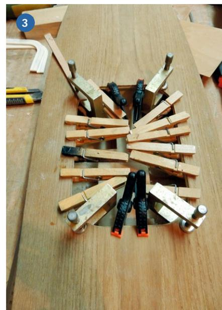
1) Zum Aussägen des Deckschnitts wird selbiger mit transparentem Klebeband versehen, damit das Furnier beim Sägen mit der Stichsäge nicht ausfranst. 2+3) Der fertige Ausschnitt wird mit vielen Klammern mit einem Rand versehen, der später den Deckel aufnimmt. 4) So sieht die Dichtung dann im fertigen Zustand aus
