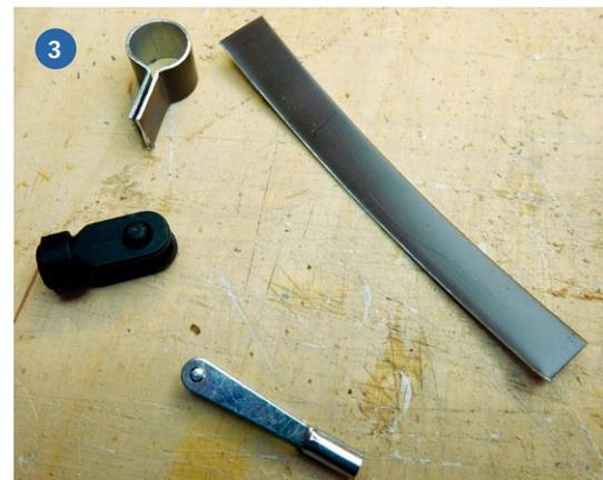
1) Die CFK-Rohre für die Spieren werden an den Enden mit einem 6-Millimeter-Buchendübel verschlossen, der mit dünnflüssigem Sekundenkleber eingeklebt wird. 2+3) Die Manschette um den Mast nimmt das Baumlager auf, das aus Dachdecker aluminium und Gabelköpfen entsteht
