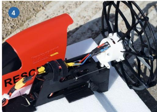
1) Die vorgefertigten Holzteile. 2) Brushless Außenläufer-Motor M Force 330 und passender Regler von Hacker. 3) Die installierte 7 x 5-Zoll-Luftschraube. 4) Fertig installierter und angeschlossener Antrieb auf dem Motorträger
