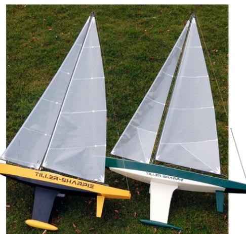
Die beiden Mustermodelle. Die Prothmann-Bombe und die abgerundeten Kanten lassen das grüne Modell etwas gefälliger erscheinen
