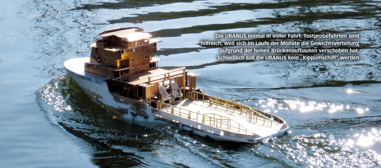
Die URANUS einmal in voller Fahrt. Testprobefahrten sind hilfreich, weil sich im Laufe der Monate die Gewichtsverteilung aufgrund der hohen Brückenaufbauten verschoben hat. Schließlich soll die URANUS kein „Kippumschiff“ werden
