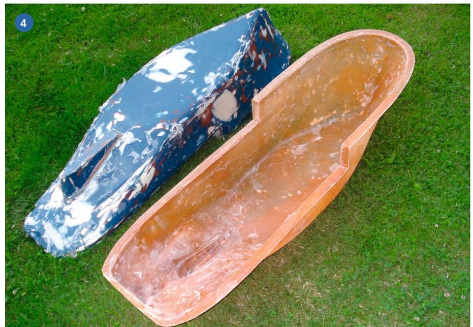
1) Die aufgestellten Spanten bevor die Zwischenräume mit Zweikomponenten-Schaum ausgefüllt wurden. 2) Durch Schleifen und Spachteln entsteht der Ur-Rumpf zum Abformen. 3) Hier ist der erste Positiv-Rumpf in der Form sichtbar. 4) Die Positivform (im Hintergrund) und Negativform sind nach etlichen Arbeitsstunden endlich fertig
