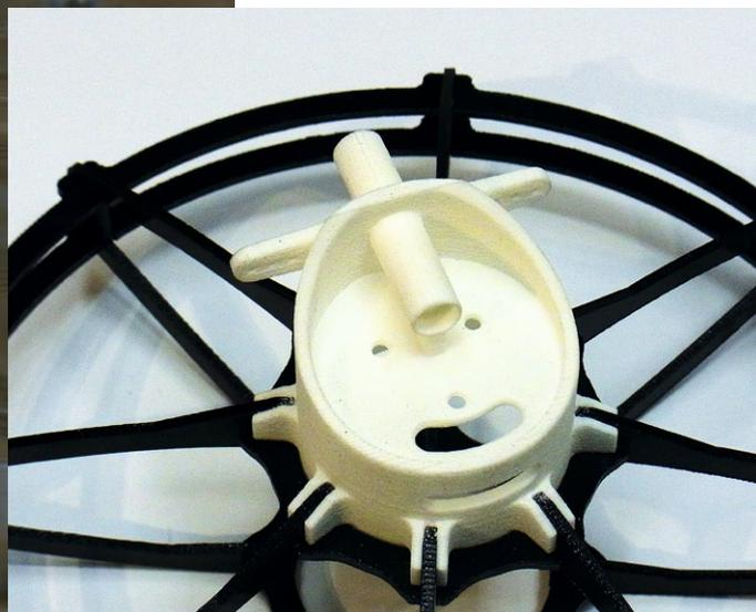
Die Motoraufnahme mit dem Schutzkäfig der Luftschraube
