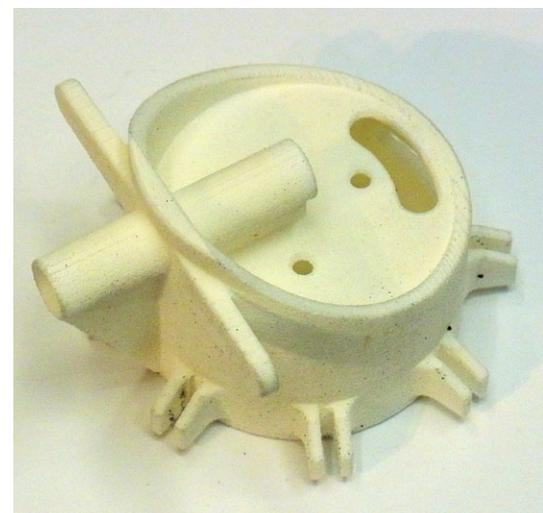
Der Motorträger samt Lenkmimik besteht aus einem 3D-Druck-Teil
