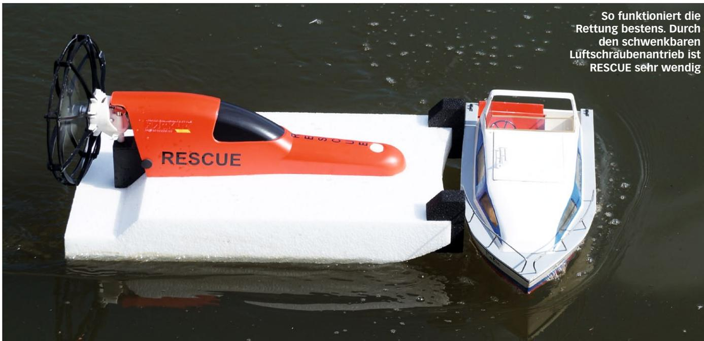
So funktioniert die Rettung bestens. Durch den schwenkbaren Luftschraubenantrieb ist RESCUE sehr wendig
