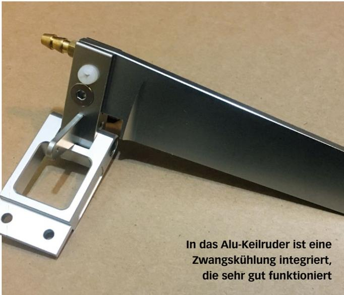
In das Alu-Keilruder ist eine Zwangskühlung integriert, die sehr gut funktioniert
