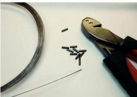
Stahldraht, Quetschhülsen und eine Kröpfzange sind die Mittel der Wahl fürs Auftakeln
