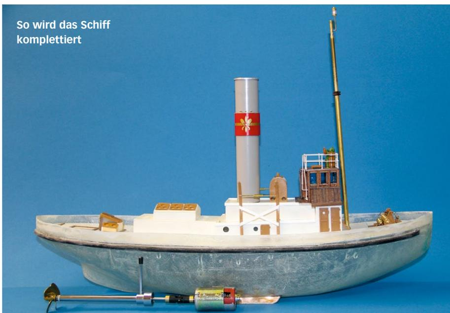
So wird das Schiff komplettiert
