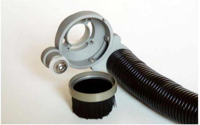
Die spezielle Absaughalterung wird unterhalb der Maschinenaufnahme mit einer Schraube fixiert. Der beiliegende Schlauch sollte über das Portal abgeführt und mit dem Staubsauger mittels Schrumpfschlauch verbunden werden, um den Austritt von Staub zu verhindern
