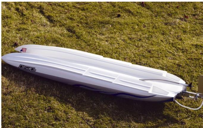
Der sauber gefertigte GFK-Rumpf ist mehrstufig ausgeführt, wie es für diese Cats so typisch ist
