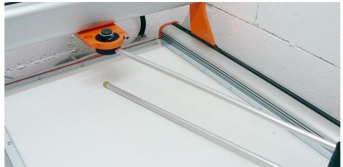
Die lange Halterung setzt zumindestens auf einer der beiden Seiten viel Platz voraus, damit auch möglichst viel der Aufspannfläche genutzt werden kann. Die Kabelführung sollte zudem über das Portal verlegt werden, um ein Herabhängen der Halterung zu verhindern – dies führt bei dickeren Schaumstoffen sonst zu schrägen Kanten
