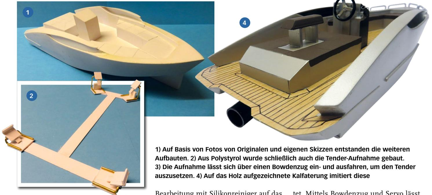
1) Auf Basis von Fotos von Originalen und eigenen Skizzen entstanden die weiteren Aufbauten. 2) Aus Polystyrol wurde schließlich auch die Tender-Aufnahme gebaut. 3) Die Aufnahme lässt sich über einen Bowdenzug ein- und ausfahren, um den Tender auszusetzen. 4) Auf das Holz aufgezeichnete Kalfaterung imitiert diese
