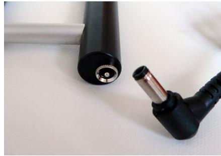
Der Stecker vom Schaltnetzteil zur Halterung des Heizdrahts dient auch als Ein-aus-Schalter. Die Verfahrswege im Schaumstoff sollten generell so kurz wie möglich gestaltet werden, erst recht, wenn man dickeren Schaumstoff schneiden möchte
