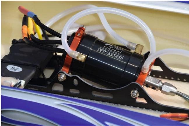
Der Brushless-Motor vom Typ SSS 3674 ist an einem wassergekühlten Motorträgersystem befestigt
