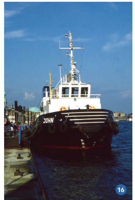
16) Beim Rumpfbau sind auch Merkmale wie Fender einzuplanen
