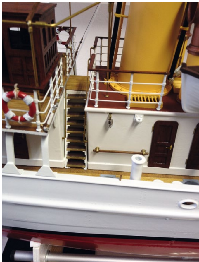
Steuerhaus-Niedergang mit Kamin-Unterbau mittschiffs
