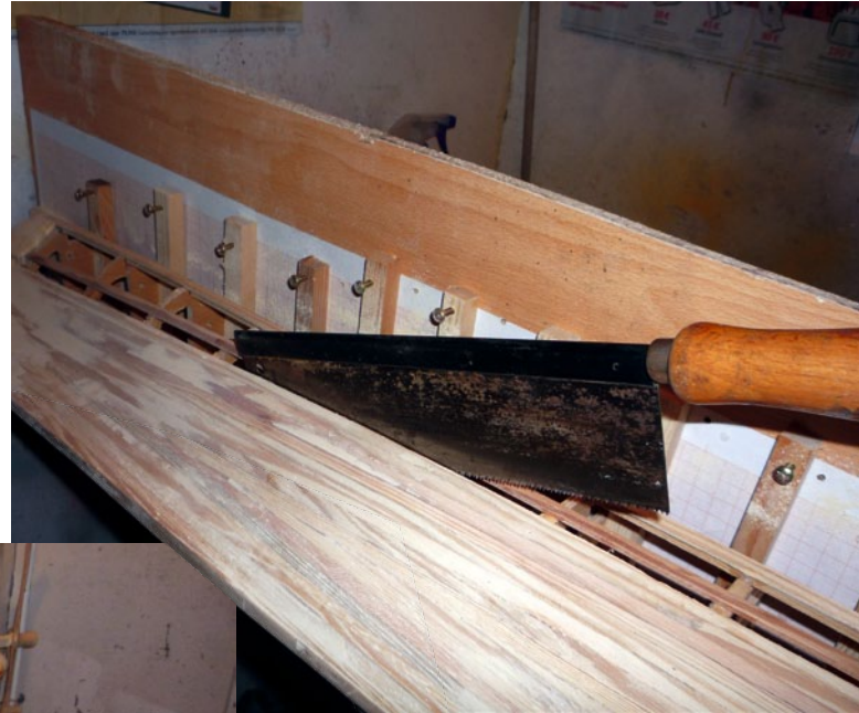
Mit einer feinen Säge wird der Rumpf in ein Ober- und ein Unterteil getrennt
