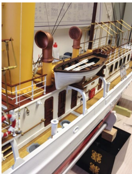
Die Lüfter backbords und mittschiffs. Heute sind sie gelb lackiert, doch ursprünglich war das Kupfer zu sehen
