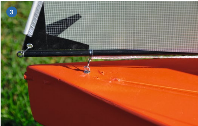
1) Die Ruderanlenkung erfolgt simpel und direkt. 2) Der Mast steht auf einem Schraubenkopf und die Hauptschot wird durch einen Gummi auf Zug gehalten. 3) Die Hauptschot tritt am Bug aus dem Rumpf, direkt hinter dem Fußpunkt des Vorstags. 4) Gut zu sehen, das flache, breite Heck mit den Doppellrudern
