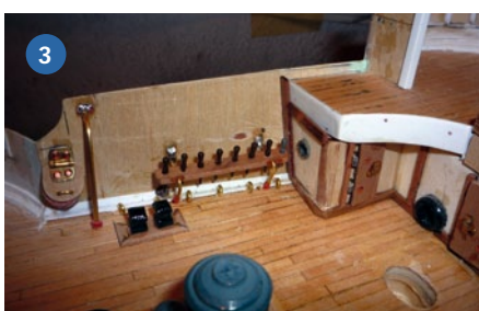
1) Mittelschiff im Rohbau mit vielen interessanten Details. Ein PVC-Rohr diente als Schornstein und ist mit Messingbeschlägen ausgestattet. 2) Die Treppe zum Betreten des Beiboots. Daneben platziert – noch unlackiert – das Rohr für die Ascheentsorgung. 3) Auf einem Segler darf die Nagelbank für das laufende Gut nicht fehlen
