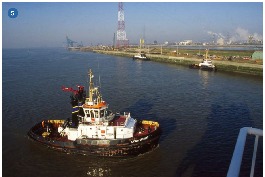
5) Aufbauten auf Schlepper sind (fast) immer vom Rumpf getrennt
