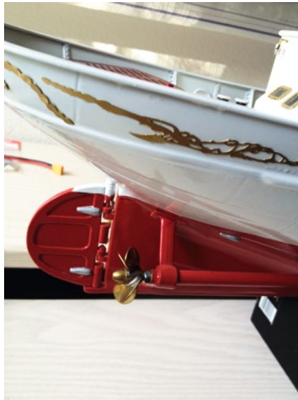
Ruder mit Steuerbord-Propeller und seitlicher Heckzier. Der überhängende Spiegel erinnert an die damalige Bauweise bei Segelyachten
