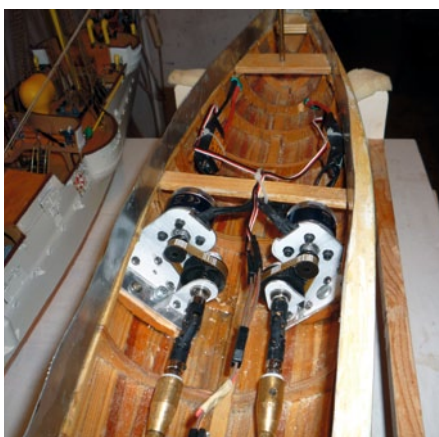
Das geöffnete Modell mit Blick auf die zwei Motoren mit Zahnriemengetriebe und stark versetzten Kardangelenken zu den Wellen
