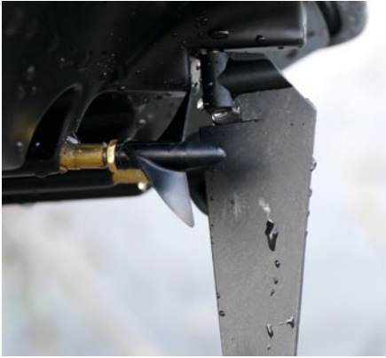
Im Gegensatz zu echten Jet-Skis hat das Modell ein konventionelles Ruder und außenliegende Schrauben
