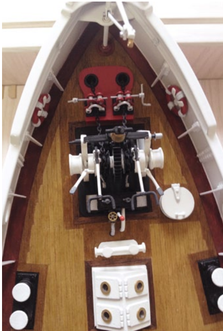
Ankerwinde mit Kettenstopper. Statt der ursprünglich schweren Metallteile kommt bei den Sockeln Holz zum Einsatz
