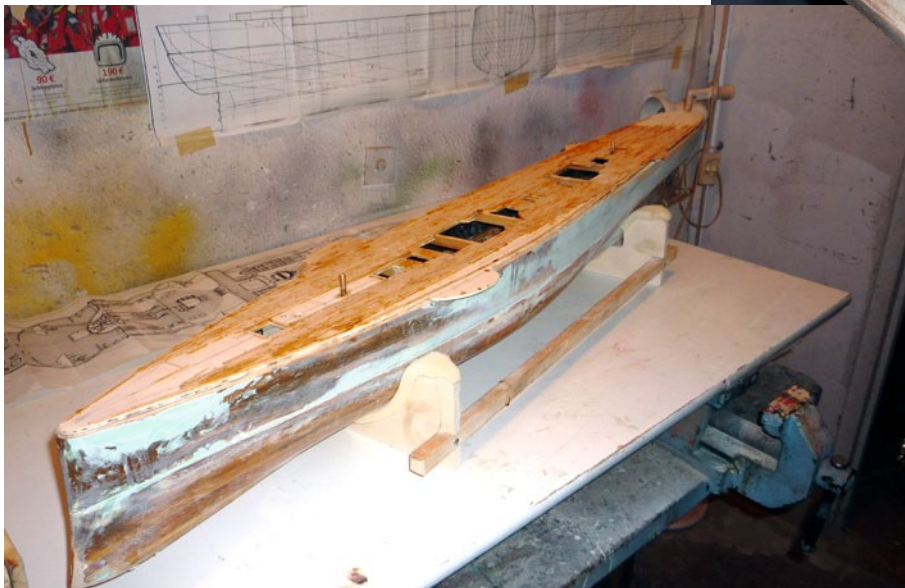
Der Rumpf ist weitgehend im Rohbau fertig und gespachtelt – auch die Stehbolzen sind bereits eingebaut. Zu sehen ist auch die Trennlinie des Rumpfs
