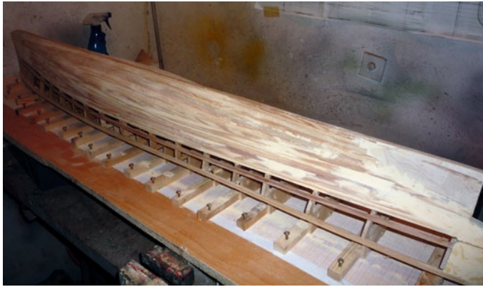
Das Modell entsteht. Hier ist der Rumpf auf der Helling aufgebaut und erste Planken sind gesetzt
