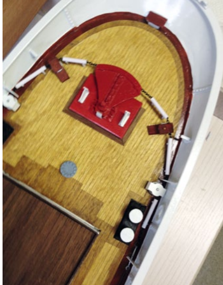
Ruder-Quadrant mit Kettenführung und Führungsrollen
