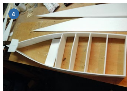
1) Mehr braucht man nicht, um die Einzelteile des Rumpfes herzustellen. 2) Zunächst werden die Seitenplanken am Bug verklebt. 3) Im nächsten Schritt wird dann der Spiegel eingebaut. 4) Die Spanten geben dem Rumpf seine Form
