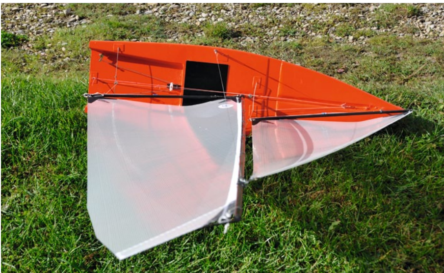
So müssen Segel stehen, die Fock ist 5 Grad weiter gefiert als das Groß
