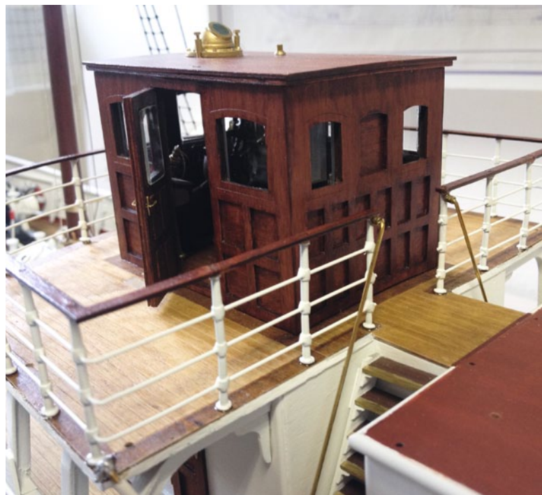
Das Steuerhaus mit den Kassettenförmigen Holzpaneelen und bereits montierter Relling
