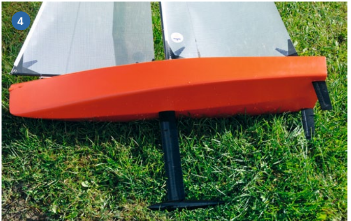
1) Die Ruderanlenkung erfolgt simpel und direkt. 2) Der Mast steht auf einem Schraubenkopf und die Hauptschot wird durch einen Gummi auf Zug gehalten. 3) Die Hauptschot tritt am Bug aus dem Rumpf, direkt hinter dem Fußpunkt des Vorstags. 4) Gut zu sehen, das flache, breite Heck mit den Doppellrudern
