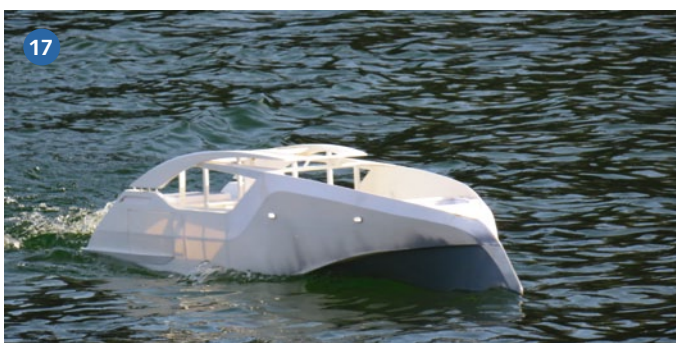
17) Die Megayacht SKY „zerschneidet“ förmlich das Wasser mit ihrem Bug. Markus und Benjamin Laimgruber bauten das Modell aus ABS-Plattenmaterial in Spantbauweise – siehe SchiffsModell 5/2018
