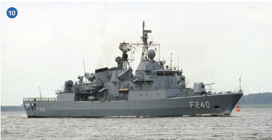
10) Fregatte BRANDENBURG mit Knickspantrumpf
