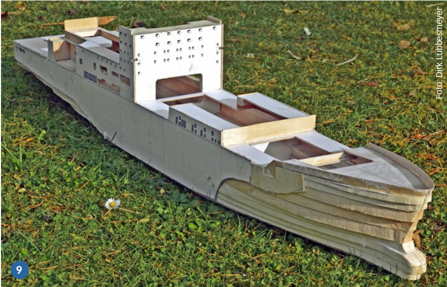
9) Hier sind Schicht- und Spantbauweise so gemischt, dass selbst Aufbauten gleich beim Bauen integriert wurden – das Downloadplanmodell AKE-3 von Dirk Lübbesmeyer aus SchiffsModell 1/2018
