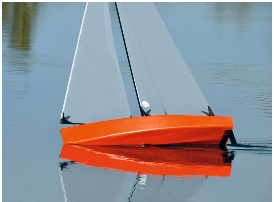
Bei Krängung hebt sich das Luvruder weit aus dem Wasser, hier fehlt noch das stützende Foil
