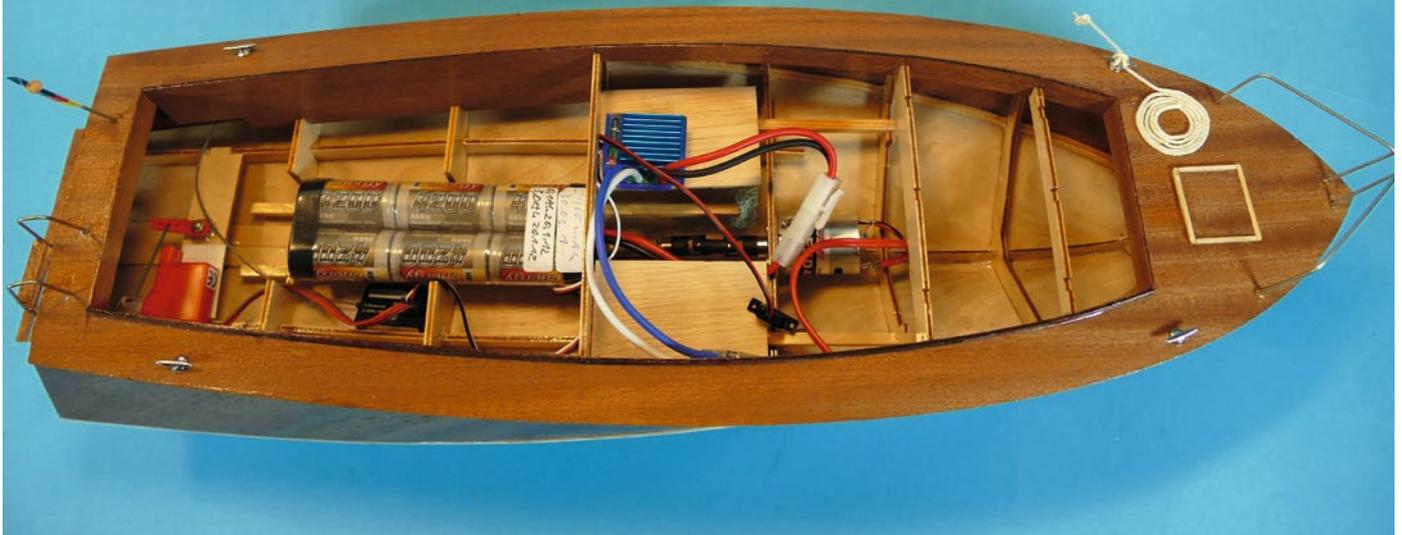
hen. Es folgte das Herauslösen der mit Laser geschnittenen Holzteile aus den Platten und das Verputzen der Teile. Das Aufstellen der Spanten und Kleben des Spantengerippes waren die nächsten Schritte. Die Pausen, die durch das Aushärten des Klebers entstanden, wurden mit anderen Teilarbeiten und mit der Suche nach geeigneten Lösungen für die nächsten Bauschritte überbrückt.
