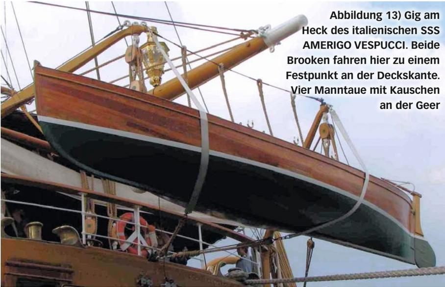
Abbildung 13) Gig am Heck des italienischen SSS AMERIGO VESPUCCI. Beide Brooken fahren hier zu einem Festpunkt an der Deckschante. Vier Manntaue mit Kauschen an der Geer
