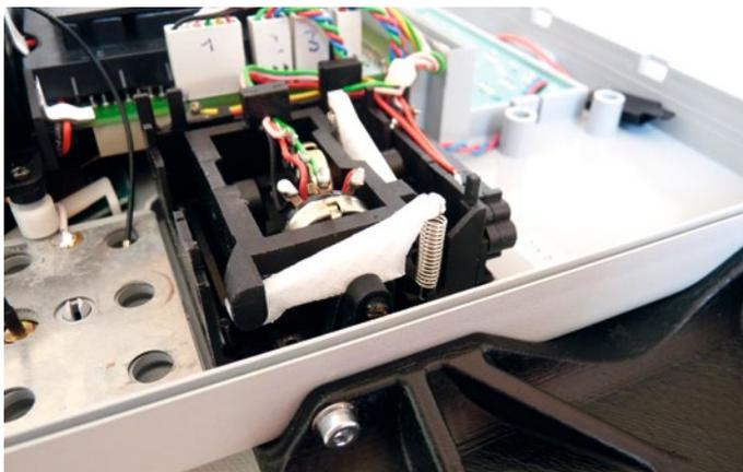
Auch filigrane Teile lassen sich aus PLA stabil drucken – bei 100 Prozent Füllung versteht sich. Die (weißen) Knüppelumlenkungen eines alten Multiplexsenders konnten so gegen neue mit einer anderen Federstellung ausgetauscht werden
