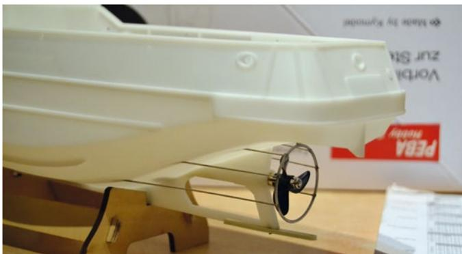
Rund um die Schiffsschraube ist ein Schutzkäfig zu bauen, was sich leicht umsetzen lässt
