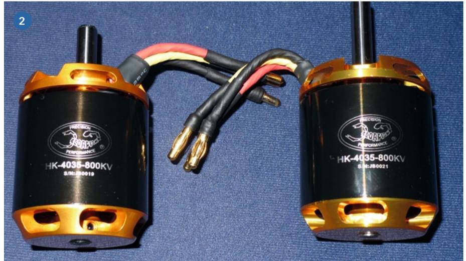
1) Die zusätzliche Kondensatorbank wird direkt in die Reglerzuleitung eingelötet. Diese ermöglicht höchste Teillastfestigkeit und optimale Leistung im Grenzbereich. 2) Das Außenläufer-Pärchen Scorpion 4035-800 sorgt für Vortrieb
