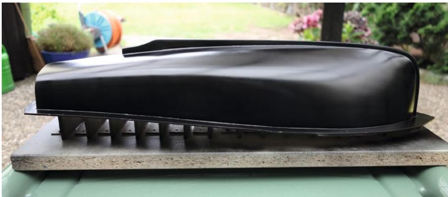
Nach mehreren Malen Schleifen und Spachteln ist der fertige Ur-Rumpf in Schwarz lackiert fertig
