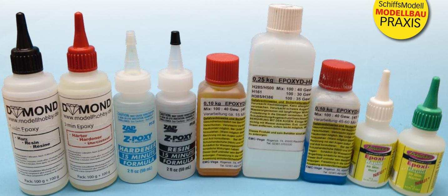
Klebesystem-Armada! Von links: Fünf-Minuten-Epoxy, 15-Minuten-Epoxy, schneller Härter (Topfzeit zehn Minuten) für Epoxidharz L 285, Harz L 285, langsamer Härter für L 285 und ganz rechts 30-Minuten-Epoxy
