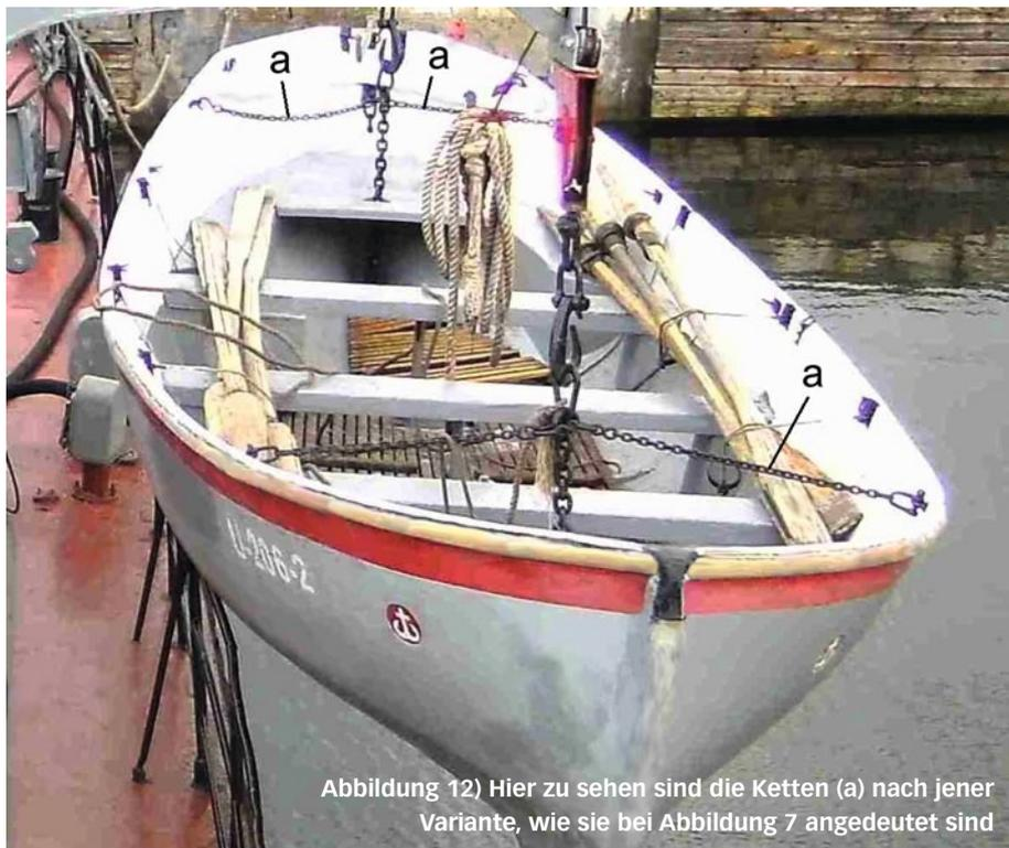
Abbildung 12) Hier zu sehen sind die Ketten (a) nach jener Variante, wie sie bei Abbildung 7 angedeutet sind
