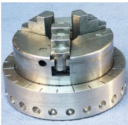
Futter mit Drehkörper und Indexteilung 24 × 15 Grad
