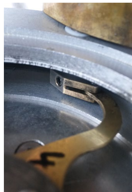
Rotor mit komplett montierter Kinematik (Lenker alte Bauart)
