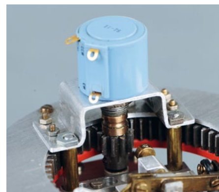
Die Antriebseinheit ist auf dem Auflagering montiert und alles auf dem Zahnkranz aufgesetzt
