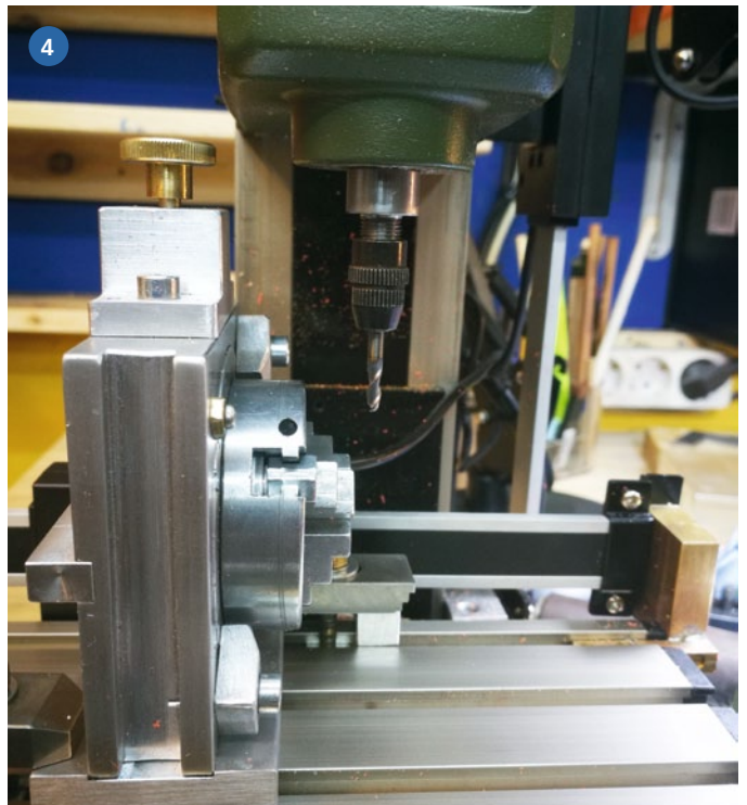
1) Grundkörper mit Nutensteinen. 2) Ausdrehen des Grundkörpers. 3) Gravieren der 24er-Teilung. 4) Vertikale Montage des selbst gestalteten Teilkopfs an der Proxxon MF 70
