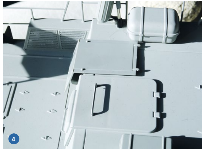
1) Damit die RC-Anlage gegen Spritzwasser geschützt ist, ist sie mit abnehmbaren Abdeckungen verschlossen. Der Spalt der Abdeckungen ist höchst präzise, minimal ausgeführt und kaum als solcher von außen erkennbar. 2) Einige der Details entstammen dem Tiger-Bausatz, andere dem von Pro Boat – der Mix macht's. 3) Der Radarbalken ist auch auf neueren Originalen der schwedischen Flotte zu finden. 4) Die zu öffnende Luke stammt aus dem Tiger-Bausatz und wertet das Pro Boat-Modell weiter optisch auf
