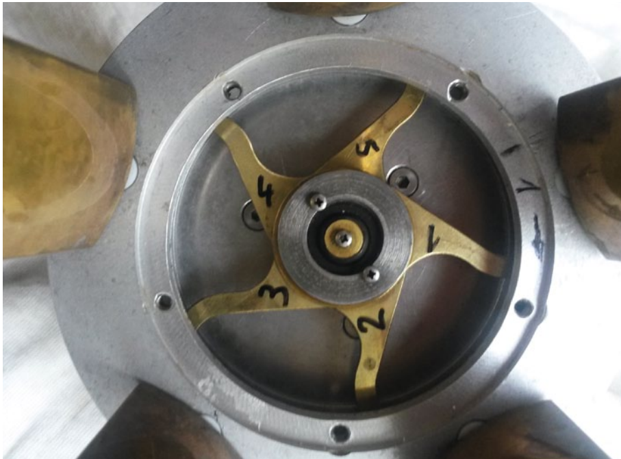
Blick in den VSP-Rotor. Messerhebel zwischen den beiden Lagerstellen für die Messerwelle. Die Lenker zeige hier noch die alte Bauart
