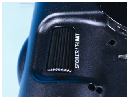
Die rechte Steuerwalze auf der Unterseite. Die Kanäle 5 und 6 werden über diese Drehwalzen betätigt
