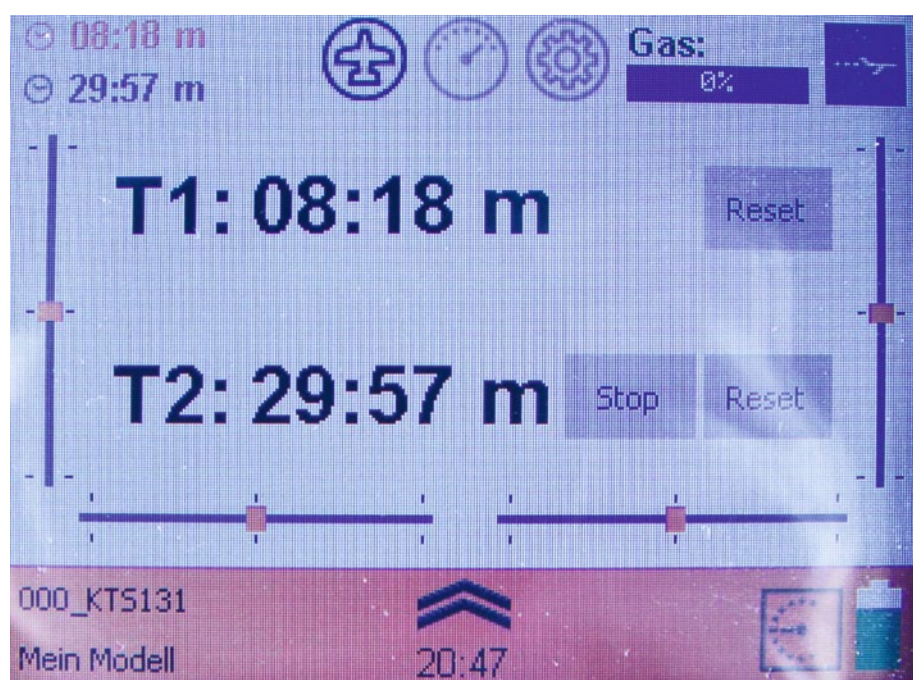
Startseite mit Timeranzeige. Das Praktische am Sender ist das farbige, hintergrundbeleuchtete und sich der Umgebungshelligkeit anpassende Touch Screen-Display
