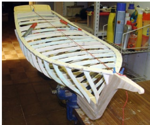
In klassischer Bauweise auf Spanten, Kiel und Balkweger entstand der Rumpf
