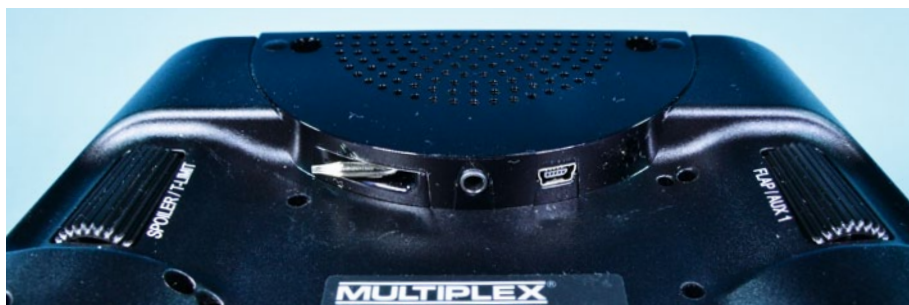
Blick auf die Unterseite des Lautsprechers mit den Buchsen für USB zum Updates und Laden sowie Ohrhörer
