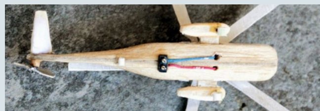
Seinen Strom und gleichzeitig festen Halt an Deck erhält der Sea King über Steckkontakte auf der Unterseite
