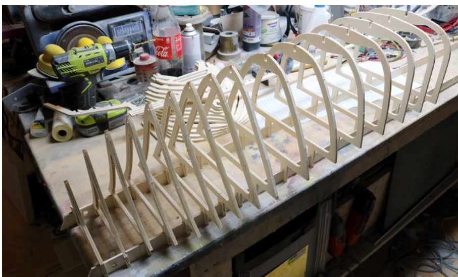
Aufstellen der Spanten, aber statt einer Heling übernehmen zwei gefräste Aufstelleisten die Aufgabe der exakten Positionierung. Verklebt wird mit Weißleim
