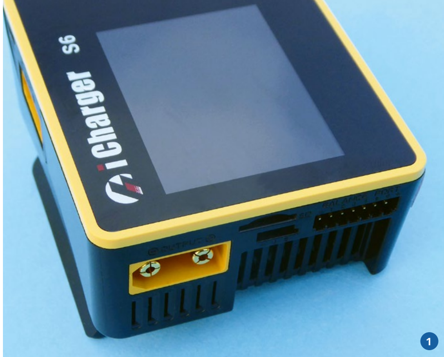
1) Im linken Seitenteil sind die Akkuanschlüsse, der Multifunktions-Port sowie der SD-Karten-Slot untergebracht. 2) Auf der rechten Seite befindet sich die Wippe zur Bedienung sowie ein kräftiger Lüfter. 3) Auf der Rückseite wird die Spannungsquelle über einen XT90-Stecker angeschlossen, außerdem befindet sich dort ein Mini-USB-Port
