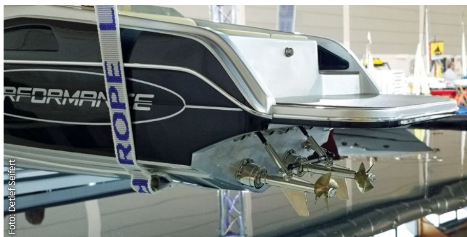
Spezielle Antriebe: Voll funktionsfähige Oberflächen-Antriebe vom Typ ARNESON-Drive am Modell einer PERFORMANCE 1107 im Maßstab 1:10
