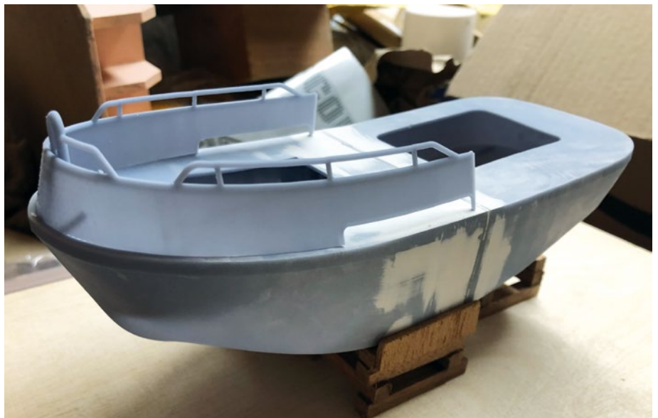
Der Vorteil von 3D-Druck ist, ganze Teile mitsamt Ausrüstungsgegenständen konstruieren und drucken zu können, wie das Schanzkleid verdeutlicht
