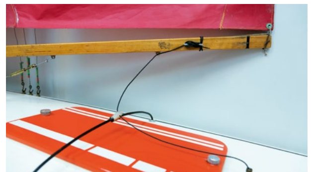
Schotführung zum Großbaum. Den Bauch am Segel verstellt man einfach durch die Klemme
