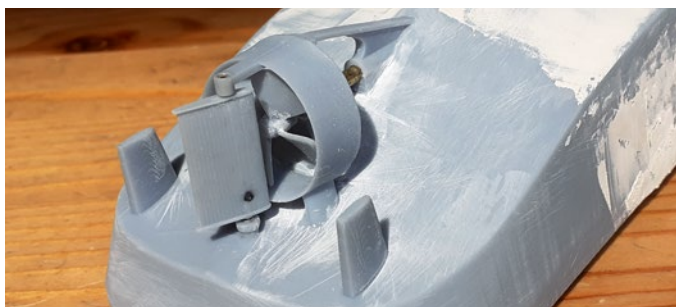
Auch die komplette Antriebs- und Ruderanlage stammt aus dem 3D-Drucker beziehungsweise Teile wurden bereits im Druck berücksichtigt, sodass bestimmte Montage- und Klebearbeiten entfielen
