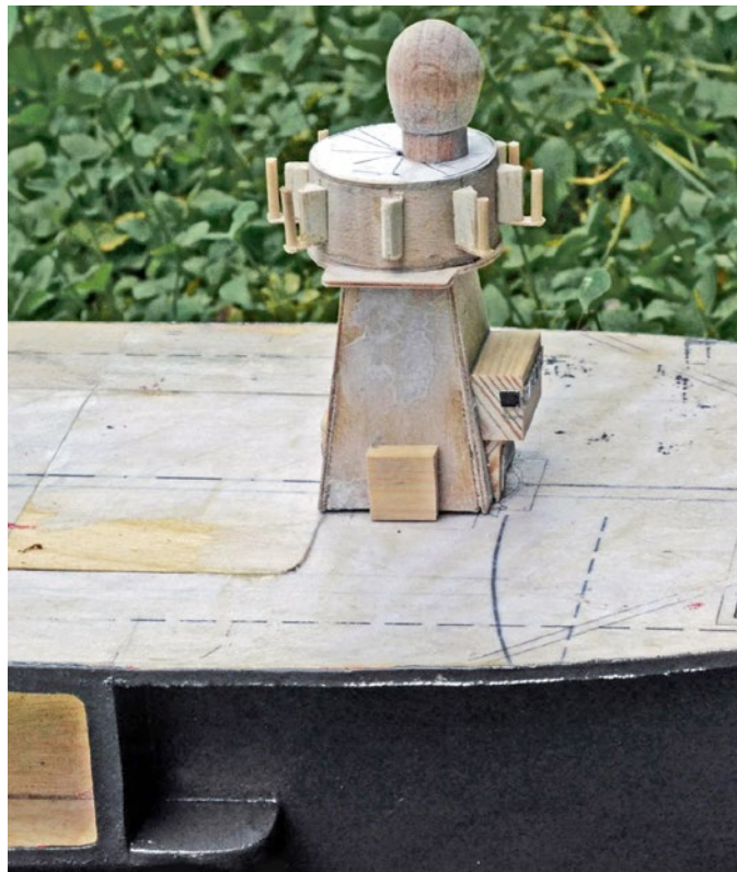
Der achterne Elektronikurm im Rohbau
