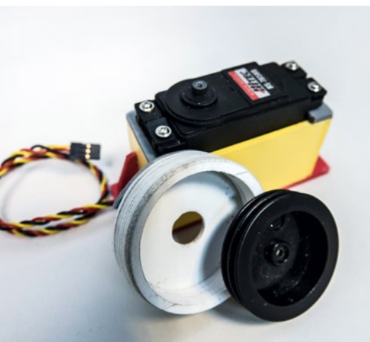
Originaltrommel mit selbst gefertigter Kapsel aus Schaum-PVC
