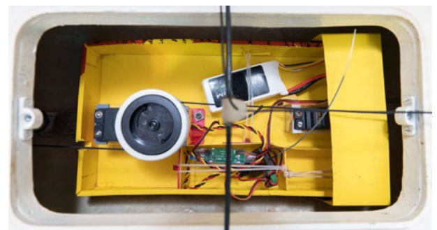
Die eingesetzte Multiplex-Winde. Der Container schützt die Elektronik noch einmal zusätzlich vor Wasser
