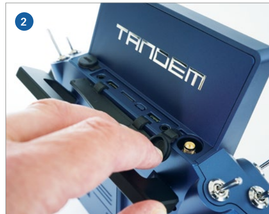
1) Zahlreiche Schalter, Drehgeber und Taster machen die X20S zu einem Multifunktionsender. 2) Rückseitig befinden sich ein SD-Mikro-Karten-Slot, USB-Anschluss und Anschlüsse für externe Module
