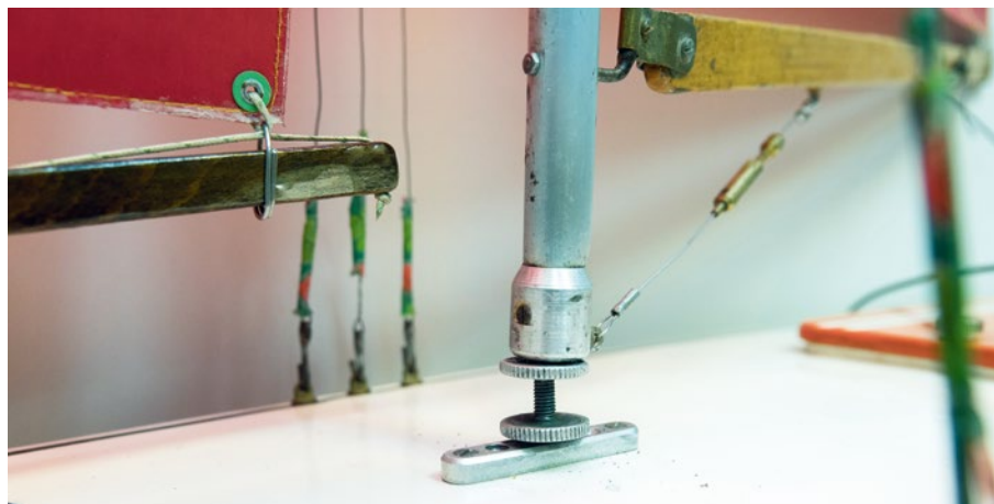
Die Wanten werden durch Hochdrehen des Mastes gespannt
