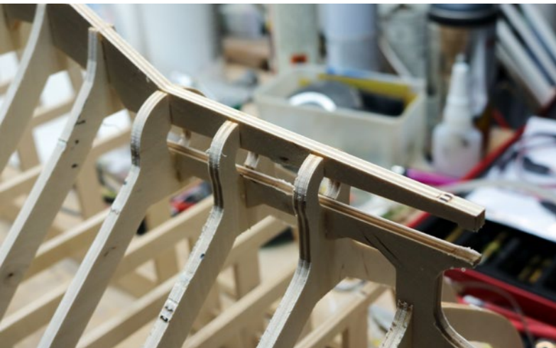
Für den direkten Einbau des Stevenrohrs sind in den Spanten Rundungen eingefräst
