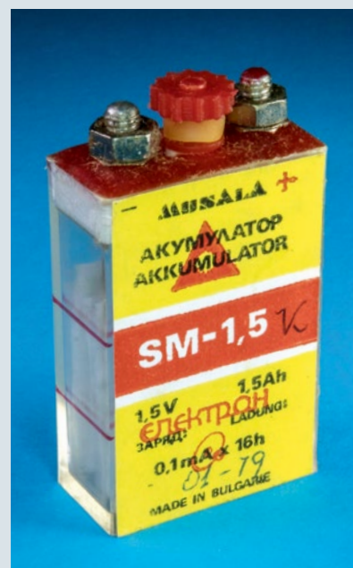
6 Zellen dieses Silber-Zinkakku 1,5 V, 1.500 mAh habe ich früher als Stromversorgung für die Segelwinde im Wettkampf eingesetzt. Eine Zelle wog nur 28 g
