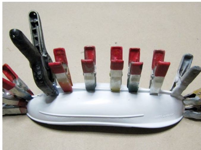
Wasserdichtes und verzugsfreies Verkleben ist das A und O. Da können es gar nicht genug Klammern sein
