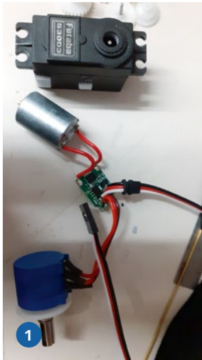
1) Ursprünglich war es geplant, die Antriebe aus Motoren und Elektronik von Servos zu bauen – das klappte jedoch nicht wie gewünscht. 2) Im Rumpf ist zwar nicht viel Platz, aber es reicht, um alle Komponenten unterzubringen. 3) Der Grundaufbau ist lackiert, nun kann es an die Details gehen
