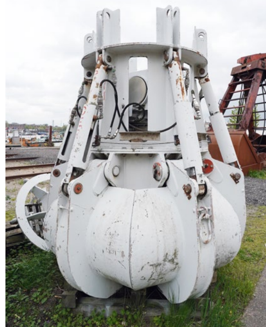
Kaikrane konnten verschiedene Schaufeln oder Greifer zum Laden oder Löschen von Ladung nutzen und sind Teil der Ausstellung
