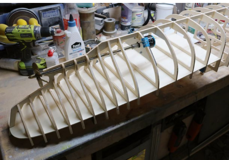
Damit Antriebswelle, Kupplung und Motorwelle exakt fluchten, ist das Gespann beim Einkleben der Welle eingesetzt
