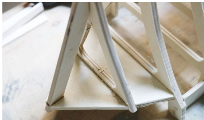
Auch der Bugbereich muss – identisch zum Heck – mit einem Formklotz gestaltet werden
