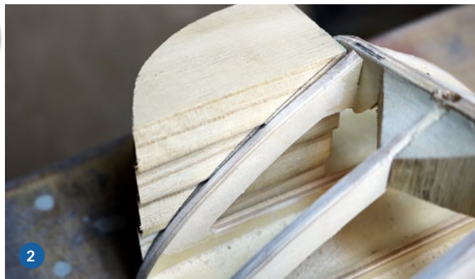
1) Da sich der hintere Teil zwischen letztem Spant und Steven nicht beplanken lässt, kommen vorgesägte Formklötze in Schichtbauweise zum Einsatz. 2) Anhand des Spants lässt sich gut ablesen, welcher Kontur der Heckbereich folgen muss
