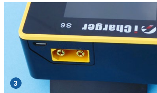
1) Im linken Seitenteil sind die Akkuanschlüsse, der Multifunktions-Port sowie der SD-Karten-Slot untergebracht. 2) Auf der rechten Seite befindet sich die Wippe zur Bedienung sowie ein kräftiger Lüfter. 3) Auf der Rückseite wird die Spannungsquelle über einen XT90-Stecker angeschlossen, außerdem befindet sich dort ein Mini-USB-Port
