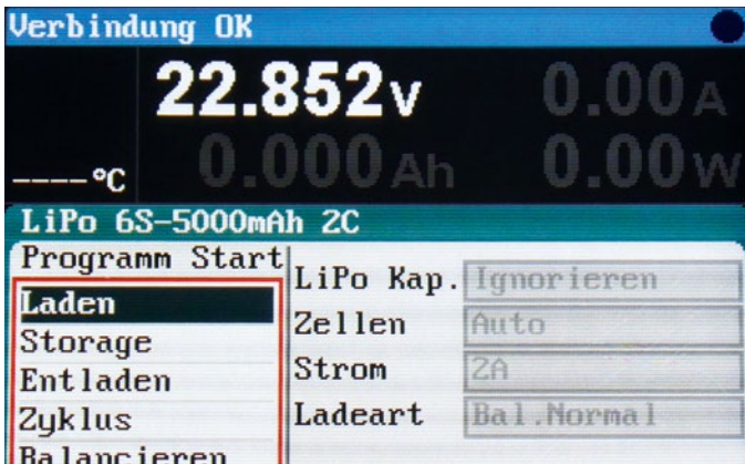
Für Lithium-Zellen stehen alle relevanten Lade- und Entlade-Vorgänge zur Verfügung – die Bedienung ist selbsterklärend
