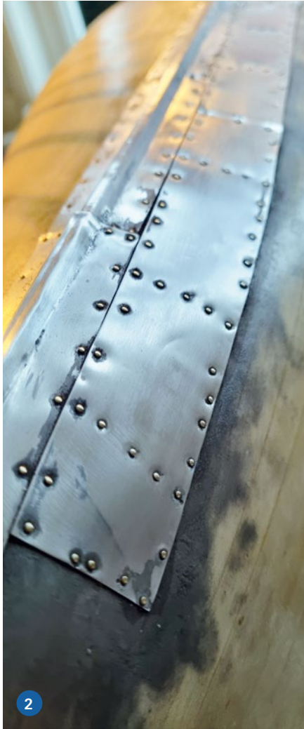
1) Das Modell im Rohbau ist fertig. 2) Der Rumpf wurde komplett mit Alublechen und kleinen Messingnägeln beplankt. So entstand genau der gleiche Look wie beim Original. 3) Das Deck entstand aus zwei einzelnen Teilen, um es besser und ohne Spannung montieren zu können
