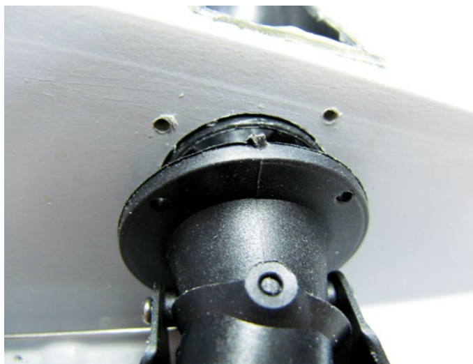
Die Bohrungen für die Düsen der Jet-Antriebe passten leider nicht und mussten daher korrigiert werden
