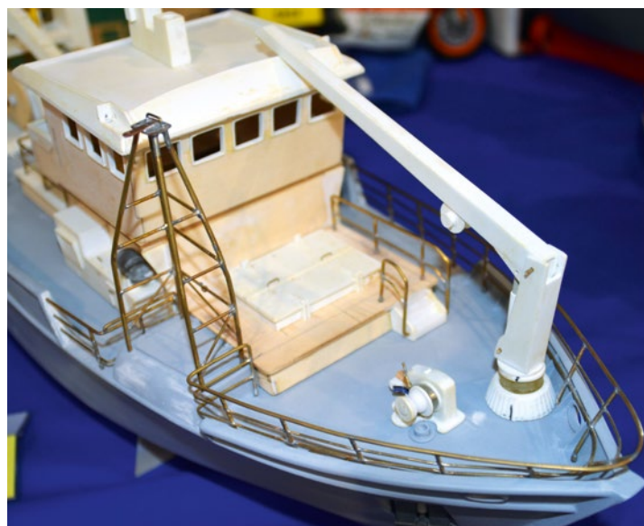
Das Ladegestell über der neuen Luke auf der Back
