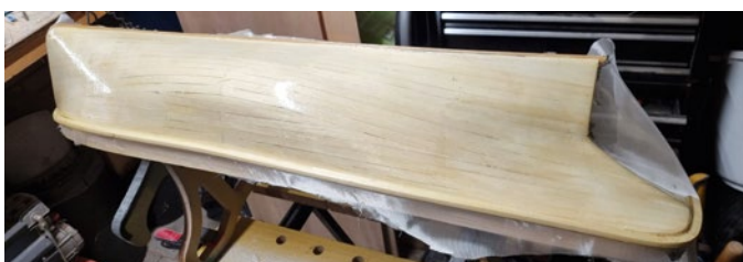
Für mehr Stabilität und Schutz wurde der Rumpf mit einer Schicht Glasfasermatte überzogen
