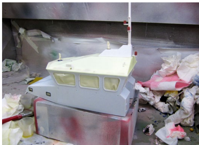
Die ersten Baugruppen werden lackiert. Dazu ist das Deckshaus entsprechend abgeklebt
