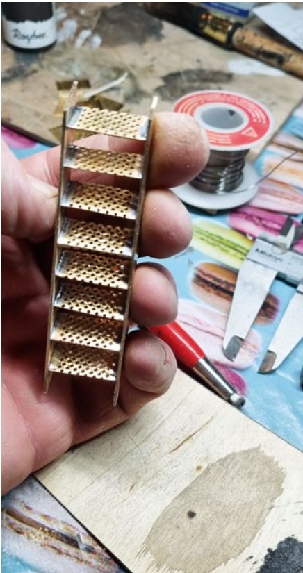
Sämtliche Details des Schiffs, so wie diese Treppe, entstanden komplett in Eigenregie, größtenteils aus Messing
