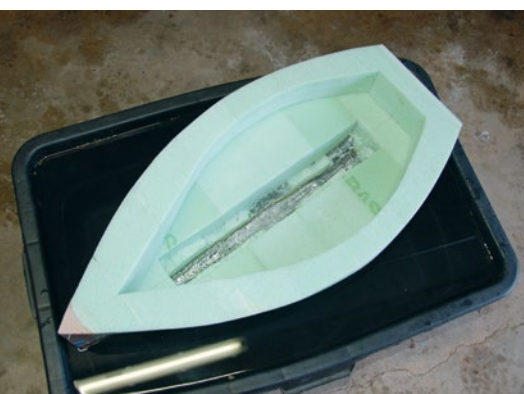
Das Bleigewicht wurde direkt in den Schaum gegossen
