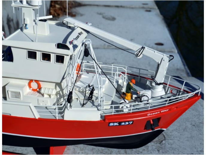
Das Schanzkleid wurde teilweise entfernt, dafür gab es eine vollumfängliche gelötete Reling
