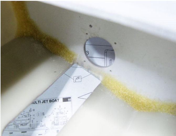
Die Ausschnitte für die Jet-Antriebe im Rumpf
