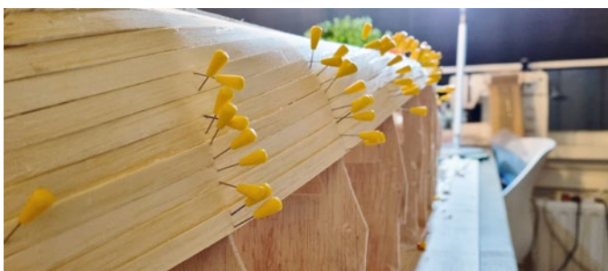
Der gesamte Rumpf wurde mit 3-mm-Balsaholz beplankt
