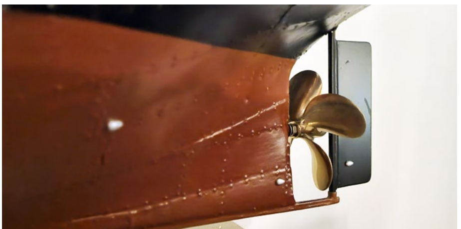
Der große Schiffspropeller arbeitet bei niedriger Drehzahl, hat dafür eine große Steigung
