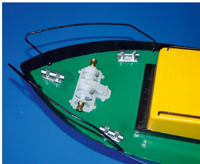
Eine noch vorhandene Winde sorgt für einen Blickfang auf dem Vordeck
