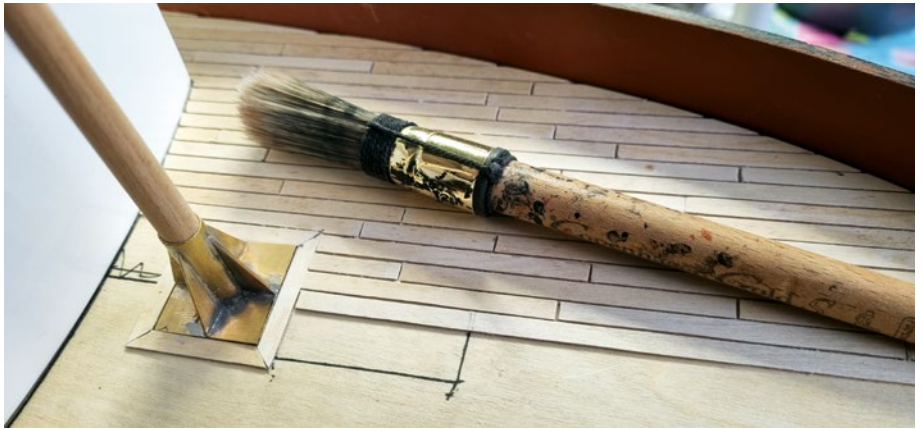
Sehr aufwändig war die Beplankung des Decks mit Holzleisten. Die Kalfaterung wurde durch Flüssiggummi imitiert
