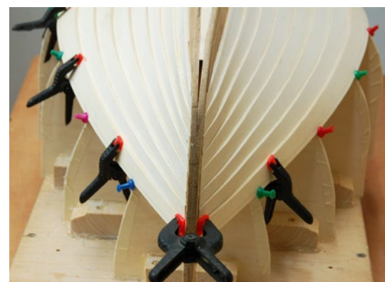
Jede Planke ist eine Maßanfertigung, damit am Ende alles spaltenfrei sitzt
