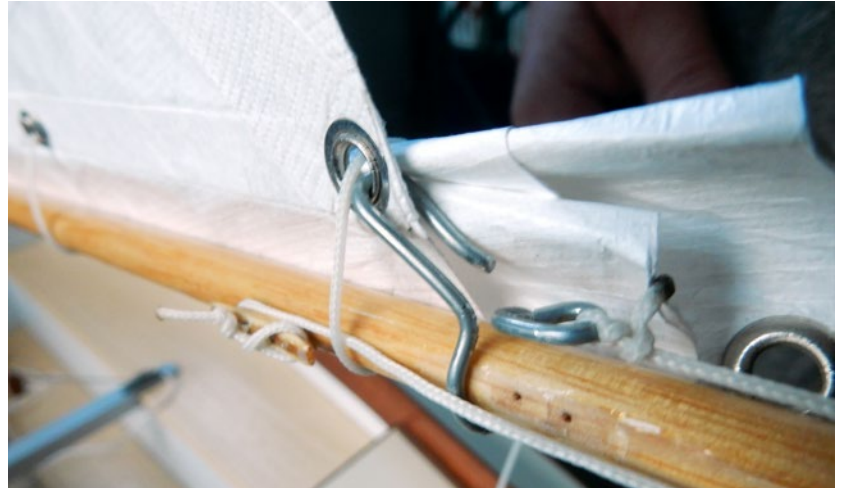
Auch das Schothorn wird an einem Haken eingehängt, nur muss dieser auf dem Baum rutschen können, damit das Unterliek eingestellt werden kann, ...
