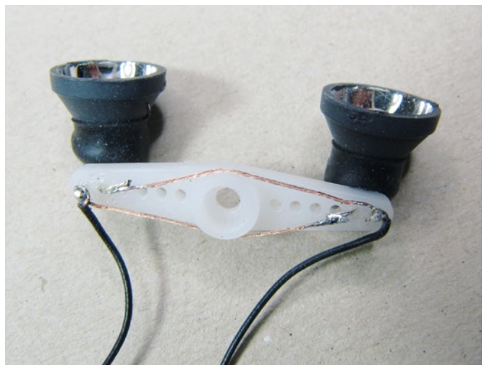
Die schwenkbaren Arbeitsscheinwerfer wurden auf einem Servohebel montiert
