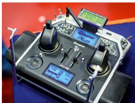
Die von Reiner Hans verwendeten, speziell geformten Steuerknüppel sind genau auf die Erfordernisse beim Betrieb der TEXELBANK ausgelegt. Sie werden über IMTH vertrieben
