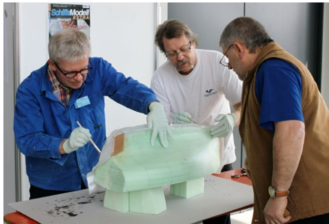
Nachdem der Rohling in Form gebracht war, konnte er mit Glasfasergewebe laminiert werden
