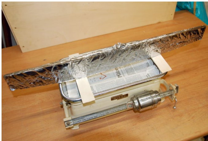
Für den Holzrumpf wurde auch ein Bleigewicht angefertigt. Es hat ein Gewicht von 4,8 kg und passt genau in den Rumpf
