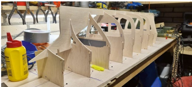
Die Spanten wurden aus Sperrholz ausgesägt und über Kopf auf dem Baubrett montiert. Dann kam der Kiel darauf
