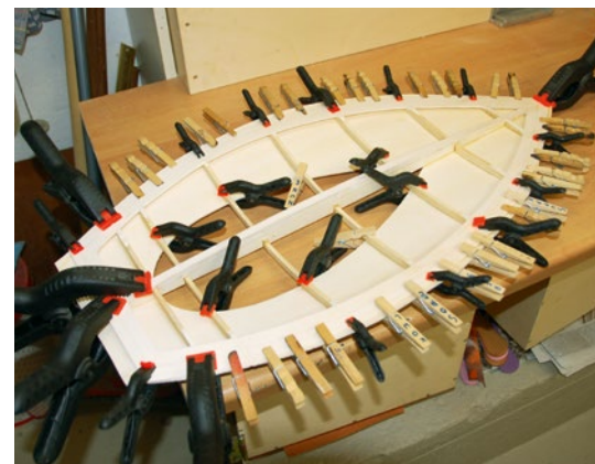
Das Deck entstand ebenfalls komplett in Holzbauweise
