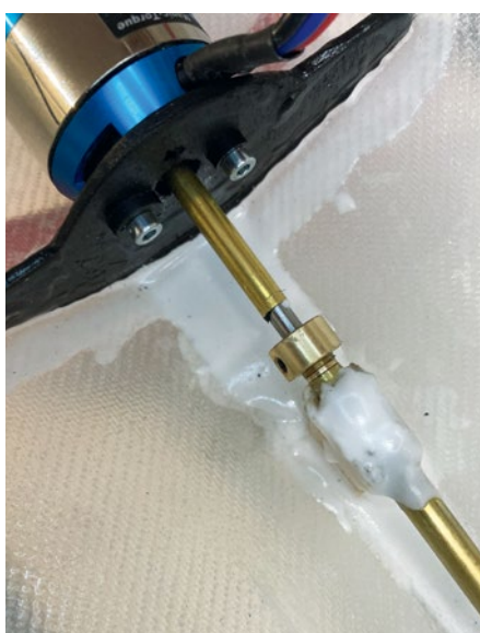
Der Motorspant und die Abstüzung der Schraubenwelle sind mit reichlich angedicktem Epoxydharz am GFK-Rumpf verklebt
