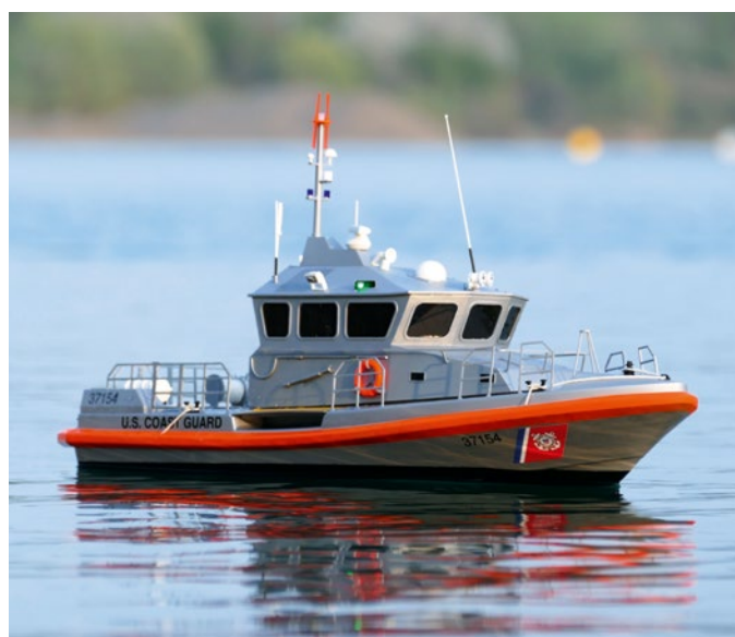
Mit Trimmblei wurde das U.S.-Coast-Guard-Modell so beschwert, dass die Jet-Antriebe komplett unter Wasser sind
