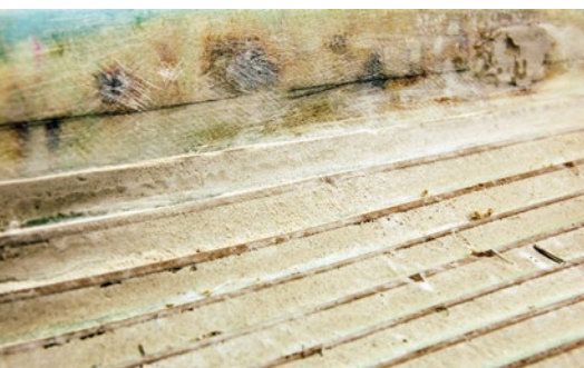
Leider entstanden unter der Spachtelmasse Luftblasen und andere Lunker, weshalb der GFK-Rumpf vorerst ausgemustert wurde
