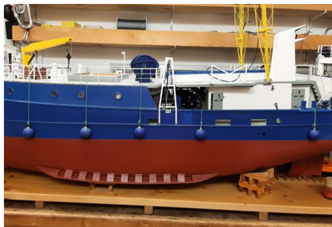
Lehre nach der ersten Ausfahrt: Fender gegen Lackschäden
