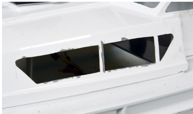
Abgeplatztes Laminat wird mit Sekundenkleber repariert und verschliffen
