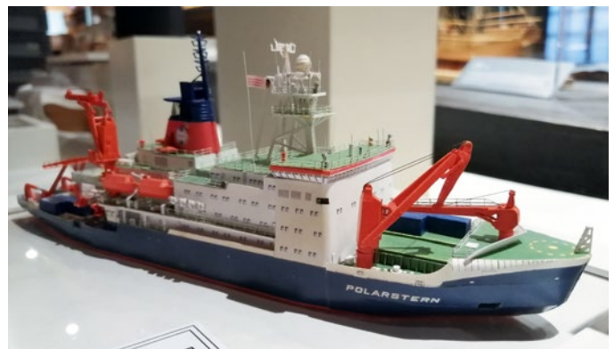
Die POLARSTERN ist ein als Eisbrecher der deutschen Eisklasse ARC3 ausgelegtes Forschungs- und Versorgungsschiff
