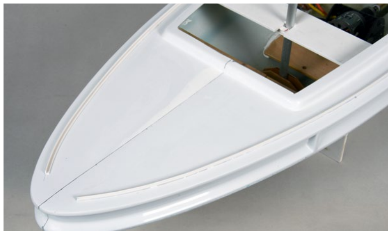
Auf Deck wird rund um das Boot eine Winkelleiste aufgesetzt
