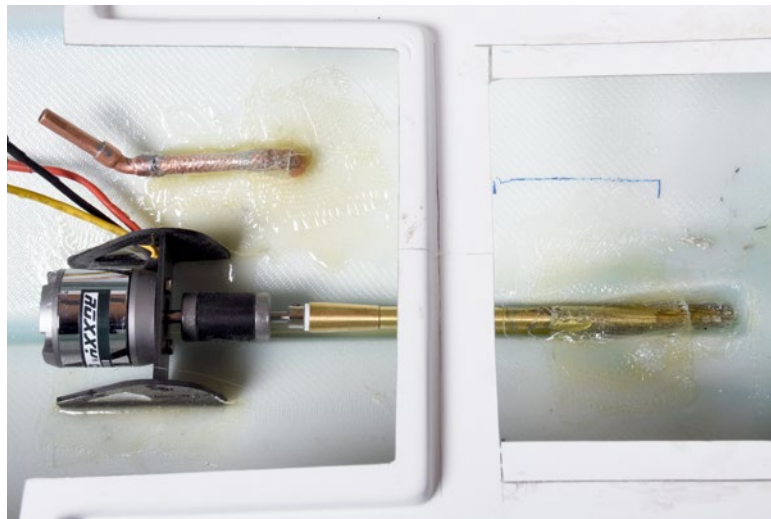
Der Antriebsstrang und das Saugrohr für die Löschanlage sind fertig eingearbeitet
