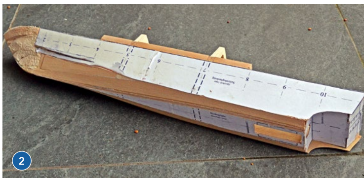
1) Von unten erkennt man den flachen Rumpfbodenteil mit der Öffnung für den Jet-Eintritt, das Bugsegment in Schichtbau und die dünne Seitenbeplankung. 2) Der Rumpf von oben. Die verlängerten Spanten 2 und 3 halten den Aufbau
