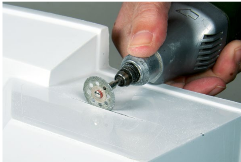
Zum Ausschneiden der Fensteröffnungen nimmt man am besten eine Diamanttrennscheibe
