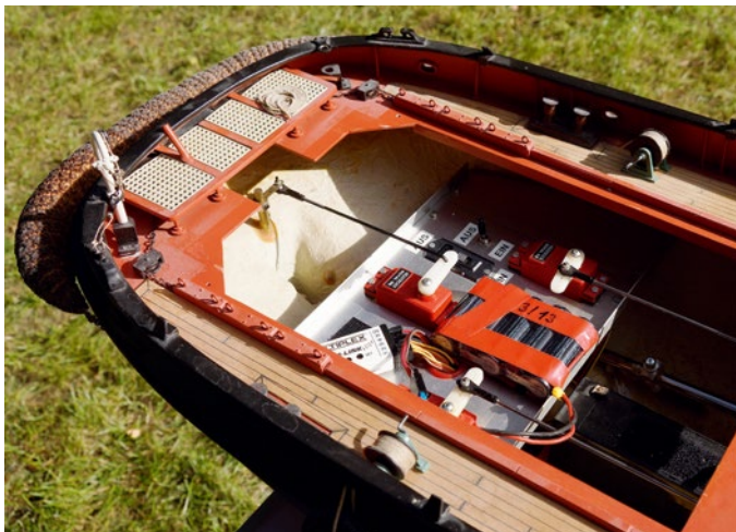
Im Heck des Schleppers ist die Elektronik der Fernsteuerung untergebracht
