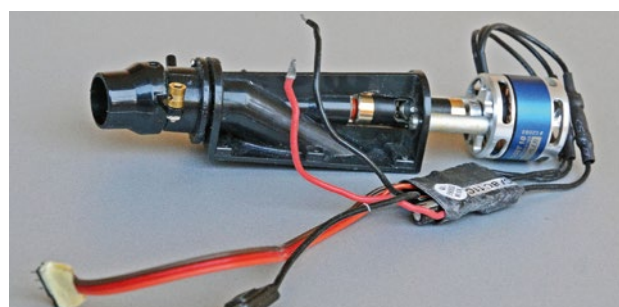
Der einbaufertige Wasserjet mit direkt angeflanschem Brushless-Motor
