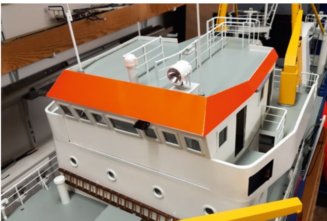
Die Dachkanten am Steuerhaus wurden mit Folie aus dem Kfz-Bereich beklebt
