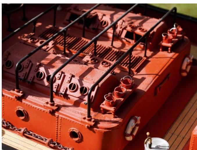
Durch die geöffneten Oberlichter kommt genug Frischluft in den Maschinenraum
