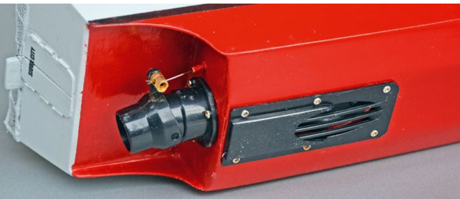
Am Heck sind die Anlenkung an die Schwenkdüse und die Abdeckung des Jet-Einlaufs zu sehen
