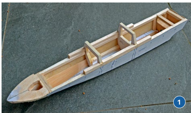
1) Von unten erkennt man den flachen Rumpfbodenteil mit der Öffnung für den Jet-Eintritt, das Bugsegment in Schichtbau und die dünne Seitenbeplankung. 2) Der Rumpf von oben. Die verlängerten Spanten 2 und 3 halten den Aufbau
