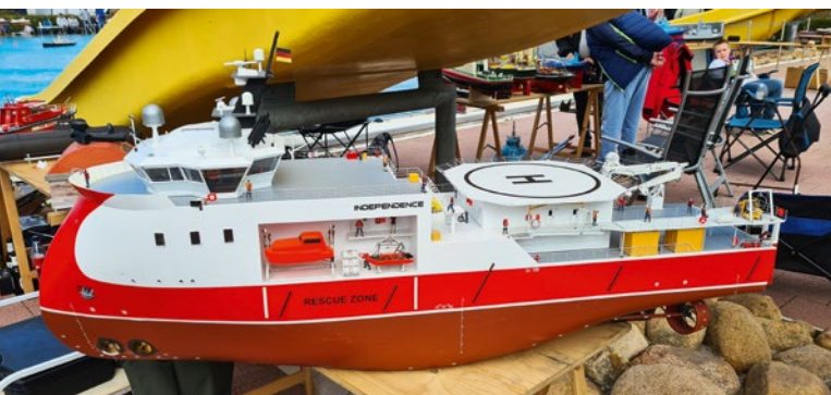
Die INDEPENDENCE, ein Offshore-Modell mit Ulstein X-Bow-Bug
