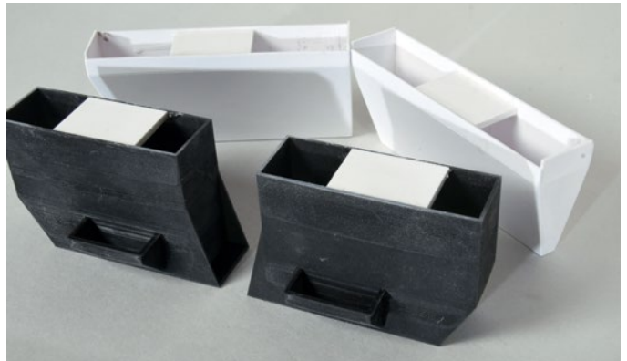
Aus Reststücken werden Bodenplatten zur besseren Stabilität und Montage eingeklebt
