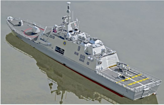
Mit dem in der Badewanne ermittelten Bleiballast liegt das Modell gut im Wasser
