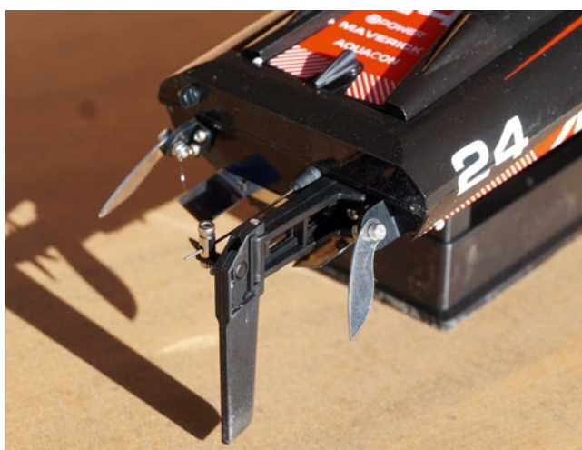
Der Propeller, das Ruder, die beiden Trimmbleche und die beiden Turnfins teilen sich den Platz am Spiegel
