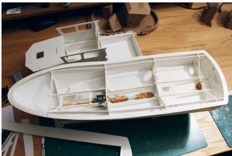
Der Motor, das Stevenrohr und der Ruderkoher werden ausgerichtet und eingearzt
