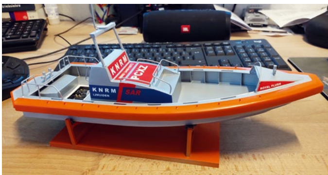
Nach der erfolgreichen Probefahrt wurden selbstgedruckte Folien aufgebracht
