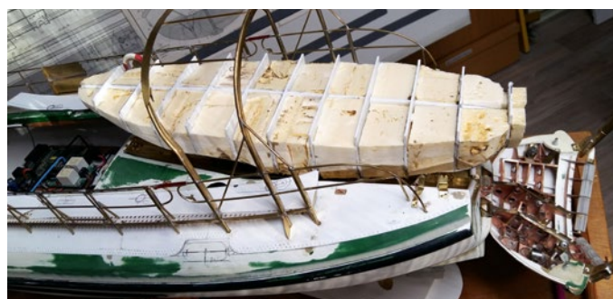
Die mit Hartschaumstücken gefüllte Rumpfform beim ersten Probeliegen
