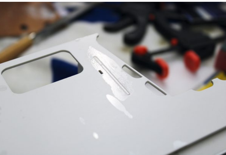
Die Verzahnungen mit den Innenwänden werden später verspachtelt
