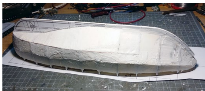
Danach wurde der Rohling wiederholt gespachtelt und geschliffen
