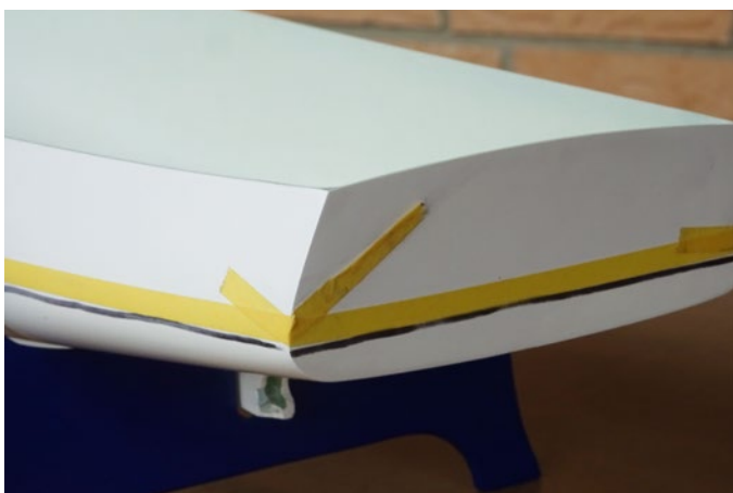
Das Maskierband vom Heckspiegel ziehe ich nach oben, um sicherzustellen, dass es an der Ecke garantiert stramm sitzt. Genauso wird das Band für die Rumpfseite nach oben gezogen
