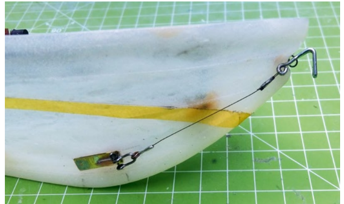
Der Fanghaken mit den extrem bruchsicheren Stahlseilen wurde vorläufig montiert
