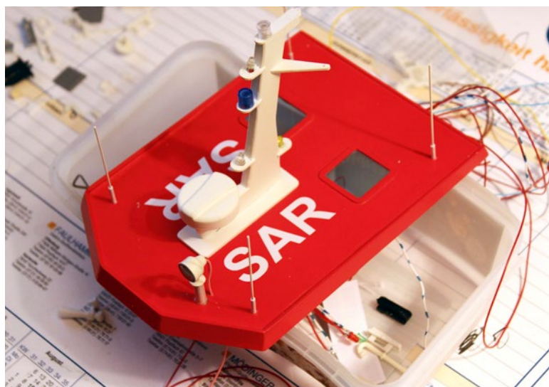
Die nautische Beleuchtung und die Arbeitsscheinwerfer werden auf das Dach montiert
