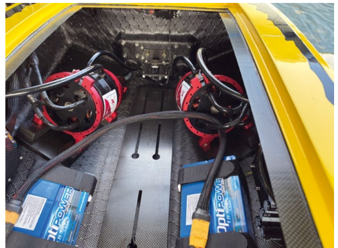
Das 2.460 mm lang Mono-Rennboot wird von zwei kraftvollen Plettenberg-Motoren angetrieben
