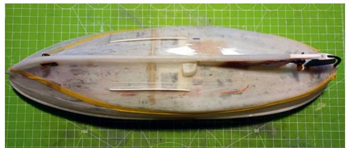
Das Unterwasserschiff mit den diesmal korrekt angebrachten Schlingerkielen
