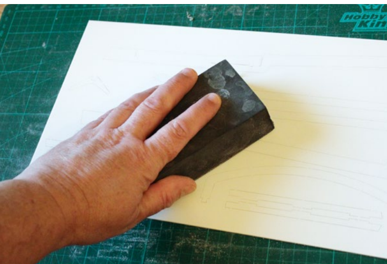
Vor dem Heraustrennen der Bauteile werden die Platten beidseitig übergeschliffen
