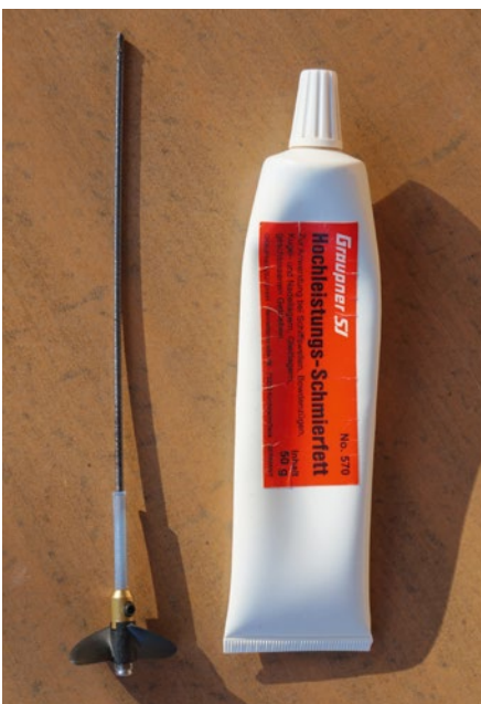
Die ausgebaute Flexwelle habe ich mit reichlich Fett gegen Korrosion und Wassereintrich geschützt
