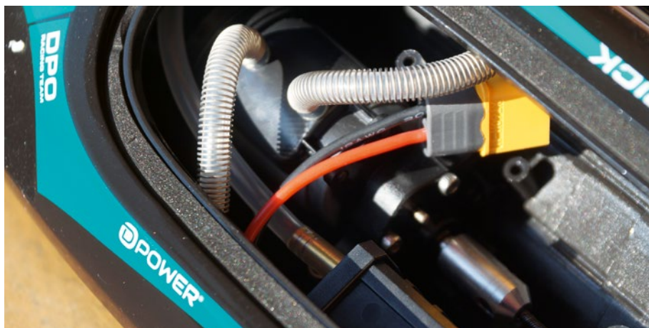
Auch bei der MAVERICK ohne Pro sind sowohl der Motor als auch der Regler wassergekühlt
