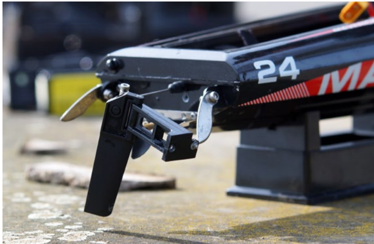
Ein treibender Ast hat das Ruder aus der Verankerung gerissen
