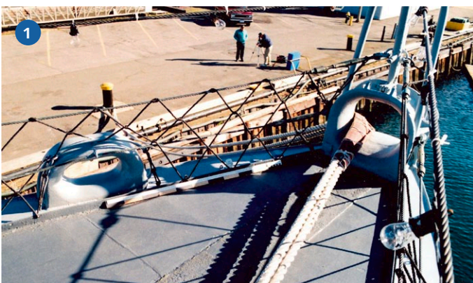
1) Klüsen als schwere Gussteile. 2) Heckklüse mit dem Hecklicht darüber an einem kurzen Stummel-Heckflaggstock
