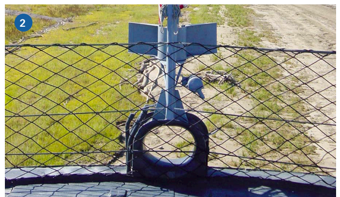
1) Klüsen als schwere Gussteile. 2) Heckklüse mit dem Hecklicht darüber an einem kurzen Stummel-Heckflaggstock
