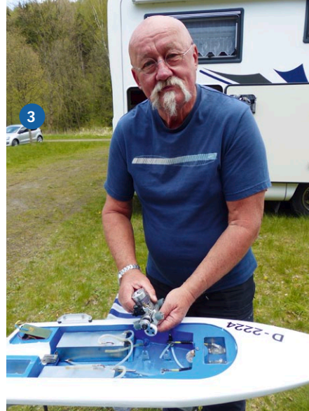
1) Die Rennboote der Klasse FSR-V 3,5 cm 3 von Jan und Christoph Schneider mit neuen Motoren. 2) Startvorbereitung bei Marcus Möller mit seinem Katamaran der Offshore Klasse 27 cm 3 . 3) Peter Krenkel, vom SMC Schwedt-Oder beim Getriebewechsel an seinem 3,5er-Offshore.
