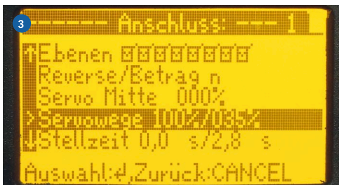
1) Die Stellzeit der Servos kann von 0 bis 10 Sekunden für jede Richtung parametrisiert werden. 2) Die Servowege sind für jede Seite unterschiedlich einstellbar. Die Vorgaben werden übersichtlich auf dem Display gezeigt, sowohl grafisch ... 3) ... als auch numerisch
