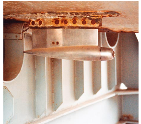
Das Staurohr zur Geschwindigkeitsmessung am Bootsboden des Originals
