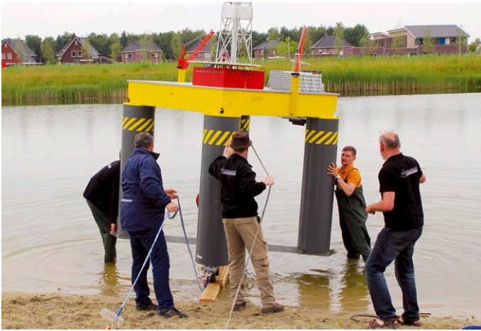
Das im Maßstab 1:50 gebaute Semi-Submersible Rig PETROBRAS XXIII wird zu Wasser gebracht
