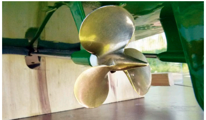
... und am Modell. Blattform, Blattfläche und Blattsteigung wurden hier originalgetreu wie möglich abgebildet
