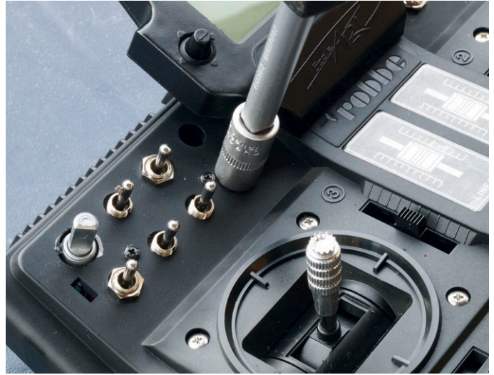
Mit einem Steckschlüssel können die Muttern der Schaltmodule gleichmäßig festgezogen werden
