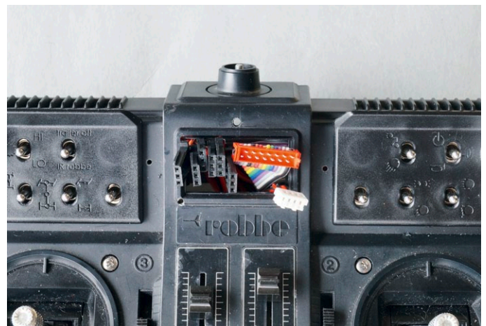
Durch das Montageloch des ehemaligen Voltmeters laufen die Anschlusskabel zum Sendemodul
