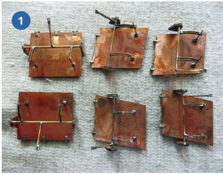
1+2) Ausrüstungsdetails wie die Maschinenraumbelüftungsklappen erfordern eine Menge Zeitaufwand, zeichnen das Arbeitsschiff aber später aus
