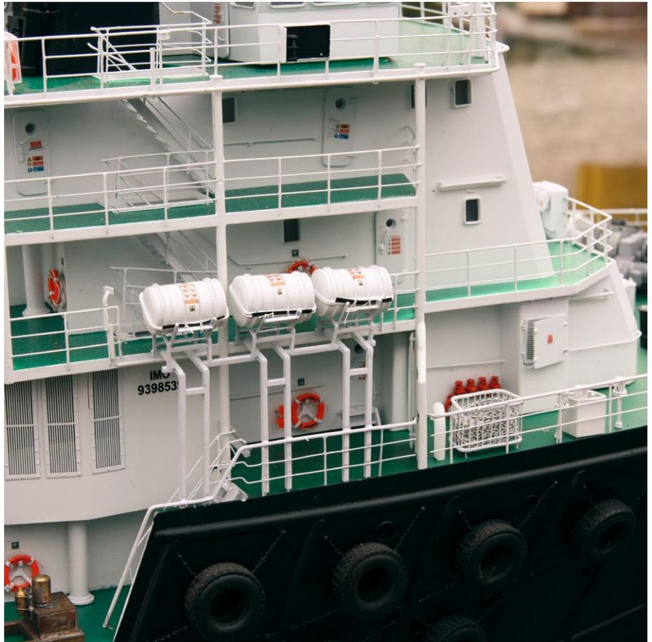
Unzählige schiffstypische Ausrüstungsgegenstände wie Luken, Rettungsinsel und Rettungsringe komplettieren den Decksaufbau
