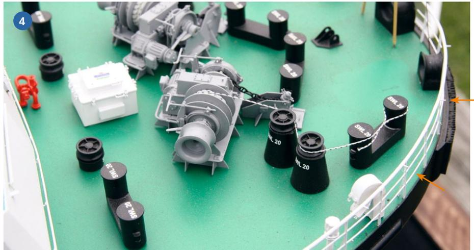
1) Aus in Leisten geschnittenen Birnbaumleisten entstand die Beplankung des Arbeitsdecks. 2) Im 40-Fuß-Container untergebracht ist ein Teil der RC-Technik des Modells. 3) Gegenstände wie Luken, Kästen, Lüfter in allen möglichen Varianten flankieren die Cargorail. 4) Fallen auf dem Backdeck zunächst Ankerwinde, Kettenstopper, Umlenkrollen, Poller und Lukeneinstiege auf, sei besonders auf die im Handlauf der Relling integrierte Selbstschutzanlage hingewiesen
