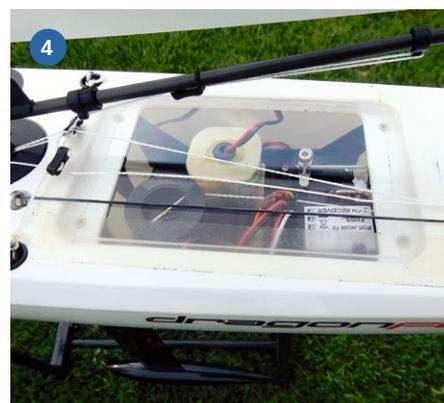
1) Der Inhalt der Kiste ist komplett, es werden nur noch Batterien benötigt. 2) Das profilierte Schwert und der Ballast sind von bester Qualität. 3) Die RC-Komponenten sind alle fertig montiert, nur der Akku muss noch rein. 4) Der durchsichtige Deckel wird wasserdicht abgeklebt
