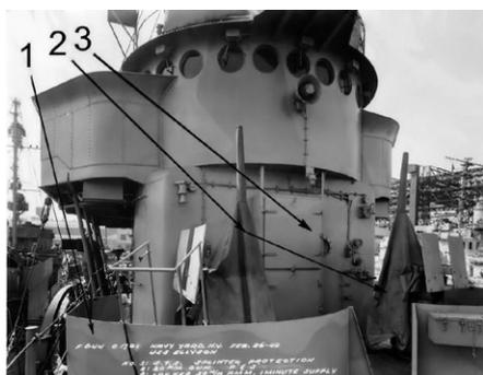
**Abbildung 14: ELLYSON 1942, 1 – Splitterschutzwanne, 2 – 20-mm-Oerlikon, 3 – Munitionsschränke. (US-Navy)**
