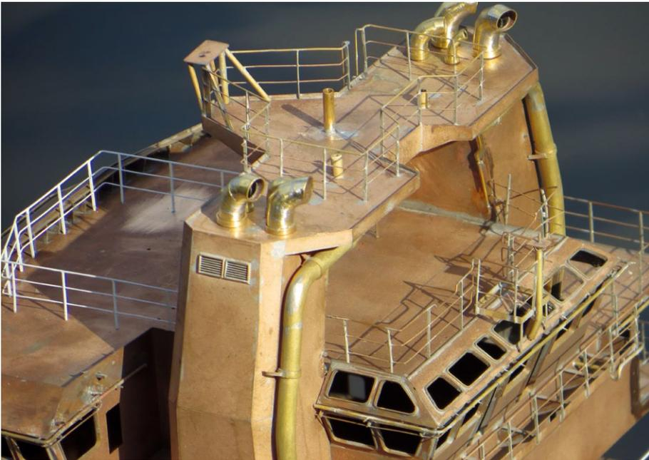
Entsprechend der Kontur der Schornsteine ist der Verlauf der Wasserrohrleitungen für die Löschmonitore zu erstellen
