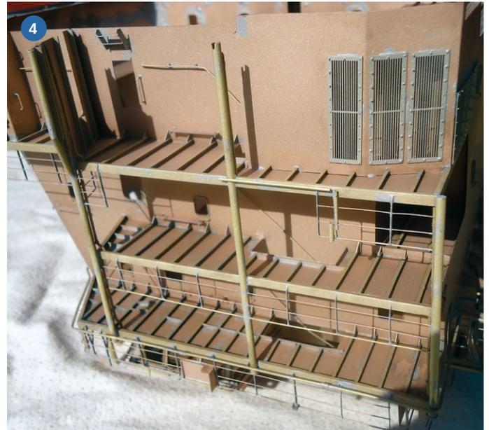
1) Aus 0,3- und 0,4-Millimeter-Bronzeblech entstanden die Aufbauten. Links unten im Bild ist die Baumethode für die Fensterrahmen zu sehen. 2) Weitgehend fertig gestellter Aufbau mit Fensterrahmen, aber noch ohne Details. 3) Vor dem Lackieren ist der Aufbau einmal komplett zu reinigen und von Rückständen, beispielsweise durchs Löten zu befreien. 4) Unter den Decks sind Winkel als Unterzüge gelötet
