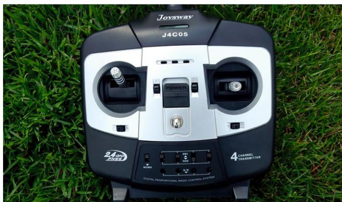
Der 2,4-Gigahertz-Vierkanal-Sender lässt keine Wünsche offen, sogar Dual-Rate ist möglich
