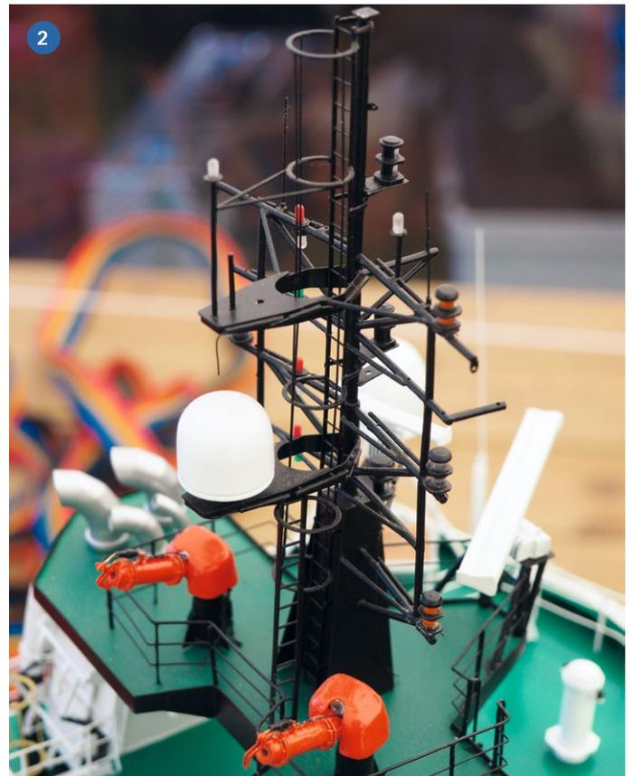
2) Monitore, Radar, Windmesser, Antennen, Leuchten und mehr machen den Mast später komplett
