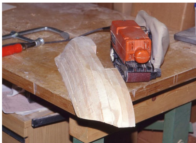
Beim Schleifen ist mit viel Bedacht vorzugehen, um den tatsächlichen Konturenverlauf des Rumpfs herauszuarbeiten. Besonders Bandschleifer neigen dazu, zu viel Material abzutragen
