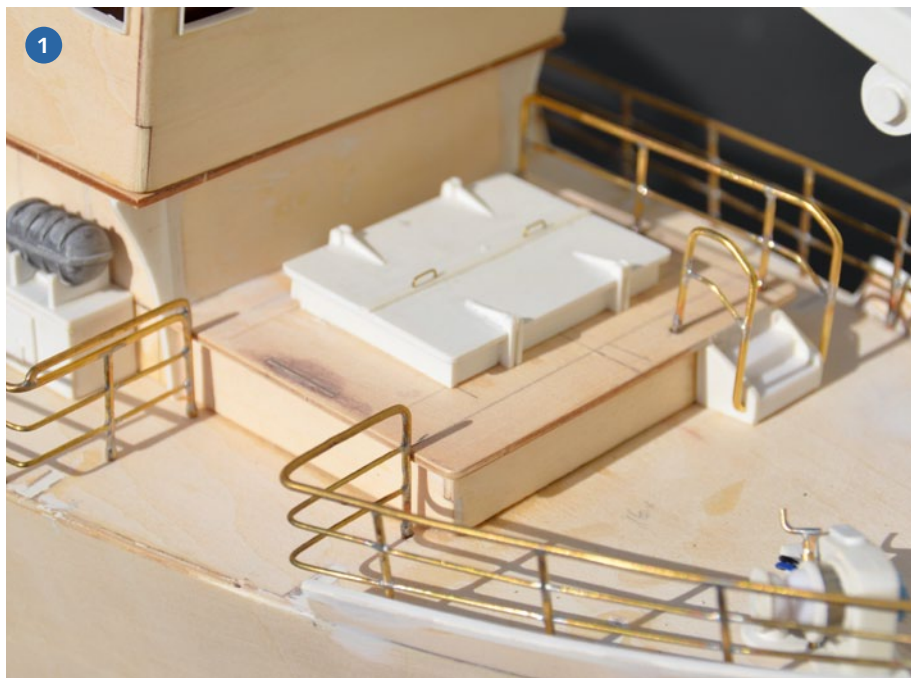
1) Reling und Geländer sind vollständig aus Messingdraht handgefertigt. 2) Die Seitenteile wurden mit Material aufgefüllt, die Fenster wurden vergrößert und erhielten Rahmen, der Abweiser am Dach erhielt Ausschnitte für die Positionslichter. 3) Die Ankerwinde im Rohbau. Die Motoratruppe wurde aus einem einfachen Holzdübel erstellt
