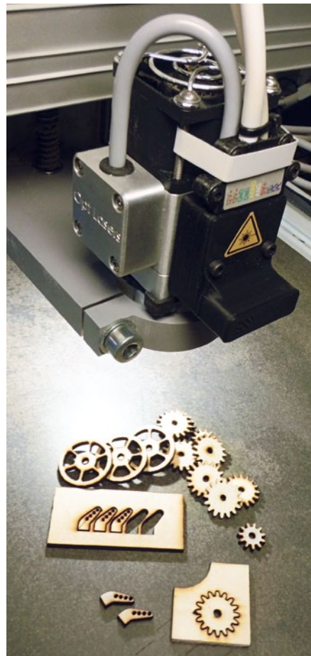
Abbildung 11: Mit Laser-Technik lassen sich nicht nur Zubehör-Teile herstellen, sondern ganze Modellteile-Sätze produzieren
