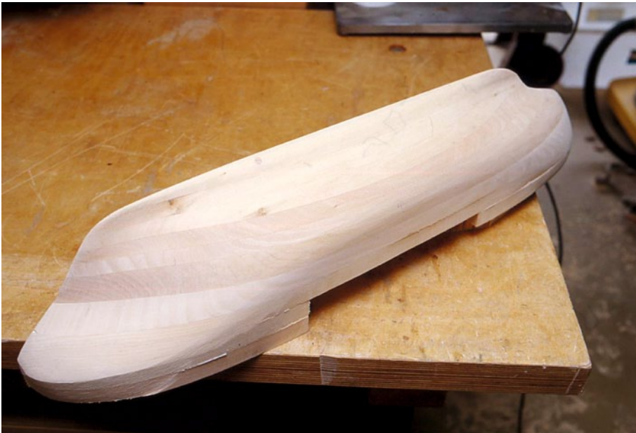
Eine perfekt herausgearbeitete Rumpfhälfte. Diese kann beispielsweise als Positiv zum Abformen eines GFK-Rumpfs genutzt werden
