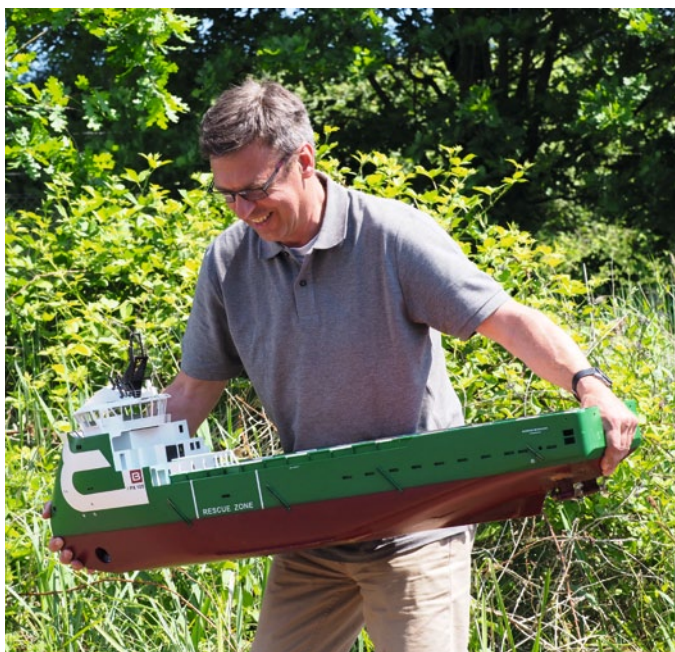
Im Maßstab 1:75 gebaut ist die BORBON MONSOON von Olaf Schulze noch gut ins Wasser einzusetzen. Der Versorger für Bohrhinseln entstand auf einem selbst gebauten GFK-Rumpf und die Aufbauten sind aus Phosphor-Bronzeblech
