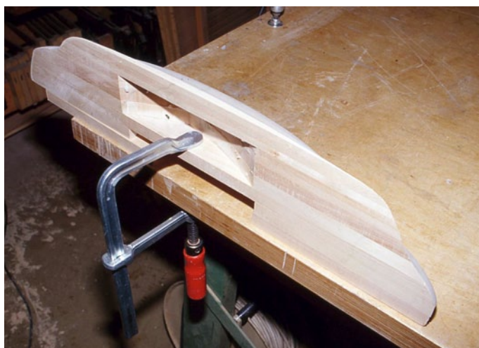
Baut man mit zwei Rumpfhälften, was ein sehr exaktes Bauen voraussetzt, dann ist zumindest das Befestigen des Rumpfs einfach
