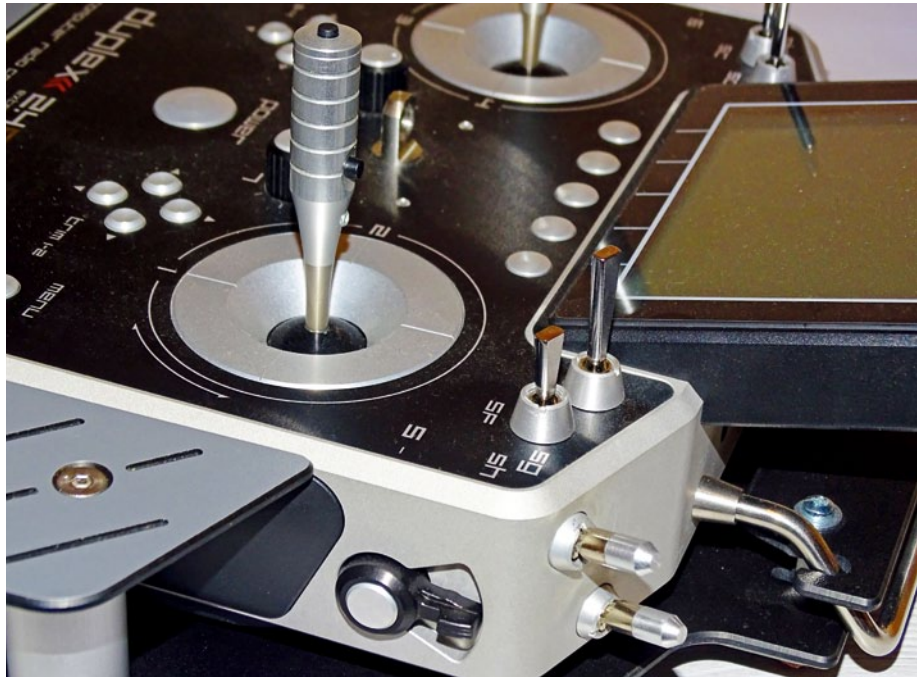
Die ausgebaute rechte Seite: Links der Knüppel mit den beiden Tasten, in der Mitte die beiden Dreiweg-Schalter, rechts unten die beiden Sicherheits-Schalter
