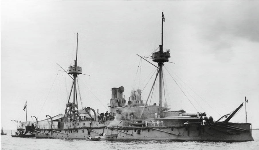
Abbildung 3: Ein Schiff der TERRIBLE-Klasse, von Beginn an keine Segeltakelage, dafür zwei Dreibein-Masten mit Gefechtsmarsen. Die langen Gaffeln mit Gaffelgeeren deute ich als Möglichkeit für eine Notbesegelung. Die Kamine stehen nebeneinander. Der hintere Teil des Schiffs ist mit Sonnensegeln bedeckt
