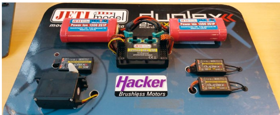
An der Central Box 200 können 15 Kanäle verwaltet werden. Hier gut zu sehen das Prinzip der Doppelstromversorgung und der Empfang über zwei Satelliten-Empfänger
