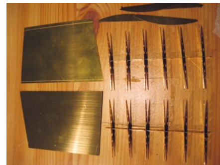
Wesentlich für das Landungsboot sind die Bugtore und Rampen zum Anlanden. Hier legte Deansmarine entsprechende Messingbeschläge dem Bausatz bei, die zu montieren sind
