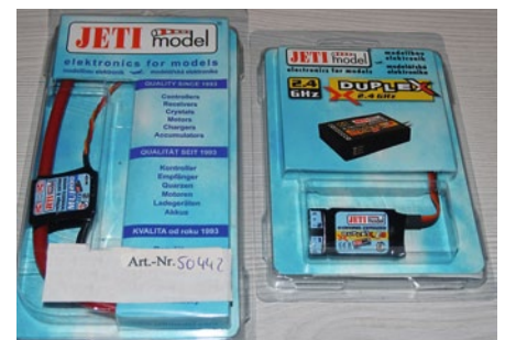
Der Jeti-Expander E4 (rechts auf dem Bild) erweitert die Anschlussmöglichkeiten um vier Sensoren – links ein Stromsensor
