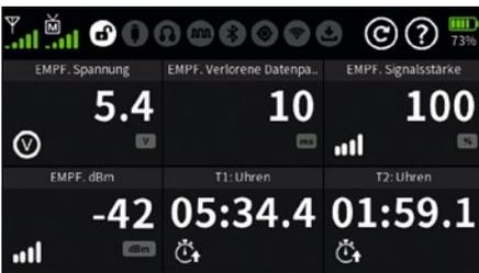
So werden Parameter des Empfängers sowie die Fahr- und die verbleibende Motorlaufzeit angezeigt
