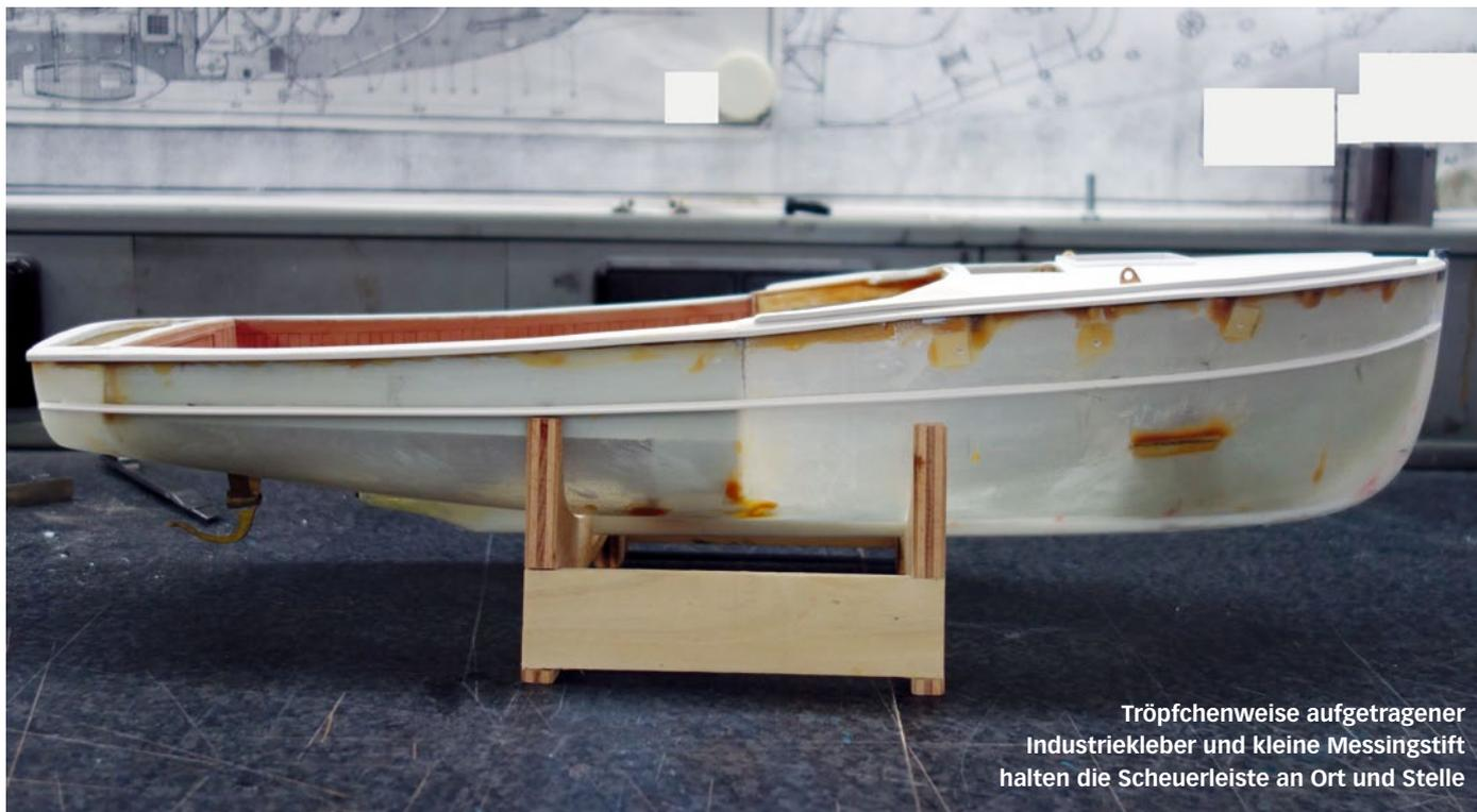
Tröpfchenweise aufgetragener Industriekleber und kleine Messingstifte halten die Scheuerleiste an Ort und Stelle
