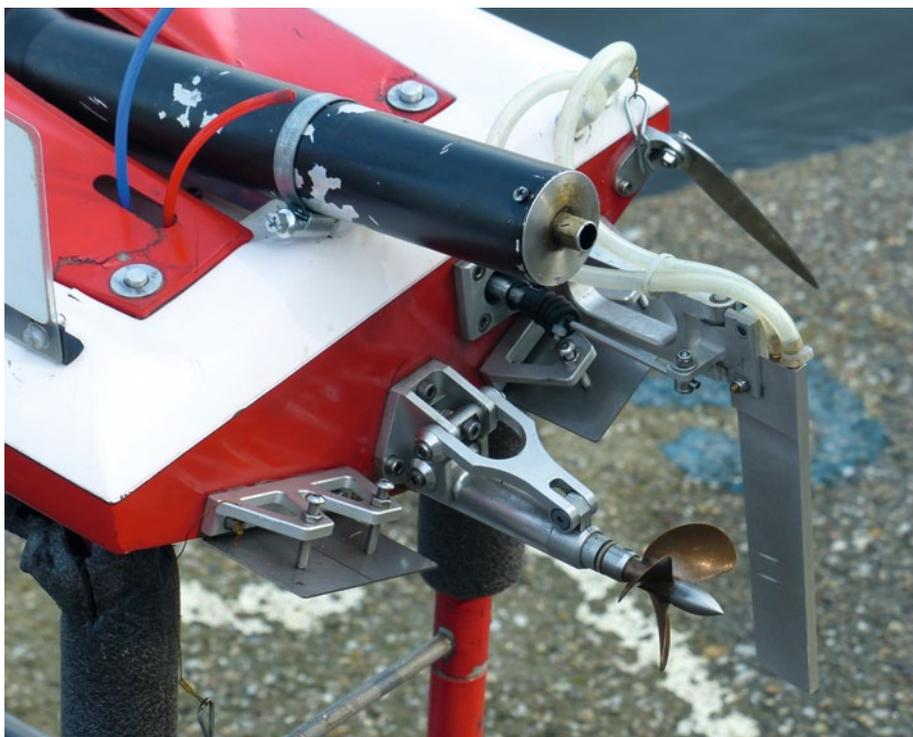
Heck eines Offshore-Boots mit Dreiblatt-Prop und manuell verstellbarer Trimmung
