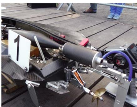
27-cm<sup>3</sup>-Offshore-Boot von Patrick Zscheckel. Der Motor ist ein modifizierter Tiger King, um den Heckauslass zu erreichen. Ein spezieller Nachschalldämpfer auf dem Resonanzrohr soll für den „guten Ton“ sorgen
