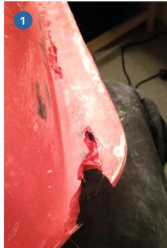
**1) Beim Laminieren entstanden riesige Luftblasen, die sich sofort offenbarten. Wer noch wenig Erfahrung mit dem Formenbau hat, dem passieren solche Fehler eben. 2) Zahlreiche Löcher und Lunker waren zu schließen, aber keine, die die Dichtigkeit berührt hätten, sondern optische. 3) Ein aufgeleimter Unterzug aus Holzleisten stabilisiert die Deckauflage und gibt Klebefläche**
