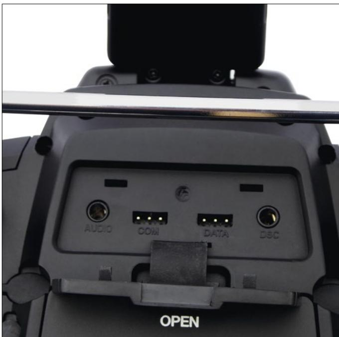
**Unter einer Abdeckkappe befinden sich Kopfhöreranschluss, COM Schnittstelle, Data- und DSC-Buchse**
