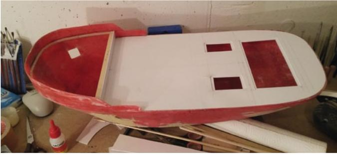
Erst nachdem die spätere Position der Antriebe und damit der nötigen Wartungsluken feststand, wurden diese aus dem ABS geschnitten
