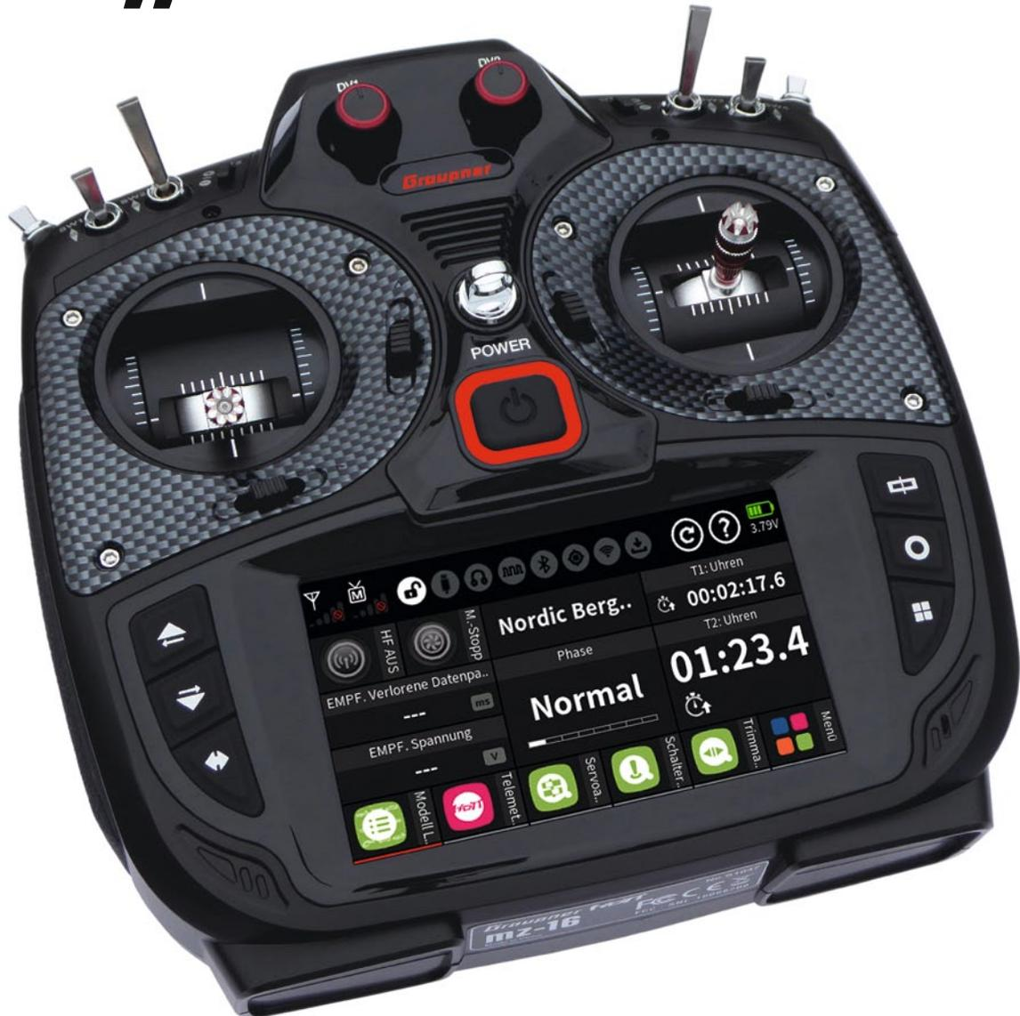
Handsender stehen in dem Ruf, primär nur für Modellflieger und damit nicht für Schiffsmodellbauer geeignet zu sein. Bei der neuen mz-16 von Graupner sieht das anders aus. Sie verfügt explizit über eine Benutzeroberfläche für RC-Schiffe. Karl-Heinz Keufner stellt die ungeahnten Möglichkeiten des HoTT-Senders vor.
