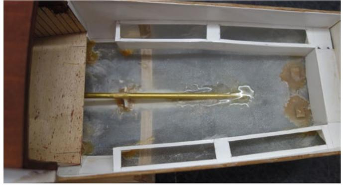
Das Stevenrohr verläuft äußerst flach, sodass darüber knapp die Pflicht-Bodenplatte zu liegen kommt
