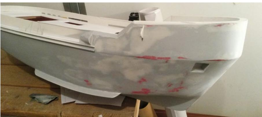
Die Rundfender liegen später auf der planen Bugschanz auf, aber dafür sind die Kästen zur Aufnahme der Verspannung einzuarbeiten
