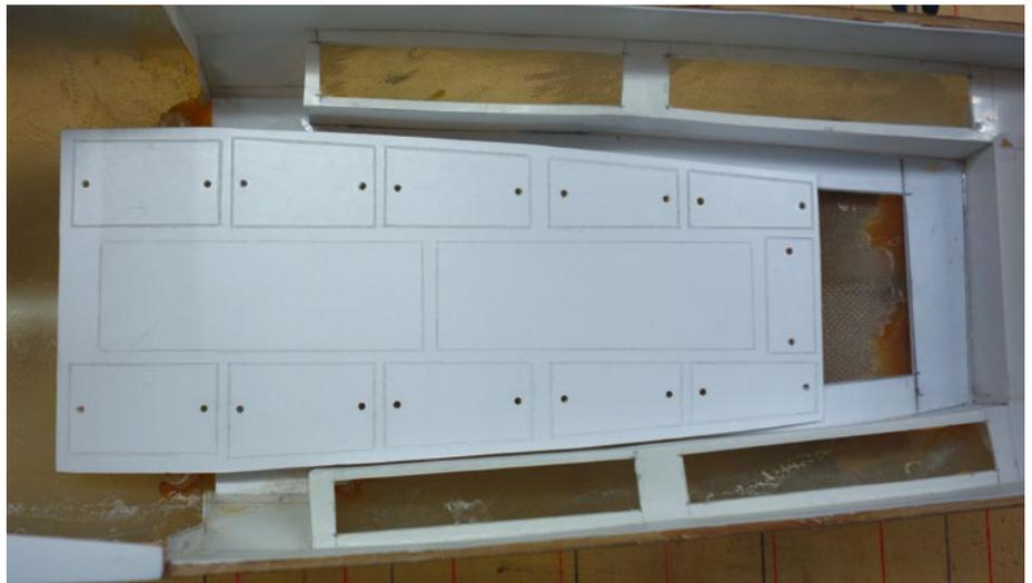
Einpassen des Bodens, der von vorne eingeschoben wird und stramm sitzt
