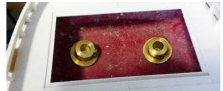
Stabile Messing-Koker arretieren den ASD-Antrieb und dienen zugleich als Wellenrohr für Anlenkung und Antriebswelle
