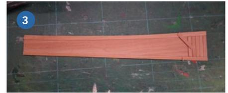
1) Aus Furnierholz entstand die gesamte Holzeinkleidung, und zwar individuell eingepasst wie ein Maßanzug. 2) Um die Schiebetüren realistisch zu gestalten, sind sie auch herausgearbeitet. 3) Nach Maß gefertigt ist auch die Rückenlehne. Aus einem Stück gebaut wäre es schneller gegangen, hätte aber nicht realistisch ausgesehen
