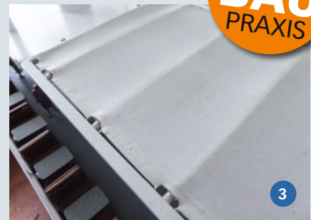
1) Ein besonderes Merkmal des Salondampfers UTTING ist das mit Stoff bespannte Oberdach. Die Basiskonstruktion besteht aus Messing-Komponenten, für die zunächst eine Montage-Vorrichtung gebaut wurde. 2) Zahlreiche Messingprofile und Knotenbleche bilden das Grundgerüst. In den Trägern sind später Leitungen für die Lichtkabel eingelassen. 3) Natürlich hat auch das Modell eine Stoffbespannung erhalten
