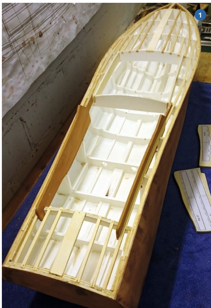
1) Bei dieser Ansicht sieht man das in Weiß gestrichene Innere und die Deckstringer. Gut zu sehen sind auch die Aussparungen für Luke und Cockpit. 2) Zieht man die Pins nach Aushärten des Ponal-Klebers heraus, lassen sich die entstandenen Löcher mit etwas Wasser behandeln und so gezielt zum Aufquellen bringen. 3) Der fertig mit Sperrholz beplankte Rumpf vor dem Schleifen
