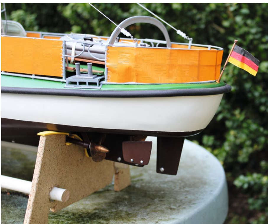
Die Relingstützen sind aus Kunststoff-Rundstäben gefertigt und die Durchzüge aus 1,5-Millimeter-Messingdraht. Für die Relingstützen wurde eine Konstruktionshilfe angefertigt, indem in ein etwas dickeres Messingröhrchen zwei Löcher im Abstand der Durchzüge gebohrt wurden. Nun konnten die etwas dünneren Kunststoffrohre in das Messingröhrchen geschoben werden – die mittels Akkuschauber gebohrten Löcher für die Durchzüge sitzen auf diese Weise immer an der richtigen Stelle. Die Herstellung der Reling selbst war dann relativ simpel, zumal sich auch hier am Bauplan der HEUSS orientiert wurde. Bei dem hinteren Trossenabweiser und Schutzbügel handelt es sich ebenfalls um ein leicht gekürztes Bauteil aus dem Baukasten
