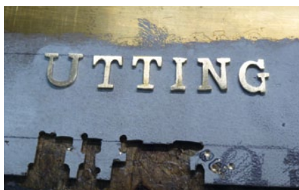
Vorbildgetreue Lettern kann man nicht kaufen, das muss man selber machen, also Messing von Hand aussägen und fein schleifen
