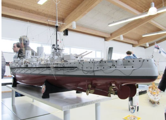
Unteransicht des Schiffs von Backbord achtern. So sehr gut zu erkennen: zwei der vier Schiffsschrauben und die Doppelruderanlage
