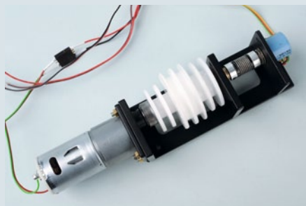
Die montierte Segelwinde mit Stirnzahnrad-Getriebe. Die Wickeltrommel ist für drei Schotleinen ausgelegt
