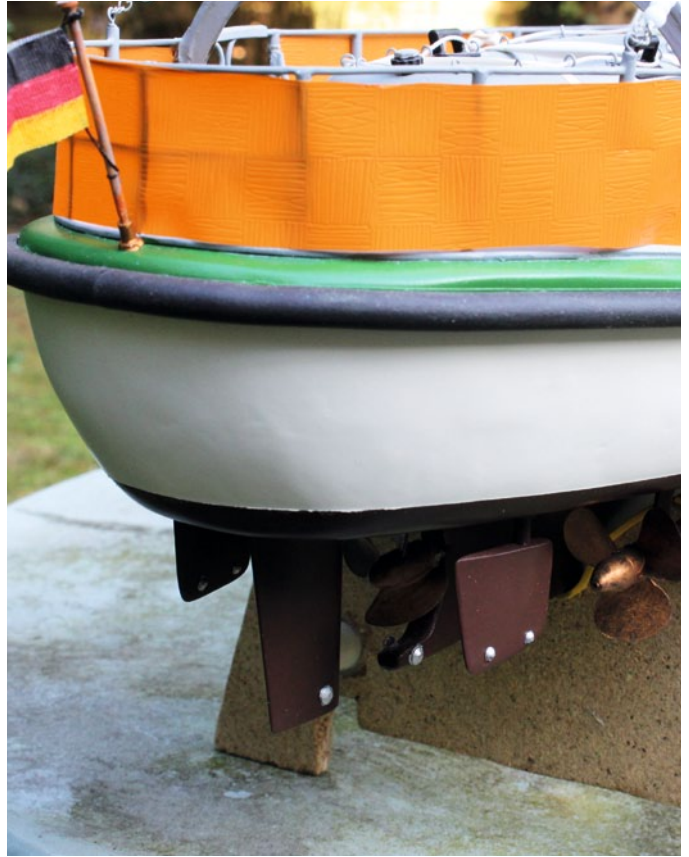
Angetrieben wird die HERMANN APELT mit zwei Graupner Speed BB Turbo-12-Volt-Motoren, die auf die beiden äußeren Wellen gekuppelt sind
