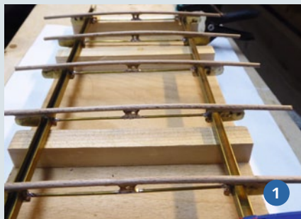
1) Ein besonderes Merkmal des Salondampfers UTTING ist das mit Stoff bespannte Oberdach. Die Basiskonstruktion besteht aus Messing-Komponenten, für die zunächst eine Montage-Vorrichtung gebaut wurde. 2) Zahlreiche Messingprofile und Knotenbleche bilden das Grundgerüst. In den Trägern sind später Leitungen für die Lichtkabel eingelassen. 3) Natürlich hat auch das Modell eine Stoffbespannung erhalten
