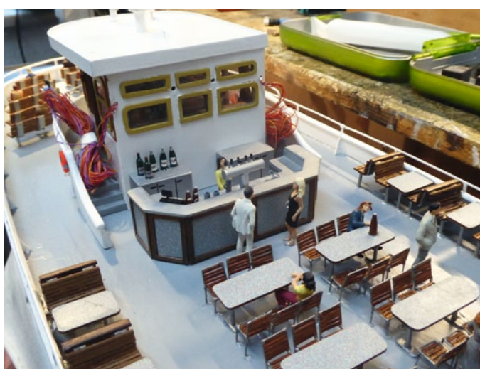
Ist erst einmal das Dach drauf, ist diese Perspektive nicht mehr möglich – hier zu erkennen sind die vorbereiteten Zuleitungen für Leuchten unter dem Stoffdach
