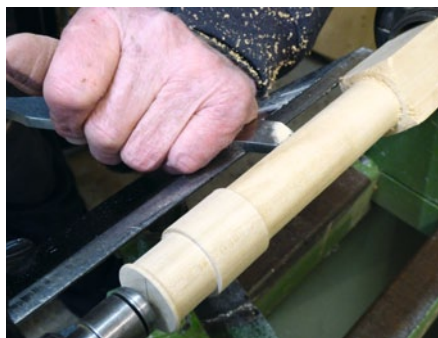
Mit Hilfe einer Drechselmaschine entstand aus einem Vierkant der runde Schornstein einschließlich Ausformungen
