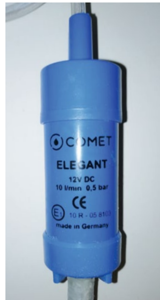
Diese Tauchpumpe aus dem Camping-zubehör sorgt für die erforderliche Durchflussmenge
