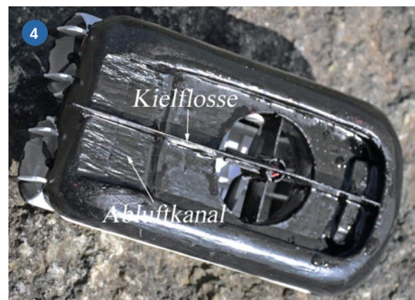
1) Einbau der Reely-Komponenten in das LCAC-Rohmodell; die Luftschaubenmotoren befinden sich in den Kartonröhren. 2) Rohmodell von oben: Der Elektronikraum ist abgedeckt. Man erkennt den Antennenstummel. 3) Modell der LCAC-101 von backbord hinten. Aus dünnem Material lassen sich auch filigrane Antriebskomponenten bauen. 4) Blick in den bereits modifizierten Luftkissenraum, also mit Kiel und mehr Platz fürs Luftpolster
