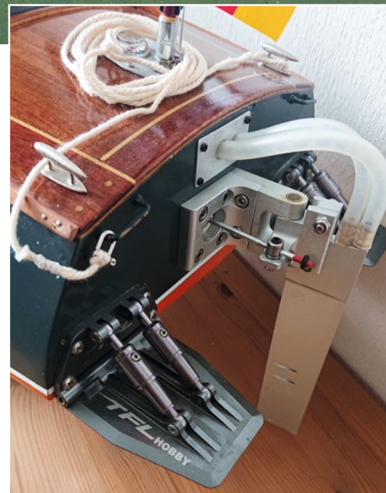
Heckansicht mit montierten Trimmklappen und Ruder. Ein Kühlschlauch geht zum Motor, der andere zum Drehzahlsteller
