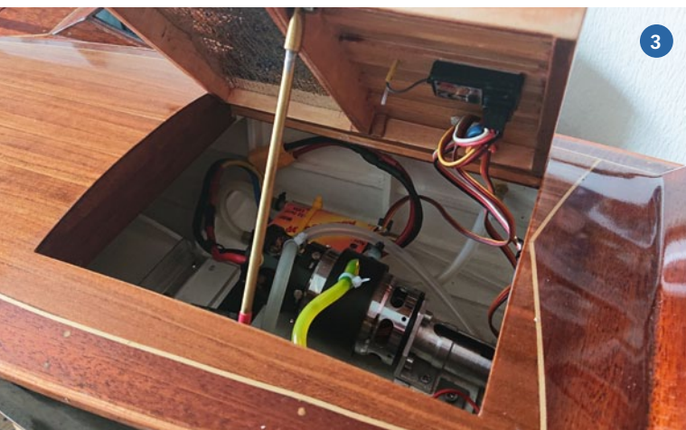
1) Seitenansicht des Boots mit fertiggestellten Holzarbeiten auf dem Deck. 2) Das Deck mit der Luke ist fertig und alles bereits lackiert. Erkennbar sind auch das bereits platzierte Armaturenbrett und der Cockpitboden. 3) Der Blick ins Innere zeigt den Plettenberg-Bürstenmotor. Dahinter liegt der Drehzahlsteller und im Deckel ist der Empfänger untergebracht. 4) Das Cockpit mit seinen mit Leder bezogenen Sitzen, dem Armaturenbrett und weiteren Details
