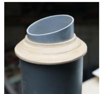
Aus Holz gedreht ist der Übergang zwischen äußerem und innerem Kaminrohr
