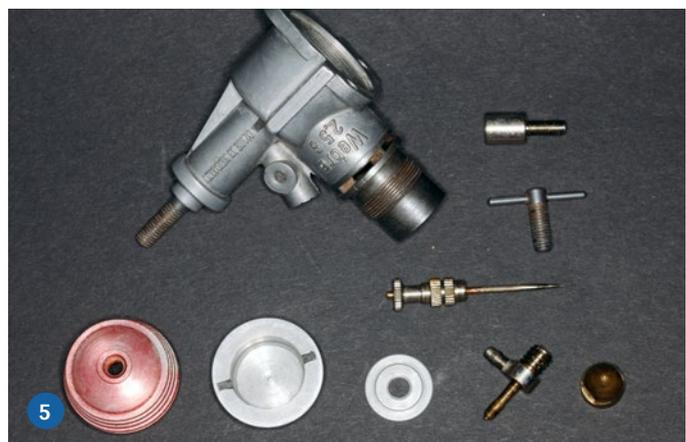
4) Anschließend wird er gut 30 Minuten in Meister Proper (1:1 mit Wasser verdünnt) versenkt – dann lässt er sich mühelos reinigen. 5) Gereinigte und konservierte Teile eines Motors, die bereit zur Montage und der erneuten Betriebsaufnahme sind
