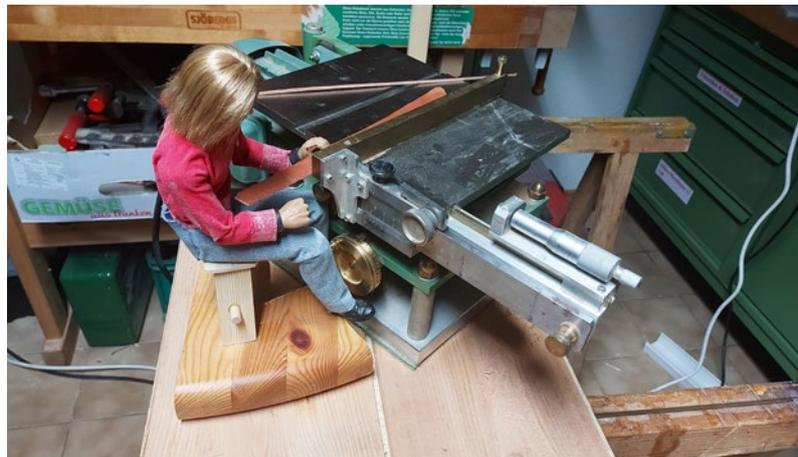
Die sichtbaren Spanten für das Cockpit werden auf einer Präzisionsäge gefertigt
