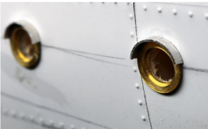
Die Blenden der Bullaugen entstanden erneut aus einem Rundrohring, der jedoch gehälftet wurde
