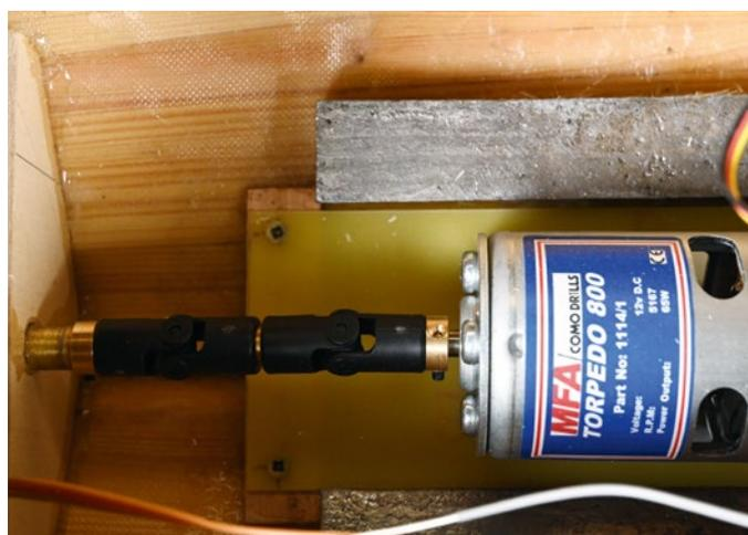
Motoreinbau mit Ballaststücken
