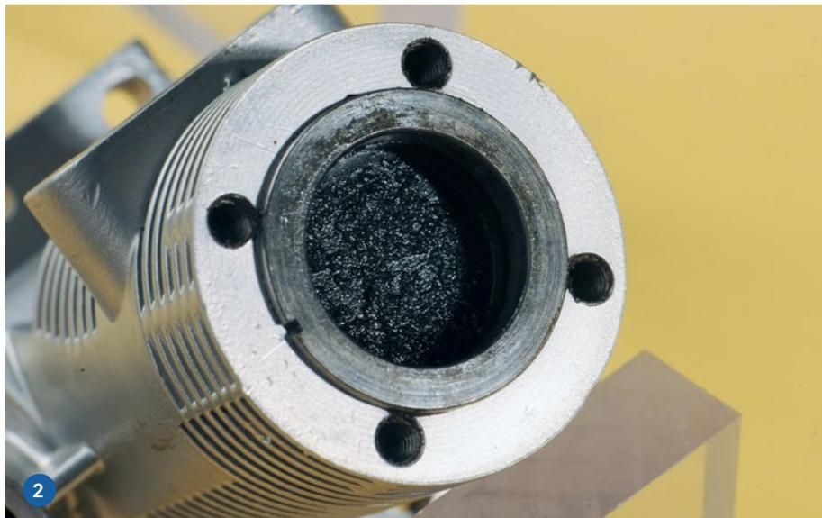
1) Ergebnis der Reinigung aus Vapor-Blasting und Reinigern an Zylinderkopf mit eingesetzter Glühkerze. 2) Vor dem Einweichen beziehungsweise Reinigen ist erkennbar, dass der Kolben dick mit schwarzer Ölkohle verkrustet ist
