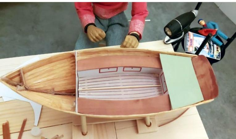
Bauteile aus einlaminiertem Papier werden angepasst
