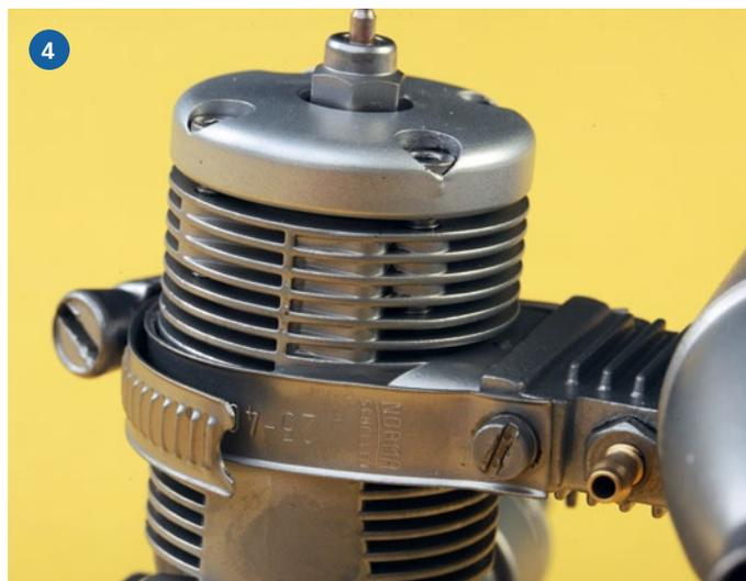
**1+2) Der Vorher-Nachher-Vergleich macht deutlich, wo sich die Verschmutzungen vor dem Reinigungsprozedere auf dem Schalldämpfer befanden. 3+4) Die Kühlrippen des Zylinders waren total verharzt und zugesetzt. Das ließ sich konventionell nicht mehr reinigen**
