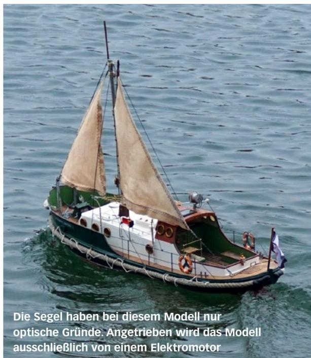
Die Segel haben bei diesem Modell nur optische Gründe. Angetrieben wird das Modell ausschließlich von einem Elektromotor
