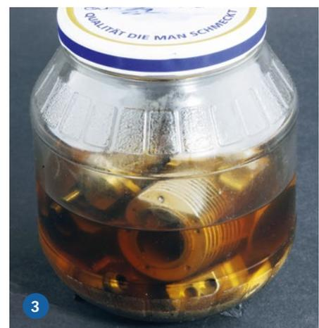
1) Mit dem Harzreiniger lassen sich bereits kleine Wunder wirken. 2) Während Cilit Bang im Drogerie-Markt erhältlich ist, bekommt man Sonax-Produkte zumeist in Baumärkten oder Autoteile-Zubehör. Bei synthetischen Ölrückständen sind sie ideal. 3) Den Deckelaufdruck nicht wörtlich nehmen! Zum Anlösen von Rizinus-Ölresten wird der Motor eine Woche in Nitroverdünnung gebadet
