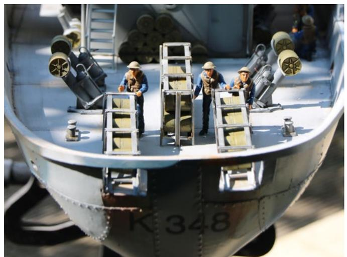
Durch die Schanzöffnungen können in den Abrollvorrichtungen die Wasserbomben abgelassen werden
