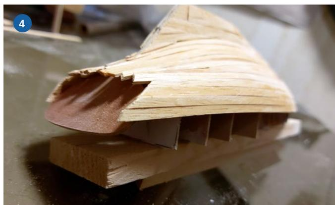
Dann ging es ans Aussägen der Teile. Alle Spanten wurden in der Mitte mit einer Japansäge „geschlitzt“ und auch die Mittelsektion bekam einen Schlitz für jeden Spant. So konnte schon mal alles grob zu einem Gerippe zusammengesteckt werden. Natürlich haben wir auch an eine Verlängerung der Spanten gedacht, sodass das gesamte Gerippe korrekt zueinander ausgerichtet auf ein gerades Stück Dachlatte geklebt werden konnte – das war die Helling.
