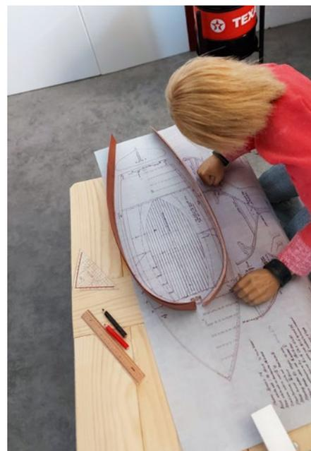
Der Süllrand wird auf dem Plan angepasst
