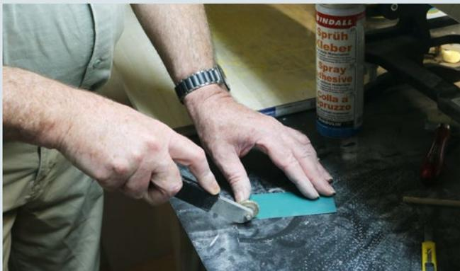
Herstellen lassen sich die Platten als Massenware, indem man diese mit einem Rändelrädchen – aus dem Nähbedarf – „nietet“
