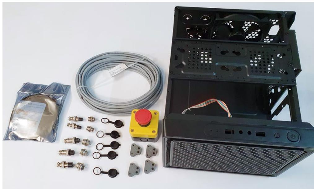
Zur Unterbringung der Steuerung dient ein kleineres PC-Gehäuse (rechts im Bild). Die noch anzufertigenden Kabelstränge (graues Kabel) werden mittels Kabelschlauch (links im Bild) gebündelt. Die gedruckten Bauteile (grau) dienen der Befestigung der Motortreiber in dem Gehäuse
