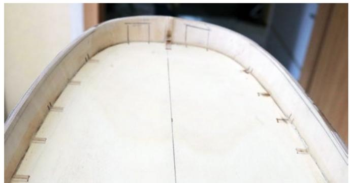
Die überstehenden Stützspanten sind abschließend entfernt worden
