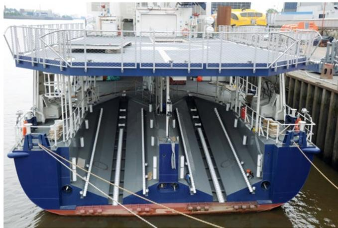
Die Heckwannen für die Speedboote – die Klappen sind demontiert
