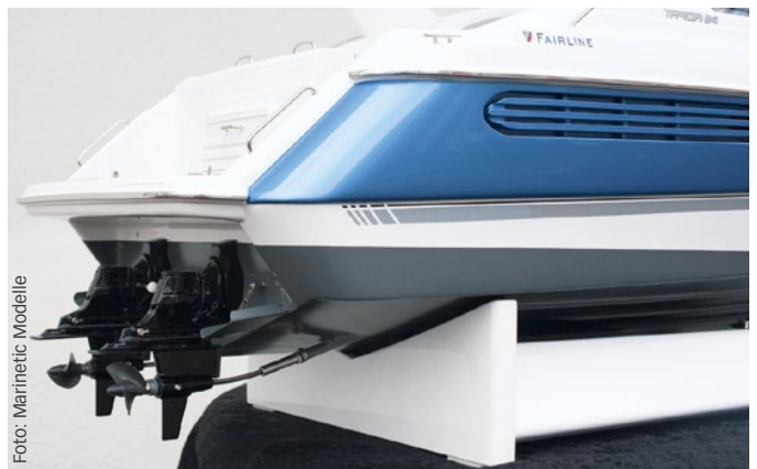
Die selbst entwickelten Pseudo Z-Drives am Heck eines Kundenmodells von Timo Stracke
