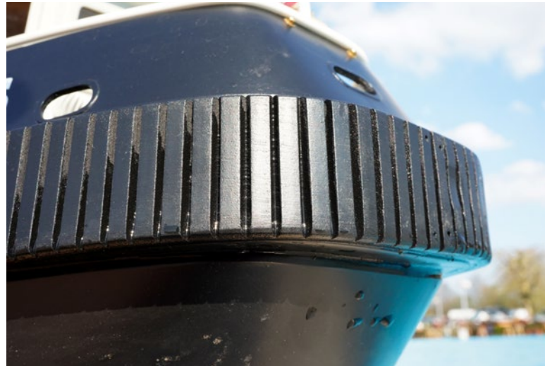
Die Schanzfender sind aus PVC-Hartschaum selbst ausgeschnitten und angeklebt
