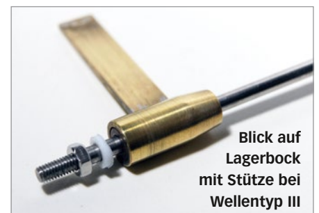
Blick auf das Lager mit Kugellager und Ölrohr bei Wellentyp III
