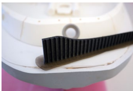
Bereits farblich eingefärbte und flexible Scheuerleiste für einen Schlepper frisch aus dem 3D-Drucker
