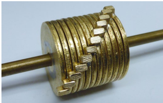
Am Modell müssen Schotlängen von fast einem Meter knotenfrei bewegt werden. Umgesetzt wurde das im ersten Anlauf am Modell über ein Scheibensystem
