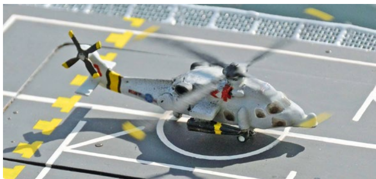
Die Rotorblätter der MH-60 Seahawk werden über einen kleinen E-Motor gedreht
