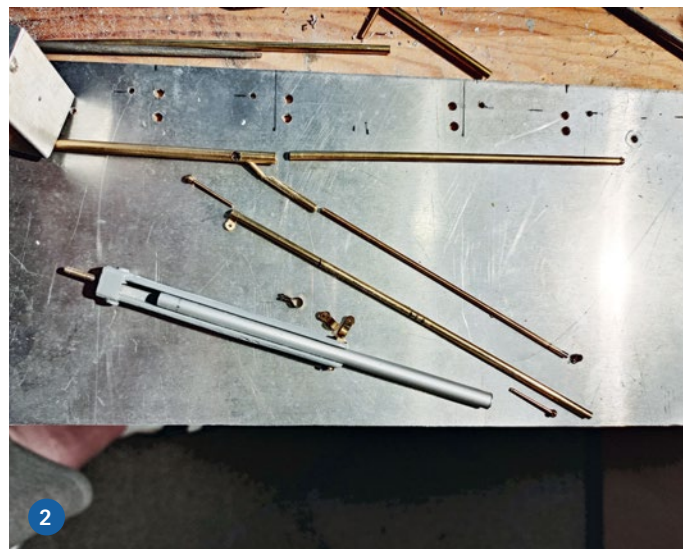
1) Mithilfe von Rohrresten und Alu-Profilen entstand das Grundgerüst der Gangway. 2) Befestigt im Fuß ist das 8-mm-Messing-Grundrohr des Fahnenmastes mit zwei verbundenen M1.2-Schrauben, das ermöglicht einen schnellen Auf- und Abbau
