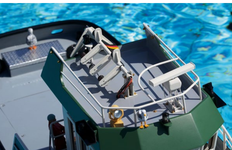
Der Mast mit funktionsfähiger Beleuchtung lässt sich ferngesteuert umlegen
