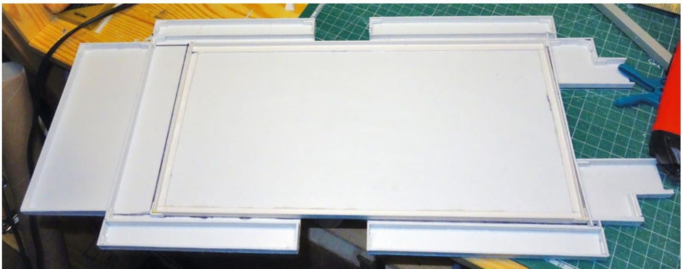
Auf den Sülrand wurde ein Rahmen aus Winkelprofil gelegt und zusammengeklebt. Darauf kam eine 1,5-mm-Polystyrol-Platte
