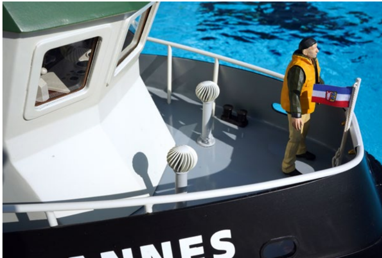
Elektromotoren versetzen die Kugellamellen-Lüfter in Rotation
