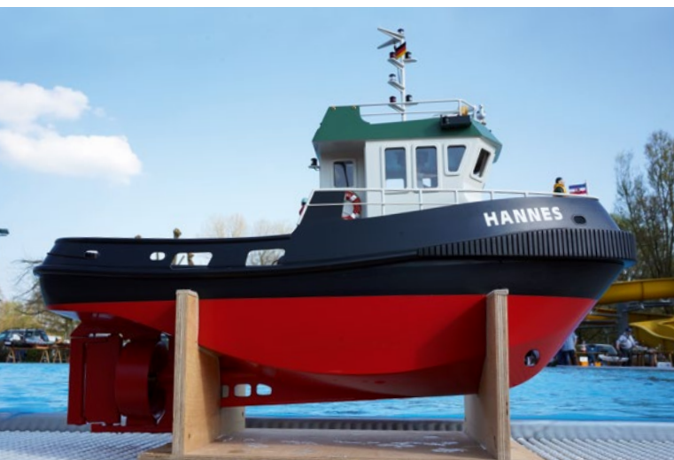
Als moderner Festmacher ist der Rumpf in Knickpantbauweise umgesetzt
