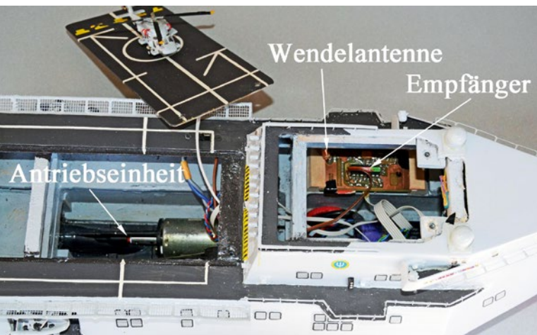
Blick ins Modellinnere: Zur Stromzufuhr sind zwei IC-Sockelstifte ins Deck eingelassen, die auch das Helimodell dort fixieren
