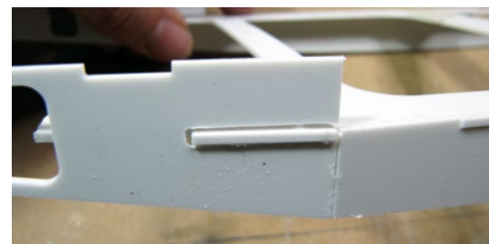
Das bewährte System von Nut und Feder versagt bei diesem Modell
