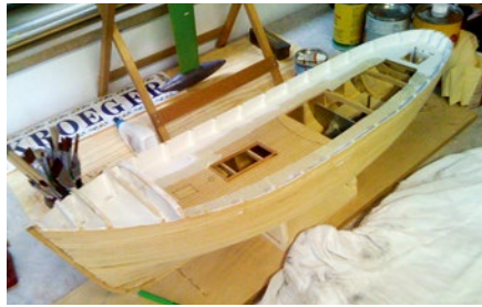
Nach 17 Jahren ist das Spantengerüst endlich gerichtet und beplankt
