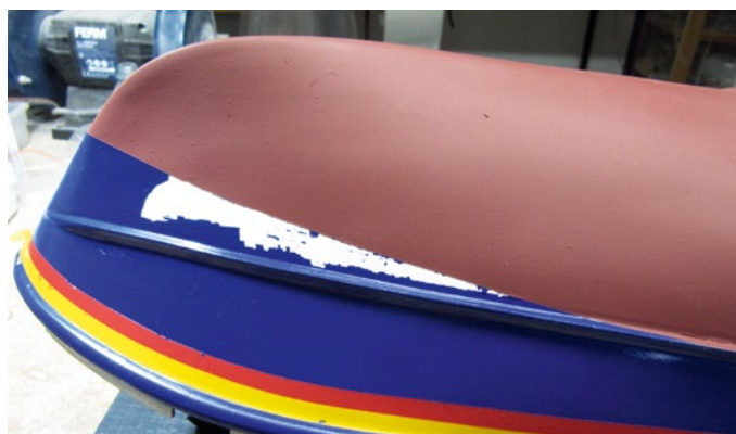
Mangels Haftung löste sich der Lack beim Abziehen der Klebestreifen mit ab
