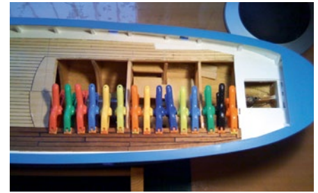
Das ursprünglich bedruckte Deck wird ebenfalls mit Holzleisten neu beplankt
