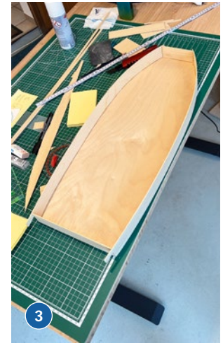
1) Von unten ist das Gegenlager für das Ruder mit drei Schrauben montiert. 2) Das Außendeck ist grob ausgeschnitten, mit Abachi neu beplankt und muss trocknen. 3) Die Wände des Innendecks sind ebenfalls aus Abachi gefertigt
