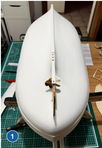
1) Von unten ist das Gegenlager für das Ruder mit drei Schrauben montiert. 2) Das Außendeck ist grob ausgeschnitten, mit Abachi neu beplankt und muss trocknen. 3) Die Wände des Innendecks sind ebenfalls aus Abachi gefertigt
