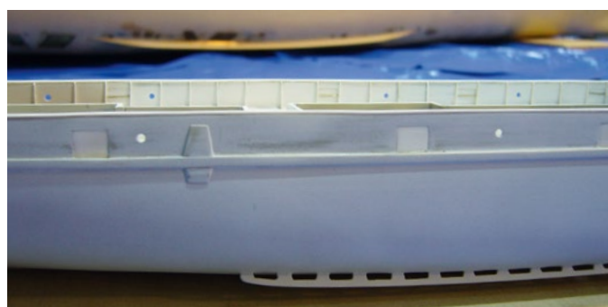
Die Schanzkleidstützen wurden ebenfalls aus Polystyrol neu gemacht
