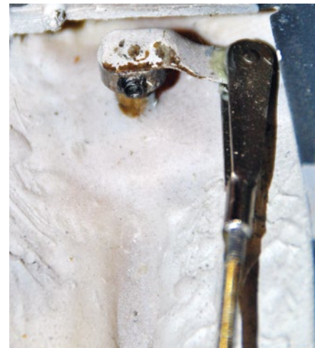
An den Ruderschaft ist zur Ansteuerung ein Stelling mit Hebel angelötet
