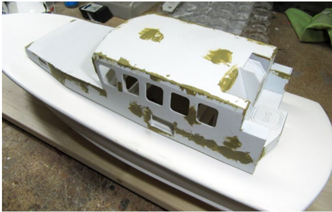
Zur Fertigstellung des Aufbaus sind größere Mengen an Spachtel nötig
