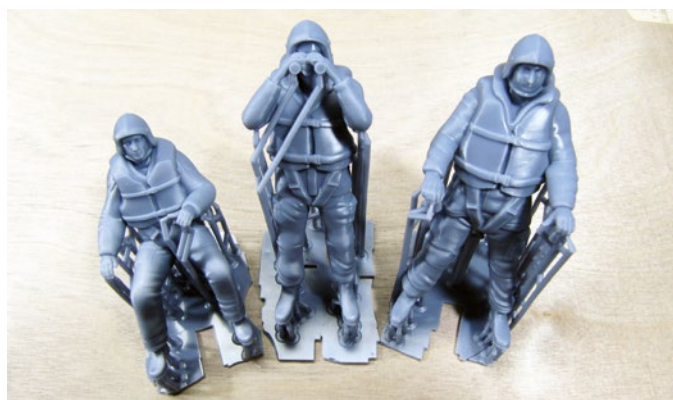
Die Besatzung ist im SLA-Druck hergestellt, wo das Stützgerippe noch abgelöst werden muss
