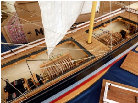
Die Windenmechanik bei der fast fertigen NÜRNBERG besteht komplett aus Holz
