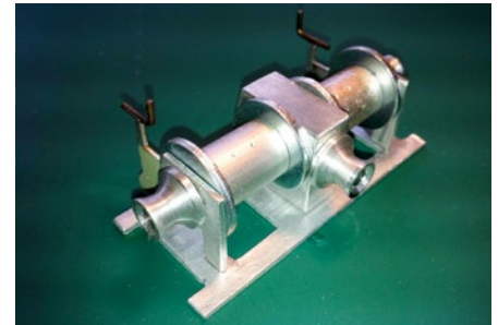
Die Holzteile der Schleppnetzwinde dienen als Vorlage für die Teile aus Blech
