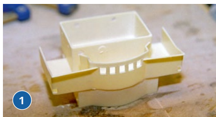
1) Bei der alten Brücke passten Ober- und Unterteil nicht zusammen. 2) Das neue Brückenhaus entstand aus Platinenmaterial und dünnen Kupferblechen. 3) Nachdem die Fenster ausgesägt waren, konnte die vorgegebene Front angelötet werden
