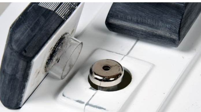
Das vordere Klimagerät auf dem Aufbau hat einen eingeklebten Magnet als Gegenstück
