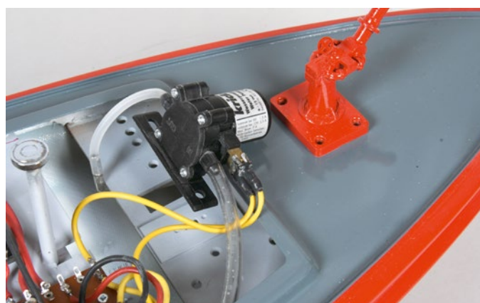
Die Löschpumpe hängt normalerweise unter dem Sperrholzbrettchen mit Empfänger und Servo
