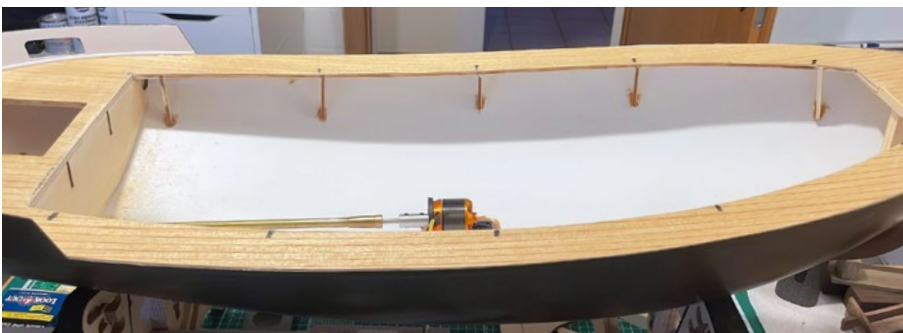
Das Außendeck ist angepasst und mit Stützen in den Rumpf eingeklebt
