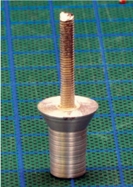
Für den Mastkorb wurde zuerst ein Aluminium-Drehteil gefertigt
