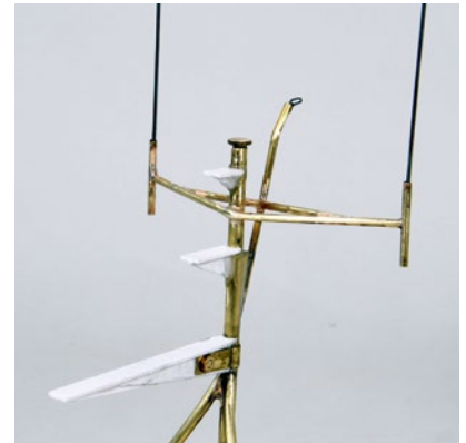
Der Mast wiederum ist aus Messing und kann weichgelötet werden
