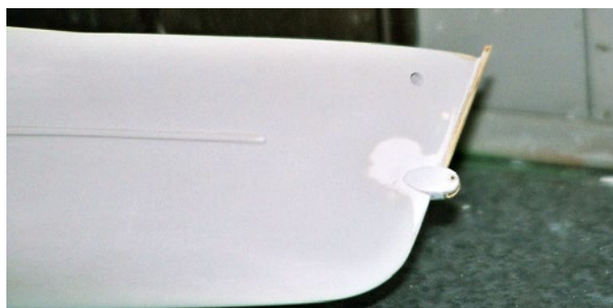
Die Aufnahme für das Bugspier ist angebracht, darüber ein Messingprofil als Verstärkung
