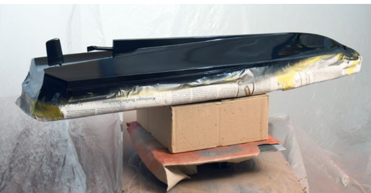
Abschließend bekommt das Unterwasserschiff seinen schwarzen Anstrich
