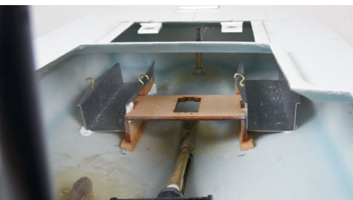
Ganz hinten im Boot sind zwei Halterungen für die Akkus vorgesehen
