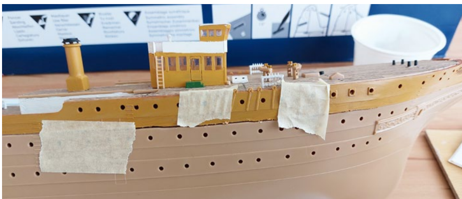
Zum Einkleben des Decks werden die oberen Rumpfhälften provisorisch angebracht
