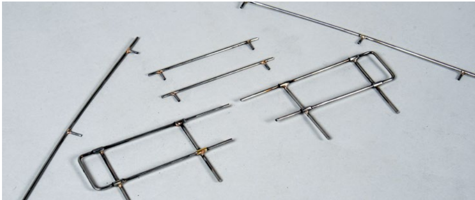
Die Reling besteht aus VA-Stahl und muss hartgelötet werden
