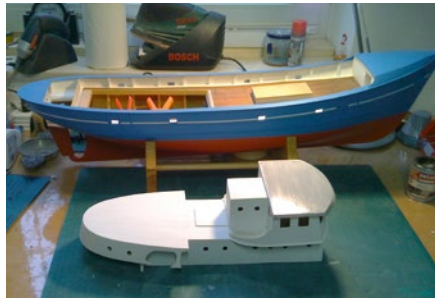
Der Aufbau aus Sperrholz muss trotz Porenfüller sorgfältig geschliffen werden
