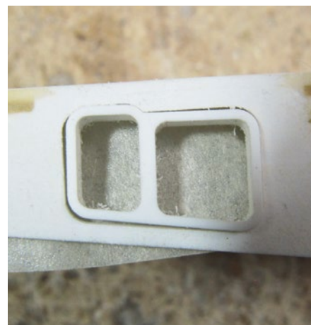
Kleine Fehlerrückmeldung: Die Ausfräsungen für Geräteeinbauten sind zu groß
