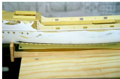
In den Rumpf wurde an jeder Seite ein Schlitz gefräst. Auf zwei passenden GFK-Platten wurde die Position der Durchbrüche angezeichnet, aufgebohrt und ausgefeilt. Dann wurden die Schlingerkiele in Form gebracht und eingebaut
