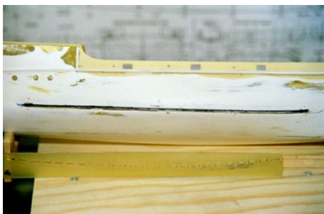
In den Rumpf wurde an jeder Seite ein Schlitz gefräst. Auf zwei passenden GFK-Platten wurde die Position der Durchbrüche angezeichnet, aufgebohrt und ausgefeilt. Dann wurden die Schlingerkiele in Form gebracht und eingebaut
