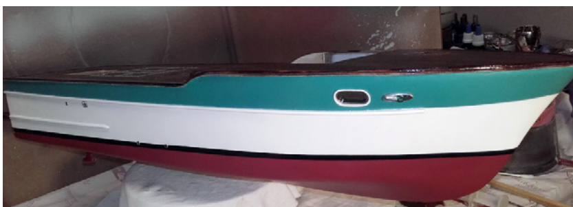
Nachdem der Rumpf lackiert war, konnten die verchromten Details montiert werden
