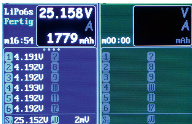
Der 6s-Akku ist voll aufgeladen und gut balanciert
