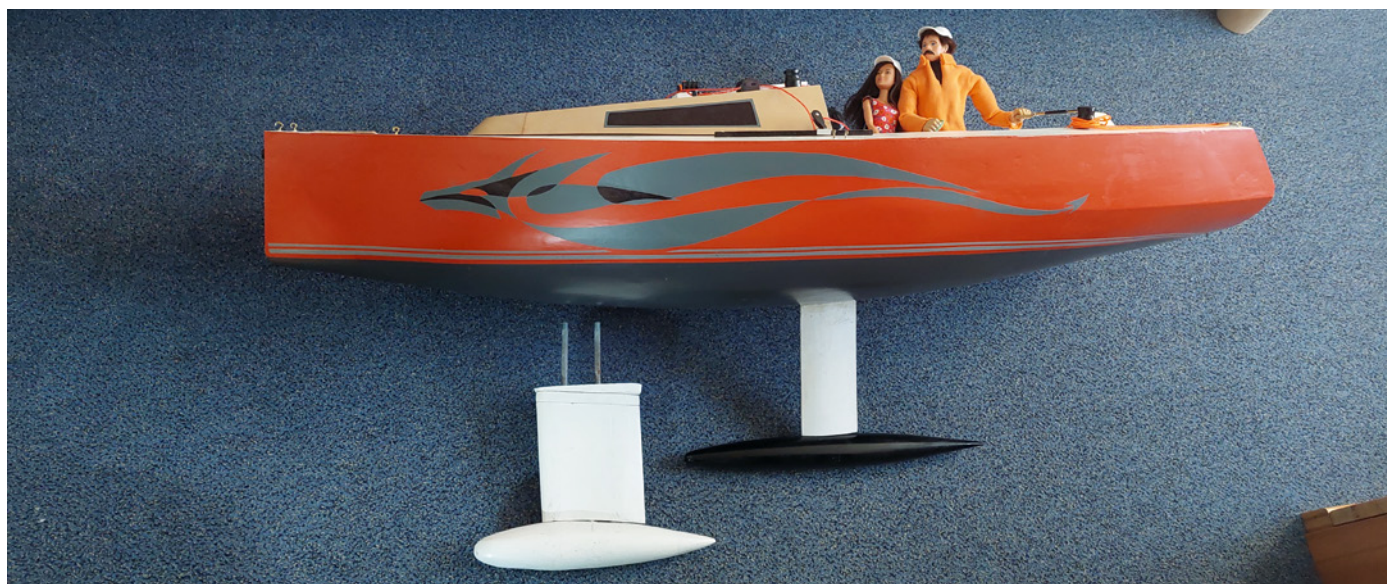
Nach etwas Feintuning ist die endgültige Form des Schwerts gefunden
