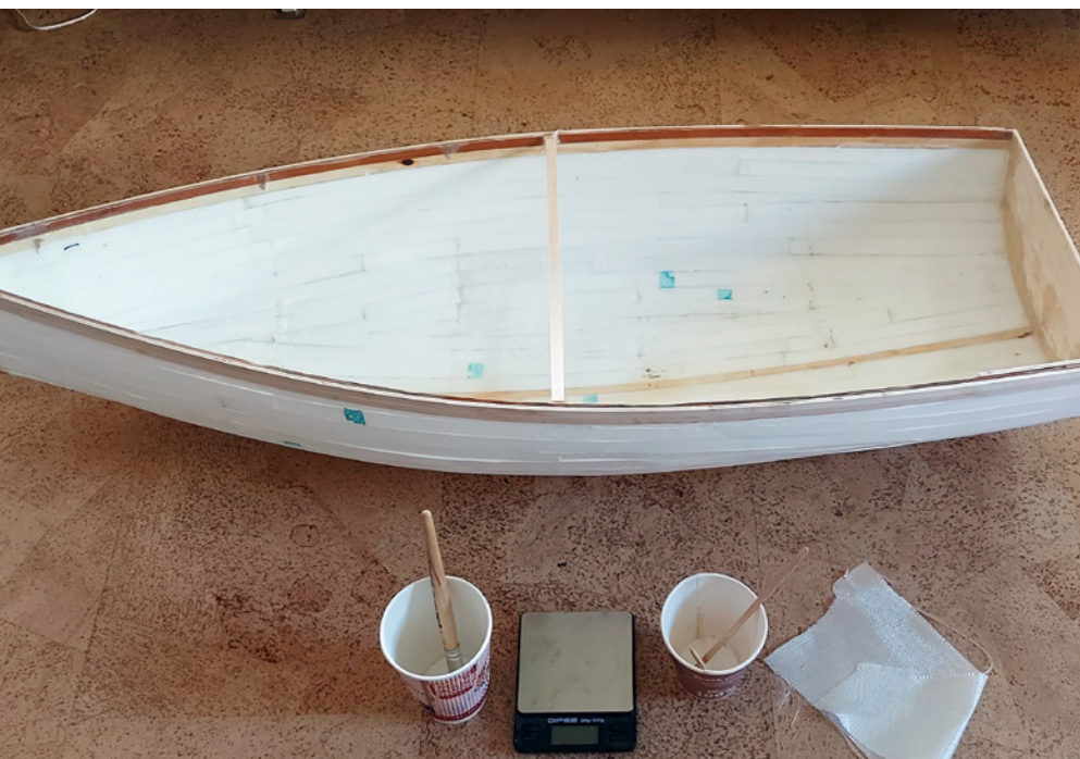
Zur Stabilisierung wurde der Rumpf innen mit Glasgewebe laminiert
