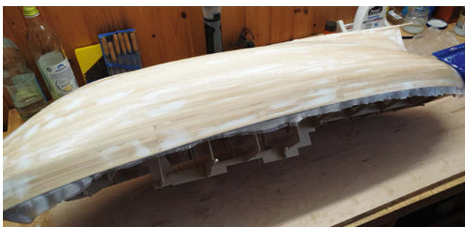
Zum Abschluss wird der Rumpf mit Glasfasermatte überzogen und ist damit wasserdicht
