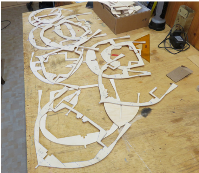
Die Spanten wurden klassisch mit Blaupapier durchgezeichnet und ausgesägt
