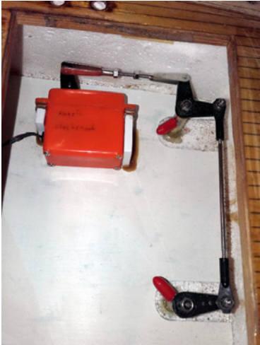
Um das Ruderservo später demontieren zu können, ist es mit Magneten befestigt
