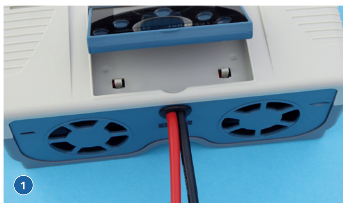
1) Das rückseitige Kabel wird mit der Spannungsquelle verbunden, außerdem befinden sich dort der USB-Port und der SD-Karten Slot sowie zwei Lüfter. 2) Die Bedienelemente sind übersichtlich angeordnet
