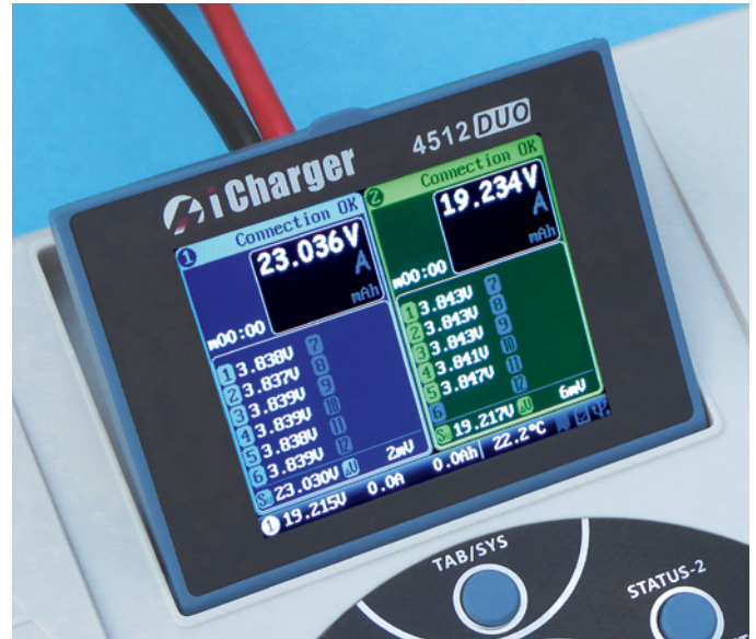
Das angewinkelte Display liegt gut im Blickfeld und lässt sich optimal ablesen, sämtliche Akkuanschlüsse erfolgen auf der Frontseite
