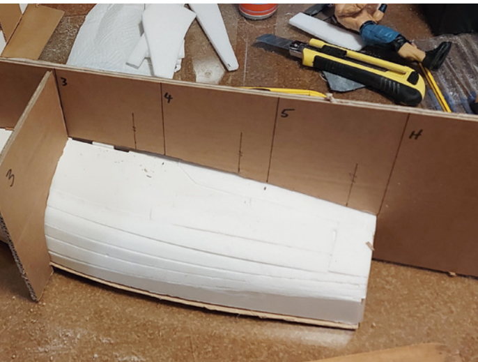
Eigentlich sollen die Depron-Planken nicht an den Spanten festkleben
