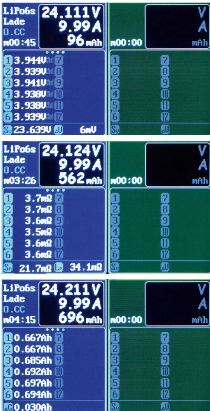
Beim Laden werden die wichtigsten Parameter übersichtlich visualisiert, dazu gehört die Anzeige der Innenwiderstände, aber auch die ge- oder entladene Kapazität der einzelnen Zellen
