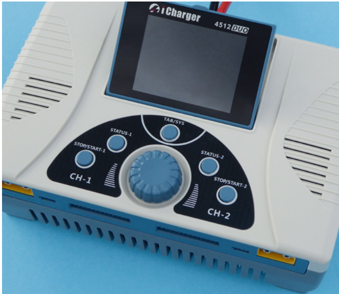
Das Ladegerät ist in einem zweiteiligen stabilen Kunststoffgehäuse untergebracht, das viele Lüftungsschlitze aufweist
