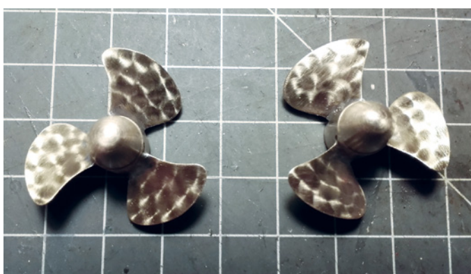
Die Schiffsschrauben von Raboesch wurden nachträglich mit Schleifspuren verschönert
