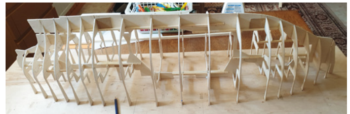
Das Spantengerüst steht auf Hellingfüßen, die hinterher gekürzt werden
