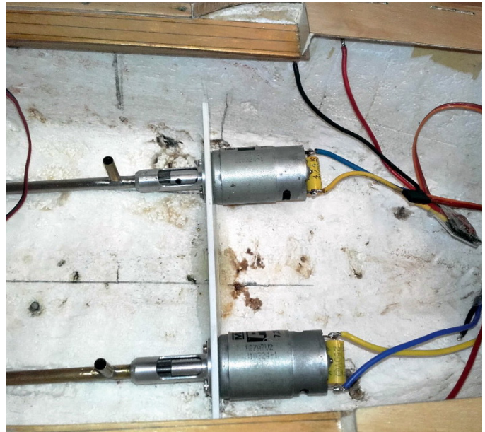
Die beiden neuen Motoren sind auf einem gemeinsamen Motorspant montiert
