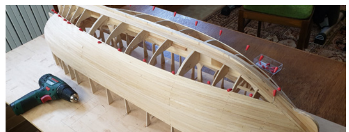
Wechselseitig werden die Spanten mit Lindenleisten beplankt
