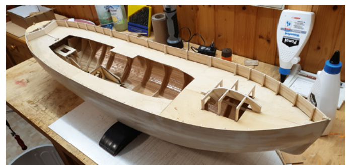
Das Deck muss für die Schanzkleidstützen passende Aussparungen bekommen
