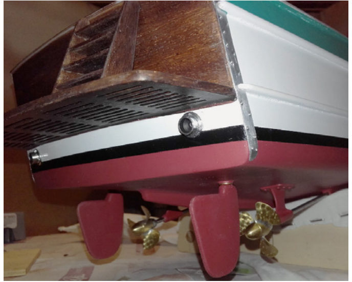
Als letzte Beschlagteile wurden die Schutzkanten und die Abgas-Auslässe am Rumpf angebracht
