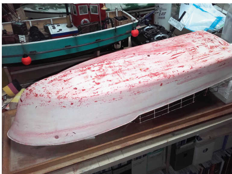
Der Styroporrumpf war beim Schleifen sehr druckempfindlich
