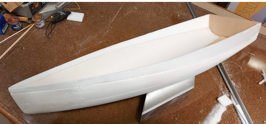
Als erste Idee wurde ein MicroMagic-Rumpf modifiziert
