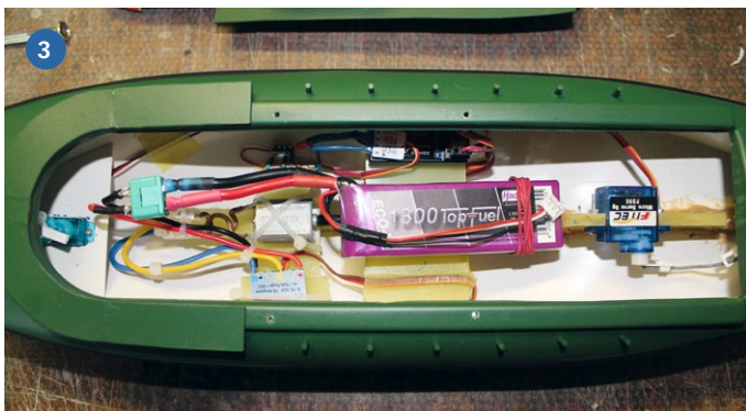
1) Ungewöhnlich, selten und höchst effektiv ist der für die Antriebe genutzte 4s-LiFePO-Akku, der 12 Amperestunden Kapazität mitbringt. 2) Die Kabel des Masts können die Knickbewegung ohne Schaden zu nehmen vollziehen. 3) Statt Holz kommt ein GFK-Kiel zur Stabilisierung des Tochterboot-Rumpfs zum Einsatz. Er nimmt auch einen Teil der Elektronik auf. 4) Die Armaturentafel ist mit LED hintergrundbeleuchtet. Zahlreiche Eigenbauteile, statt der aus dem Baukasten, sorgen für einen authentischen Eindruck
