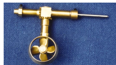
Eine Besonderheit der NORMAND NEPTUN ist der Swing up Thruster, der in Eigenarbeit entstand
