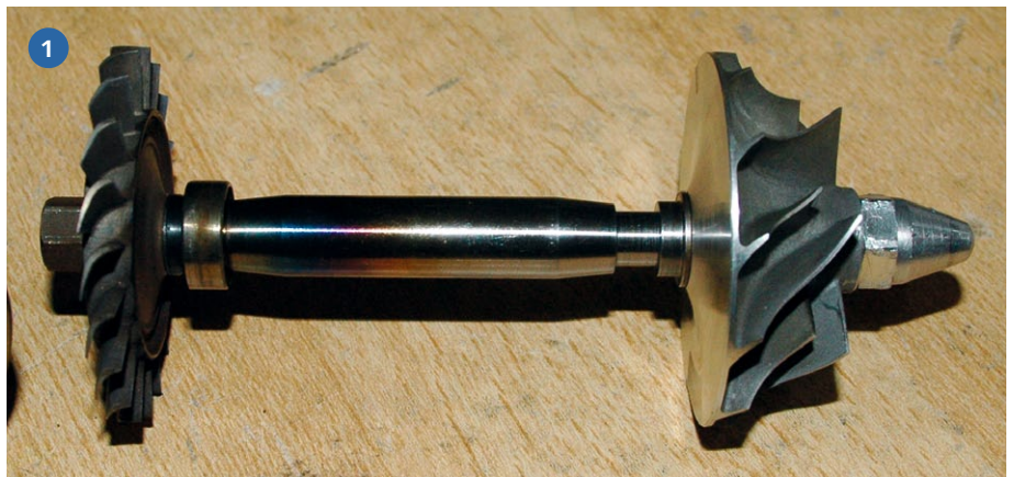
1) Auf der Turbinenwelle befindet sich vorne der Kompressor und hinten treibt der Abgasstrahl das Turbinenrad an. 2) Das Turbinenrad vom Zwei-Stufen-Getriebe wird ausschließlich vom heißen Turbinenstrahl angetrieben
