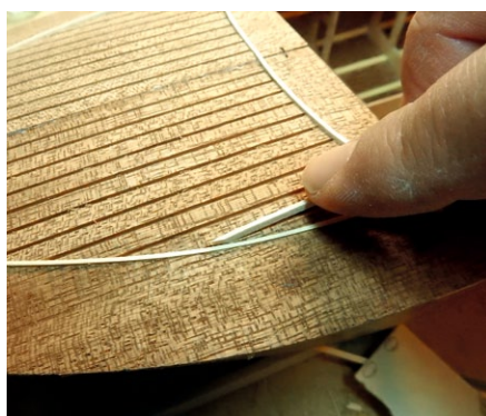
Das Einpassen der hellen Holzleisten ist mühsam, aber es lohnt sich wegen der tollen Optik
