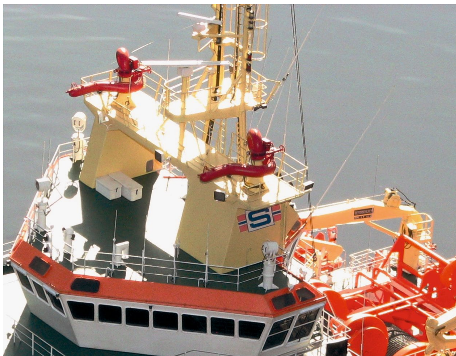
Auf dem Original fördern beide Löschmonitore die enorme Menge von 7.200 Kubikmeter Wasser in der Stunde
