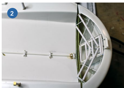
1) Über eine einfache Umlenkung lassen sich beide Ruder simultan bewegen. Die Heckklappe steuert ein Servo über eine ausladende Seilzug-Verbindung. 2) Das Umlenkseil ist versteckt in der Wanne geführt. 3) Zum Absetzen und Einholen des Tochterboots hat sich die Seil-Haken-Methode bewährt
