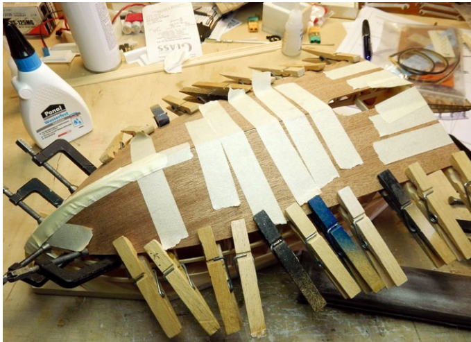
Mit vielen Klammern und Klebeband wird zuerst die Bodenbeplankung und danach die Seitenbeplankung aufgebracht
