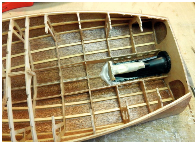
Der Jet wird eingepasst, provisorisch an Ort und Stelle gehalten und dann von oben mit angedicktem Epoxy vergossen
