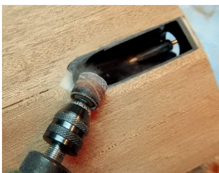
Der Einlauf des Jets muss sauber verschliffen werden, damit der Strömungswiderstand so gering wie möglich ist
