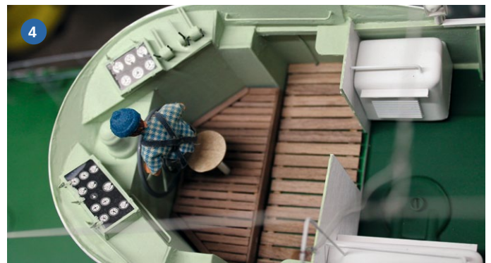
1) Ungewöhnlich, selten und höchst effektiv ist der für die Antriebe genutzte 4s-LiFePO-Akku, der 12 Amperestunden Kapazität mitbringt. 2) Die Kabel des Masts können die Knickbewegung ohne Schaden zu nehmen vollziehen. 3) Statt Holz kommt ein GFK-Kiel zur Stabilisierung des Tochterboot-Rumpfs zum Einsatz. Er nimmt auch einen Teil der Elektronik auf. 4) Die Armaturentafel ist mit LED hintergrundbeleuchtet. Zahlreiche Eigenbauteile, statt der aus dem Baukasten, sorgen für einen authentischen Eindruck
