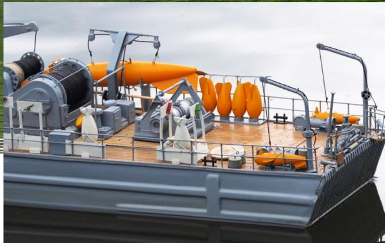
Back des Räumbootes MARS aus der WEGA-Klasse mit den typischen Ausrüstungsgegenständen zur Kampfmittelräumung
