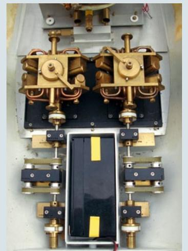
Zwei V-Maschinen mit Übersetzung für den Zweischaubenantrieb
