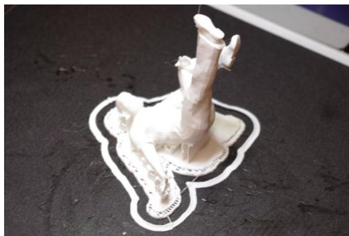
Druck in weißem PLA mit Raft (Fundament) auf BuildTak, einer Art Dauerfolie auf dem Druckbett
