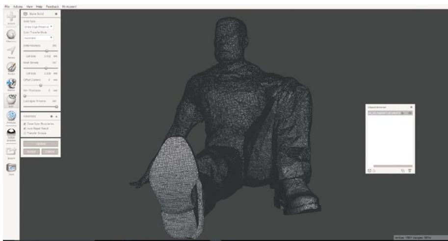
Sind wirklich hunderte Dreiecke nur für die Schuhsole notwendig? Reduzieren hilft beim späteren Druck
