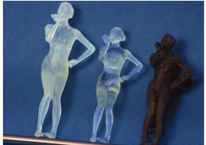
Vergleich der beiden in Auftrag gegebenen Figuren Frosted Ultra Detail von shapeways (links) und Clear Acrylic Resin von creabis (mitte) mit der selbst gedruckten PLA-Figur (rechts)
