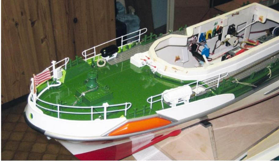
**Basis für die orangenen Fender war ein Balsastück, das nach dem Zuschleifen abgeformt und abgegrissen wurde**
