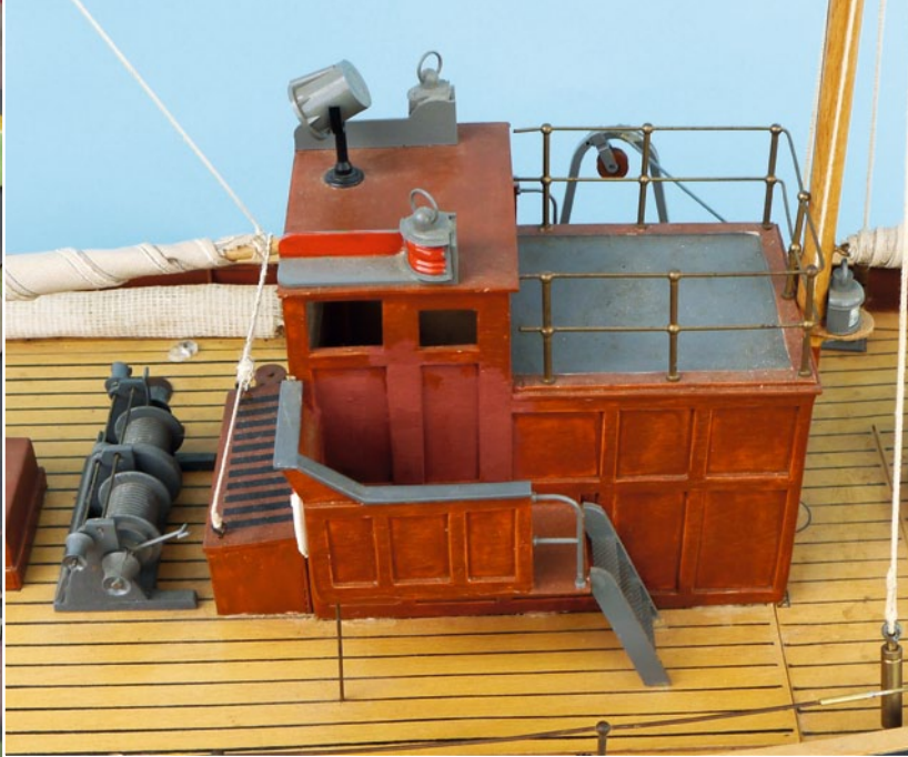
Das Deckshaus beinhaltet den Steuerstand und die Kombüse sowie den Abtritt für die Besatzung, die Netzwinde wird direkt vor dem Deckshaus angebracht
