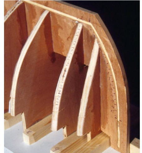
Erst wenn das komplette Spantengerüst gestrakt ist, kann mit dem Aufbringen der Planken begonnen werden. Hier ist im Vorsteven eine Nut zur Aufnahme der Leisten eingelassen
