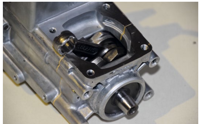
Das obere Pleuellager wurde von 8 auf 9 Millimeter vergrößert, das untere von 10 auf 12 Millimeter
