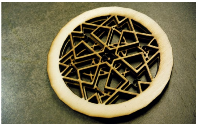
Abbildung 12: Filigranste Strukturen lassen sich mit Hilfe eines Lasers produzieren – mit einer CNC-Fräse wäre das nicht machbar
