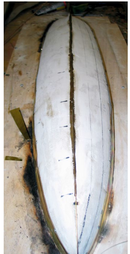
Die Form für den Rumpf wurde zunächst mit Gips erstellt, anschließend wurden Messingbleche darüber verlötet
