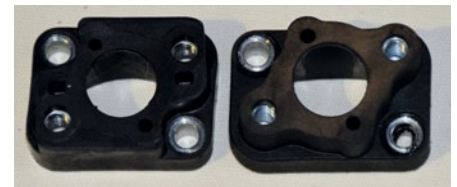
Der Isolator ist etwas breiter geworden, die Vergaserbefestigung hat jedoch weiterhin die gleichen Abmessungen
