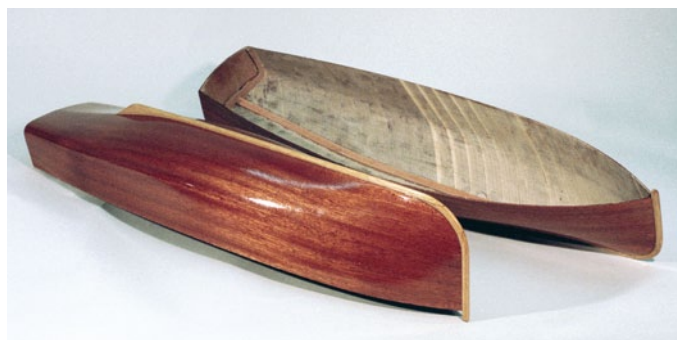
Aufwändig, jedoch sehr effektiv ist die diagonale Bepankung mit dünnen Holzstreifen
