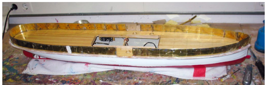
Die Form für den Rumpf wurde zunächst mit Gips erstellt, anschließend wurden Messingbleche darüber verlötet
