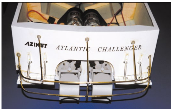
Um den Jetantrieb am Heck der ATLANTIC CHALLENGER zu schützen, ist ein stabiles Schutzgitter aus Messingdraht angebracht
