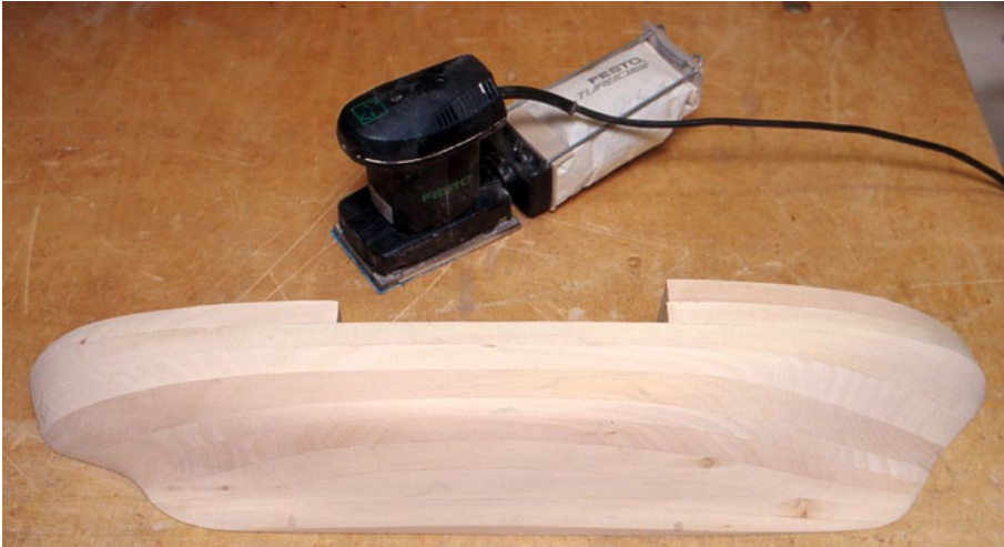
Bis der Rumpf soweit feingeschliffen ist, vergeht einiges an Zeit. Man erreicht ein so gutes Ergebnis, wenn man beim Schleifen immer wieder mit eine „Spanten“-Schablone die Kontur überprüft
