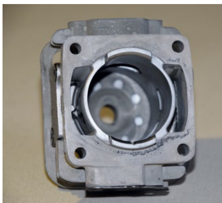
Neu gestaltet sind die Überstromkanäle, die jetzt komplett geschlossen sind
