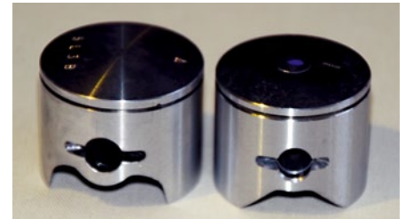
Links der Kolben Zenoah G320 PUM und rechts der Kolben des G290 PUM. Die Modifikation ist auf den ersten Blick erkennbar
