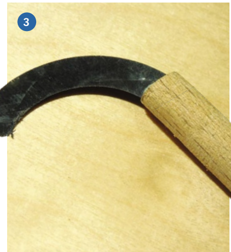
Abbildung 1) Der Abstandssensor erzeugt kleine Messfehler, wenn das von ihm emittierte Licht an zwei unterschiedlichen Ebenen reflektiert wird. Abbildung 2) Schnittkante im Querschnitt – die Flanken sind nahezu senkrecht, hier am Beispiel eines 1 Millimeter starken Balsabrettchens. Abbildung 3) Die Fokussierung gelingt leicht mit einer Blendenlamelle, die zur Sicherheit an einem Griffchen befestigt ist
