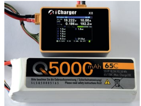
Praxistest beim X8 wurden mit einem 6s-LiPo mit 5.000 Milliamperestunden Kapazität vom Typ Quantum durchgeführt
