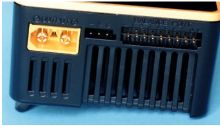
Die linke Gehäusesseite mit den Anschlüssen für Akku, Servo und Balancer
