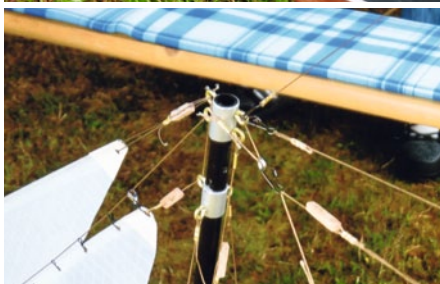
Es wurde das Schonersegel im Unterliek soweit gekürzt, damit es an einem Baum haarscharf vor dem Großmast vorbeigeführt werden kann
