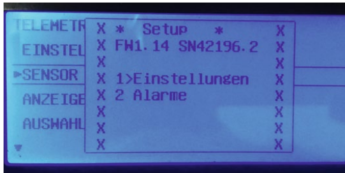
Der UniSens-E kann vor Ort auch ohne PC über das Telemetriemenü des Senders programmiert oder angepasst werden
