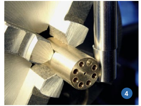
Abbildung 2) Strichabstände bei Wabeco 0,05 Millimeter. Die Striche sind schon zu breit und der Durchmesser vom Skalerring könnte viel größer sein (Eigenbau). Abbildung 4) Die Kante eines runden Teils wird im Teilkopf angefahren
