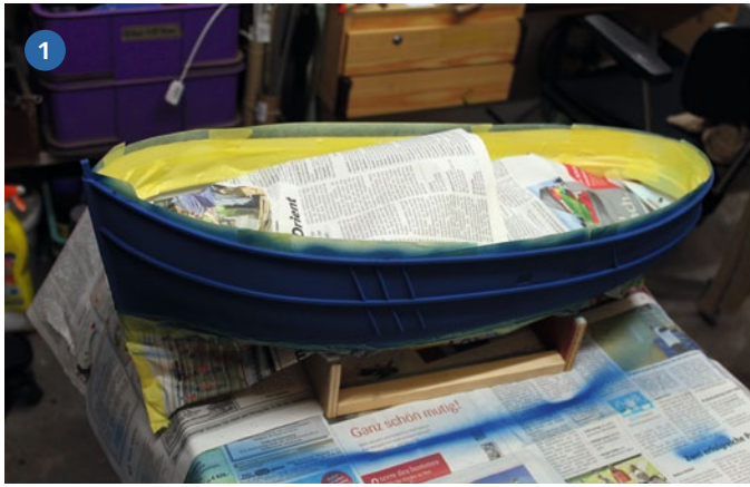
1) Im nächsten Arbeitsgang erfolgte die Lackierung des Überwasserschiffes. 2) Das Deck nach der Beplankung und Lackierung des Süllranddeckels: Man sieht die spätere Position des Hauptmastes, des Hauptschalters und des Abgasrohres
