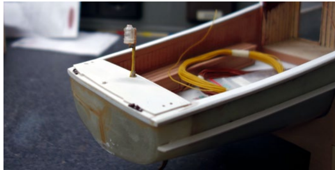
Nach dem gleichen Prinzip wie die Toplaterne ist auch die Hecklaterne funktionsfähig beleuchtet
