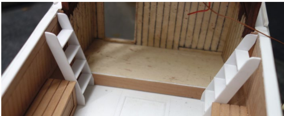
Stellprobe der Niedergänge, die aus Frästeilen – zunächst am PC – entworfen worden sind
