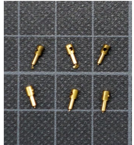
Aus Messingstiften und -rohren entstanden die filigranen Handlaufstützen fürs Dach
