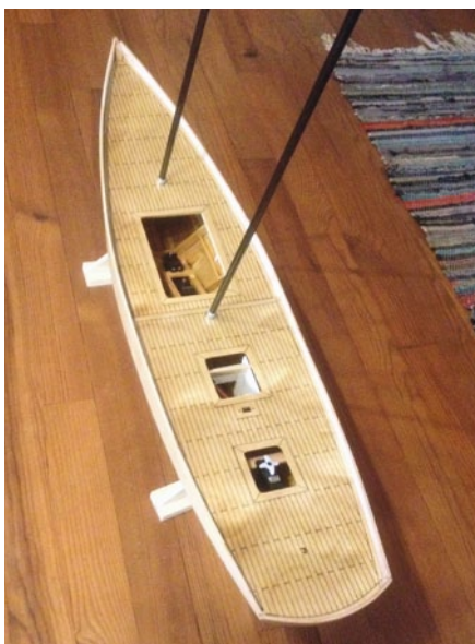
Die Deckaufbauten wurden teilweise etwas vergrößert, damit man einen besseren Zugang zu den technischen Einbauten hat
