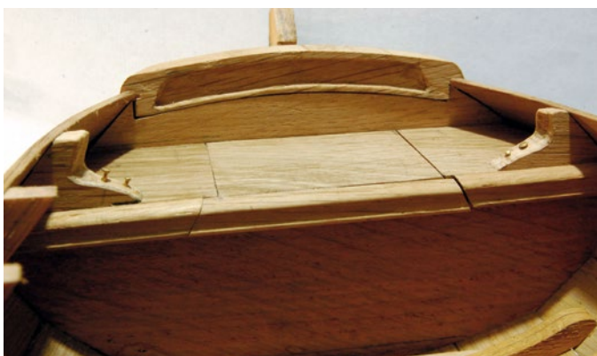
Die Sitzbank achtern wird gebaut ...
