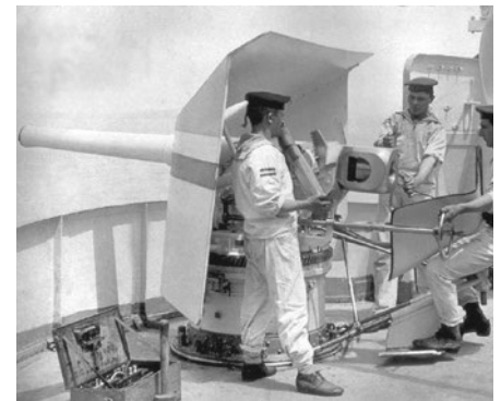
Mannschaft an einer 88-Millimeter-Mittelpivot-Lafette C/89 jener Zeit
