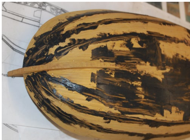
Die Kalfalterung wurde mit Silikon versiegelt, das nach dem endgültigen Trocknen abgeschliffen wurde, sodass nur welches in den eingeritzten Plankenstößen zu sehen ist
