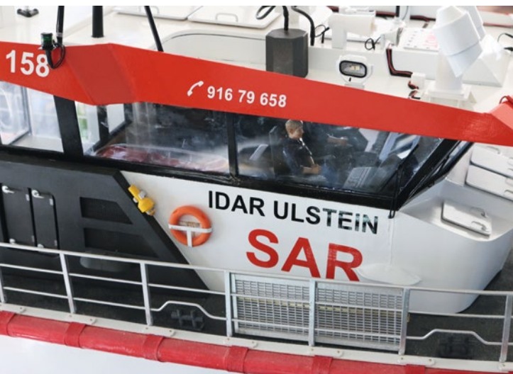
Details sind erstellt und angebracht. Vorreiber, Reeling, Zugangsluken und Steuerhaus sind fertig
