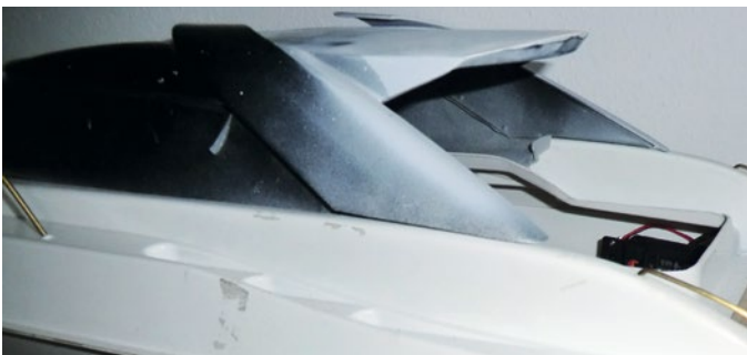
Das Dach aus dem Baukasten wurde komplett ersetzt. Als hinterer Abschluss wurde in Spantenbauweise ein ABS-Stück eingesetzt, von seitlichen Dreiecks-Stückchen gestützt, angeklebt und verspachtelt
