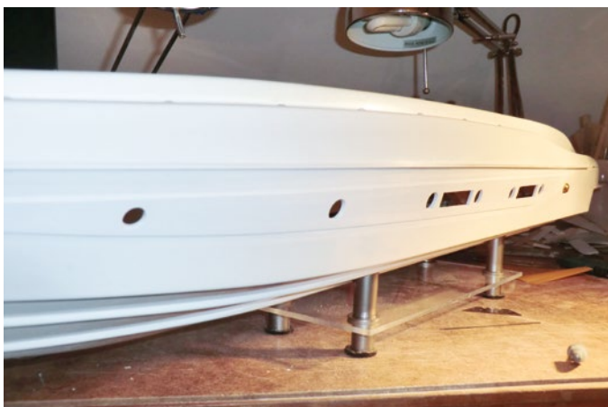
Das Fensterband entstand durch Löcher, die mit einem Kegelschleifer auf das passende Maß gebracht wurden. Die rechteckigen Fenster wurden mit einer Feile bearbeitet
