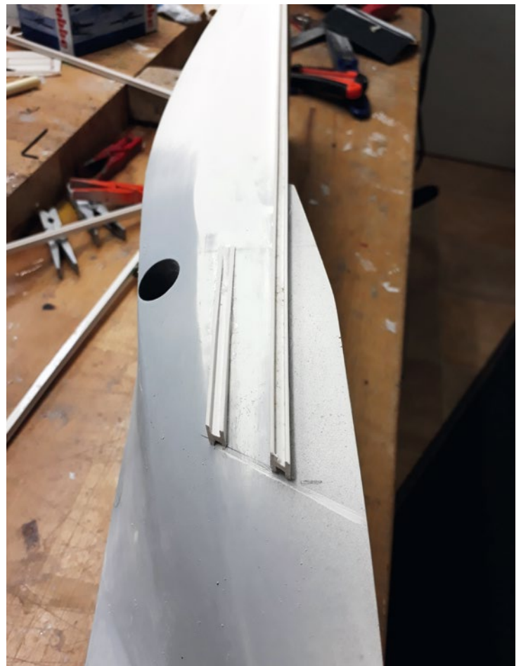
Um die am Rumpf befindlichen Scheuerleisten nachzubilden, wurde ein H-Profil aus Polystyrol angeklebt
