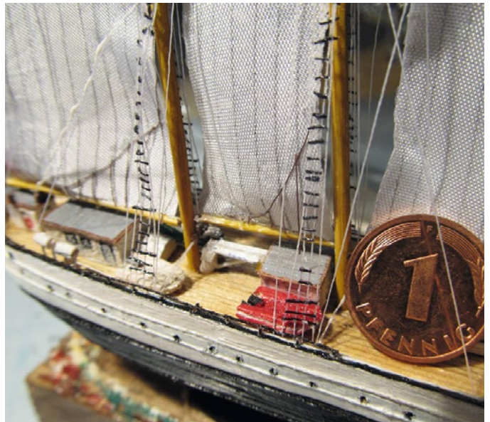
Detail des Decks mit Beiboot. Die Reling wurde aus Besenborsten und Sekundenkleber-gestärktem Nähgarn gefertigt
