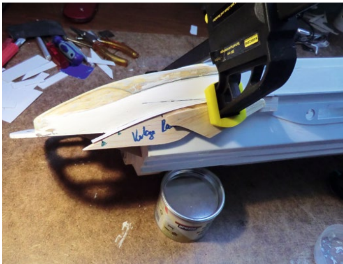
Für die gewünschte Biegung des Naht-Verlaufs wurde eine Schablone erstellt. Die neue Leiste wurde dann anhand der Schablone seitlich aufgeklebt
