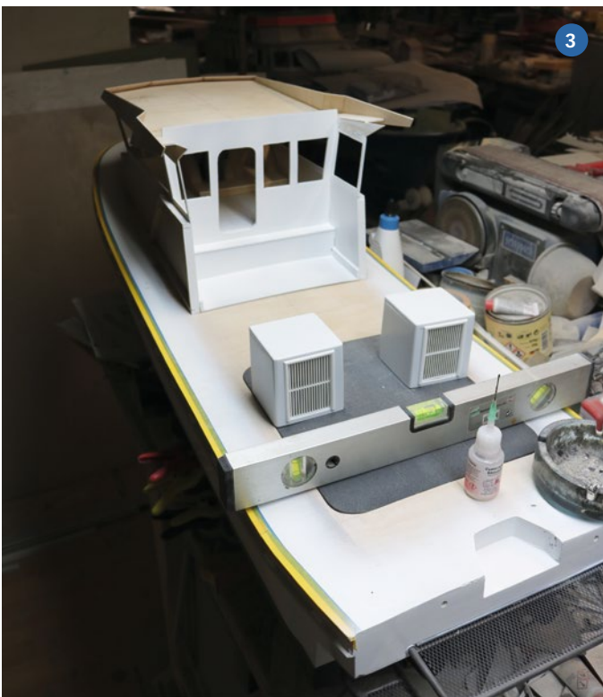
1) Die vorgesehene kompakte 30-Millimeter-Antriebseinheit mit neuer Servoaufnahme für Standard-servos. 2) Die Abwicklungen sind am Rumpf angebracht und vorlackiert – der Aufbau entsteht. Passprobe für ein Besatzungsmitglied. Die Abmessungen sind stimmig. 3) Der Heckbereich: Abluftkästen und der hintere Zugang zum Schiffsinneren sind gut zu erkennen. 4) Die Heckklappe ist von Scale Print und kommt dem Original sehr nah. Die Einpassung erfolgt an separaten Haltern. 5) Die fertig angeschlagene Rückfahrklappe am installierten Jet. Seitlich ist der Kühlwasserauslass zu erkennen
