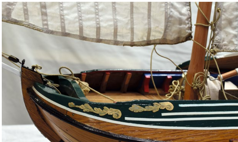
Das Vorschiff: Die Verzierungen am Bedeckelbalken im Bug und der Hennebalken an der Steuerbank gelangen mit Hilfe einiger Diamantfräser
