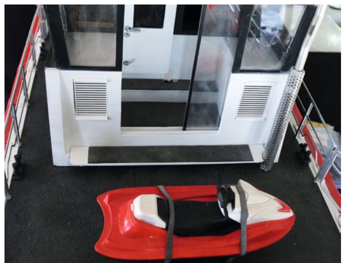
Ansicht vom Heck. Der Berge-Jet ist zugekauft und lediglich umlackiert. Der Abgaspfosten der Kombüse mit seinem Hitzeschutz stellte auf Grund seiner Formgebung eine Herausforderung dar
