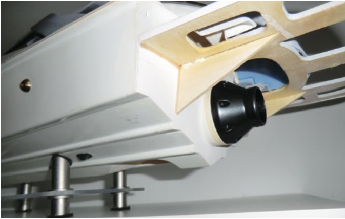
Die Badeplattform musste größer werden als vorgesehen. Sie wurde aus einem Grundträger aus Holz aufgebaut. Auf der Außenseite wurden noch ABS-Ringe aufgesetzt, um den schrägen Winkel des Heckspants auszugleichen
