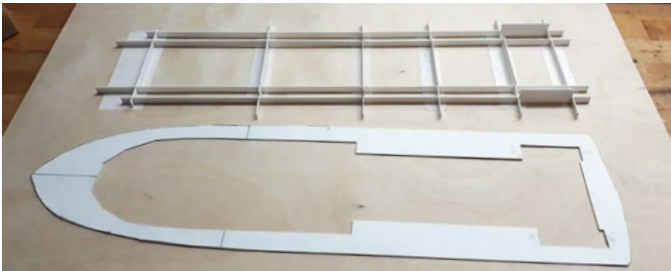
Der Rahmen, der das Deck stützen sollte, passte nicht – er war falsch konstruiert worden. Statt die nötigen Platten neu zu zeichnen, wurden diese kurzerhand manuell ausgeschnitten oder mit Hilfe vorliegender Teile angepasst
