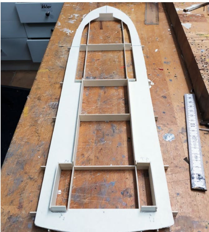
Das Deck wurde mit seinen Unterzügen, dem Süll und ein paar zusätzlichen Verstärkungen mit dem Rumpf verklebt. Hilfsmittel war Ruderer
