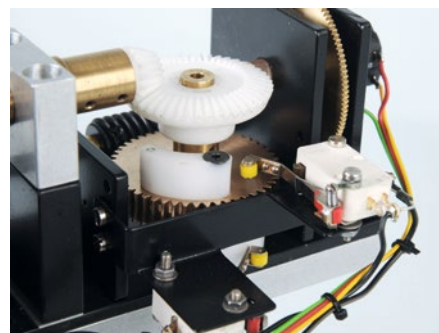
Die Endlagenschalter: Auf dem Schneckenrad wurde ein Stift platziert. Dieser läuft, sollte die Elektronik nicht wie gewünscht funktionieren, gegen einen der beiden Mikroschalter. Der entsprechend angefahrne Mikroschalter unterbricht dann die Spannung zum Getriebemotor
