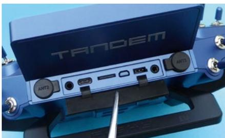
Sämtlich Ports einschließlich eines SD-Karten-Slots sind durch eine Abdeckung geschützt und gut zugänglich
