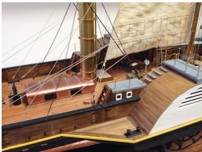
Der Aufgang zur Brücke erfolgt über den Schaufelradkasten
