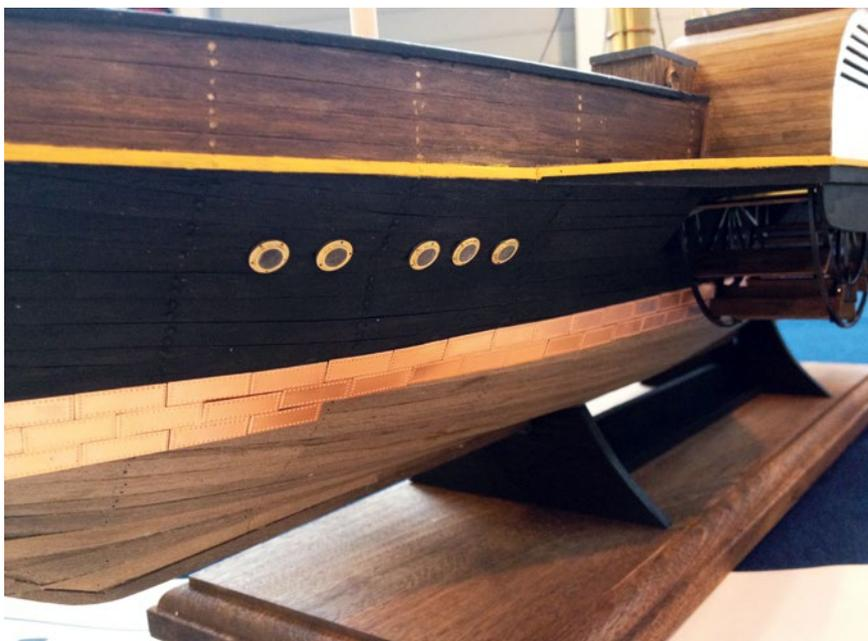
Das gesamte Unterwasserschiff wurde mit insgesamt 1.250 Kupferplättchen beklebt
