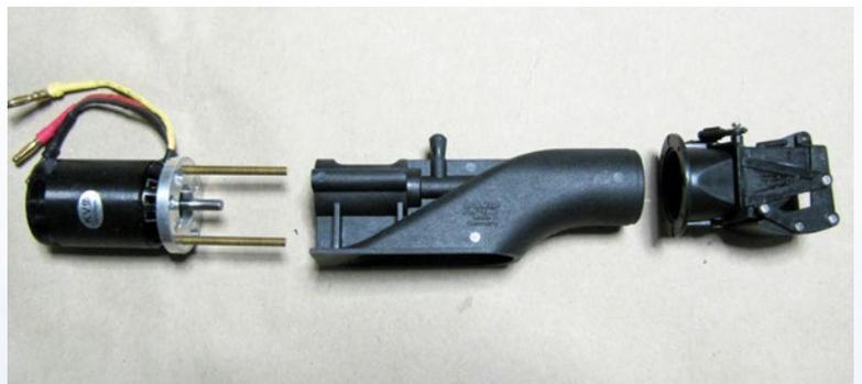
Der Jet stammt von Kehrer Modellbau. Ein Brushless-Motor treibt den Impeller an
