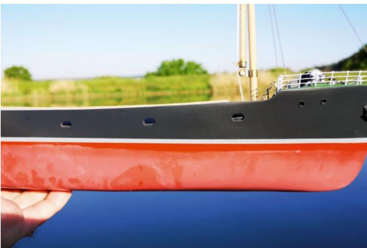
Leider reagiert der neue Lack mit dem Wasser und wird milchig. Nach einer Stunde ist der Effekt jedoch wieder vollständig verschwunden
