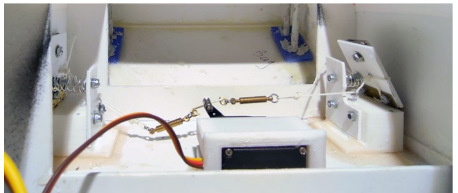
Blick auf die Klappschaltung. Wichtig ist dabei, ein dehnungsfreies Band zu verwenden. Die Wartenspanner helfen bei der Feinjustierung
