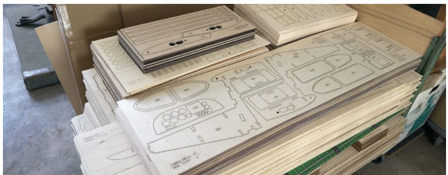
Bündelweise produzierte, frisch gelaserte Holzteile für eines der vielen Baukastenmodelle warten auf die Konfektionierung
