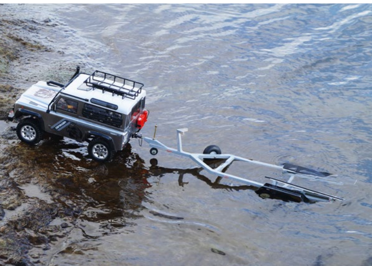
Damit der Bootstrailer selbst nicht aufschwimmt, muss er angemessen beschwert werden
