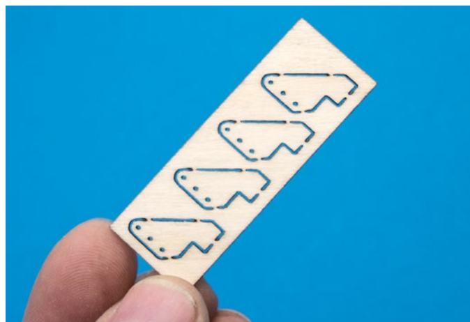
Eine Sache von wenigen Minuten: Ruderhörner konstruieren und aus 1,5-mm-Birkensperrholz auslasern. Man beachte die feinen 0,8er-Bohrungen sowie die optimal ausgerichtete Maserung
