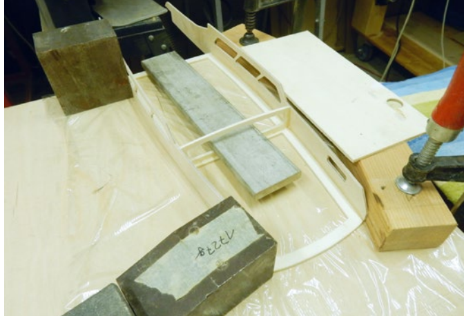
Am Rahmen werden zunächst die Seitenteile geklebt
