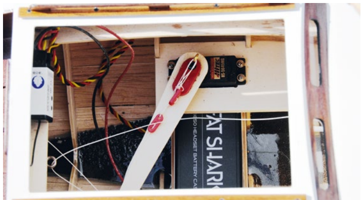
Der Ballast besteht aus Eisenschrot, das mit Harz vergossen ist. Die Segelverstellung erfolgt mittels eines Servos mit langem Hebelarm
