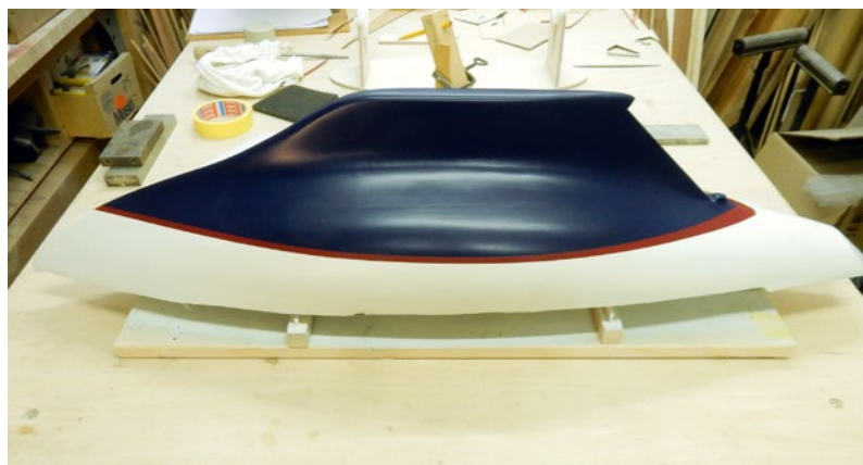
Fertig lackiert! In diesem Stadium ist es besonders einfach, die Wasserlinie anzuzeichnen
