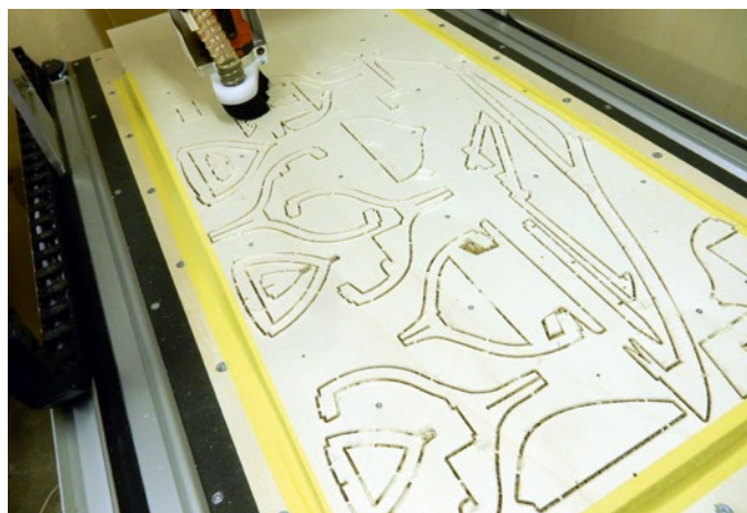
Mit Hilfe der erstellten Daten lassen sich auf der CNC-Fräsmaschine Bauteile aus Sperrholz erstellen
