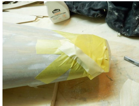
Am besten fixiert man das Ganze mit viel Klebeband bis zum Aushärten des Klebers
