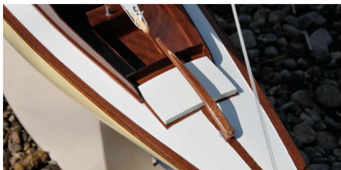
Die Pinne ist der Hingucker auf dem Achterdeck und hilft auch auf dem Wasser die Position des Ruderblatts zu erkennen
