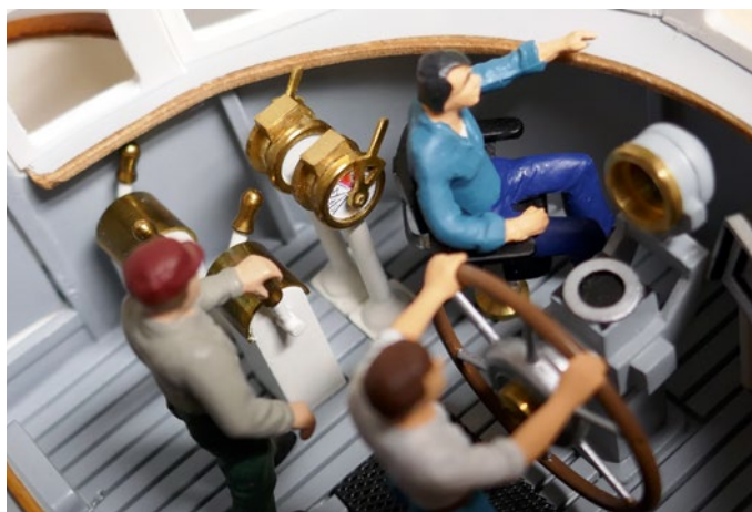
Später kaum mehr erkennbar, aber für Erbauer Jörg Bayer eines von vielen wichtigen Elementen, ist beispielhaft der Maschinentelegraph mit Anzeiger
