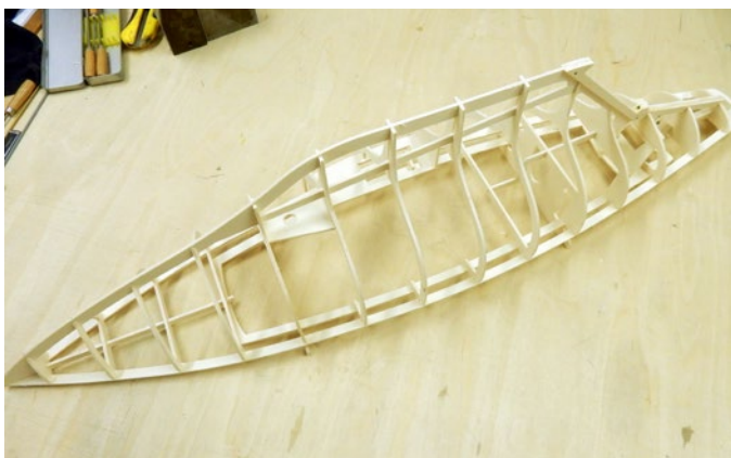
Das Rumpferippe wird mittels gefrästen Deckstringern ausgerichtet
