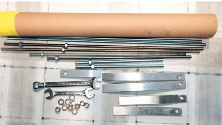
Das Befestigungssystem ist in einer Pappröhre mit in der Transportbox verstaut. Zusätzliche Längen der Gewindestangen oder Klemmbleche sind jederzeit möglich
