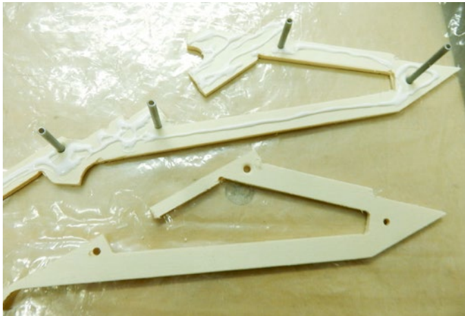
Die Teile des Kiels werden mit Stiften aus Bowdenzugröhrchen sicher zueinander positioniert
