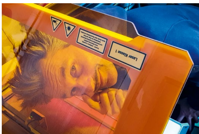
Der transparente Deckel ist nicht ohne Grund orange. Er filtert die schädlichen Laser-Lichtwellen heraus, sodass man dem Gerät bedenkenlos bei der Arbeit zusehen kann
