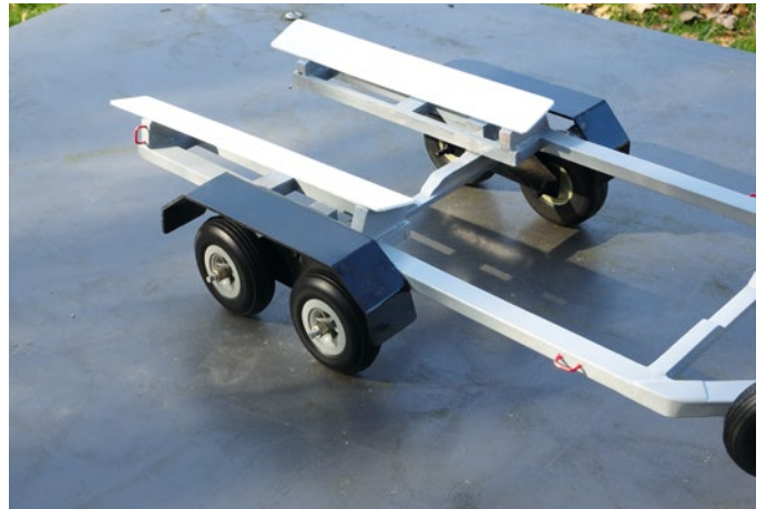
Bei den hinteren Bootsauflagen fehlt noch die Moosgummilage, um den Bootsrumph zu schützen und etwas zu fixieren
