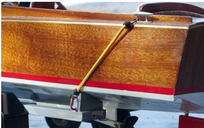
Spanngummis fixieren das Boot sicher auf dem Trailer
