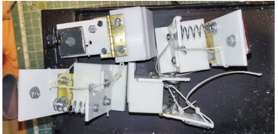
Die fertig zusammengebauten Blöcke des Klappsystems, jeweils von einer anderen Seite gesehen
