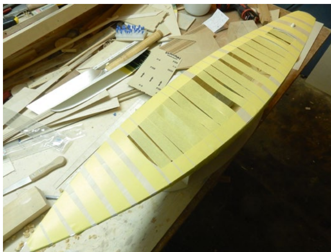
Mit viel Klebeband auf dem Rumpf gehalten, bis der Kleber ausgehärtet ist, kann man das Deck verkleben
