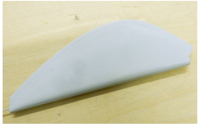
Nach dem Verschleifen ergibt sich ein passgenaues Ruderblatt
