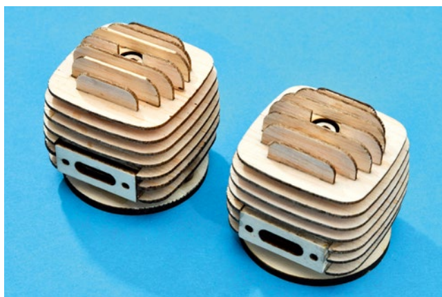
Diese selbstkonstruierte Zweizylinder-Benzinmotoratruppe war mir bisher fürs Hand-Aussägen zu lästig. Mit dem Laser hingegen ist das kein Problem
