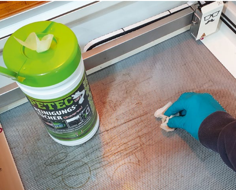
Mit Werkzeug-Reinigungstüchern lassen sich unvermeidliche Abbrand-Reste vom Gitterblech rubbeln
