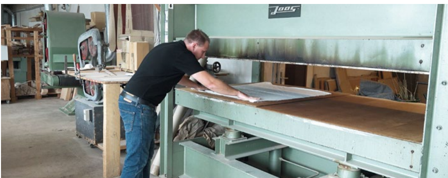
Eine Spezialität von aero-naut sind mit Textil verleimte Furniere, die ideal für Oberflächenbeplankungen sind – die Fertigung erfolgt direkt in Reutlingen
