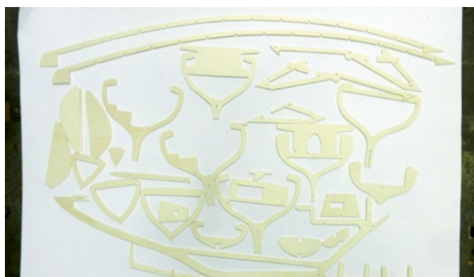
Das Ergebnis von einer Stunde Fräsarbeiten. Von Hand wären die Teile nur sehr schwer herstellbar und nur mit deutlich geringerer Präzision realisierbar
