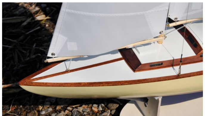
Entgegen dem Original ist die Fock als Pendelfock ausgeführt, was den Segeleigenschaften sehr zugutekommt
