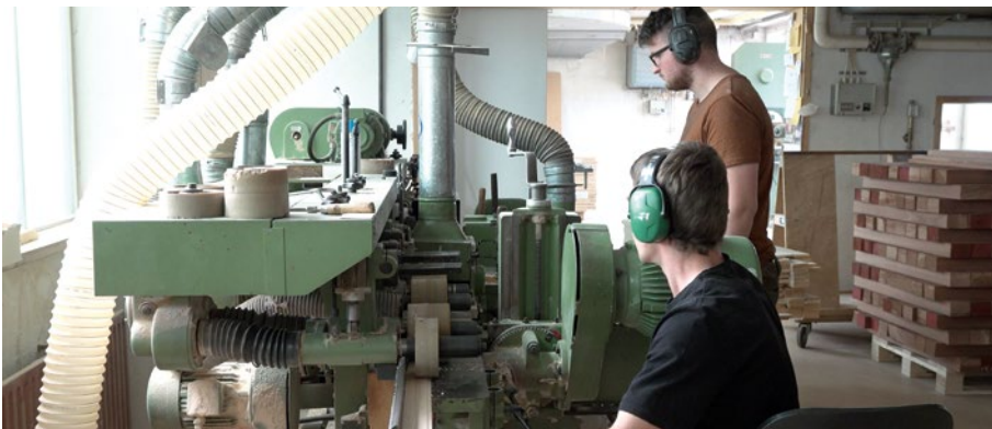
In der Holzwerkstatt kommen präzise, seit Jahren bewährte Industrie-Maschinen zum Einsatz, hier zum Profilieren von Leisten
