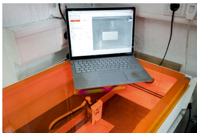
Mein neues Holzbearbeitungszentrum. Auf dem Laptop konstruierte Bauteile werden von nun an mit sehr geringem Aufwand „auf den Laser geworfen“
