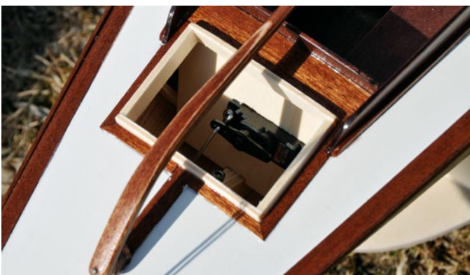
Die kleine Rudermaschine für die Ruderanlenkung verliert sich fast in dem geräumigen Raum unter dem Achterdeck
