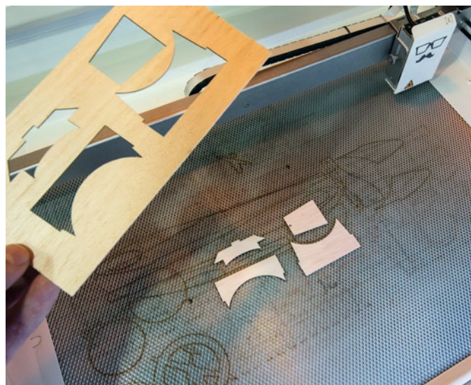
Heute geht das so: Fertige Teile aus dem Laser entnehmen. Auch ein passionierter Handwerker muss sich eingestehen, dass die Teile mit der Bandsäge weniger exakt gelingen
