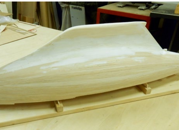
Zunächst erfolgt das Beschichten mit Glastmatte und Epoxyd-Harz
