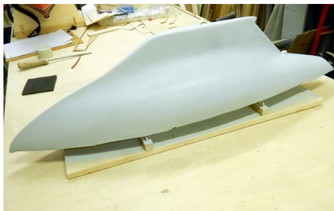
Anschließend kann man den Rumpf ein zweites Mal beschichten und schleifen
