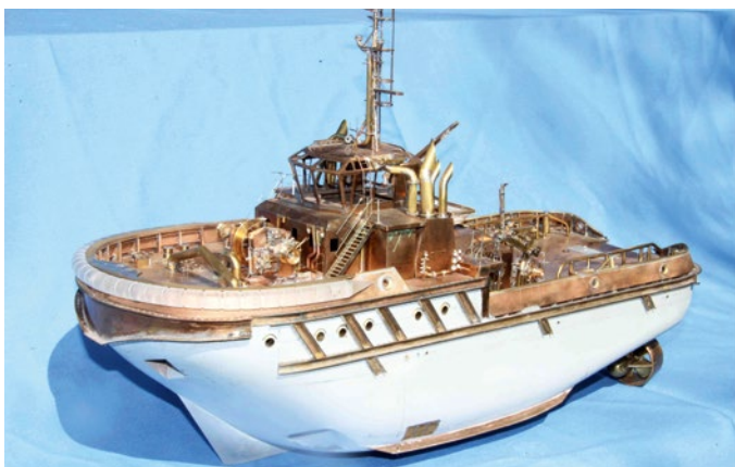
Sämtliche Aufbauten sind aus Bronzeplatten und Messing gelötet
