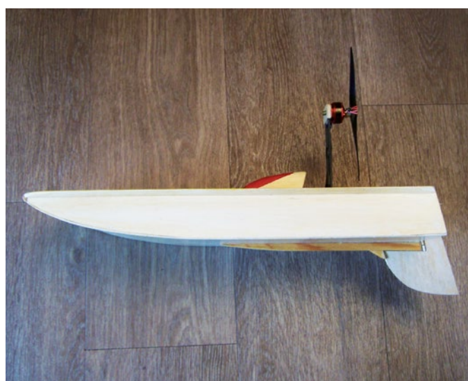
Das Modell mit getauchtem Ruder steuert besser, bleibt aber oft im Seegras hängen
