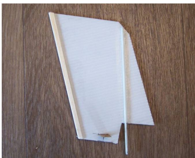
Am Ruder ist eine Gurney Flap aufgeklebt, die die Ruderwirkung verbessert
