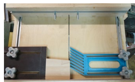
Der Sägeschlitten mit gedrucktem „Featherboard“ und Seitenanschlag
