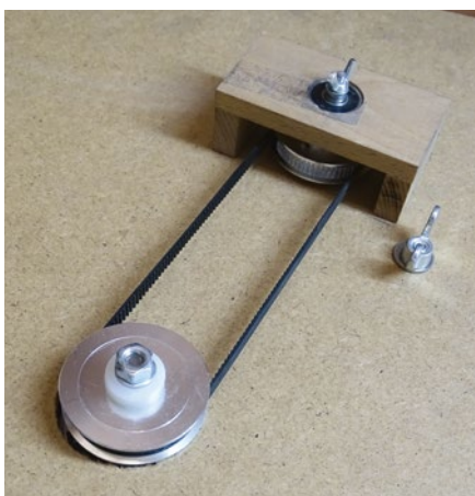
Ein Riemen überträgt die Winkelverstellung des Tisches an den Winkelmesser
