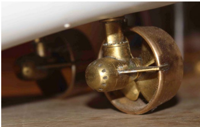
Die ASD-Antriebe sind feinsten Eigenbau, auf den sich Alexander Mehl gefreut hat
