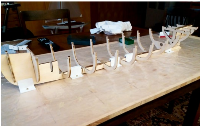
Der Kiel wird mit kleinen Winkeln senkrecht auf das Baubrett geschraubt
