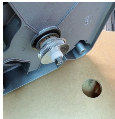
Das Lager der Winkelverstellung ist um ein Modulrad zu erweitern
