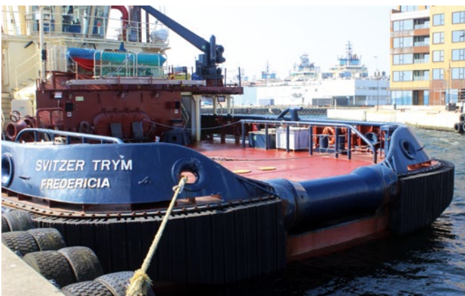
Die Heckrolle des Schleppers. Im Hintergrund liegen die großen Brüder der Svitzer-Reederei
