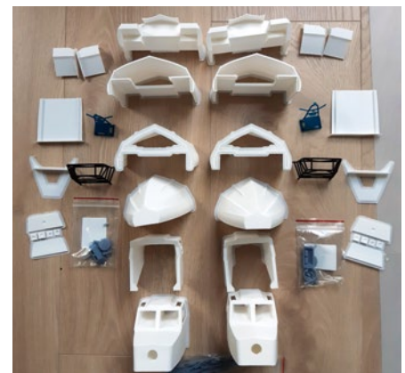
Das Boot ist in logische Einzelteile zerlegt und dann ausgedruckt
