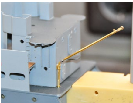
Der fertige Kran wird an der Rückseite des Brückenhauses montiert
