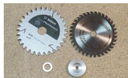
Vergrößerte Anpressplatte und Reduzierhülse für vielfältige Sägeblattwahl
