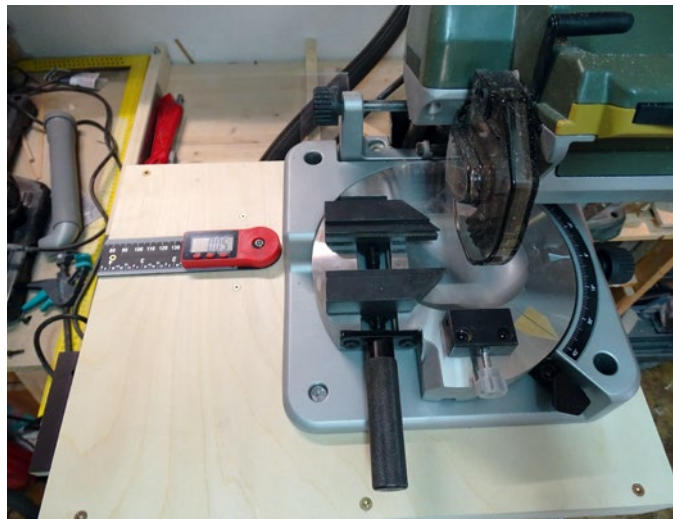
Nach dem Tuning verfügt die KGS 80 über eine optimale Kombination für winkelgenaues Sägen
