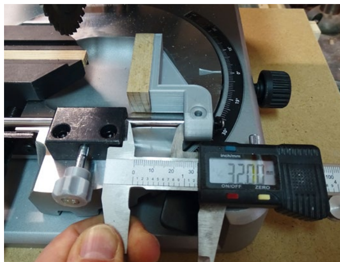
Der neue Längenanschlag bietet bessere Möglichkeiten beim Einstellen des Längenmaßes
