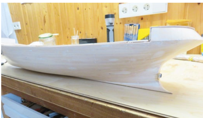
Der fertige Rumpf wird geschliffen und mit Glasgewebe überzogen
