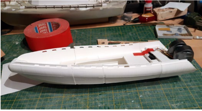
Der Rumpf ist zusammengeklebt und die Motoren montiert
