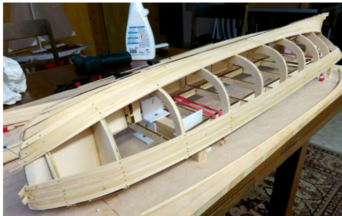
Nachdem das Spantengerüst gestrakt wurde, kann mit dem Beplanken begonnen werden
