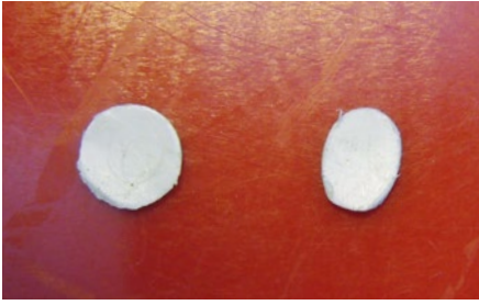
Die Mannlochdeckel wurden ausgestanzt und dann oval geschliffen
