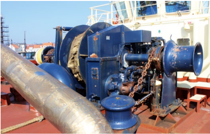
Eines der Highlight der SVITZER TRYM ist die kombinierte Schlepp- und Ankerwinde auf der Back
