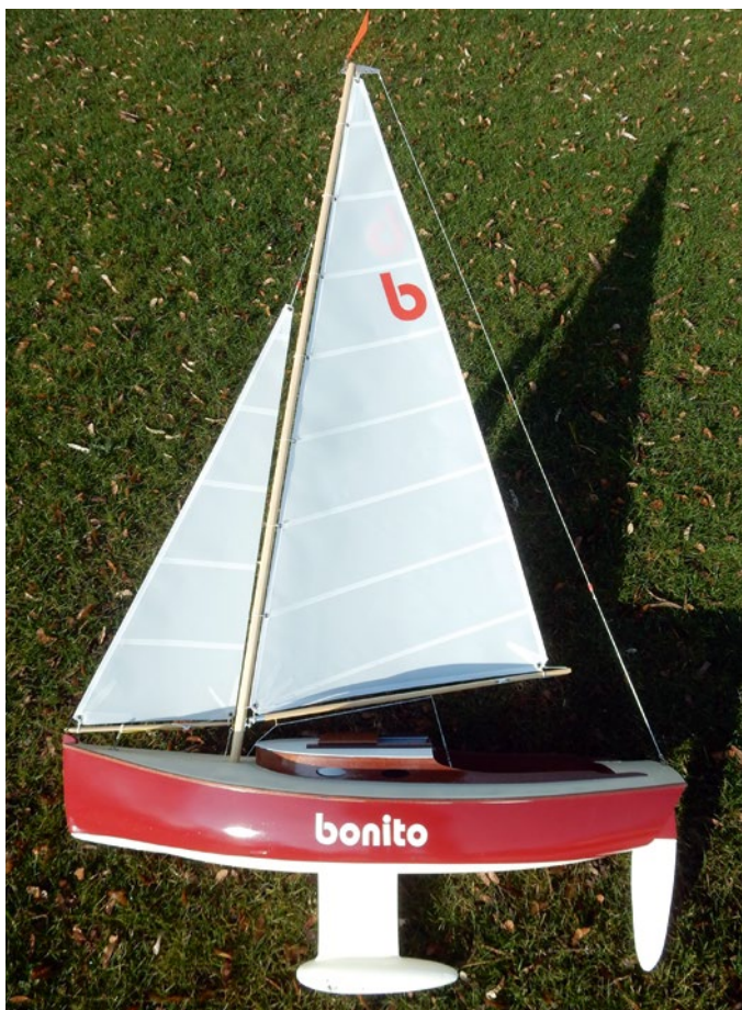
Das kurze Kielschwert mit dem BELLISSIMA-Ballast
