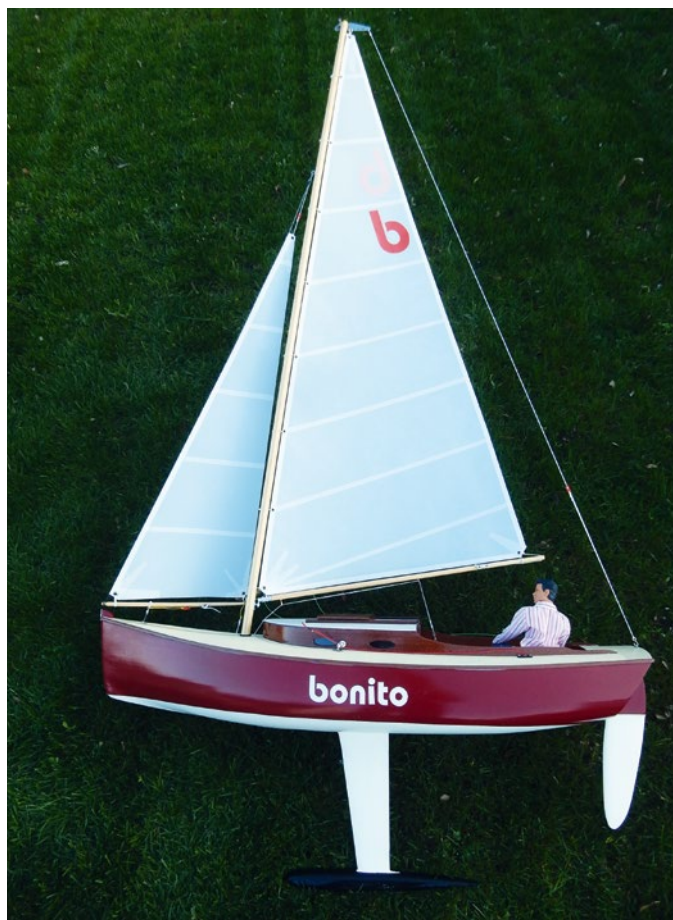
Das finale Kielschwert mit dem DF95-Ballast
