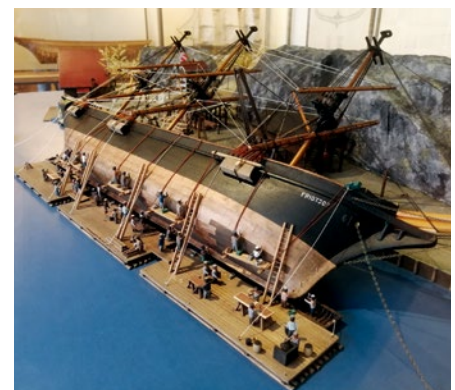
In diesem Diorama ist die FRIDTJOF für Reparaturarbeiten auf die Seite gelegt
