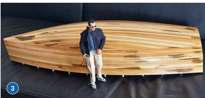
1) Mit Takelage und Anbauteilen ist das CAD-Modell komplett. 2) Mit einer transparenten Wasserfläche kann auch virtuell gesegelt werden. 3) Das Urmodell für die GFK-Form ist nicht mit Depron, sondern mit Leisten beplankt. 4) Uwe Kreckel mit seiner DRAGO auf der Messe in Friedrichshafen
