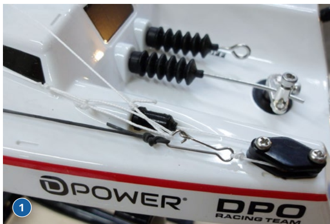
1) Die Schoten der Segel werden an einem Anglerhaken eingehängt. Nur die Vorschot war etwas zu kurz und musste mit einer Schlaufe verlängert werden. 2) Die Serviceöffnungen werden mit passenden Aufklebern abgedeckt
