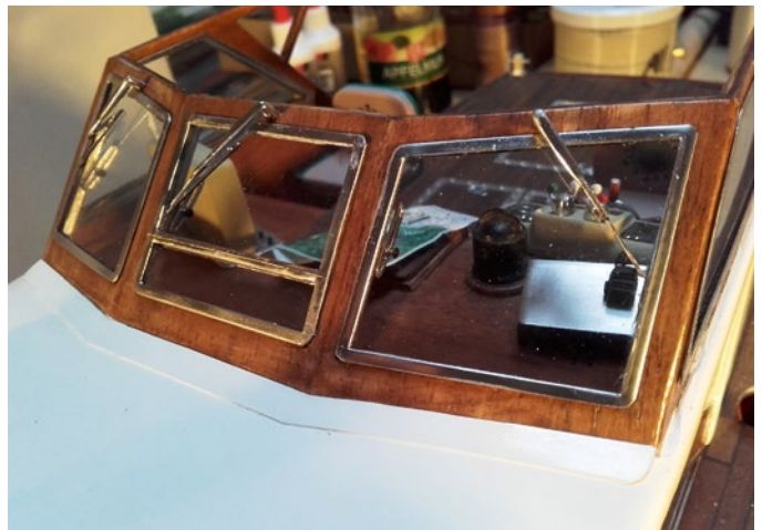
Die Fenster des Fahrstands wurden mit Ausstellern und Scheibenwischern versehen
