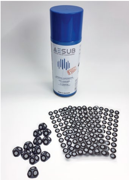
Nützliches Zubehör: Klebe-Dots, 3D-gedruckte Pyramiden mit aufgeklebten Dots und Spezialspray, um glänzende und dunkle Oberflächen scanbar zu machen
