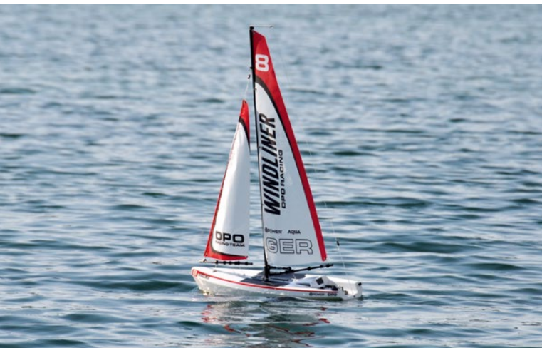
Aufgrund der schweren Akkus liegt das Testmodell etwas zu tief im Wasser
