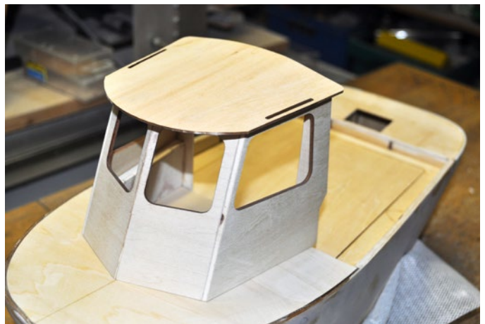
Das Dach ist montiert, und die Brücke steht ohne Spalt auf dem Deck
