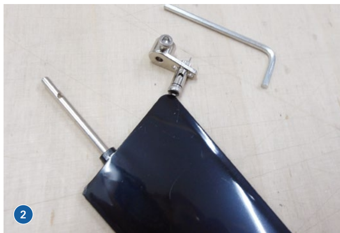
1) Mit dem Ballast ausgestattet, wird die Flosse im Rumpf angeschraubt. 2) Das Ruderblatt wird durch einen Metall-Anlenkhebel angesteuert. Der dafür notwendige Inbusschlüssel liegt dem Modell bei
