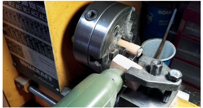
Der Reifen für das Steuerrad wurde in der Drehbank selbst angefertigt
