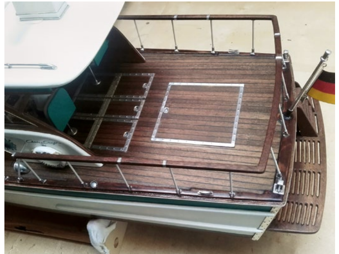
Nach dem Versiegeln des Handlaufs wurde er auf die Stützen geklebt
