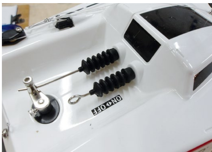
Sehr praktisch fällt die Schalterbetätigung vom Cockpit aus
