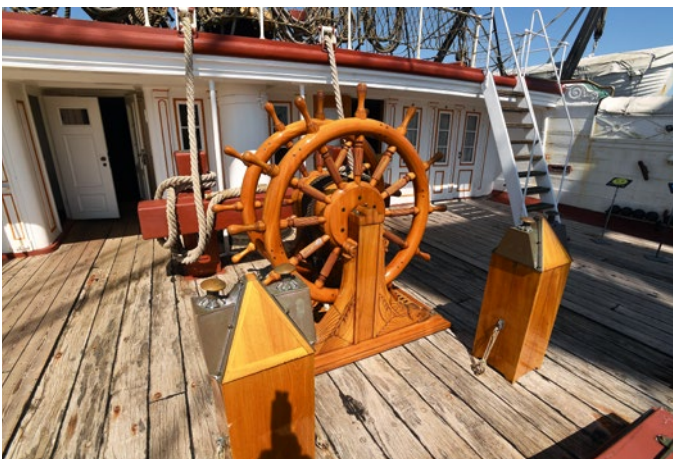
Die Steuerräder sind mit Seilen mit dem Ruder im Heck verbunden
