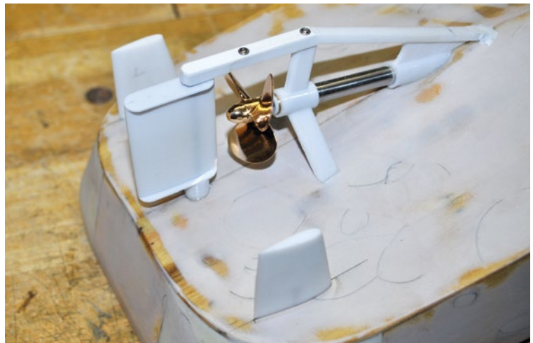
Das Stevenrohrlager und das Ruder sind Druckteile
