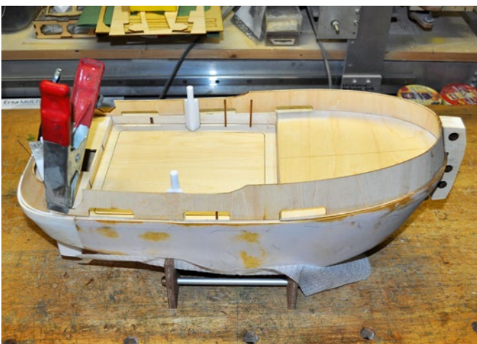
Das Schanzkleid wird an der Bugschulter und an den Pollern ausgerichtet
