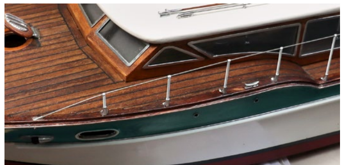
Das Drahtseil als Handlauf der vorderen Reling bildet einen perfekten Bogen
