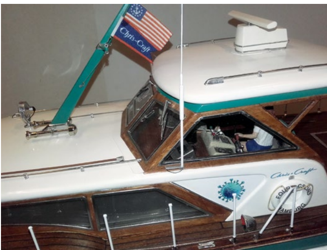
Zwischendurch wurde die abnehmbare Funkantenne montiert
