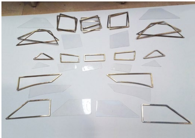
Die Fensterrahmen sind aus Messingprofilen gefertigt und mit Farbe verchromt
