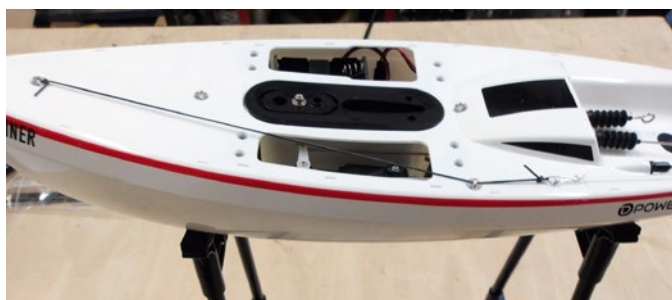
Der Rumpf ist schon vormontiert, nur die beiden Serviceöffnungen sind noch zu verschließen
