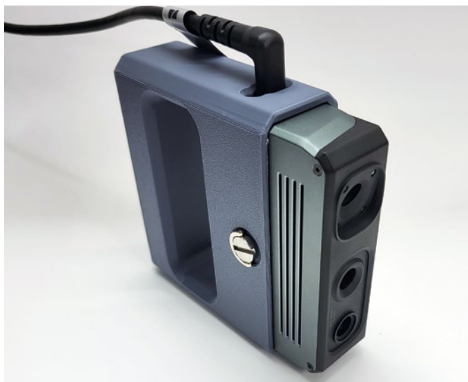
Der gedruckte Handhalter für den Scanner macht das Handhaben des Scanners komfortabel
