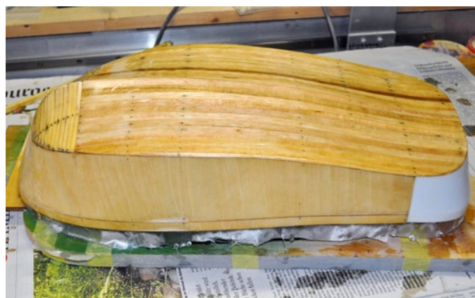
Von außen wurde jetzt die dünne GFK-Matte aufgelegt
