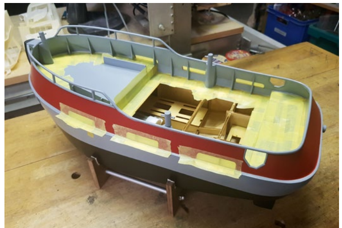
Für den weißen Anstrich muss das Schanzkleid umfangreich abgeklebt werden
