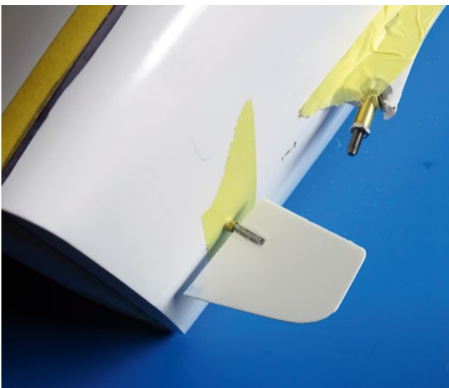
Das selbstgebaute Ruderblatt passt nun optimal zur Kontur des Rumpfs
