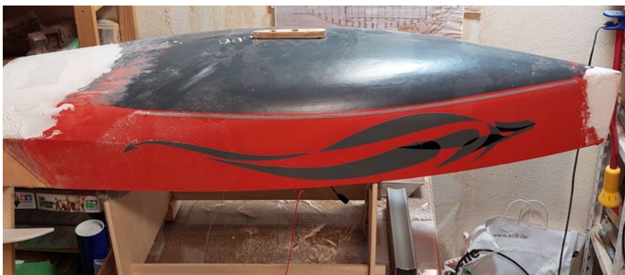
Das Boot erhielt einen modernen Wave-Piercing-Bug
