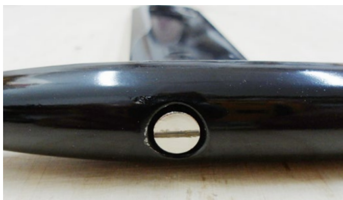
Der Ballast wird mit einer großen Hutmutter mit Schlitz an der Flosse befestigt
