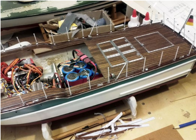
Nachdem sie gestrichen und verchromt sind, werden sie ins Deck eingesetzt
