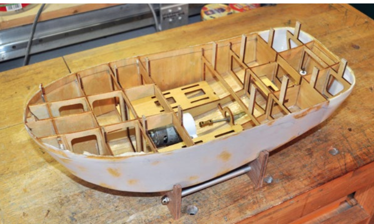
Der Innenraum wurde ebenfalls mehrfach mit Clou-Bootslack ausgepinselt
