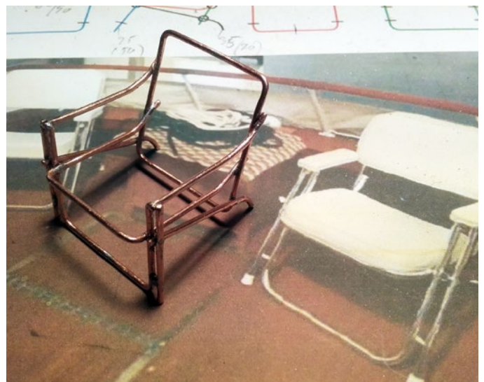
Das Gestell der Deckchairs wurde nach einem Foto aus Kupferdraht gebogen
