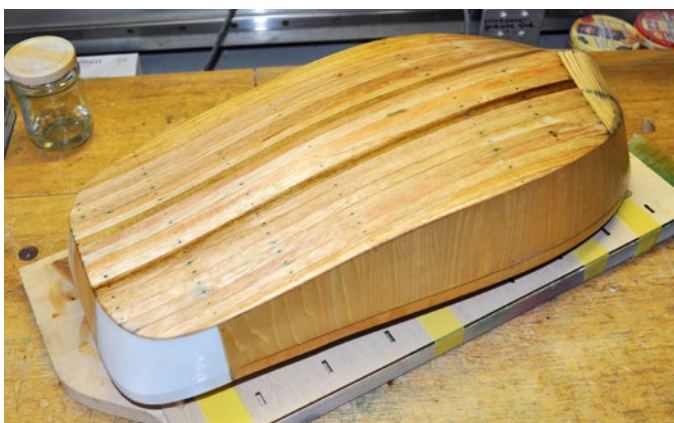
Der fertige Rumpf wird mehrmals mit Clou-Bootslack gestrichen
