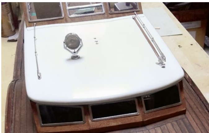
Der Suchscheinwerfer lässt sich mit einem Servo bewegen
