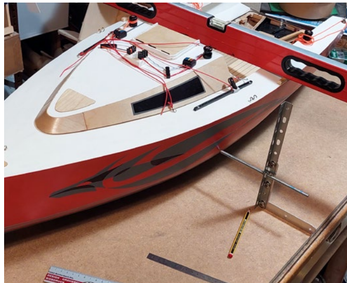
Für die CAD-Rumpferstellung muss das Modell abgetastet werden
