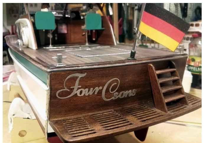
Der Schiffsname am Heck ist wiederum aus Vinylfolie geplottet
