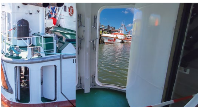
Die Rettungsöffnungen der HERMANN MARWEDE von außen und innen
