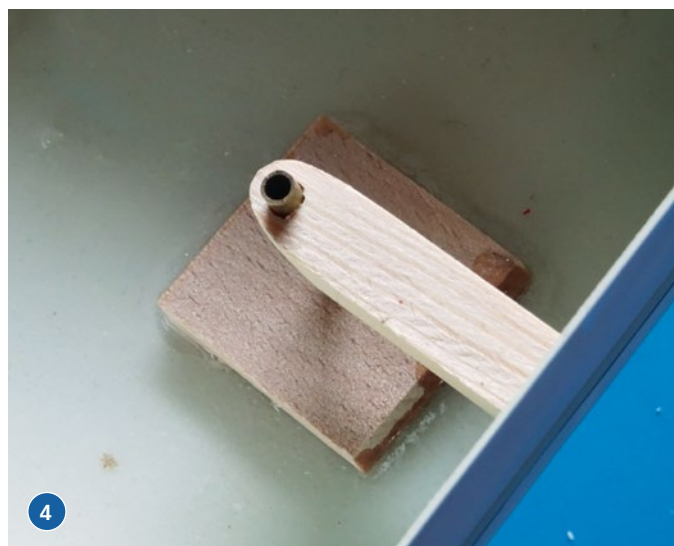
3) Die Länge des Ruderkokers wird durch die Rumpfhöhe vorgegeben. Es sollte über der Oberkante noch ausreichend Platz für die Anlenkung bleiben. Das quer über den Rumpf gelegte Holz dient der Kontrolle. 4) Dieses Kiefernholz dient der Abstützung des Ruderkokers zum Heckspiegel
