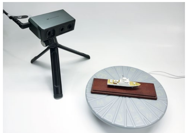
Das kleine Patrouillenboot wird im Table-Scan-Modus digitalisiert
