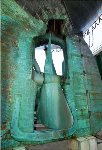
Der Propeller kann in den Rumpf gehievt werden, damit er beim Segeln nicht stört
