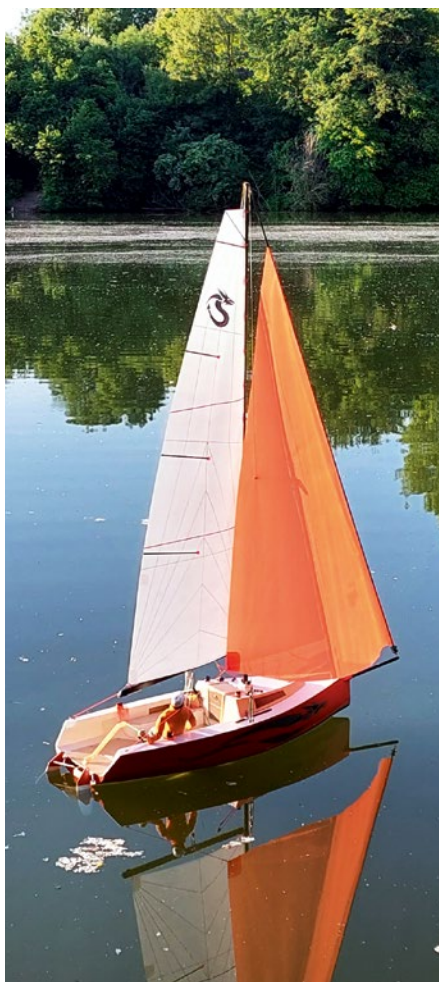
Am ausfahrbaren Bugspriet kann mit Genua gefahren werden
