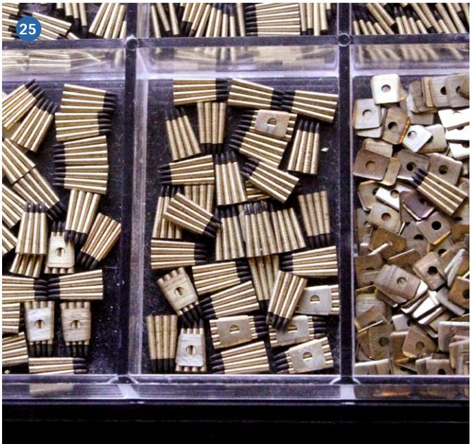
Abbildung 22) Wir sehen nur den Rohbau dieses Deckshauses. Weitgehend Messing, 0,3-mm-(kupferkaschiertes) Leiterplatten-Material, ein auf 0,4 mm Wandstärke leergedrehter Alu-Zylinder, HFM-Platte. Abbildung 23) etwa 600 vorgedrehte Granaten – Fließbandfertigung. Abbildung 24) Nur knapp 9 mm lange Granaten. Abbildung 25) Die Löcher in der Mitte der Bleche sind als „Einhängebohrungen“ nötig, damit diese in der Prägevorrichtung nicht verrutschen können
