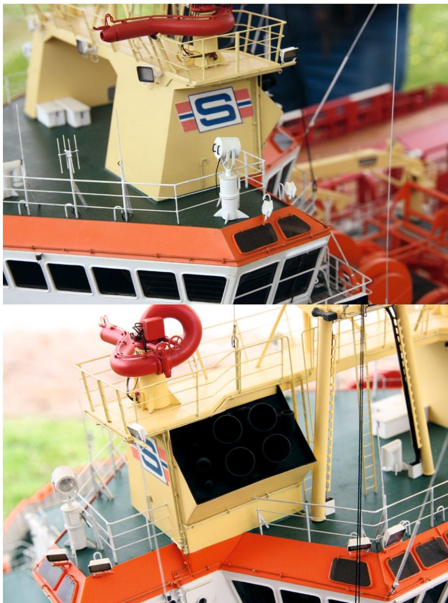
**Antennen, Scheinwerfer, Reling, Kabelstränge und vieles mehr entstanden aus Kupferdraht, Messing und/oder Polystrol. Der Schornstein wiederum aus Phosphorbronze, weil sich dieses ideal löten und problemlos mit anderen Teilen verbinden lässt**
