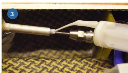
1) Der Rumpf FREYA sollte es sein. Er ist als Bulletproof-Version ausgeführt. 2) Die beiden Antriebswellen werden mit den präzisen Wellenkupplungen mit dem Flexwellen-Bogen und dem Zwischenlager verbunden. 3) Die Flexwelle sollte man in regelmäßigen Abständen ausbauen und gut schmieren. 4) Im Inneren des Rumpfs befindet sich genügend Platz für die nötigen Einbauten. 5) Bei zirka 40.000 Umdrehungen pro Minute würde es mit einem Kunststoff-Propeller schon schwierig werden
