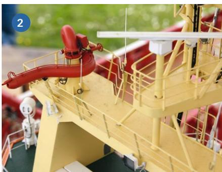
**1 + 2) Schornsteine, Rohrleitungen und Masttraverse sind asymmetrisch aufgebaut. Identisch hingegen sind die beiden mächtigen Löschmonitore. Im Modell entstanden sie aus Alu. Die Originale können aufgrund der Pumpenleistung über 7.200 Kubikmeter Wasser pro Stunde versprühen. 3) Unzählige Einzelteile bilden bei den Masten ein Ganzes. Leider setzte ein Tropfen Sekundenkleber das eigentlich drehbaren Radar fest**
