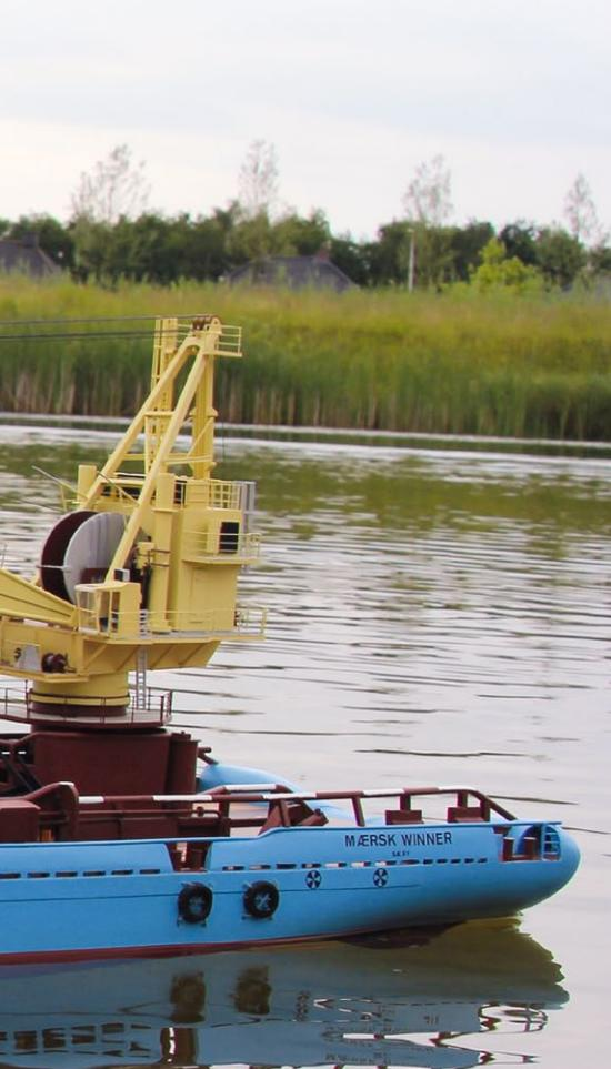
niert. Eine weitere Anforderung ist, dass die tonnenschwere Last zum Beispiel auf dem Meeresgrund vorsichtig abgesetzt werden muss. Da aber auf hoher See immer eine gewisse Dünung steht und das Schiff mit dem Kran sich auf und ab bewegt, muss die Last über das Hubwerk ausgependelt werden; dies wird über einen komplizierten hydraulischen Mechanismus realisiert (Heave Compensated). Der Kran kann in Wassertiefen bis 2.000 m arbeiten.
