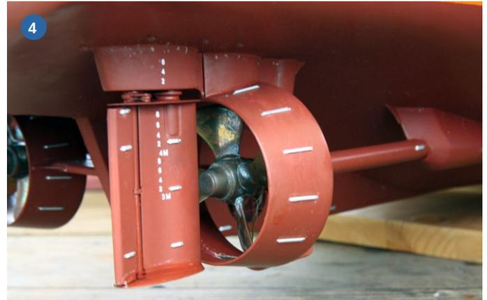
1) Aus Messing entstanden die Kortdüsen. 2) Schlingerkeile sind mit einer Sollbruchstelle versehen. 3) Wellen, Kortdüsen und Ruder sind in oder an Plexy-Teilen befestigt – der Rumpf entstand aus Polystyrol. 4) Markierungen, Anoden und eine vorbildgetreue Optik von Schiffsschraube sowie Rudermechanik sorgen für ein stimmiges Bild
