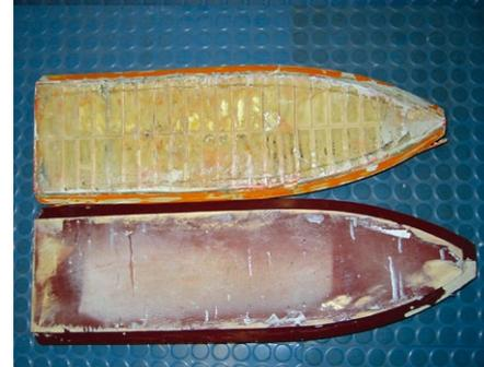
1) Eine überschaubare Anzahl an Details sichert eine zügige Fertigstellung eines Modells wie der MP 111 FRDC. 2) In Spantbauweise entstand der Rumpf. 3) Die Zwischenräume sind mit einem Bauschaum ausgefüllt, der hier bereist bis zur Kontur entfernt wurde. 4) Aus dem Negativ entstanden zwei GFK-Rumpfhälften als Positive. 5) Nach dem Spachteln und dem Einbau der beiden Jetantriebe nimmt der Rumpf Gestalt an
