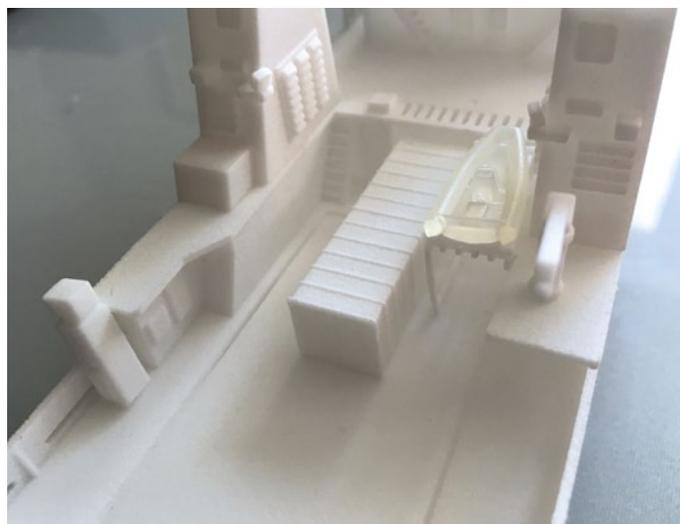
1) Montage des Beiboorthalters mittels einer Steckverbindung. Auch so etwas kann digital ausprobiert werden, bevor das Modell gedruckt wird 2) Hier der fertig installierte Beiboorthalter auf dem rohen gedruckten Deck
