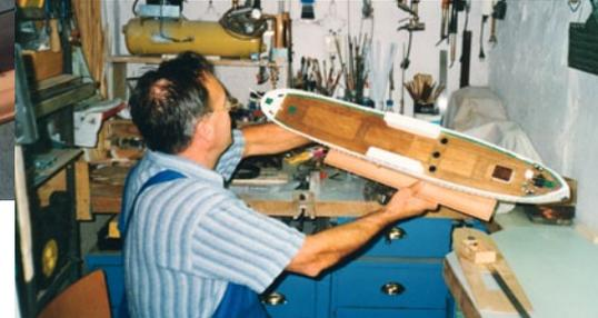
**Da zum Bau des Rumpfs keine Epoxydharze verwendet werden konnten, entstand der Rumpf in Holz-Papier-Leim-Mischbauweise**
