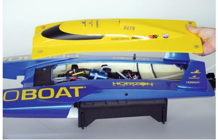
Mit vier Rändelschrauben lässt sich der große GFK-Deckel auf dem Rumpf befestigen
