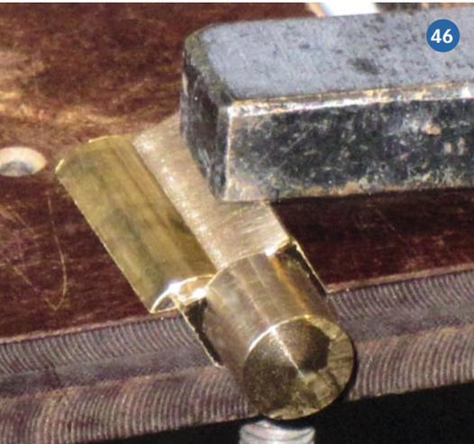
Das Prisma mit der Rundung wird zum Löten mit einer Reißnadel festgehalten
