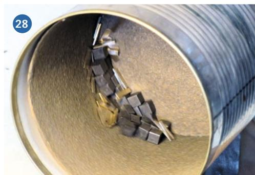
27) Exakter kann man die Teile anders nicht fertigen 28) Schon jahrelang im Gebrauch: meine Entgratungs-Trommel. Die Büchse hängt mit dem Boden an einem kleinen Getriebemotor
