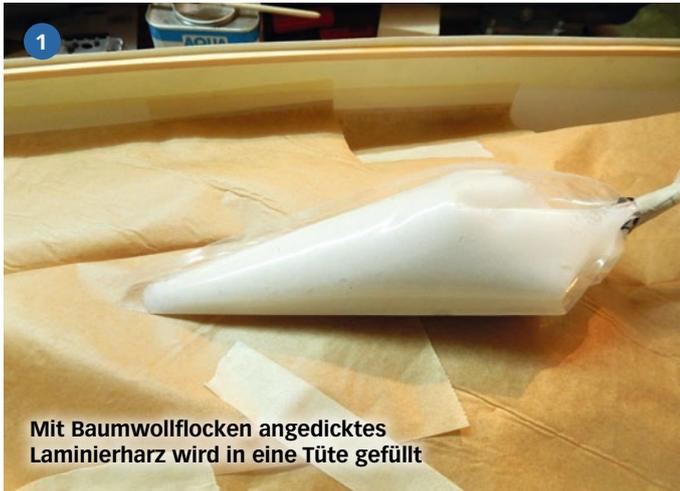
1 Mit Baumwollflocken angedicktes Laminierharz wird in eine Tüte gefüllt
