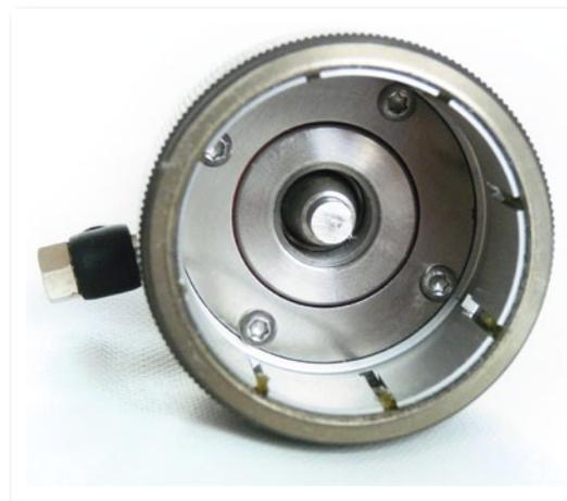
**Die Montage der WZW-Einheit erfolgt rasch am Außengewinde der HF-Spindel, wobei die Kraftübertragung über einen Morsekegel erfolgt, welcher spielfrei in sein Gegenstück der HF-Spindel gleitet**
