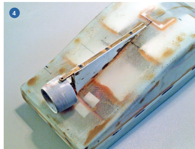
1) Ausgangsbasis waren diese Teile aus einer Ebay-Auktion. Am nicht verwendeten Aufbau lässt sich am deutlichsten erkennen, dass zahlreiche Teile neugebaut wurden. 2) Ein im Durchmesser passendes Plastikrohr aus dem Sanitärbedarf entpuppte sich als ideale Kortdüse. 3) Das Stevenrohr wird nach dem exakten Ausrichten eingekleidet. 4) Durch die Kortdüse ist eine gute Manövrierbarkeit gewährleistet, was dem Springer Tug beim Schleppen entgegenkommt
