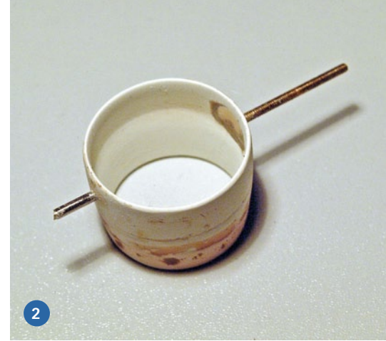
1) Ausgangsbasis waren diese Teile aus einer Ebay-Auktion. Am nicht verwendeten Aufbau lässt sich am deutlichsten erkennen, dass zahlreiche Teile neugebaut wurden. 2) Ein im Durchmesser passendes Plastikrohr aus dem Sanitärbedarf entpuppte sich als ideale Kortdüse. 3) Das Stevenrohr wird nach dem exakten Ausrichten eingekleidet. 4) Durch die Kortdüse ist eine gute Manövrierbarkeit gewährleistet, was dem Springer Tug beim Schleppen entgegenkommt
