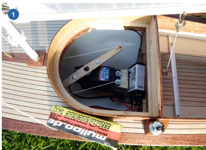
1) Das Segelverstellerservo in Standardgröße füllt die Kajüte fast vollständig aus. Ein kleiner Empfänger und Akku passen noch hinein. Gut zu sehen ist die Schotführung. 2) Die Großschot wird über einen Traveller zum Baum geführt
