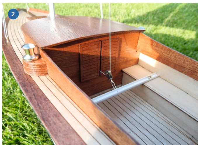
1) Das Segelverstellerservo in Standardgröße füllt die Kajüte fast vollständig aus. Ein kleiner Empfänger und Akku passen noch hinein. Gut zu sehen ist die Schotführung. 2) Die Großschot wird über einen Traveller zum Baum geführt
