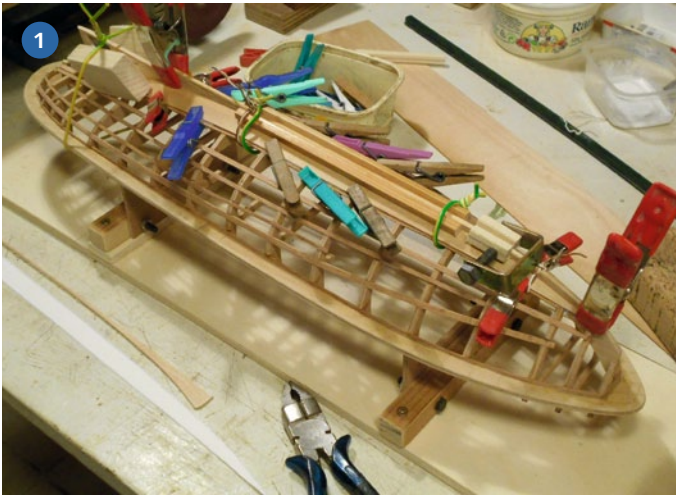
1) Die Beplankung wird Streifen für Streifen angepasst und aufgeleimt. Für jedes Teil wird zunächst eine Kartonschablone angefertigt und deren Kontur auf das Sperrholz übertragen. Das geschieht spiegelbildlich vom Kiel ausgehend. 2) Nach dem Beplanken wird die Außenhaut gespachtelt und rund geschliffen
