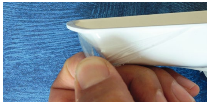
Vor dem Lackieren wird die Schutzfolie abgezogen. Es sei denn, man verklebt zuerst das Deck mit dem Rumpf und lackiert dann
