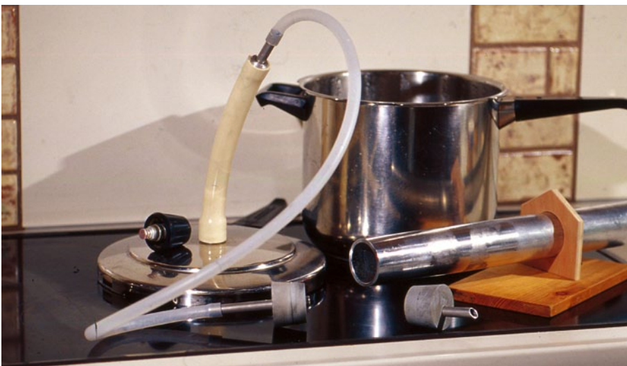
Wasserdampf aus dem Schnellkochtopf wird umgeleitet zum „Leistenkocher“. Zu erkennen sind das sicher gelagerte Hauptrohr, in dem die Holzleisten eingeschoben werden, und die Verbindung über Silikonschläuche sowie Aluröhrchen und Gummistopfen
