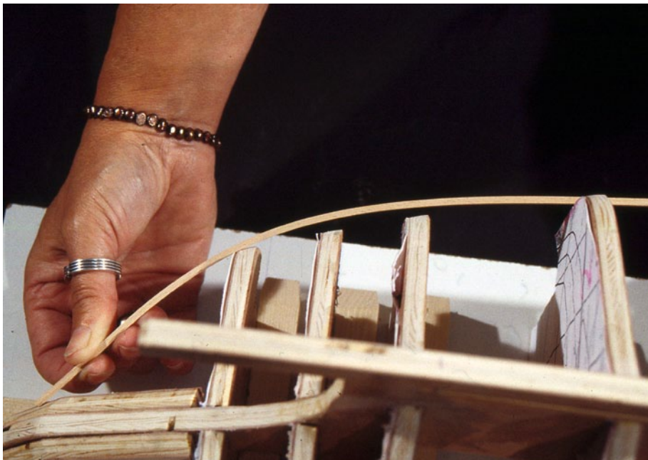
Ganz wichtig vor dem Beplanken mit Leisten ist das Straken der Spanten, damit später auch eine gute Auflage der Leisten gewährleistet ist
