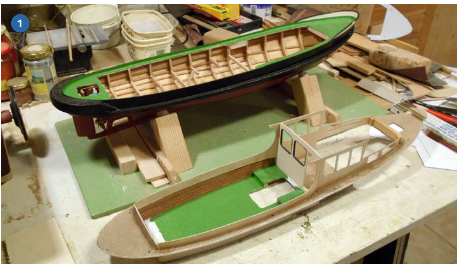
1) Aufbauten und Deck sind als ein Teil ausgeführt und damit als Ganzes abnehmbar. 2) Da die Fenster recht groß sind und einen Blick aufs Innere gewähren, erhielt das Ruderhaus eine Einrichtung
