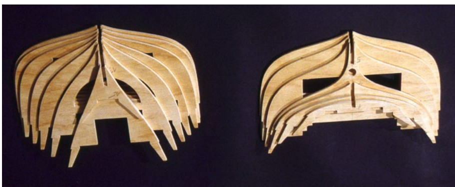
Der Blick auf die gestapelten Spanten verdeutlicht, dass die bauchigen inneren Spanten mehr Auflagefläche (Stirnfläche) für die Beplankungsleisten haben als die vorderen und hinteren. Das erfordert ein gezieltes Verjüngen der Beplankungsleisten
