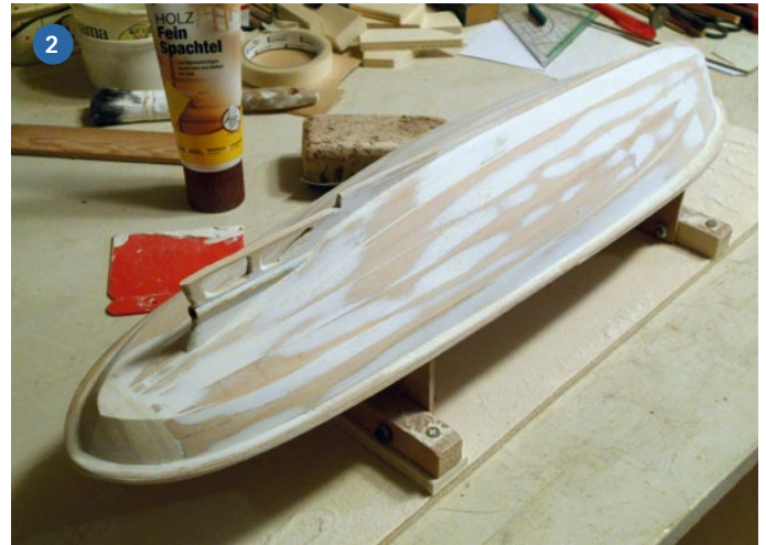
1) Die Beplankung wird Streifen für Streifen angepasst und aufgeleimt. Für jedes Teil wird zunächst eine Kartonschablone angefertigt und deren Kontur auf das Sperrholz übertragen. Das geschieht spiegelbildlich vom Kiel ausgehend. 2) Nach dem Beplanken wird die Außenhaut gespachtelt und rund geschliffen
