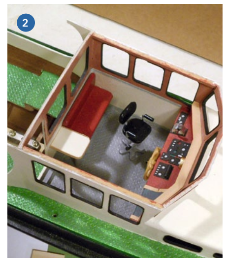
1) Aufbauten und Deck sind als ein Teil ausgeführt und damit als Ganzes abnehmbar. 2) Da die Fenster recht groß sind und einen Blick aufs Innere gewähren, erhielt das Ruderhaus eine Einrichtung
