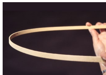
Um so enge Radien bei einer Holzleiste zu erzielen, ohne dass diese bricht, sind entweder spezielle Biegehölzer zu verwenden oder man muss die Leiste „abkochen“
