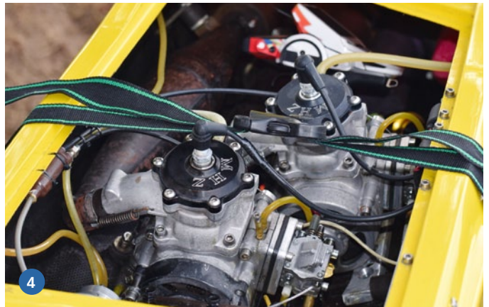
1) Das Offshore Rennboot OSV 180 von Isamtec mit einer JetCat SPM5 an Bord zeigte absolut sichere Fahreigenschaften auf dem Neckar. 2) Zwei JetCat SPM5 Turbinen sorgen für den Vorschub der MYSTIC. 3) Die vier Zylinder sind ein absoluter Blickfang in der MUSCLE ZNETIX. 4) Zwei MHZ Blata-Motoren mit je 50 Kubikzentimeter Hubraum in einem Modell sind eine absolute Rarität und eben fast nur auf solchen Treffen wie in Heilbronn zu sehen
