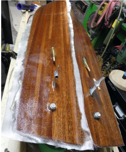
Eine Lage Gewebe mit Epoxydharz getränkt sorgt für absolute Dichtigkeit und steigert die Festigkeit extrem
