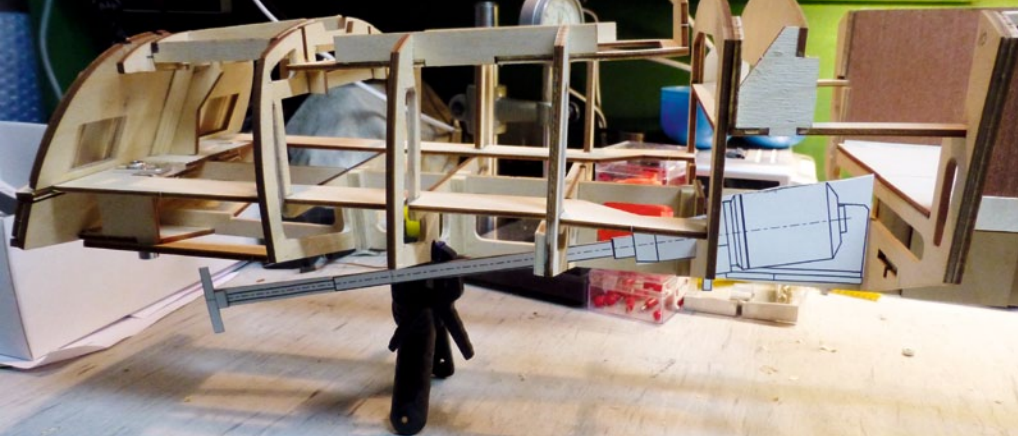
Das Spantengerüst ist soweit fertiggestellt, dass die Planung und Umsetzung des Motoreinbaus erfolgen kann
