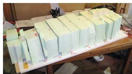
In konventioneller Spantenbauweise entstand der Rumpf. Die Zwischenräume sind mit Styrodur ausgefüllt
