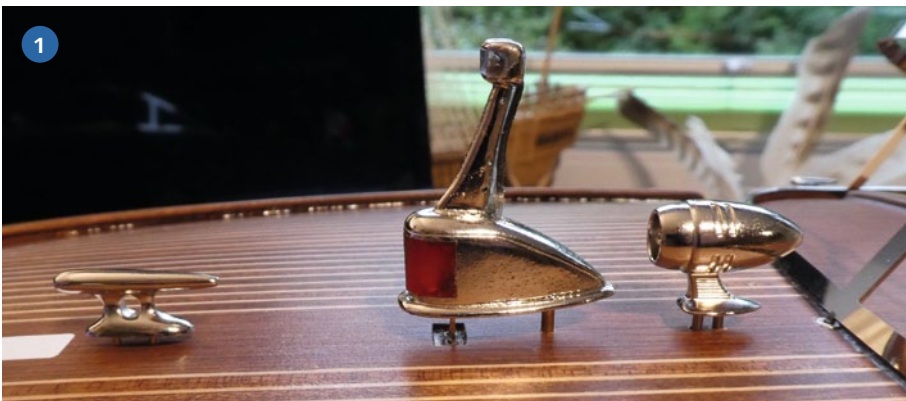
1) Sowohl die wenigen, aus dem Baukasten verwendeten, als auch die in Eigenarbeit erstellten Beschlagteile sind verstiftet und dann festgeklebt. 2) Über viele Beschlagteile verfügt die RIVA nicht, doch die wenigen müssen aufgrund des Maßstabs einfach perfekt sein, wie hier der Suchscheinwerfer
