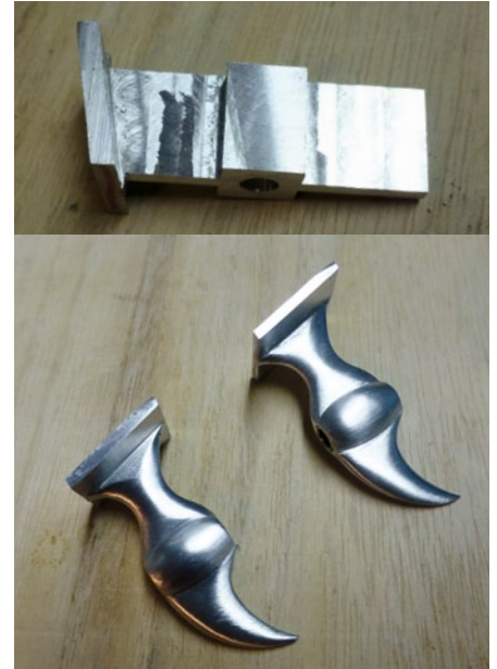
Links ein Rohbauteil für das Wellenlager und rechts die fertig geschliffenen Stützen
