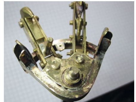
Um die Schleppvorrichtung funktionsfähig zu gestalten, kam Messing zum Einsatz
