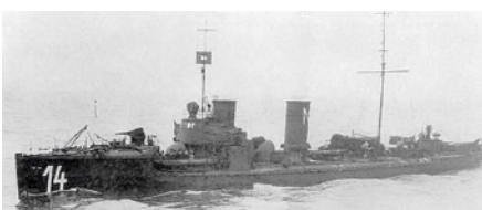
S 14, die Brücke ist flacher, die Lüfter nach hinten geschwenkt (S steht für Werft Schichau)
