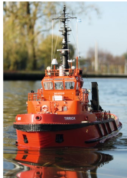
Bemerkenswert ist die Wendigkeit von TIRRICK – diese verdankt sie den eingebauten Voith Schneider-Antrieben
