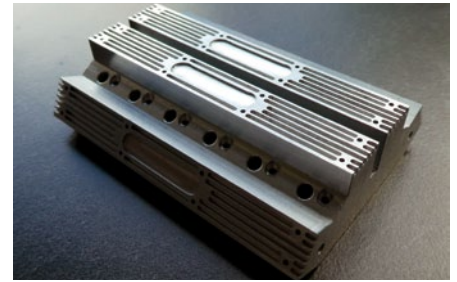
Optisches Highlight der RIVA AQUARAMA Lamborghini ist der Motor. Der Zylinderkopf entstand aus einem selbst gefrästen Alu-Block
