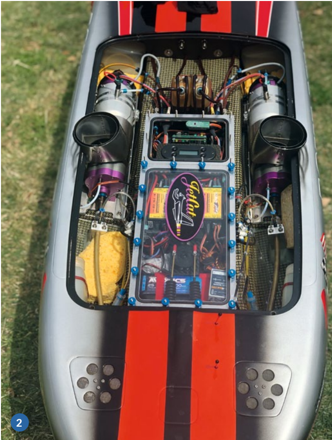
1) Das Offshore Rennboot OSV 180 von Isamtec mit einer JetCat SPM5 an Bord zeigte absolut sichere Fahreigenschaften auf dem Neckar. 2) Zwei JetCat SPM5 Turbinen sorgen für den Vorschub der MYSTIC. 3) Die vier Zylinder sind ein absoluter Blickfang in der MUSCLE ZNETIX. 4) Zwei MHZ Blata-Motoren mit je 50 Kubikzentimeter Hubraum in einem Modell sind eine absolute Rarität und eben fast nur auf solchen Treffen wie in Heilbronn zu sehen
