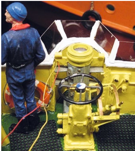
Oben auf dem Steuerstand sind sogar die Steuerkulissen für die Antriebe mechanisch gekoppelt und bewegen sich mit
