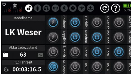
Der Zustand der Schaltfunktionen wird farbig gekennzeichnet
