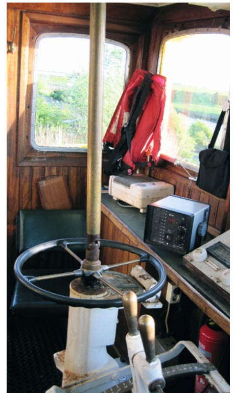
Das Steuer auf der Brücke und auf dem oberen Steuerstand sind beim Original über eine Welle verbunden – so auch im Modell
