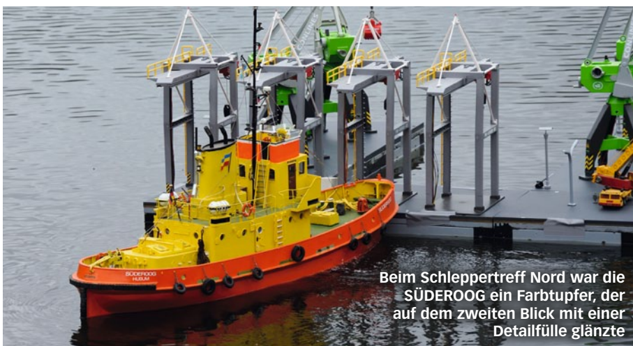
Im Wasser macht sich die mögliche Wendigkeit durch die Voith Schneider-Antriebe bemerkbar
