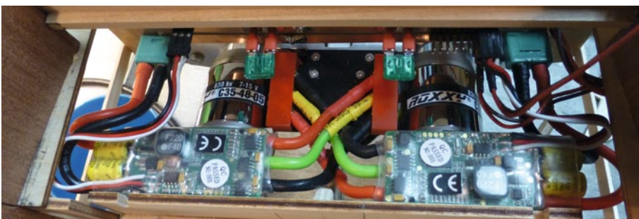
Kurze Kabel vom Motor zum Regler reduzieren Verluste und Störungen, zudem ist alles schön übersichtlich
