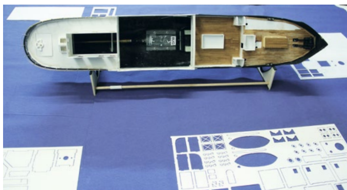
Vereinfacht wird der Bau dank der zahlreichen Frästeile aus Polystyrol. Zu erkennen ist auch die abschnittsweise Holzbeplankung
