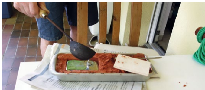
Guss des Gewichts für die Bilge – das darf nicht fehlen
