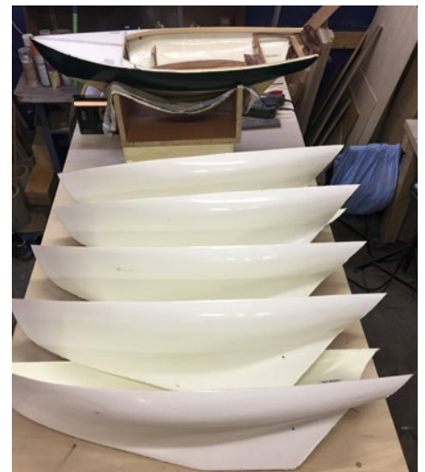
Die Urform wird komplettiert, sodass die Form daraus entsteht, aus der dann die Rümpfe abgezogen werden können
