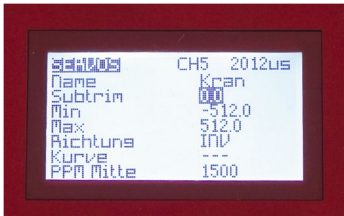
Das Setup einer Funktion erfolgt in den Menüs „Mischer“, „Kurven“ und „Servos“, die alle übersichtlich gehalten sind
