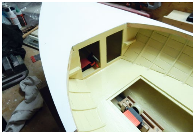
Der Akku ist durch eine Luke im vorderen Schott erreichbar. Hier ist das Deck schon aufgeklebt
