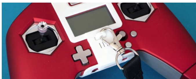
1) Ein nützliches Zubehör ist das weiße Plastikteil (Bracelite), um am Sender einen Gurt befestigen zu können. 2) Von FrSky gibt es eine Fülle an Empfängern, hier eine leichte, kleine Sechskanal-Version mit Doppelantennen. Zu prüfen ist immer, ob Sender und Empfänger aufgrund des gewählten Übertragungsprotokolls kompatibel sind
