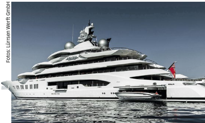
Die aufgeklappte Tendergarage der Backboard-Seite mit einem Tender am Traversenlift
