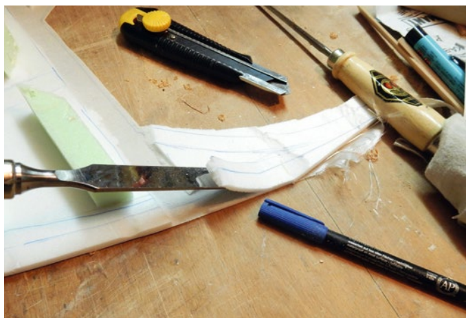
Das Deck ist auf Selitron laminiert, das abgeschält werden muss, um auf dem Unterbau nicht zu dick aufzutragen
