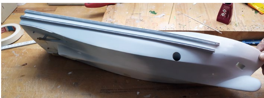
Die Fenderleisten schützen das Modell bei Zusammenstößen
