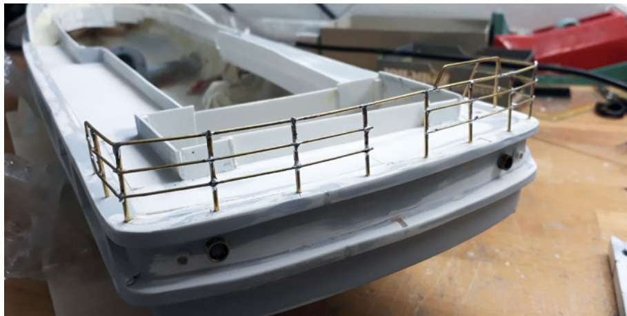
Die Reling auf dem ganzen Schiff wurde aus 1-mm und 0,8-mm-starken Messingdrähten gebogen und anschließend verlötet
