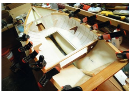
Viele Klammern halten den Deckstringer beim Verkleben in Position
