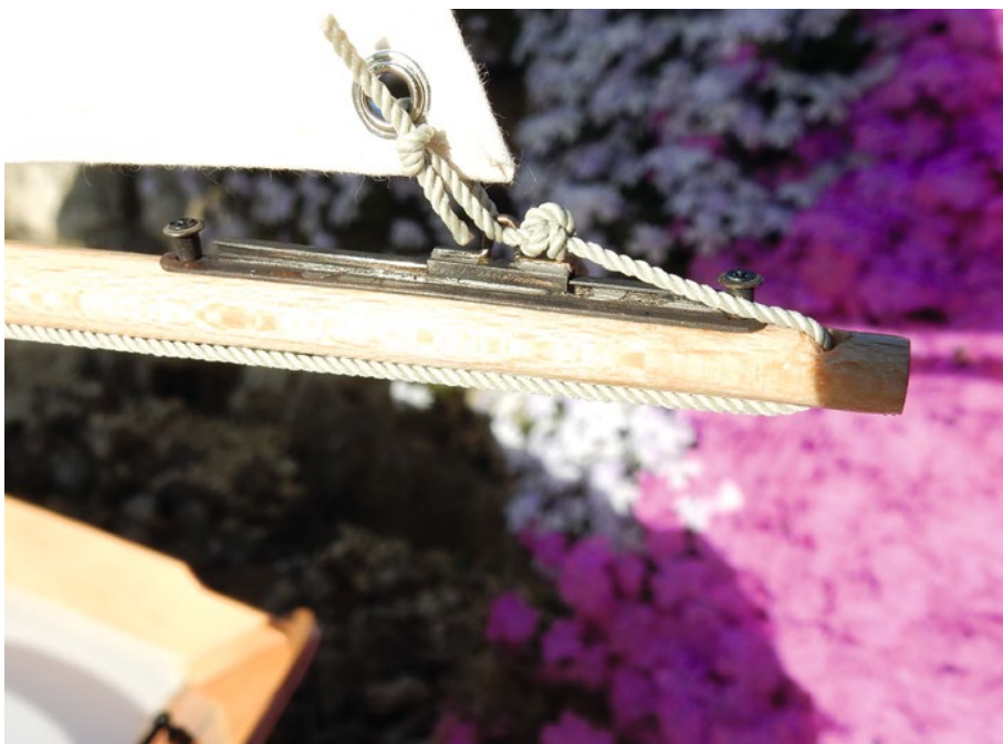
Zur Einstellung der Unterliekspannung ist eine Schiene am Baum installiert
