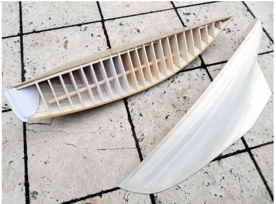
22 Halbspanten mussten zweimal hergestellt werden, um zusammen mit den Trennebenen das Gerüst der Urform zu ergeben, die nach dem Beplanken geteilt werden kann
