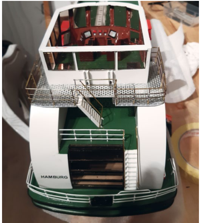
Die Treppen selbst entstanden aus selbstgezeichneten Wangen und Trittböden, die ein schönes, aber wackeliges Ergebnis hervorbrachte. Die Montage der Treppen in den vorgesehenen Bereichen stabilisierte diese aber zusehends
