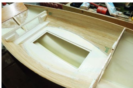
Die Spanten und Böden werden außerhalb des Rumpfes zusammengebaut, bevor sie an Ort und Stelle eingearzt werden
