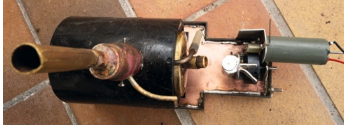
Nach ersten Fahrten die Abdampf-Führung geändert. Ein Kupferfitting aus dem Baumarkt passte perfekt auf den Abzug des Kessels. Dieser führt über einen Adapter in ein Messingrohr. Alles wurde mit Silberlot verbunden
