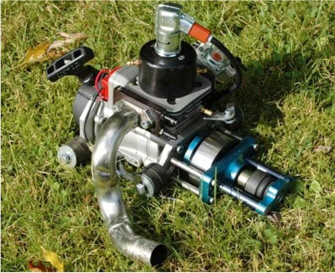
Der Zenaoh G290 mit der MHZ-Fliehkraftkupplung
