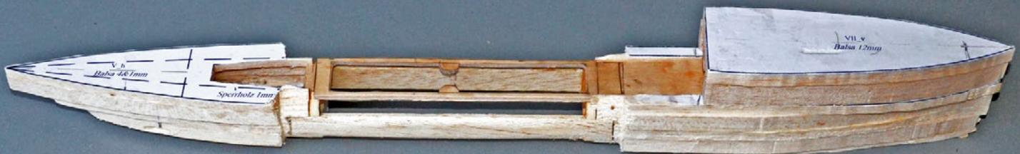
Das Rohmodell vor der Abdeckung des Mittelteils. Gut zu erkennen sind die beiden Spanten und die beiden, breiten Stringer
