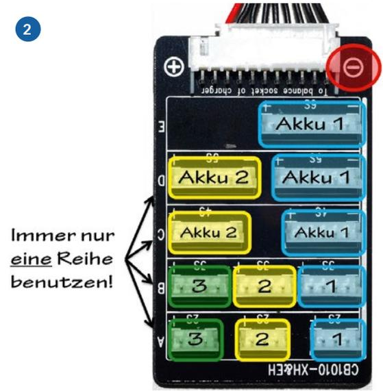
1) Bringen Sie unbedingt Kennzeichnungen an, damit die LiPos in der richtigen Reihenfolge an das Ladekabel angeschlossen werden. 2) In dieser Reihenfolge müssen die Akkus an die Balancerplatine angeschlossen werden. Akku 1 ist immer derjenige, dessen Minuspol mit dem Minus-Anschluss des Ladegeräts verbunden wird
