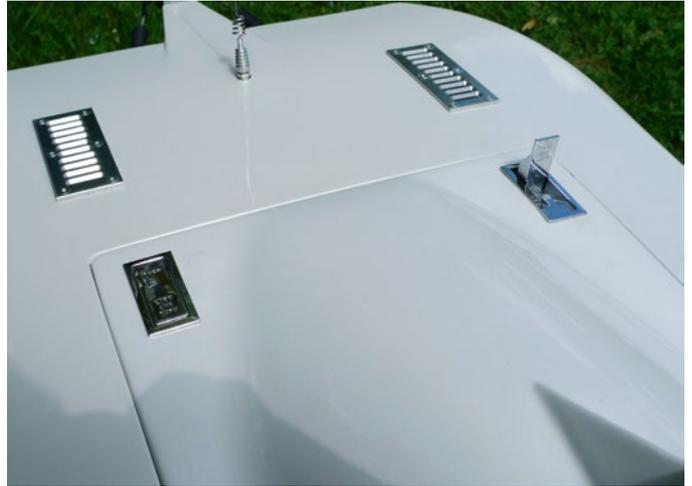
Die Hauberverschlüsse ermöglichen ein schnelles und sicheres Öffnen und Schließen des Modells
