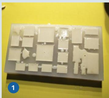
1) Ist die Gießform aus Silikon erst einmal erstellt, kann mit dieser bedarfsgerecht die erforderliche Menge an Teilen aus Resin gegossen werden. 2) Das fertige Resinusstück hat eine sehr hohe Oberflächengüte und ist nach einer kurzen Reinigung vom Trennwachs lackierfähig
