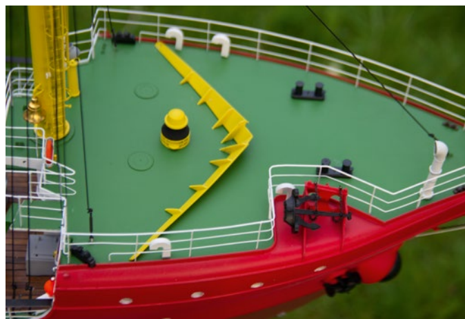
Augenfällig ist der Wellenabweiser, aber markant ist der Buganker samt Befestigung
