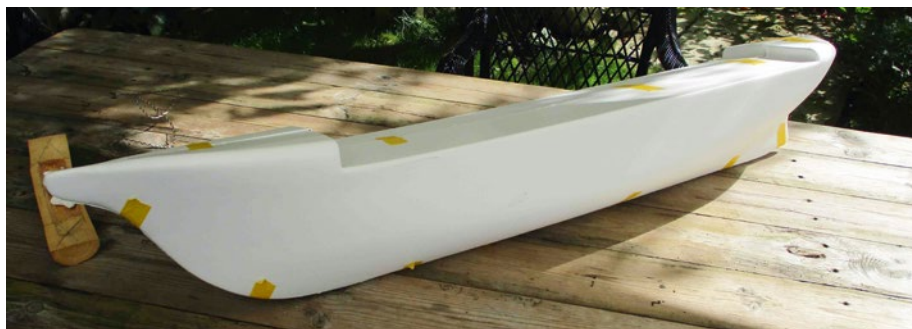
Eigenbauten auf Basis eines tiefgezogenen Rumpfs sind selten, aber das bot sich bei diesem Modell an
