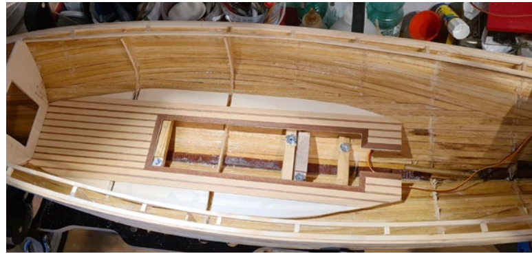
Bei der Befestigungsmethode von Kessel und Maschine wird darauf geachtet, dass sich beide zu Wartungszwecken leicht entnehmen lassen
