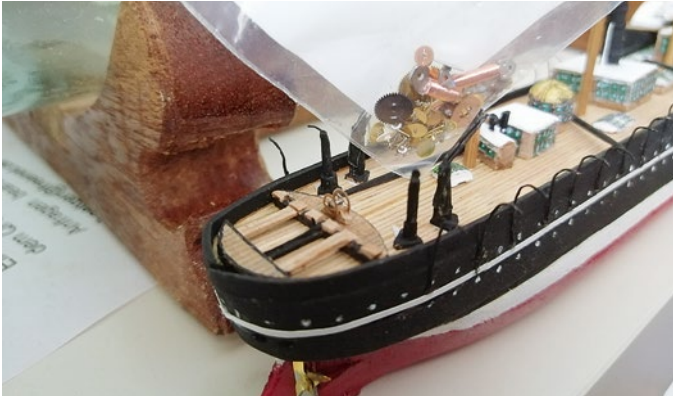
Zahnräder aus Armbanduhren dienen als Steuerräder
