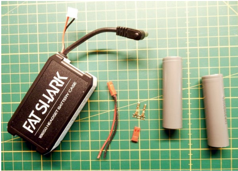
Alle Zutaten zum Seglerglück auf einen Blick. Wer keine Crimpzange hat, greift zu fertigen BEC-Kabeln, die dann einfach an die Kabel der Box gelötet werden
