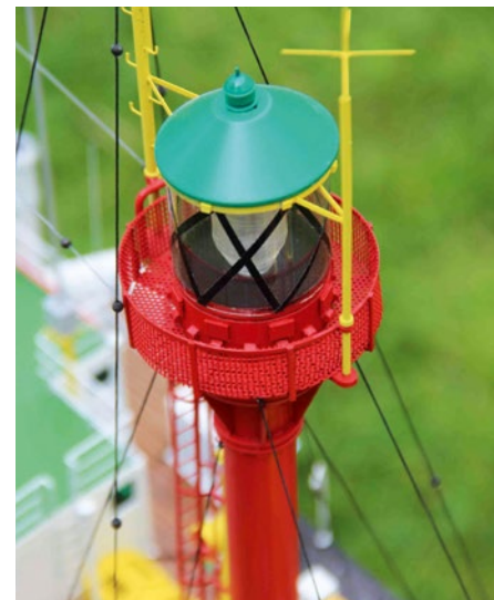
Herzstück des Leuchtfeuers ist die geschliffene Fresnelleuchte im Inneren
