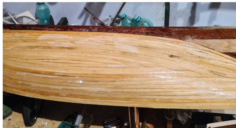
Der lackierte, leicht kantige Rumpf soll an die Originalreue erinnern, die nie aalglatt aussahen
