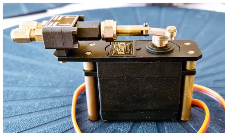
Zur direkten Ventilsteuerung kommt ein Servo mit hoher Stellkraft zum Einsatz
