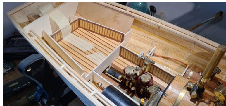
Beim Innenausbau kommen Pappe und Papier für die Erstellung des Bodens und die Feinabstimmung zum Einsatz
