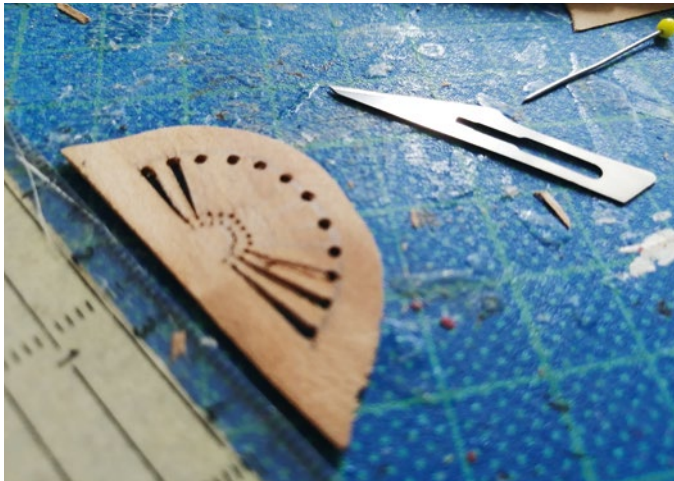
Mit dem Skalpell wurden die Schlitze der Schaufelradkästen ausgestochen
