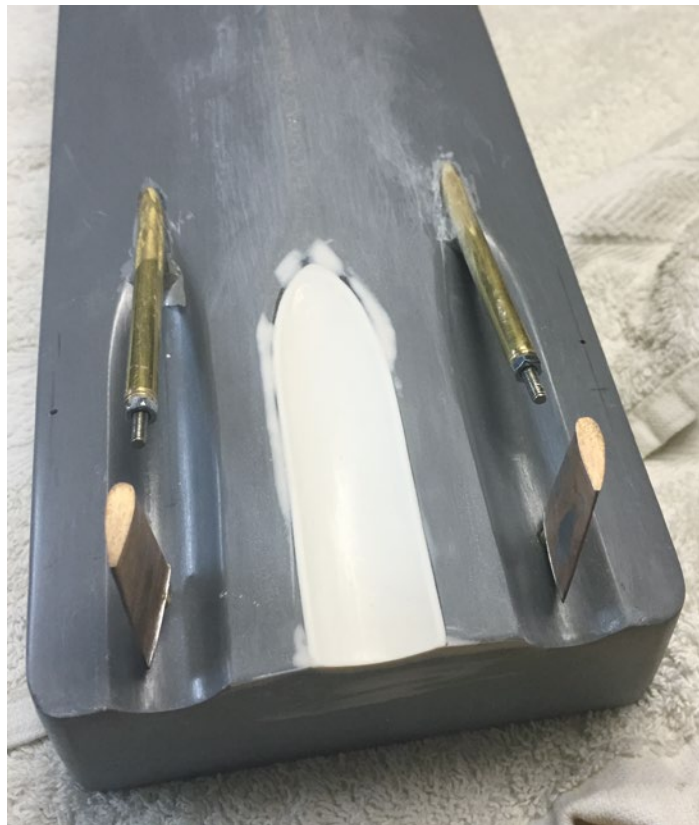
Realisieren eines dritten Wellentunnels am GFK-Rumpf. Im späteren Fahrbetrieb sind aber nur die äußeren Propeller angetrieben
