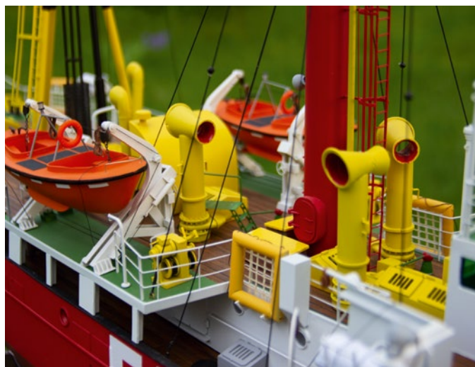
Alle Lüfter sind wie die Davits oder Beiboote vorwiegend aus Polystyrol im Eigenbau entstanden
