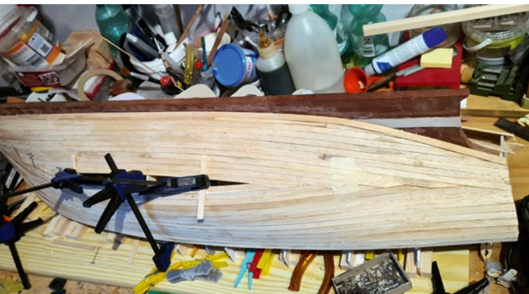
Die Beplankung erfolgte mit Abachi-Leisten, die exakt einzusetzen waren
