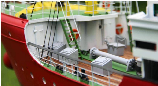
Stau- und Seekästen sind übers ganze Schiff verteilt und entstanden aus Polystyrol
