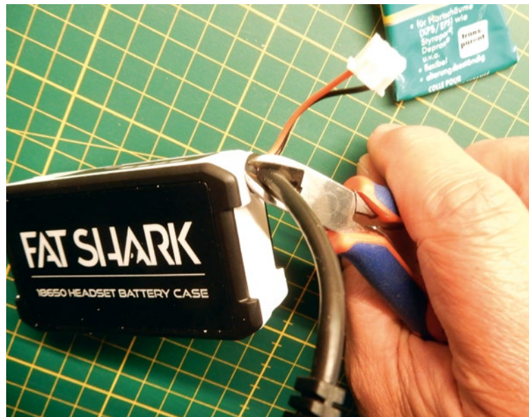
Zuerst wird das dicke Kabel der Fat Shark-Akkubox direkt an der Gummithülle abgezwickelt. Wichtig: Einen scharfen Seitenschneider benutzen, damit die Adern sauber durchtrennt werden und keinen Kurzschluss bilden
