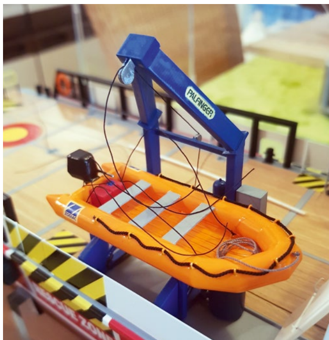
Das für solche Schiffe typische „Baukasten“-Prinzip half beim Konstruieren und Bauen von Standard-Elementen wie dem Davit und Schlauchboot
