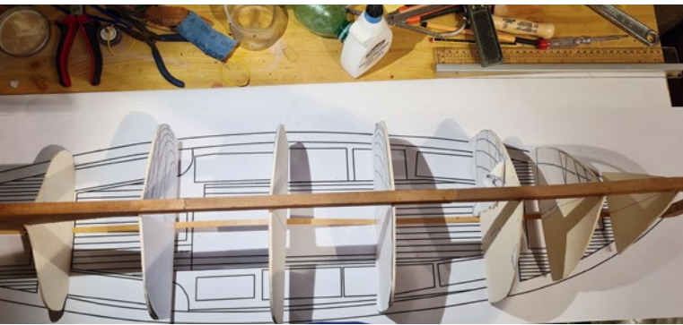
Der Kiel besteht aus mehreren verdübelten Mahagoni-Teilen
