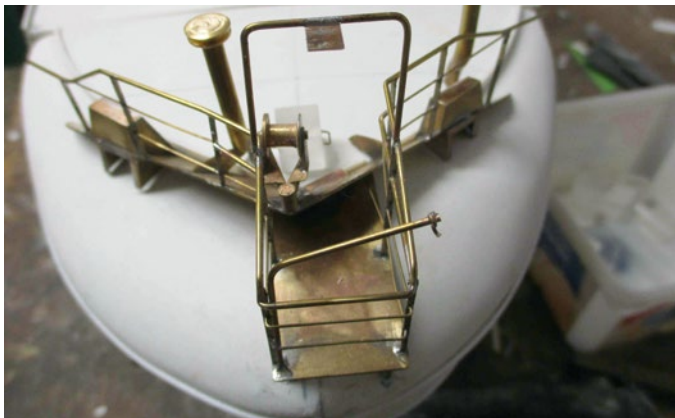
Vorteil der Messingbauweise ist, das komplette Stück fürs Lackieren demontieren zu können
