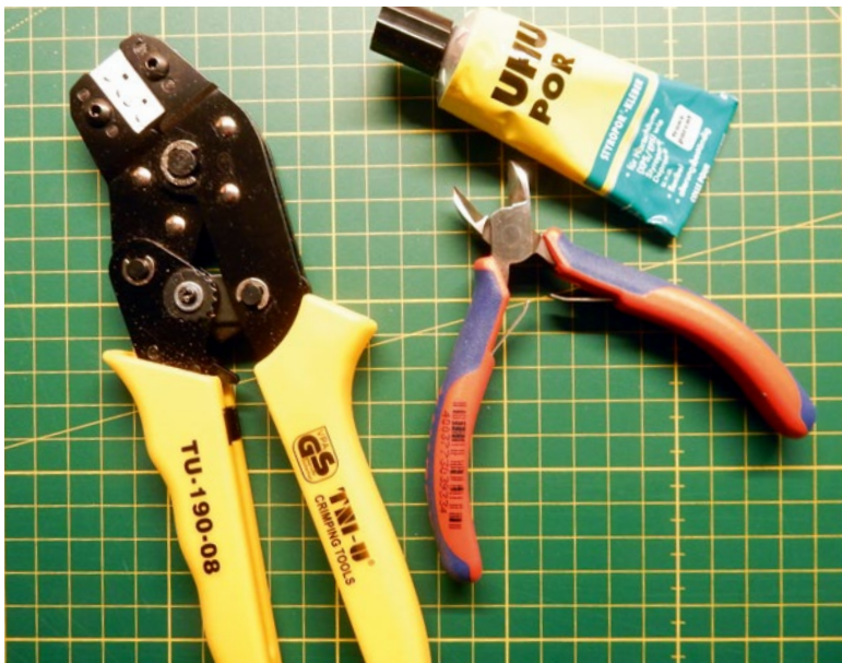
Viel Werkzeug wird nicht benötigt. Die Crimpzange kann ich nur jedem empfehlen, der gerne Servokabel und BEC-Kabel selbst konfektioniert
