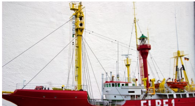
Obwohl der mittige Mast das Typschiff prägt, ist doch der Vormast mit Resonanzkörper das eigentlich aufwendigere Teil
