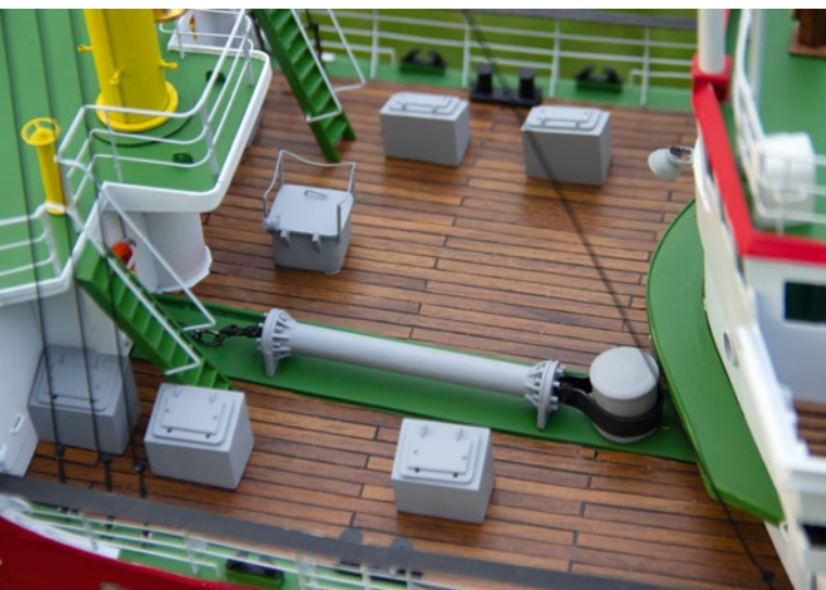
Typisch für dieses Arbeitsschiff ist die Holzbeplankung auf dem Arbeitsdeck
