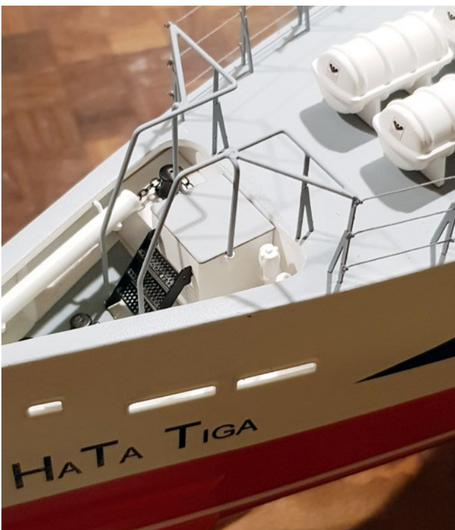
Bemerkenswert für die HATA TIGA ist der Niedergang zum Bugbereich mit Fallrohr, Winde und Ankerkettenkasten
