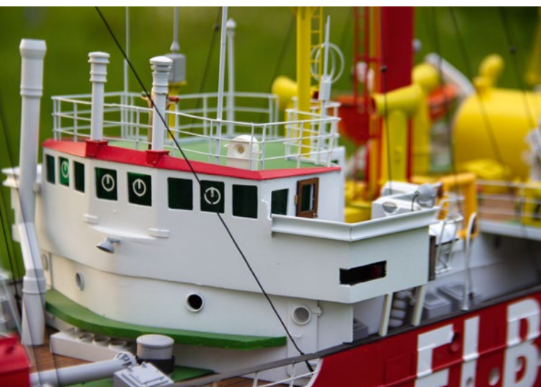
Das Brückenhaus entstand aus Polystyrol und wurde in einem Stück gebaut
