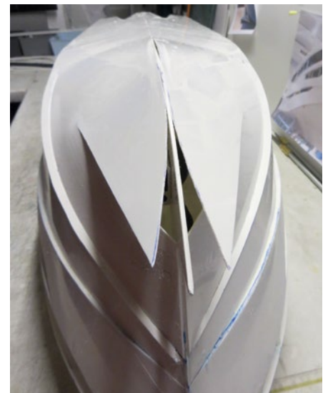
Das Grundgerüst der Bugnase besteht aus einer einzelnen Platte
