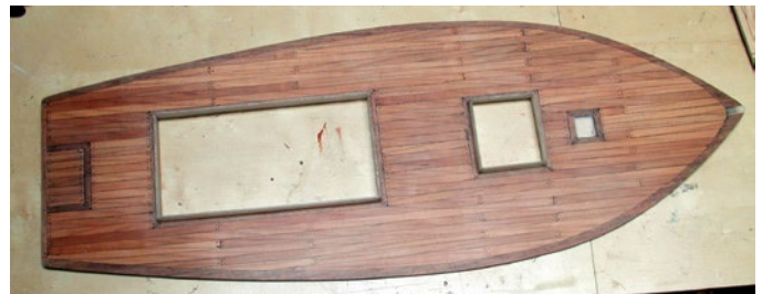
Das erste selbstgebaute, gealterte und mattierte Holzdeck
