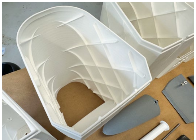
Die kreuzweisen Stringer versteifen die Rumpfschale und sind konstruktiv einfache Schnitte in den Volumenkörper des Rumpfssegmentes
