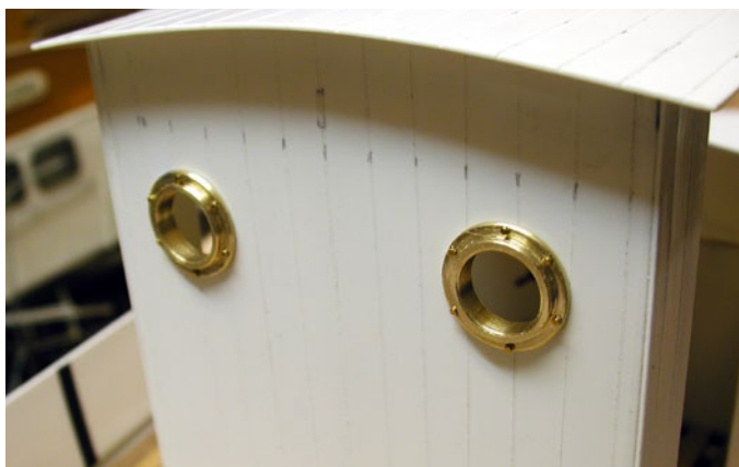
Die achteren Bullaugen sind aus Messing gedreht und mit Sechskantschrauben versehen
