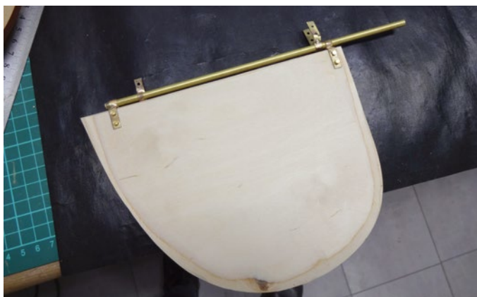
Das riesige Ruder wird mit Messingbeschlägen am Rumpf befestigt
