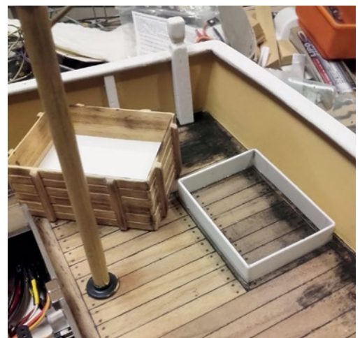
Die Ruderabdeckung erhielt nachträglich einen Süllrand, der mit einer Kiste kaschiert wird
