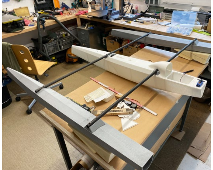
Die Rümpfe wurden mit 16-mm-Karbonrohren als Beams verbunden
