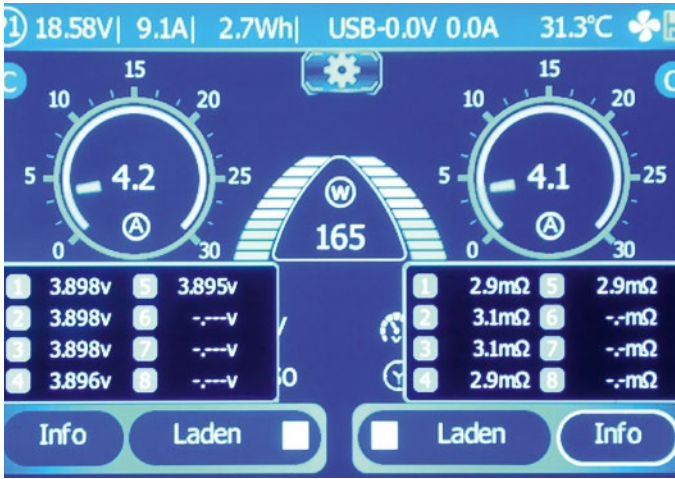
Beim Laden werden die wichtigsten Parameter übersichtlich visualisiert, dazu gehört auch die Anzeige der Innenwiderstände
