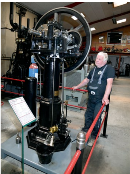
Der atmosphärischer Gasmotor von Otto und Langen, den Gründern von Deutz
