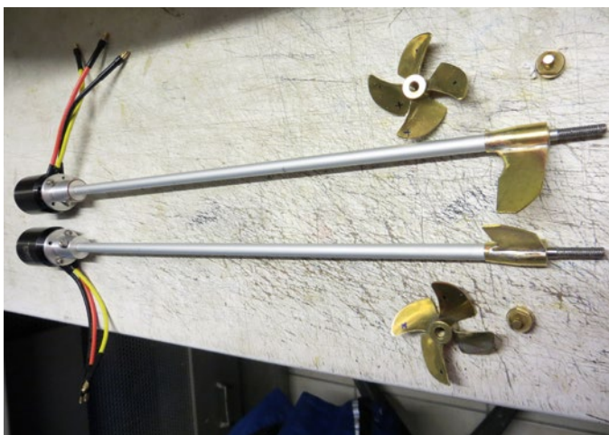
Die selbstgebauten Wellenanlagen mit den direkt angeflanschten Brushless-Außenläufern
