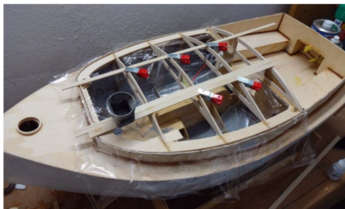
Um beim Beplanken des Kajütdachs das Festkleben zu verhindern, wird Frischhaltefolie dazwischen gelegt
