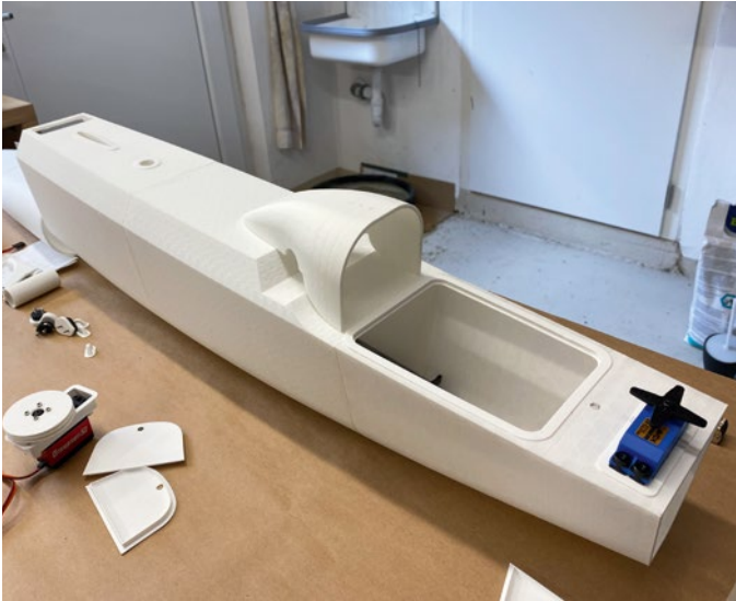
Der erste MOD40 im 3D-Druck entsteht aus LW-PLA mit 5 mm Wandstärke und einem Infill
