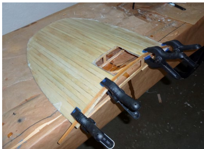
Das fertige Aufbaudach wird später von vier Magneten auf dem Rahmen gehalten
