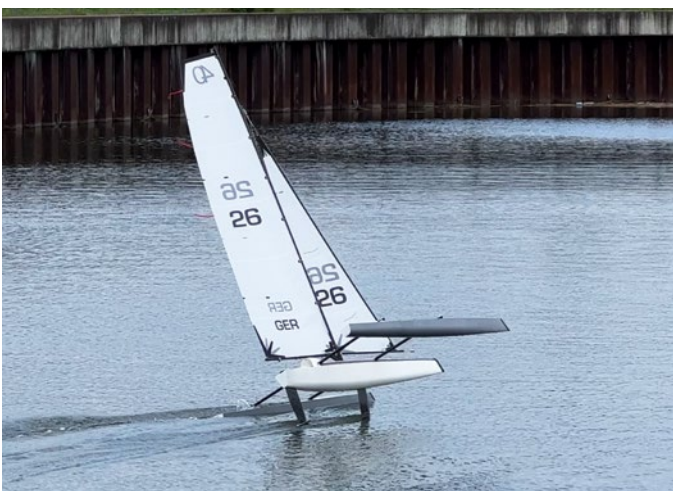
Die erste Probefahrt war ein voller Erfolg. Schnell und ausgeglichen segelt der gedruckte MOD40 und geht am Wind sofort auf einen Rumpf
