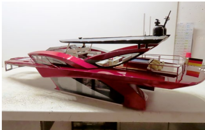
Der Aufbau lässt sich in einem Stück komplett abnehmen
