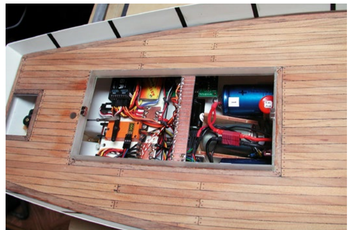
Nachdem der Einbau der Technik fertig war, wurde das Deck eingeklebt
