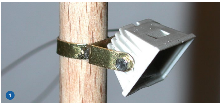
1) Der Strahler bekam eine Mastaufhängung aus Messing.
