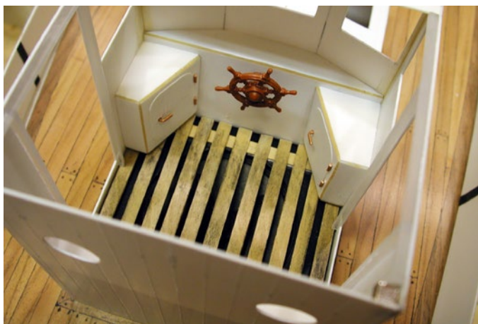
Unter der Grätung im Steuerhaus ist der Lautsprecher verborgen
