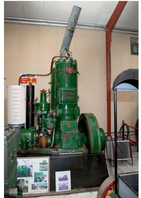
Ein Grenaa-Einzylinder, einst typisch für Fischerei- und kleine Frachtschiffe
