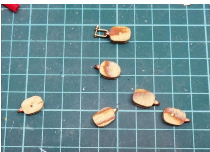
Die Blöcke wurden ebenfalls aus Holz, Kupferstreifen und Messingrollen selbst gebaut
