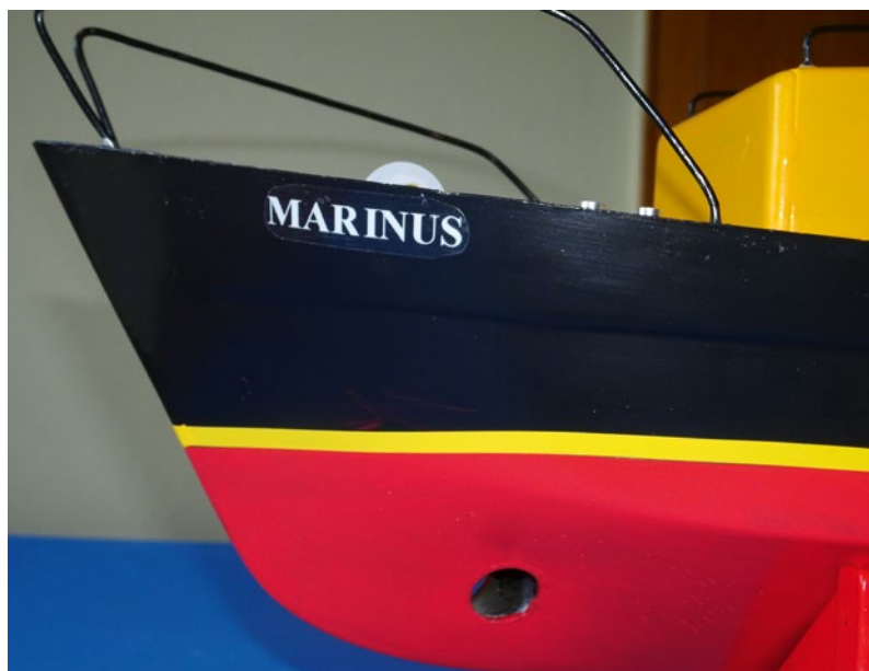
Das BSR beim Vermessungsschiff MARINUS (Schiffsmodell 07/22), das genauso groß wie die Barkasse ist
