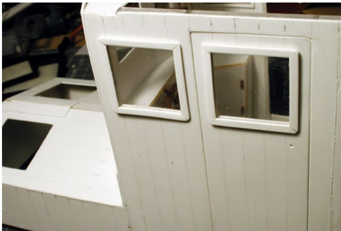
Die Fenster können nach dem Lackieren einfach eingesetzt werden
