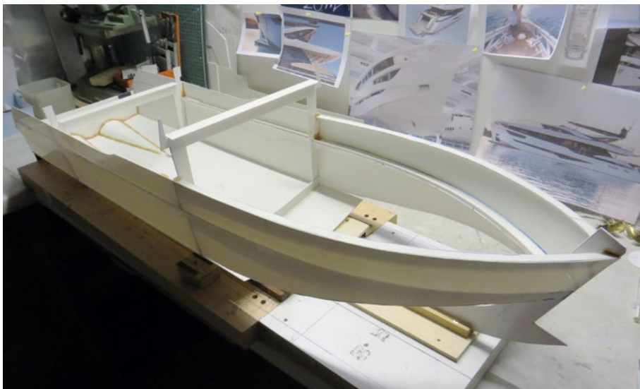
Danach wird die Bordwand Teil für Teil aus ABS-Platten angepasst
