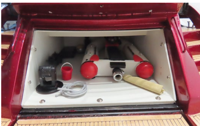
Die Heckgarage lässt sich zur Wartung des Ruders nach dem Lösen der Schrauben rausziehen
