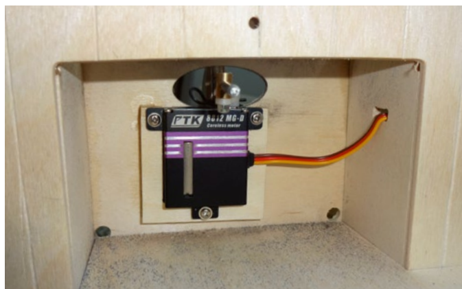
Das Ruderservo wird mit dem Rahmen direkt an den Spiegel geklebt
