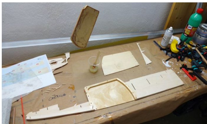
Die beiden Teile für den Kiel sind mit Bohrungen für Führungsstifte versehen
