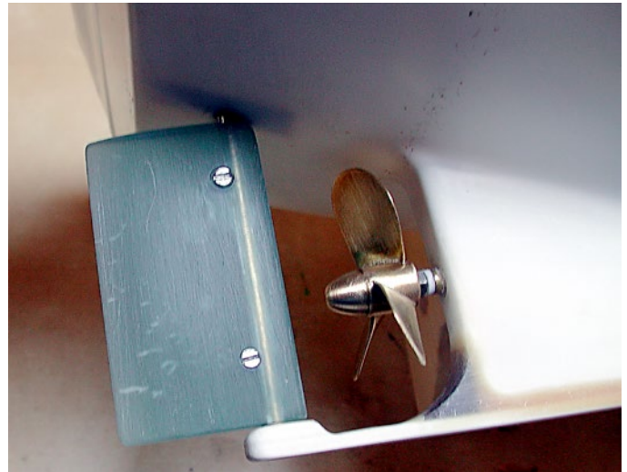
Das Ruder wurde aus Plexiglas neu gebaut, um es demontieren zu können
