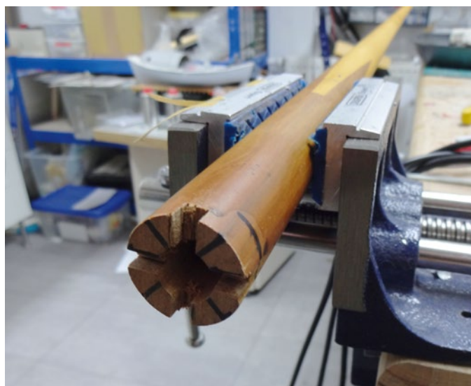
Der Mastfuß ist kreuzförmig eingesägt, damit er verdrehsicher auf dem Kiel sitzt
