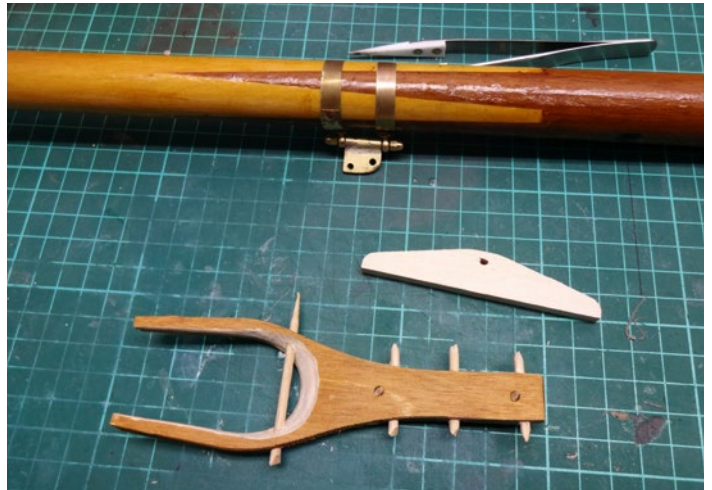
Nach der Wässerung wurden die Frästeile der Gaffelklau in Form gebracht
