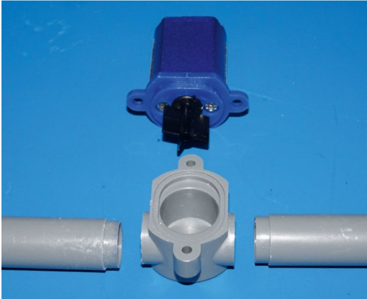
Das kleine Bugstrahlruder von Raboesch eignet sich natürlich besonders für kleine Modelle, wie die geplante Barkasse
