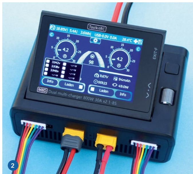
1) Das Ladegerät ist in einem Kunststoffgehäuse untergebracht, der Bildschirm kann für optimales Ablesen angewinkelt werden. 2) Das Display liegt gut im Blickfeld und lässt sich aus verschiedenen Perspektiven gut ablesen, die beiden Bedienelemente sind griffgünstig angeordnet
