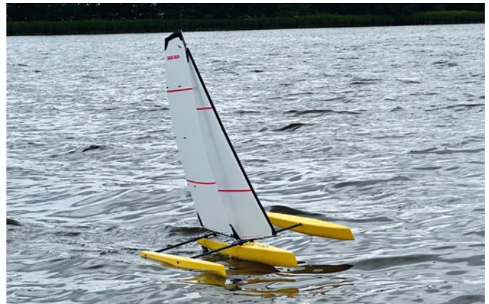
Der TRI65 in voller Fahrt, hier mit dem A+ Rigg der DF65
