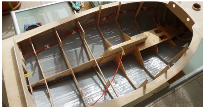
Der Rumpf wurde von innen mit gefärbtem Epoxidharz gestrichen, damit man Fehlstellen besser sieht
