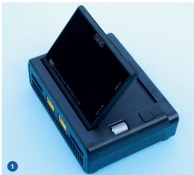
1) Das Ladegerät ist in einem Kunststoffgehäuse untergebracht, der Bildschirm kann für optimales Ablesen angewinkelt werden. 2) Das Display liegt gut im Blickfeld und lässt sich aus verschiedenen Perspektiven gut ablesen, die beiden Bedienelemente sind griffgünstig angeordnet
