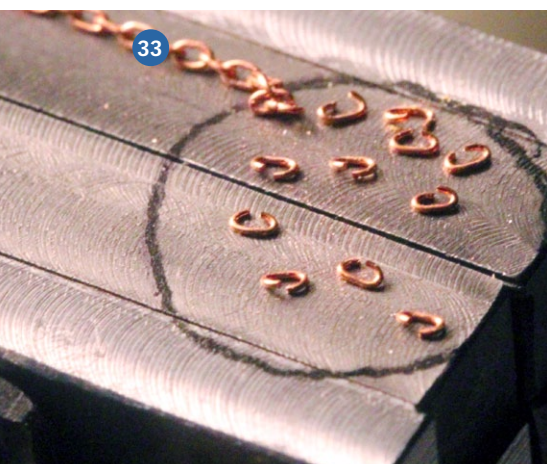
Abbildung 33) Oft lege ich noch mehr Glieder in den Kreis, bevor ich mit dem „Ketten“ beginne. Abbildung 34) Die Stahl-Riegel hatten unten bereits die großen Bohrungen, bevor ich sie verarbeitet habe. Der Messing-Becher ist nur auf der hinteren Backe erhöht auf einem Blechstreifen angeklebt
