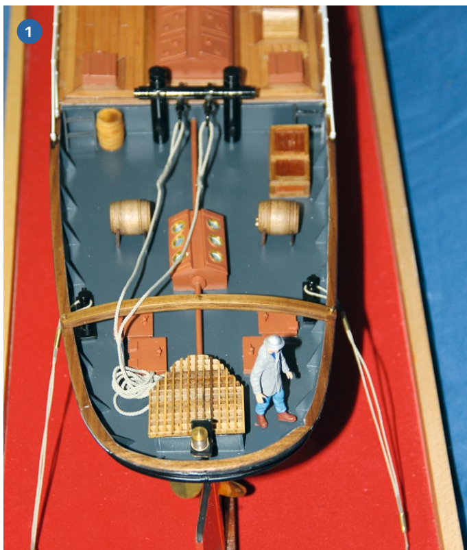
1) Unter der Grating besteht ein Zugang zur Ruderanlage. 2) Zwei Holzleisten zwingen den Rumpf in Form, während die Decksauflage eigelebt wird. 3) Messing und Polystyrol kamen bei Ruder und Hacke zum Einsatz
