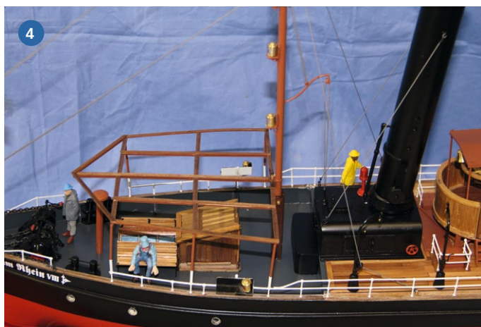
1) Unter Deck erfolgt die eigentliche Ruderanlenkung, aber oberhalb ist eine Verbindung zum Steuerhaus gegeben. 2) Selbst gebaute und Kaufteile, beispielsweise die Fässer, sorgen für Leben auf der WACHT AM RHEIN. 3+4) Aus Holz und Messing entstand das Gestell für das Sonnensegel – ein besonderes Merkmal des Schiffs. 5) Bei Bedarf lässt sich das komplette, auf einer Plexiplatte montierte Mitteldeck abnehmen
