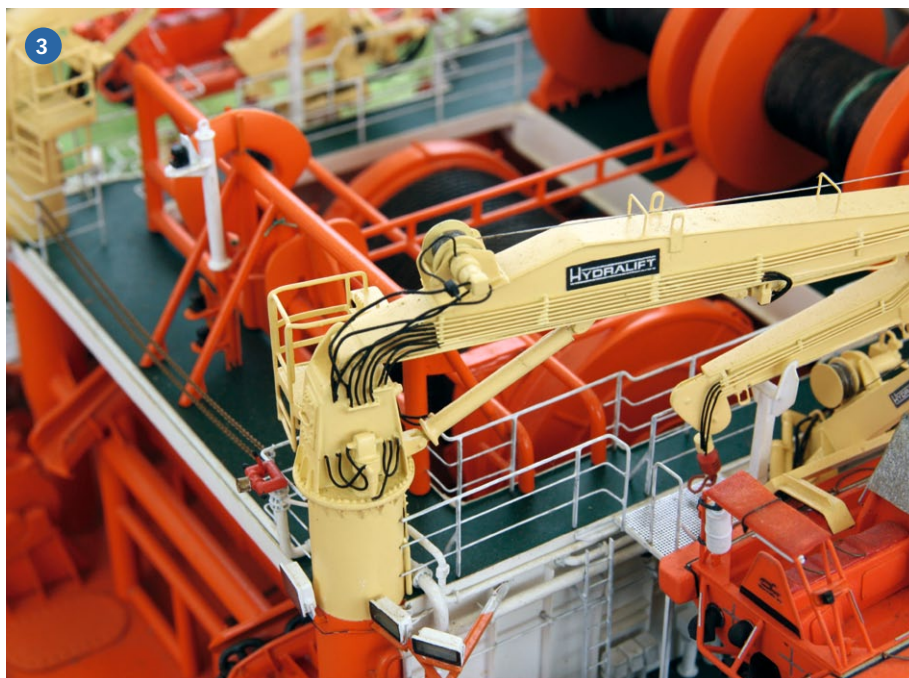
1) Ein Davit im Rohbau zum Fieren der Beiboote auf der NORMAND NEPTUN. 2) Neben dem Materialmix wird hier vor allem die Dimension des an sich großen Krans deutlich. 3) Feinster Draht wird zur Nachbildung der Hydraulikschläuche verwendet
