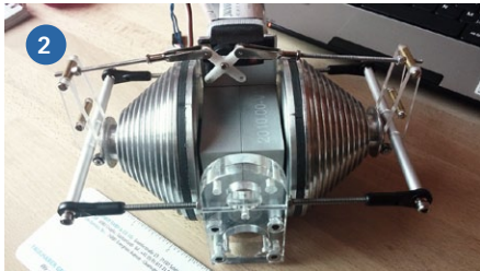
1) Ramosers Windensystem ist speziell auf die SprintaRC ausgelegt, aber auch für andere Modelle eine tolle Lösung (Quelle: Ramoser). 2) Die Schupp Genua-Winde ist die edelste Windenlösung, die momentan käuflich zu erwerben ist. Sie kann 1.800 Millimeter Schot wickeln und hat zwei konische Trommeln mit Kupplung für die nicht wickelnde Seite (Quelle: Schupp). 3) Der Größenunterschied der unterschiedlichen Winden ist deutlich zu erkennen
