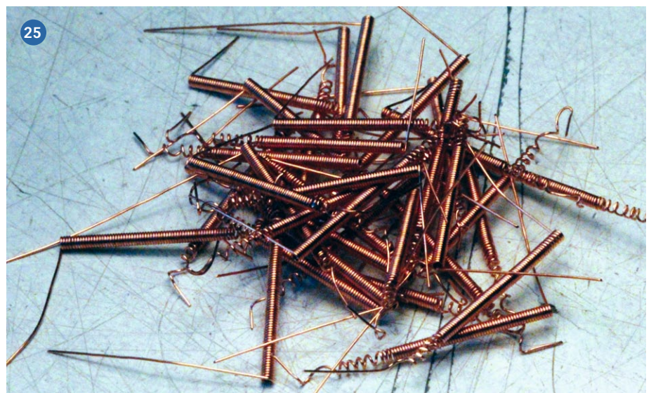
Abbildung 21) Die Spindeln können auch Feingewinde haben, doch immer 1-Millimeter-Steigung. Abbildung 22) Man erkennt sehr gut, wann man das Verdrillen beenden muss. Abbildung 23) Das ist nur der Anfang. Abbildung 24) Den Bohrer dreht man aus der Wendel heraus – geht aber nur in einer Drehrichtung. Abbildung 25) Der Außendurchmesser der Wendel beträgt etwa 1 Millimeter. Abbildung 26) Die Kanten werden nur leicht entgratet
