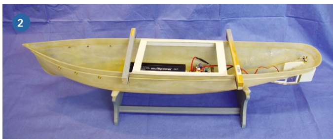
1) Unter der Grating besteht ein Zugang zur Ruderanlage. 2) Zwei Holzleisten zwingen den Rumpf in Form, während die Decksauflage eigelebt wird. 3) Messing und Polystyrol kamen bei Ruder und Hacke zum Einsatz
