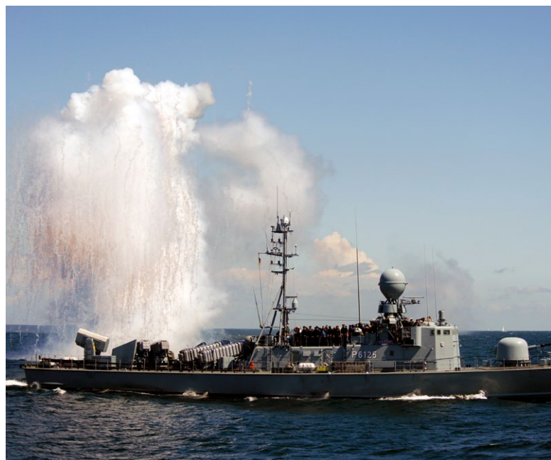
HotDog-Schießen – mit diesem „Feuerwerk“ werden anfliegende Flugkörper abgelenkt
