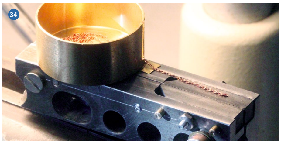
Abbildung 33) Oft lege ich noch mehr Glieder in den Kreis, bevor ich mit dem „Ketten“ beginne. Abbildung 34) Die Stahl-Riegel hatten unten bereits die großen Bohrungen, bevor ich sie verarbeitet habe. Der Messing-Becher ist nur auf der hinteren Backe erhöht auf einem Blechstreifen angeklebt
