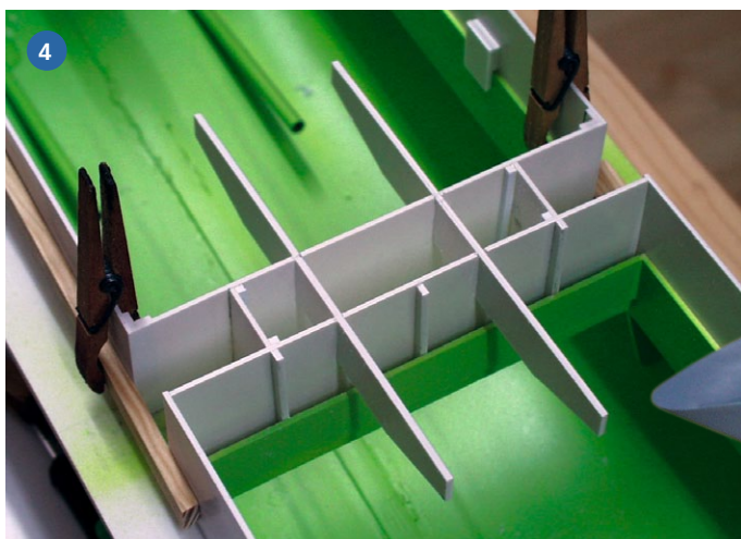
1) Eine Fräse war nicht zur Hand, also wurden die Fenster sorgfältig mit einem Bohrer und Feile ausgearbeitet. 2) Von innen zusätzlich angeklebte Polystyrol-Leisten erhöhen die Klebefläche. Zwingen bewirken einen geraden Aufbau. 3) Der hohe Süllrand garantiert einen sicheren Halt der Aufbauten und schützt weitestgehend vor Wassereintrich. 4) Vorderer und hinterer Kabinaufbau sind im Übergangsbereich vielfach miteinander verbunden. 5) Der Rohbau ist weitestgehend abgeschlossen, der Rumpf grundiert
