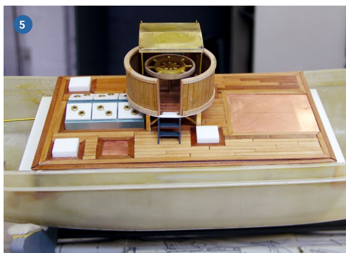
1) Unter Deck erfolgt die eigentliche Ruderanlenkung, aber oberhalb ist eine Verbindung zum Steuerhaus gegeben. 2) Selbst gebaute und Kaufteile, beispielsweise die Fässer, sorgen für Leben auf der WACHT AM RHEIN. 3+4) Aus Holz und Messing entstand das Gestell für das Sonnensegel – ein besonderes Merkmal des Schiffs. 5) Bei Bedarf lässt sich das komplette, auf einer Plexiplatte montierte Mitteldeck abnehmen
