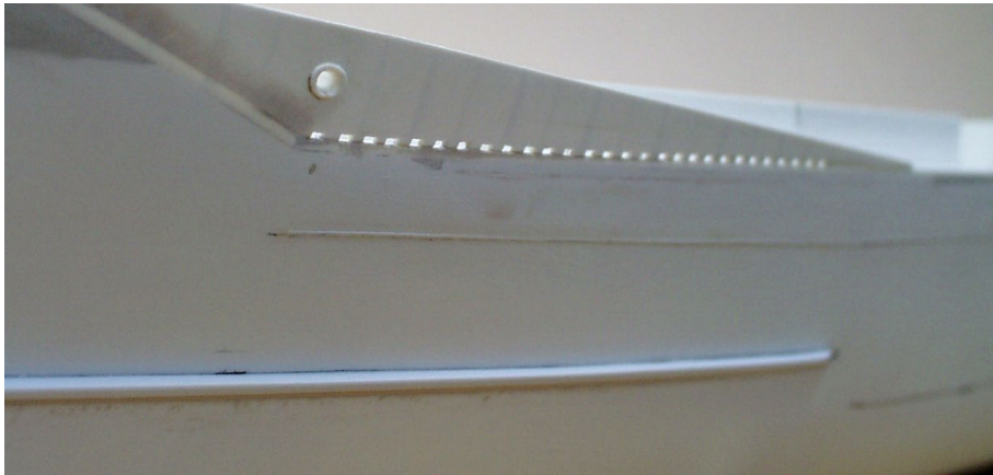
Scheuerleiste und Schanzkleid, das exakt der Rumpfkontur folgt, entstanden in Eigenarbeit aus Polystyrol
