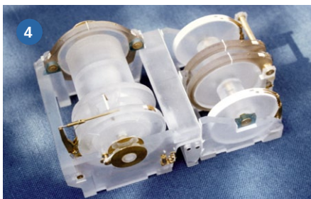
1) Plexiglas, Phosphorbronzeblech und Messing kamen hauptsächlich zum Einsatz. 2) Die Schanzkleidstützen sind eingelötet. 3) Eine Vielzahl an Wasser- und Hydraulik-Leitungen sowie Handläufe bestimmen die Optik. 4) Zum Drehen eignet sich Plexi ideal, bringt aber auch einiges an Gewicht mit sich. 5) Blick auf die mit Trossen belegten Winden. 6) Hier schlägt das Herz des Arbeitsschiffs
