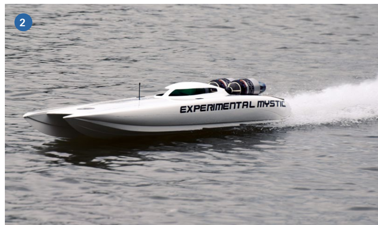
1) Blick auf die Turbine JetCat SPM5 in einem Hydro. 2) Ein sehr interessantes Projekt von Dr. Matthias Gneuss. Denn die 1.850 Millimeter lange Mystic wird ausschließlich von den beiden Strahltriebwerken angetrieben
