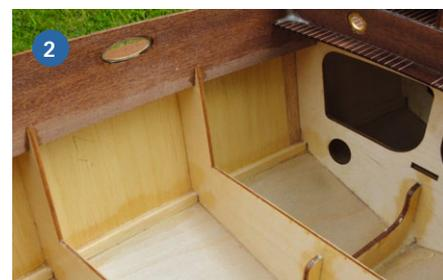
1) Ein äußerst stabiler und schicker Rumpf ist entstanden. 2) Die zusätzlich eingebrachten Längsgurte bestehen aus zweifach verleimten Balsaleisten. 3) Die Kajütwände werden eingesetzt und mit den Stringern aus Kiefernleisten verklebt. 4) Um das Deck fest mit dem Rumpf verkleben zu können, sind einige Hilfsmittel nötig
