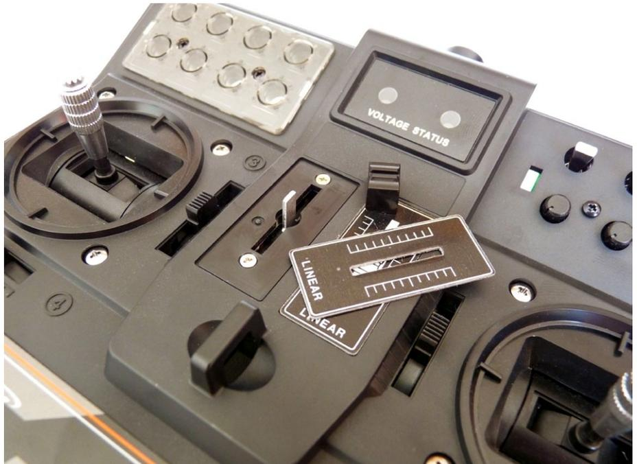
Zum Schieber gehört natürlich auch eine neue Abdeckung für die Senderfrontplatte und ein aufsteckbarer Knopf zur besseren Bedienbarkeit
