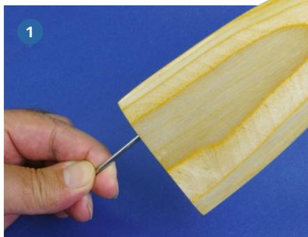
1) Durch die mehrschichtige Verleimung des Ruderblatts lässt sich die Profilierung recht gut erstellen. 2 Die RC-Ausrüstung liegt gut zugänglich unter dem abnehmbaren Dach
