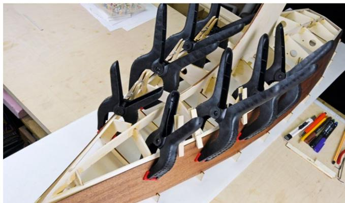
Die Rumpfsseitenteile mit Mahagonioberfläche werden angepasst
