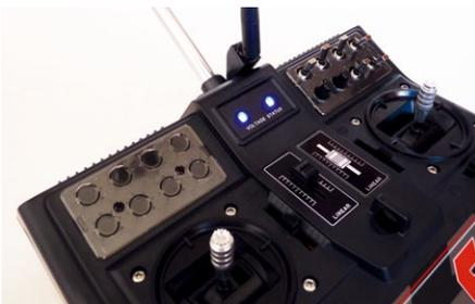
Im Betrieb sollte die Antenne möglichst senkrecht zum Sender stehen, da 2,4-Gigahertz-Signale wie eine Art Donut von der Antennenspitze abgestrahlt werden. Dies ermöglicht optimale Reichweite und die Position stört bei der Bedienung überhaupt nicht
