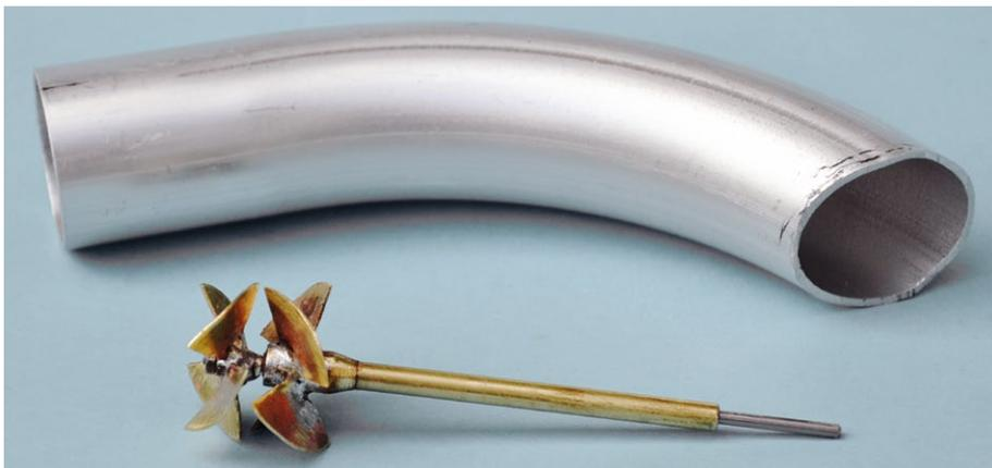
**Die Einzelteile des Flautenschiebers. Hauptbauteil sind der 90-Grad-Alu-Krümmen und das Stevenrohr mit selbstgebautem Stator sowie Propeller**
