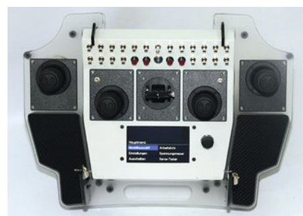
Eine bluecontrol 1.8 mit fast Vollausrüstung (27 Schalter/Taster/Poti, 4 x 4D2T und Navy)
