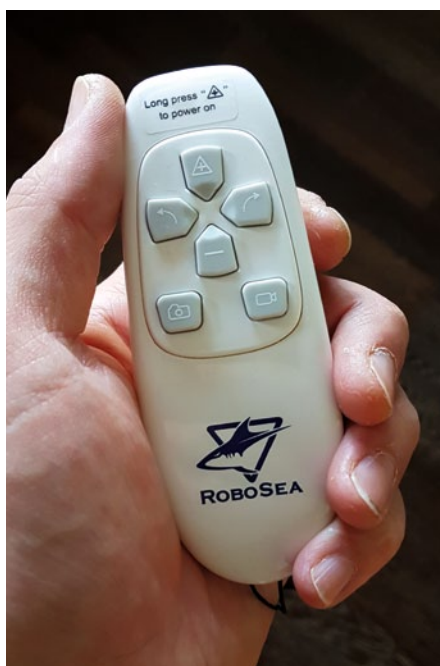
Für die Steuerung der Drohne Unterwasser liegt ein Handsender bei, der die Signale zum U-Boot überträgt – mit dem Smartphone ist das nicht möglich
