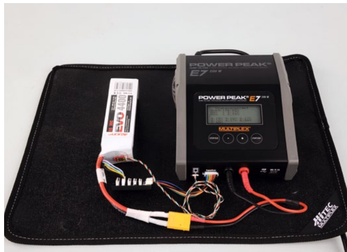
LiPo-Akku und das höherwertige Ladegerät Power Peak E7 für den stationären Gebrauch auf feuerfester Ladematte
