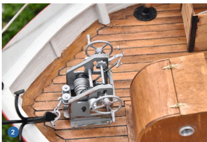
1) Typisch für Krabbenkutter älteren Typs ist der runde Krabbenkocher. Der ist wegen der Kochdämpfe natürlich hinter dem Deckshaus platziert. 2) Auf der RAMONA ist tatsächlich noch eine handbetriebene Ankerwinde platziert. Daneben zu sehen der Niedergang zum Vorschiff aus Holz. 3) Waschtrommel und Rüttelsieb entstanden nach Vorlage des Modells JULE von aero-naut
