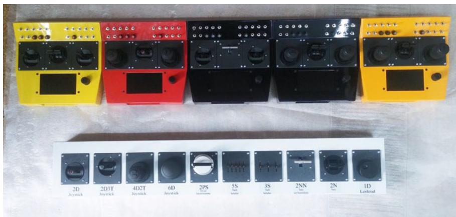
Durch optionale Joysticks wie die Version 2PS (Pot- und Schottelsteuerung) oder Navy-Schieberegler ist die Brixl-Technik auch für Schiffsmodellbauer ausgesprochen interessant
