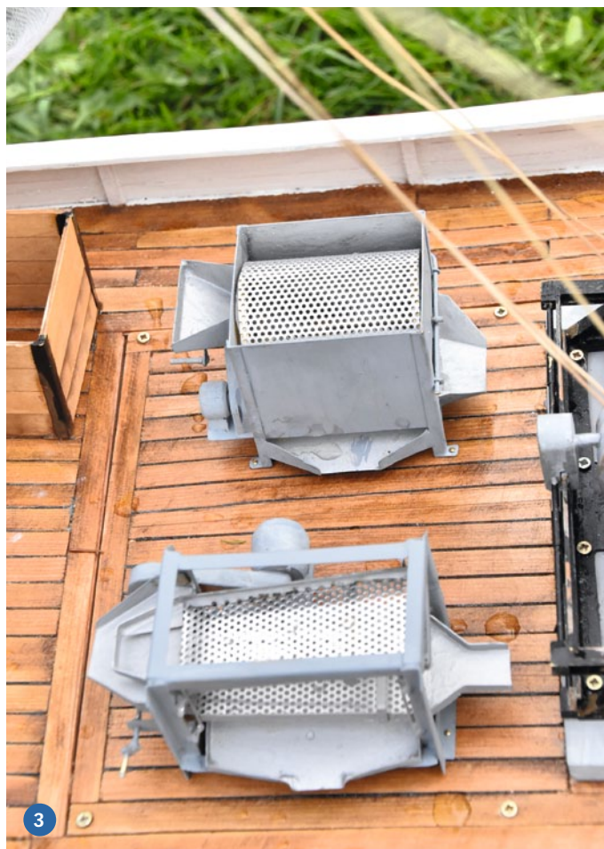
1) Typisch für Krabbenkutter älteren Typs ist der runde Krabbenkocher. Der ist wegen der Kochdämpfe natürlich hinter dem Deckshaus platziert. 2) Auf der RAMONA ist tatsächlich noch eine handbetriebene Ankerwinde platziert. Daneben zu sehen der Niedergang zum Vorschiff aus Holz. 3) Waschtrommel und Rüttelsieb entstanden nach Vorlage des Modells JULE von aero-naut
