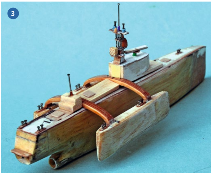
1) Das SEAHUNTER-Modell hat auf einem SchiffsModell-Heft Platz genommen – es verdeutlicht die Dimensionen des im Original über 40 Meter langen Schiffs. 2) Das Rohmodell der SEAHUNTER vor der Pönung. Es kommt überwiegend Balsa und nur wenig Sperrholz zum Einsatz. 3) Aus dieser Perspektive gut zu erkennen sind die Wellenhose und die Nagel-Poller
