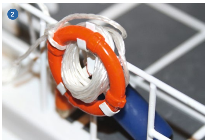
1) Der Graupner-Bausatz stellt eine solide und gute Grundlage für den Aufbau eines Modells nach selbst gewähltem Vorbild dar. 2) Filigraner als der Baukastenbeschlag sieht die Rettungsringaufnahme im Eigenbau aus – der ist einfach an die Messingreling gelötet. 3) Die Handläufe am Aufbau sind doppelt ausgeführt
