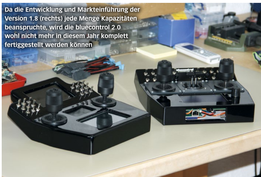
Durch optionale Joysticks wie die Version 2PS (Pot- und Schottelsteuerung) oder Navy-Schieberegler ist die Brixl-Technik auch für Schiffsmodellbauer ausgesprochen interessant
