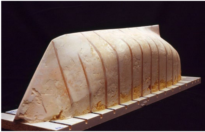
Der grob vorgeschliffene PU-Schaumrumpf ist bereit zum Auftrag der Spachtelschicht/Grundierung
