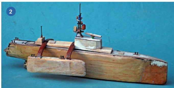
1) Das SEAHUNTER-Modell hat auf einem SchiffsModell-Heft Platz genommen – es verdeutlicht die Dimensionen des im Original über 40 Meter langen Schiffs. 2) Das Rohmodell der SEAHUNTER vor der Pönung. Es kommt überwiegend Balsa und nur wenig Sperrholz zum Einsatz. 3) Aus dieser Perspektive gut zu erkennen sind die Wellenhose und die Nagel-Poller
