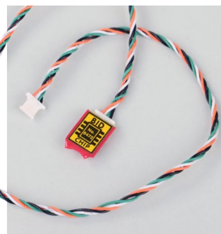
BID-Chip mit längerem Datenkabel. Das kann vor allem bei Akkus hilfreich sein, die weniger gut zugänglich im Rumpf untergebracht und zum Laden selten herausgenommen werden
