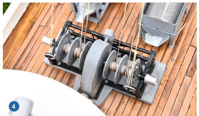
1) RAMONA mit gehieften Netzen. Die Bäume sind über Winden, die unter Deck liegen, gesteuert. 2) Das Vordeck des Modells mit seinen schiffstypischen Ausrüstungsgegenständen. Wichtig sind da auch die Fischkästen. 3) Kernelement des Achterdecks ist die Kajüte. Auf dessen Dach thront die „Rettungsinsel“, aber auch ein funktionsfähiger Suchscheinwerfer. 4) Die funktionsfähige Netzwinde – wobei der eigentliche Windenantrieb unter Deck sitzt
