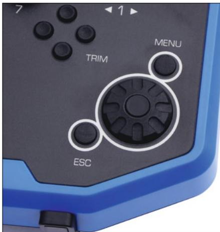
Mit Hilfe des Drehgebers mit 'Enter'-Funktion, der 'ESC'- und der 'Menü'-Taste erfolgt, in Verbindung mit dem farbigen LC-Display und den Funktionstasten, die Programmierung der Anlage
