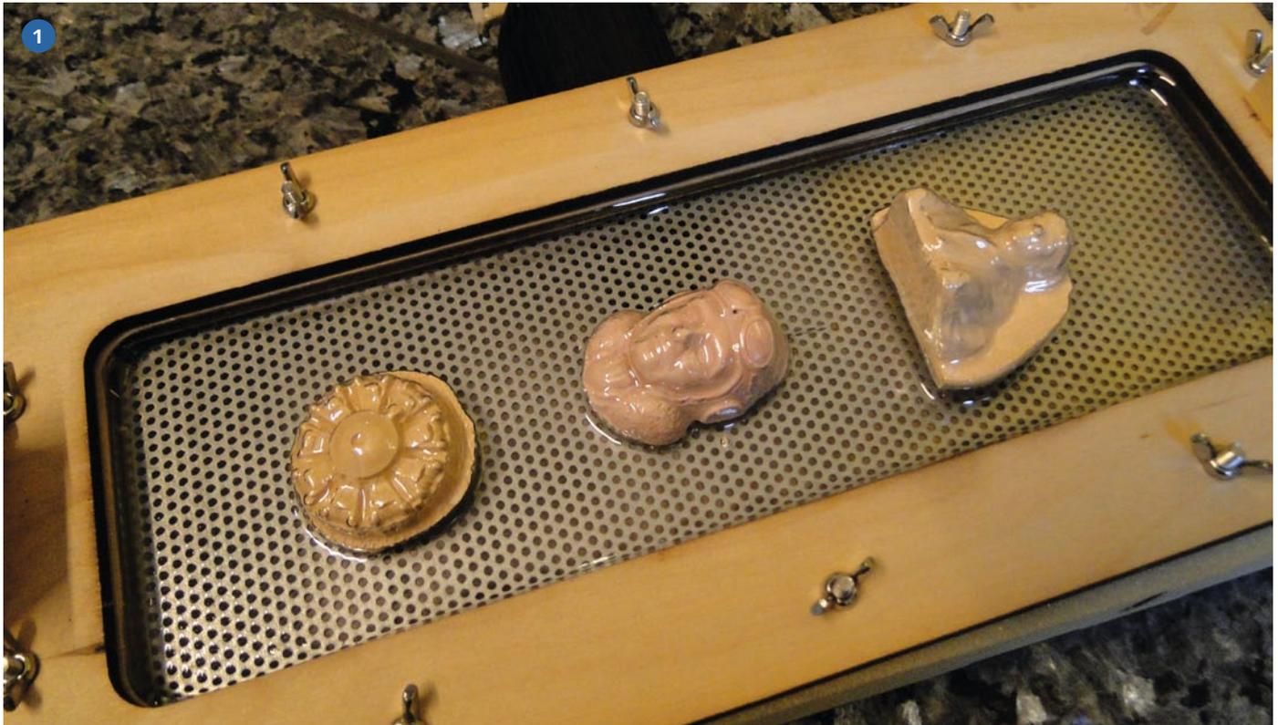
1) Je kleiner die Formen sind, desto unproblematischer lassen sie sich abformen. 2) Mit dem Tiefzieh-Verfahren lassen sich dünnwandige, leichte Teile fertigen. 3) Der „Sockel“ aus Holz unter dem eigentlichen Tiefziehteil ermöglicht ein sauberes Abformen bis ans untere Ende der Form
