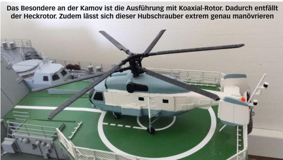
Das Besondere an der Kamov ist die Ausführung mit Koaxial-Rotor. Dadurch entfällt der Heckrotor. Zudem lässt sich dieser Hubschrauber extrem genau manövrieren
