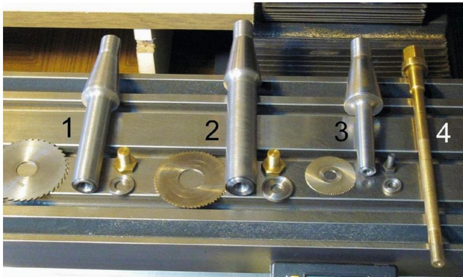
**Abbildung 18) Auch die Druck-Unterlegscheiben dreht man selbst**
