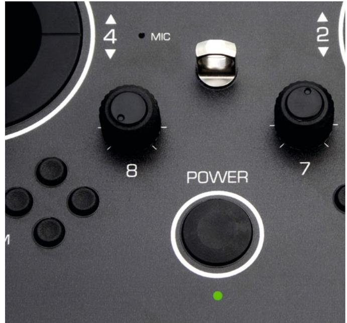
Mittig sind der Schalter mit Status LEDs, zwei Drehgeber, ein Mikrofon sowie die Öse für den Gurt platziert
