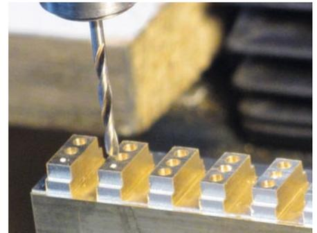
Abbildung 7) Die Zwischenräume müssen immer ausreichend tief gefräst werden (Sägeblatt-Dicke)
