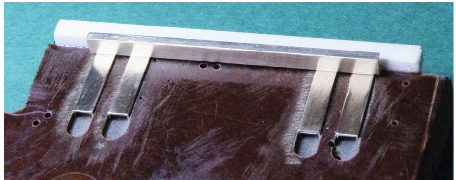
Abbildung 30) Die lange U-Schiene wird beim Lötten an die weiße PVC-Kante angelegt. Danach wird das Ganze umgekehrt und die zweite U-Schiene angelötet
