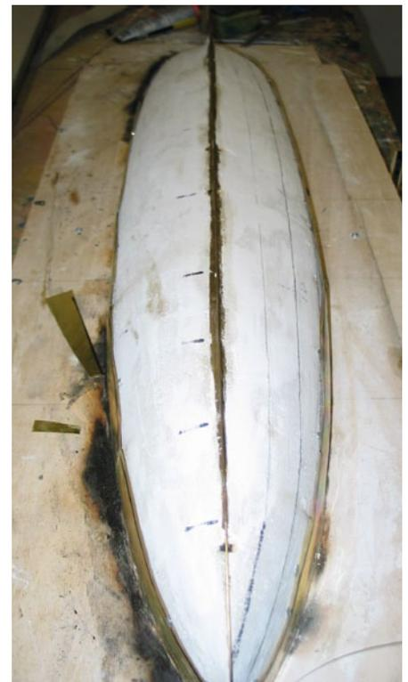
Um den Rumpf aus Messing bauen zu können, kam ein Mallenbau über eine Gipsform zur Anwendung
