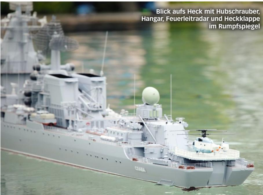
Blick aufs Heck mit Hubschrauber, Hangar, Feuerleitradar und Heckklappe im Rumpfspiegel
