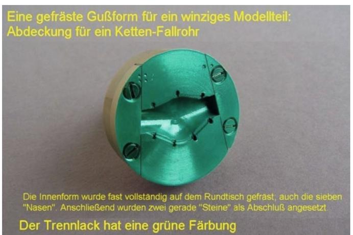
Eine gefräste Gußform für ein winziges Modellteil: Abdeckung für ein Ketten-Fallrohr
