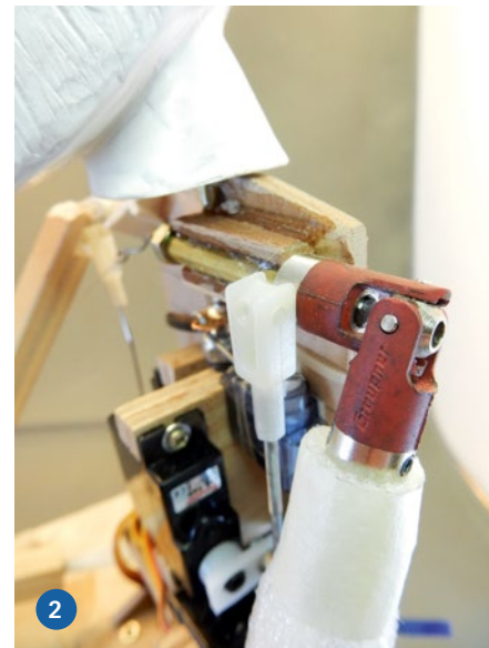
1) Der Arm wird von einem eigenen Servo angesteuert, es ist das eigentliche Lenkservo, dem alle anderen folgen. 2) Das Kugelgelenk in der Schulter, es überträgt Kräfte in die gewünschte Richtung und lässt freie Bewegungen in die andere zu
