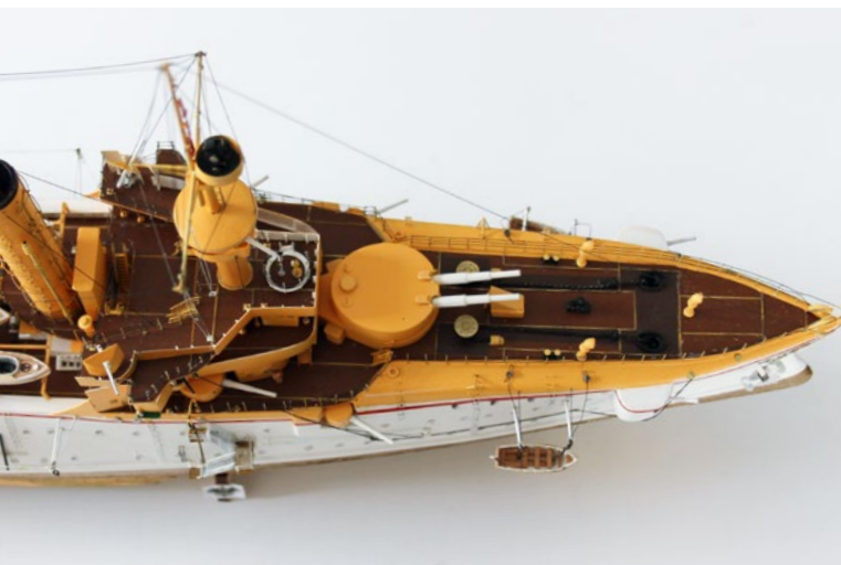
Aufsicht auf den Bugbereich. Auch im Maßstab 1:200 wurden zahlreiche Details umgesetzt
