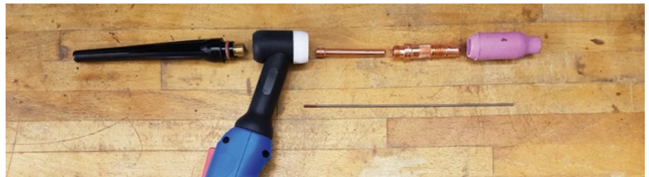
Der Brenner in seine Einzelteile zerlegt (v.l.n.r.): Brennerkappe, Handstück, Spannhülse, Düsenhalterung, Düse, darunter die Wolfram-Elektrode (ungeschliffen)
