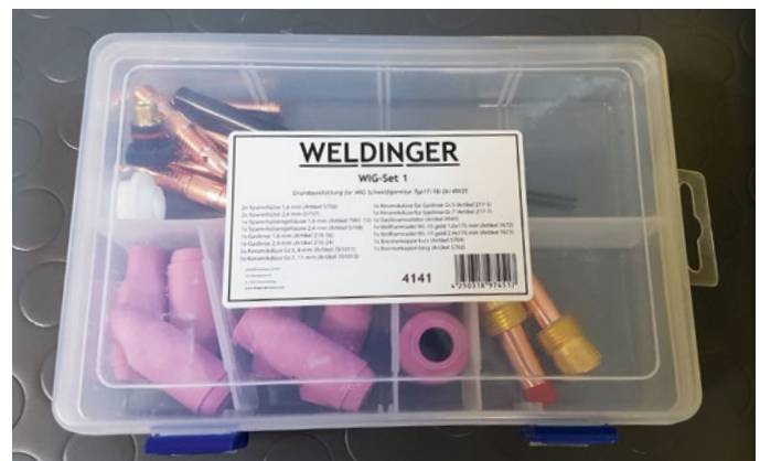
Im sogenannten WIG-Set 1 werden diverse Düsen, Spannhülsen und Elektroden zum Gerät mitgeliefert
