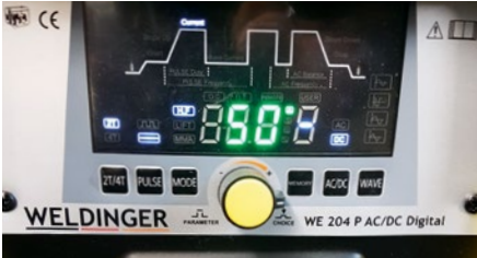
Das Display des Geräts ist übersichtlich gestaltet. Über den zentralen Dreh-Druckschalter werden die zahlreichen Funktionen der Steuereinstellungen vorgenommen
