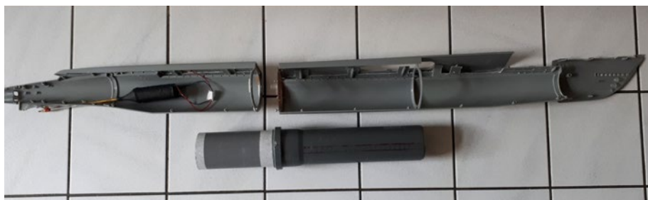
Die linke Rumpfhälfte mit Motoreinheit im Freiflutraum
