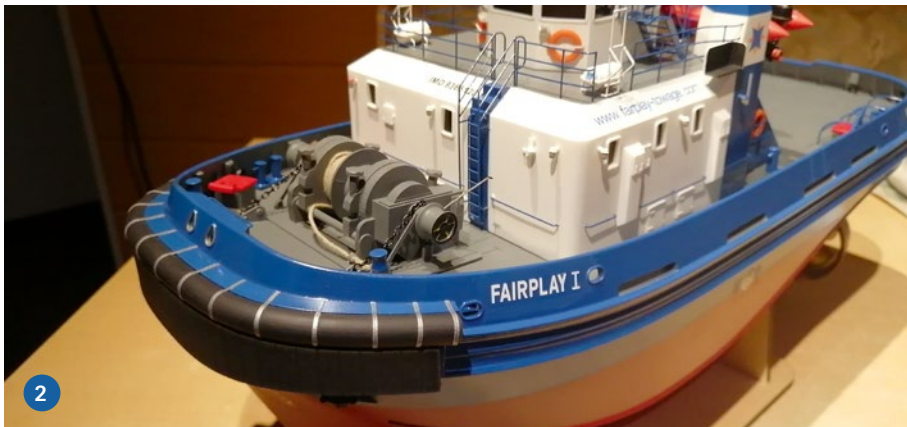
1+2) Die Winde auf dem Vorderdeck besteht nur aus wenigen Teilen. Diese weisen aber viele feine Strukturen und Details auf. Daher Vorsicht beim Schleifen. Erst nach dem Lackieren sieht man Nietenreihen und Schraubenimitationen
