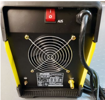
Blick auf die Rückseite des Schweißgeräts: Auch hier ist alles übersichtlich. Zentral ist die Gerätelüftung angebracht. Unten rechts ist der Anschluss für den Gasanschlussschlauch zu sehen
