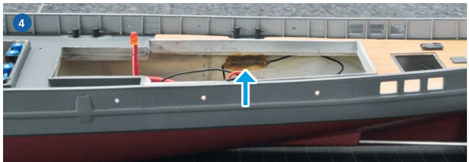
1) Neu im Programm von IMTH ist der Power-Switch PS-01, der Belastungen bis 20 Ampere verträgt. 2) Der Belegungsplan gibt Auskunft, wie das PS-01 geschaltet werden kann. 3) So erfolgt die Platzierung der LED und der Reed-Kontakte unter den Pollern. 4) Von außen ist nicht sichtbar, dass sich die Kontakte direkt hinter der Bordwand befinden
