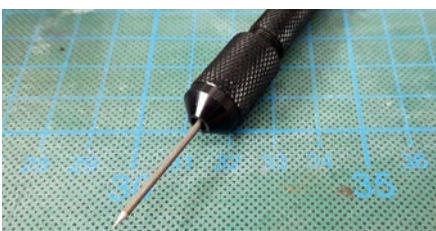
Die Wolfram-Elektrode ist geschliffen und noch in der Anschleifhilfe eingespannt
