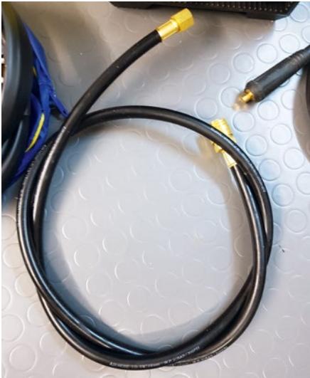
Der Gasschlauch zum Anschluss des Geräts an den Druckregler ist schon vorkonfektioniert
