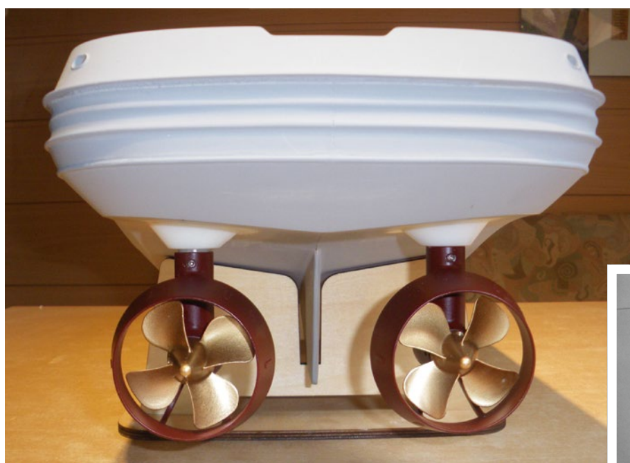
Die Antriebe sind größtenteils aus Kunststoff. Das bedeutet: Vorsicht bei der Bearbeitung und beim Einbau. In den Antrieben arbeiten Wellen aus Stahl und Kegelzahnräder
