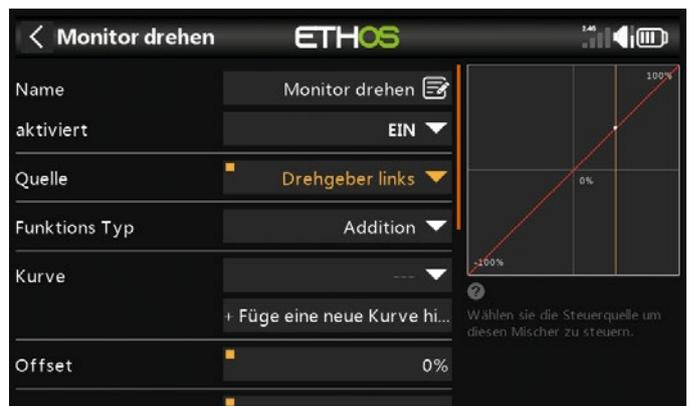
Zum Drehen der hinteren Löschkanone wird ein Mischer angelegt
