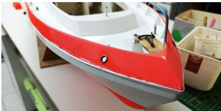
Vor allem optisch war eine Erneuerung für das Modell nötig: Die Lackierung war bereits ausgebleicht und einige Beschlagteile mussten ersetzt werden
