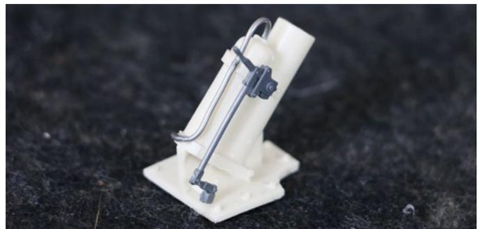
Aus Resin gegossene Teile für einen Wabo-Werfer. Die Wasserbomben sitzen hier auf dem im festen Winkel verbauten Werfer auf
