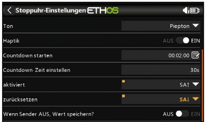
In diesem Menü erfolgt die Konfiguration für eine Stoppuhr
