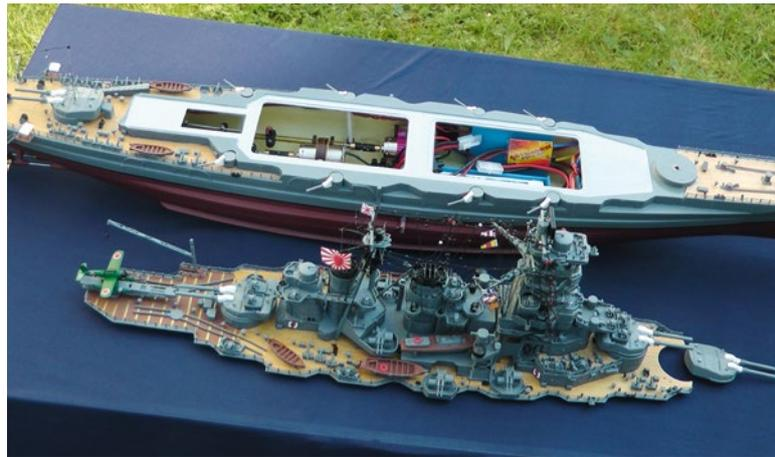
Für den Akkuwechsel und Wartungsarbeiten lässt sich der gesamte Aufbau einfach abnehmen
