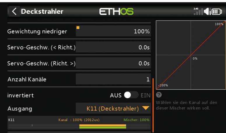
Mischer-Konfiguration für einen Schaltkanal, am Beispiel für die Betätigung der Deckstrahler
