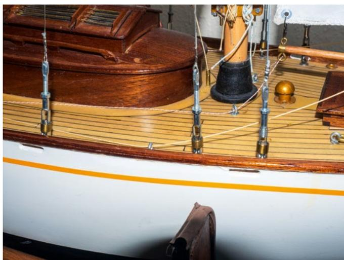
Wanten mit M3-Gabelköpfen, um diese für den Transport einfach lösen und im Betrieb spannen zu können
