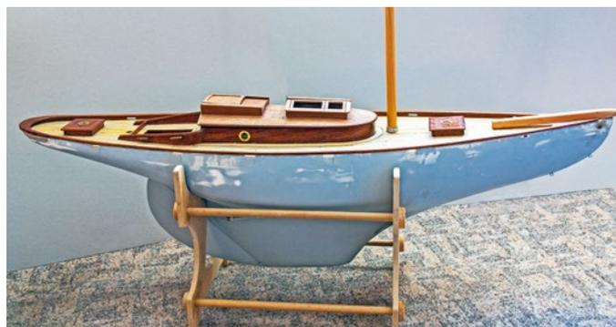
Der Rumpf ist fertig grundiert und bereit zum Lackieren. Leider vertrug sich der anschließend aufgebrachte Lack nicht mit der Grundierung und alles musste noch einmal gemacht werden
