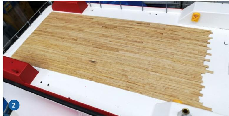
1) Ran an die Arbeit: Alle notwendigen Teile stehen für das technische sowie optische Upgrade zur Verfügung. 2) Es war dringend notwendig, das alte Arbeitsdeck zu ersetzen. Nach langer Suche fiel die Wahl auf die Beplankung der Holzplatte aus Flugzeugspertholz sowie Unterkonstruktion des Decks gegen Verzug
