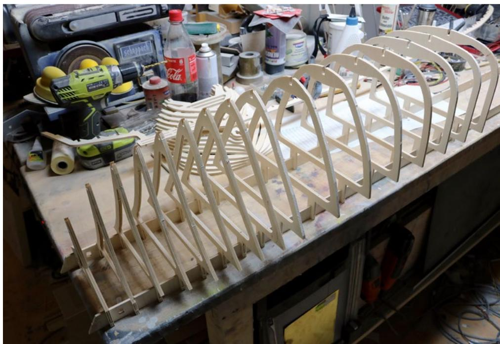
Mit Hilfe von Zeichnungen zum Original war der vorbildliche Nachbau des Schiffsrumpfs auf Holzspanten gut möglich
