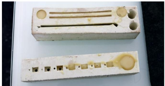
Um massenweise Bauteile zu produzieren, wie das besonders bei Ausrüstungsgegenständen rund um die Bewaffnung von Vorteil ist, bieten sich Formenbau und Resinguss an
