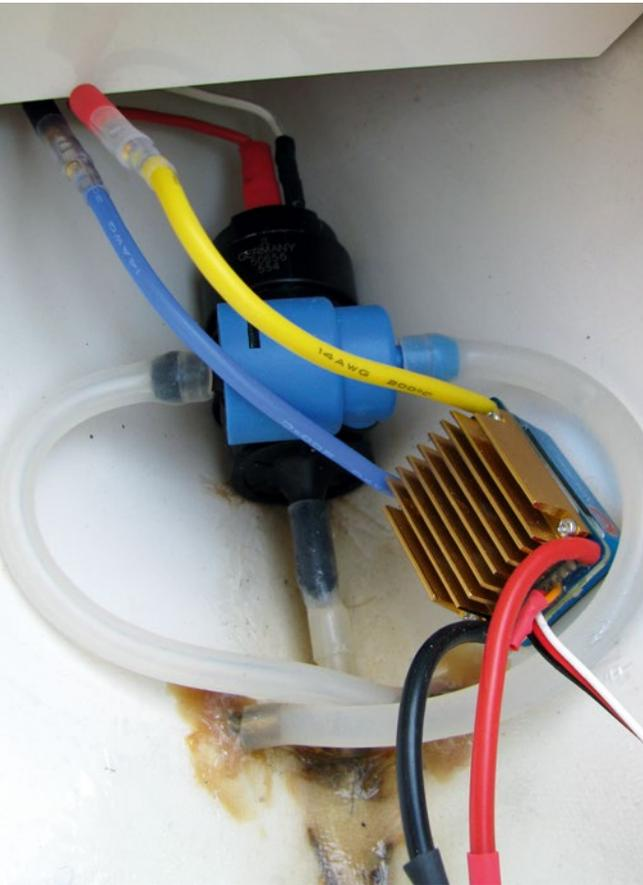
Querstrahler auf Basis einer Scheibenwischerpumpe
