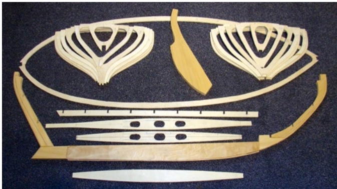
Spanten, Steven, Bug und Kiel sind anhand der Bauplanskizze zu fertigen
