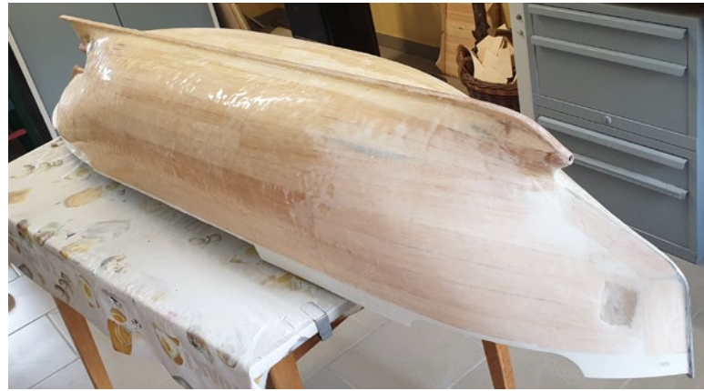
Nach dem Schleifen des Rumpfs folgte eine Versiegelung mit drei Lagen Glasgewebe
