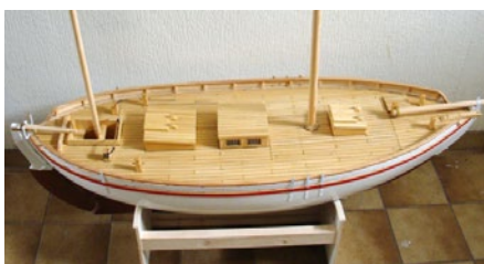
Deck und Aufbauten sind solide auf Decksunterzügen befestigt
