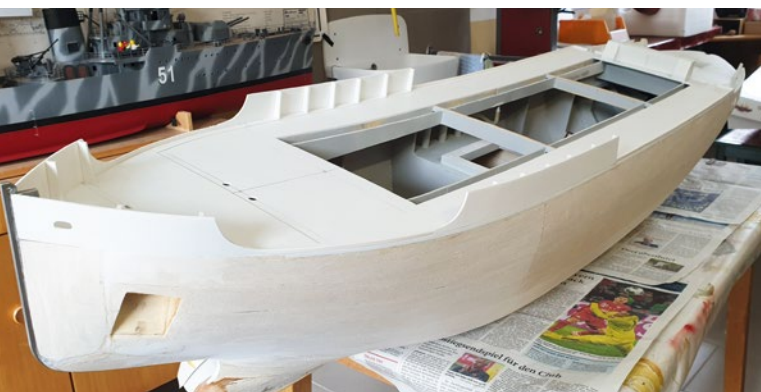
Die Zugangsöffnung zum Rumpfinneren ist bewusst üppig gewählt, um weiten Zugang zu haben
