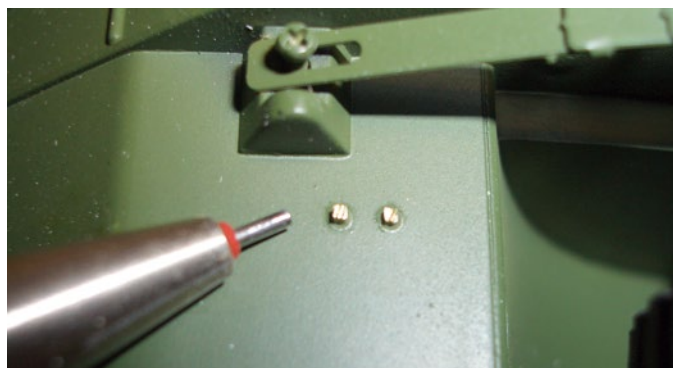
Diese beiden Kontakte an der unteren Heckseite sollen den Stromkreis für den Schraubenantrieb bei Wasserkontakt schließen
