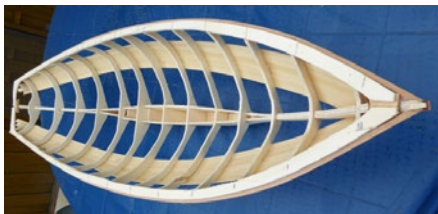
Hier ein Beispiel, wie man den Kiel zur Ballastaufnahme auch hätte bauen können
