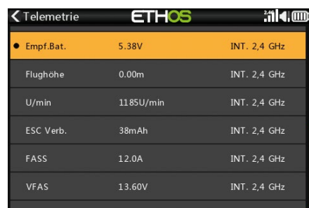
Mit Hilfe eines UniSens-E und der Empfängersensorik werden viele relevante Telemetriedaten erfasst und angezeigt
