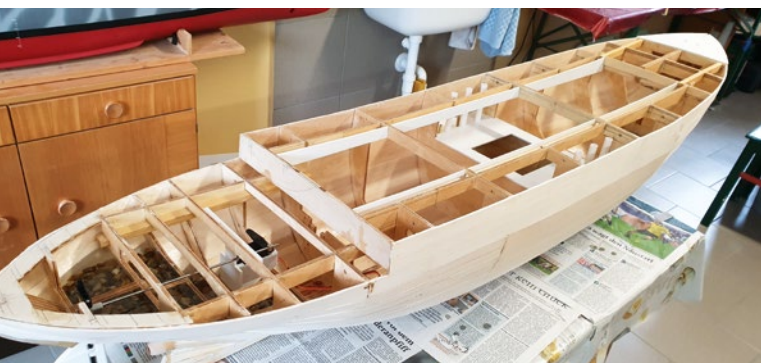
Achtern sowie im Bug sind Steine als Ballastgewicht eingelassen und mit Epoxidharz füllend vergossen
