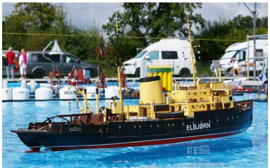
Gut 46 kg Gewicht verdrängt die 1.545 mm lange ELBJÖRN und zählt damit zu den Dickschiffen – Eisbrecher müssen eben was auf den Rippen haben
