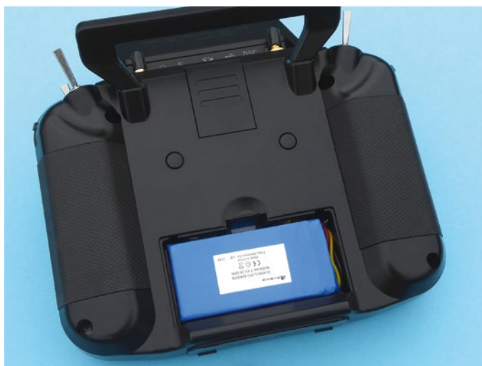
Rückseitig sind das Akkufach und ein Schacht für ein externes HF-Modul sowie zwei weitere Tasten untergebracht, zur Stromversorgung dient ein 2s-LiPo-Akku mit 4.000 mAh
