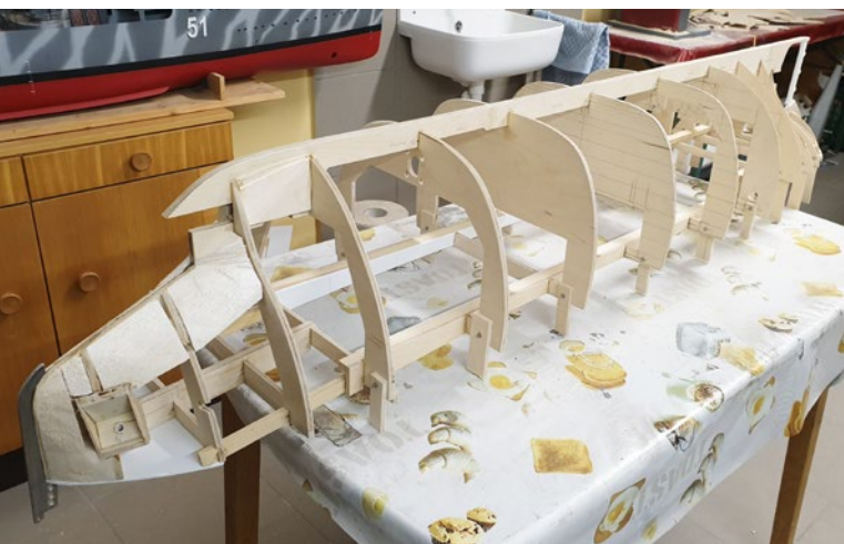
Auch der 1:33-Nachbau entstand in klassischer Spantenbauweise über Kopf auf einem Tisch als Helling – Füßlinge bringen die Spanten auf die nötige Höhe
