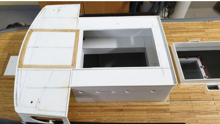
Während der Rumpf aus Holz entstand, fiel die Wahl beim Aufbau auf Polystyrol. Es lässt sich leicht verarbeiten und vereinfacht den Lackiervorgang
