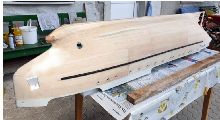
Scheuerleiste, Ankertasche und Bullaugen sind im lackierfertig verschliffenen Rumpf eingesetzt beziehungsweise montiert
