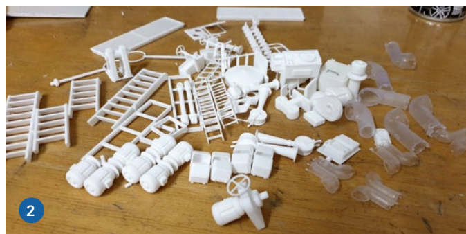
1) Ein großer Teil der ELBJÖRN wurde am PC gezeichnet, um eine Grundlage beispielsweise für die Produktion von 3D-Druck-Teilen zu erstellen. 2) Zunächst stellte ein Druck-Dienstleister die Teile her, erst später nahm ein eigener Resin-Drucker seinen Dienst auf
