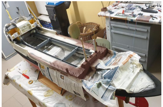
Da Teile des Aufbaus fest mit dem Rumpf verbunden sind, waren zum Lackieren immer wieder Bereiche abzukleben
