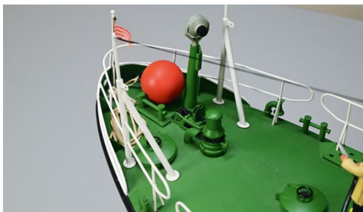
Zwischen 2000 und 2003 entstanden etliche Teile neu, beispielsweise die Reling, Ankerwinde oder Suchscheinwerfer, jedoch wurden die alten Schwanenhalslüfter und Poller weiter genutzt
