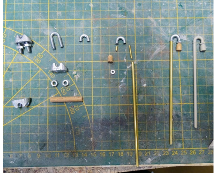
Drahtseilklemmen und Messingrohr lösten das Schwannenhalsproblem
