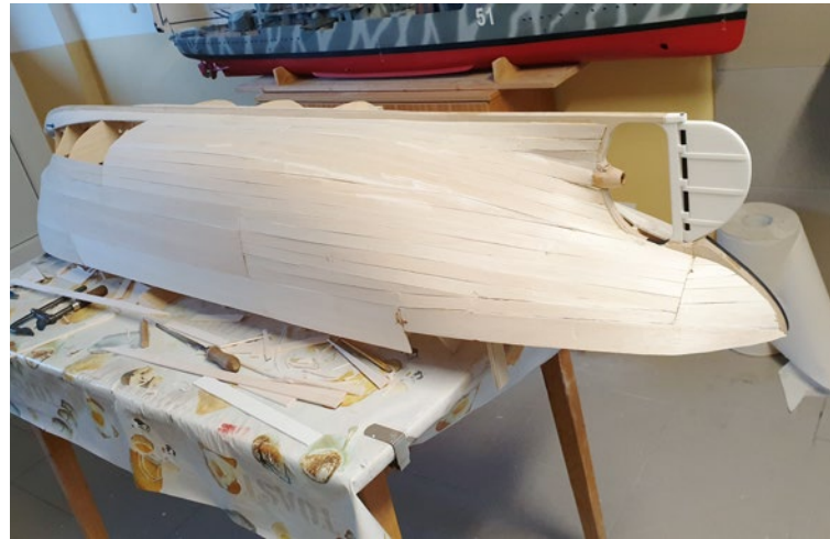
Das Beplanken mit Balsaleisten war die einfachste Methode
