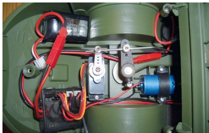
Zwischen dem Empfänger und dem Sender der 2,4-GHz-Anlage wird eine Verbindung hergestellt. Eine Kontroll-LED ist im Empfänger implementiert
