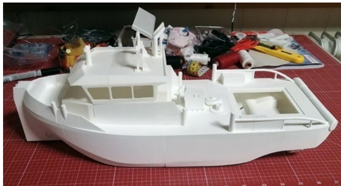
Der Rumpf kommt in zwei Teilen mit fertigem Deck. Kleiner Nachteil: Einbauten sind komplizierter
