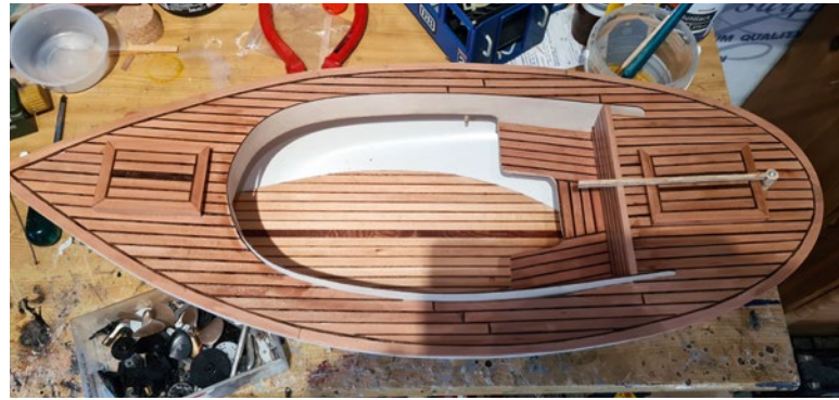
Das Deck wird ebenfalls mit Leisten aus Birnenholz veredelt
