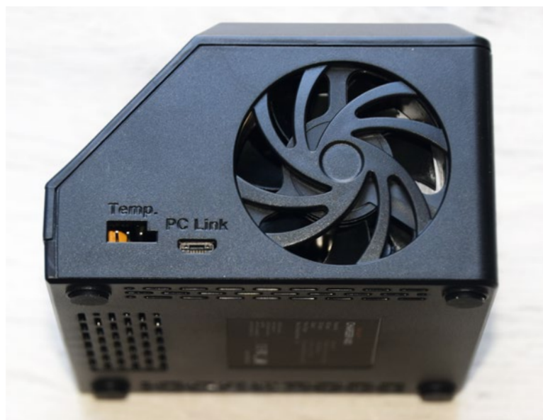
An der rechten Seite befinden sich der USB-Anschluss und die Buchse für den Temperatursensor
