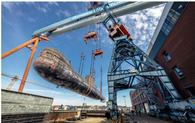
In Kiel hebt der Portalkran das U-Boot aus dem Trockendock auf den Transportponton
