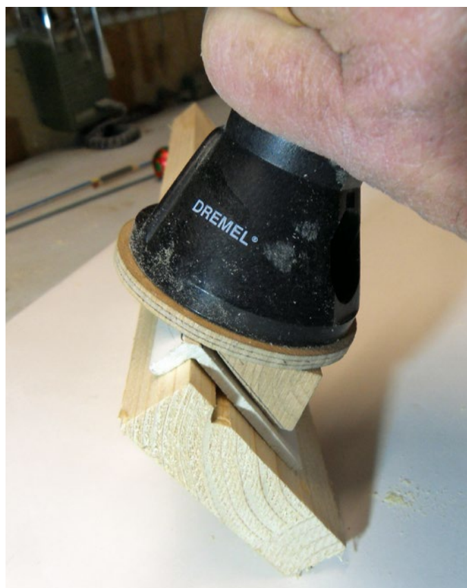
Damit werden die Aussparungen für die Planken gefräst
