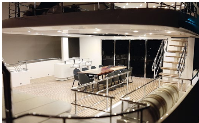
Als Außenbeleuchtung sind 2-mm-SMD-LEDs in die Decke eingelassen
