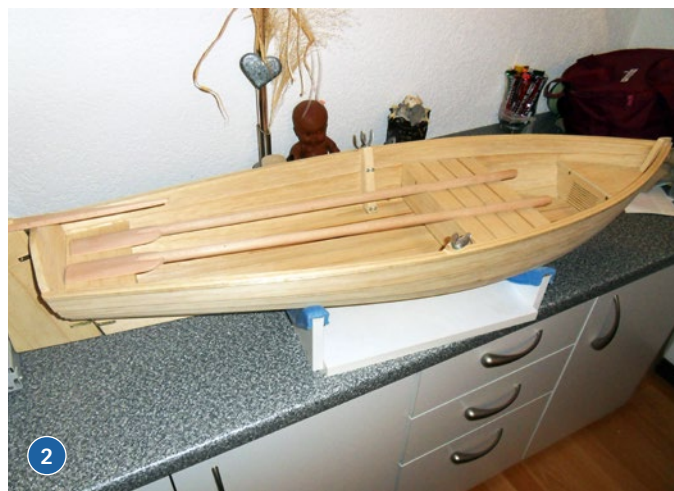
1) Das Ruder ist mit selbstgebauten Beschlügen am Heckspiegel befestigt. 2) Der Rumpf ist fertig fürs Beizen, Harzen und Lackieren
