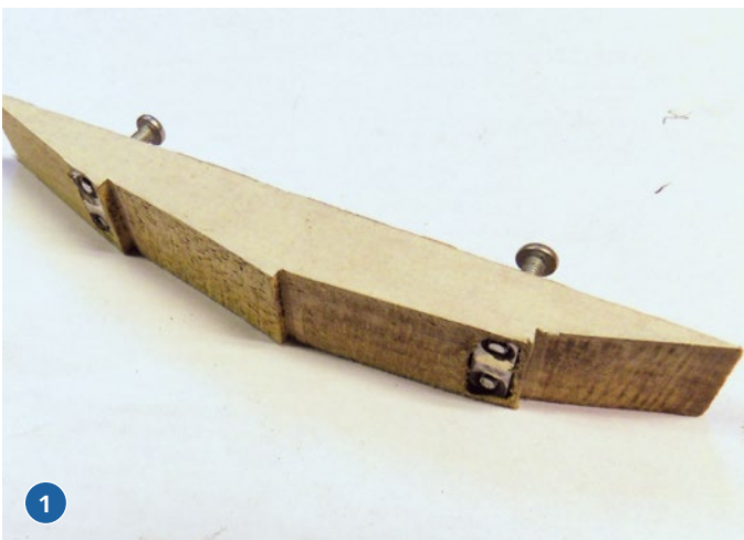
1) Die Ruderrollen mit den Befestigungsschrauben der Rudermechanik. 2) Die Hochzeit von Riemen und Ruderblatt
