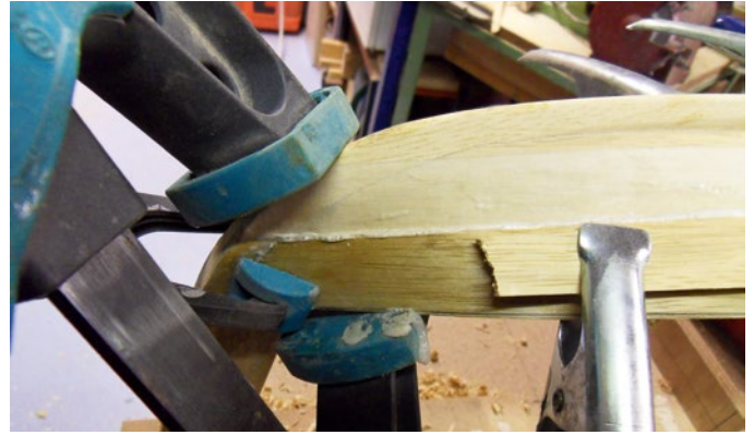
Die zweite Planke wird aufgeklebt
