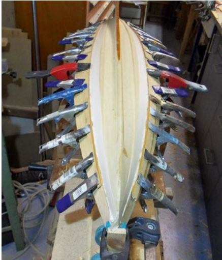
Verleimt wird immer gleichzeitig auf beiden Seiten des Rumpfs
