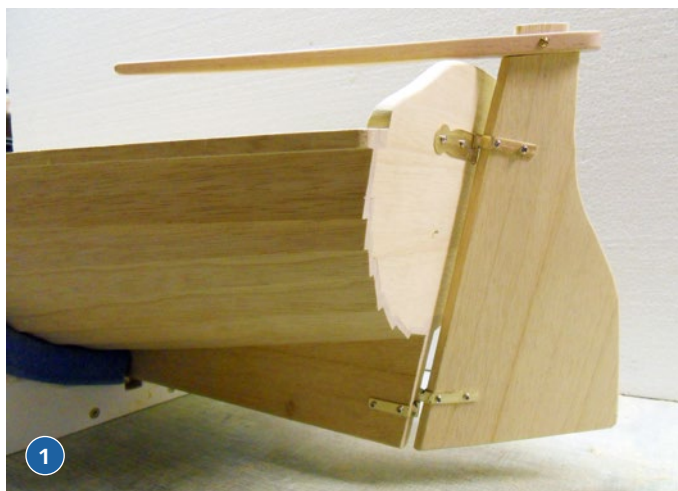
1) Das Ruder ist mit selbstgebauten Beschlügen am Heckspiegel befestigt. 2) Der Rumpf ist fertig fürs Beizen, Harzen und Lackieren
