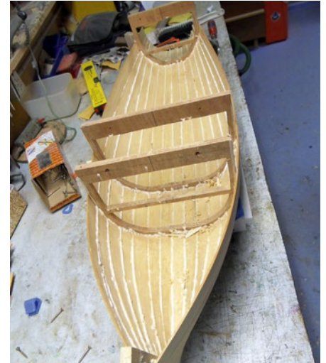
Auch von innen kann der Rumpf jetzt verputzt werden
