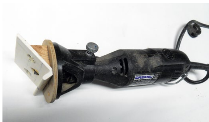
Zum Ausfräsen des Bugstevens wird der Dremel umgebaut
