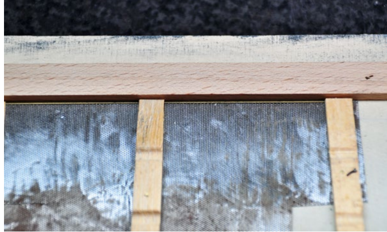
Mit einer Buchenleiste als Anschlag wird das erste Messingprofil aufgelötet
