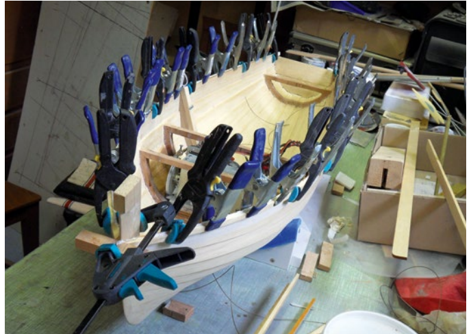
Die Scheuerleiste wird in einem Stück aufgeklebt
