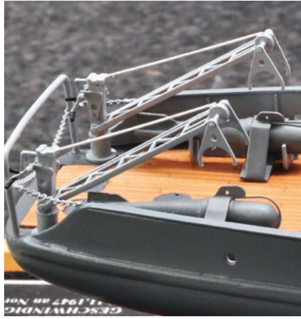
Die Otterkrane sind ebenfalls aus Bausätzen gefertigt
