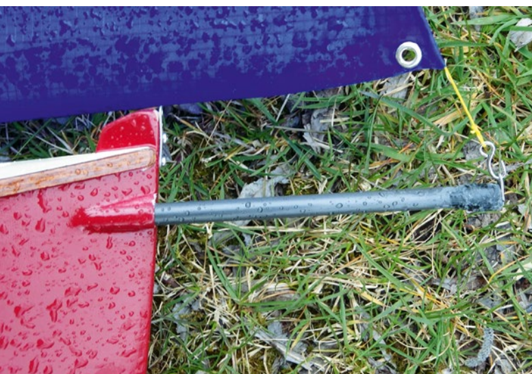
Der Bugspriet für den Code Zero wird einfach von vorne in eine Aufnahme am Bug eingesteckt
