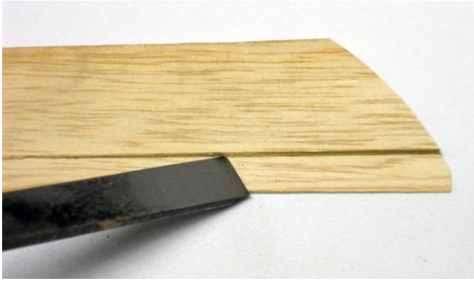
Die Überlappung der unteren Planke wird erstellt
