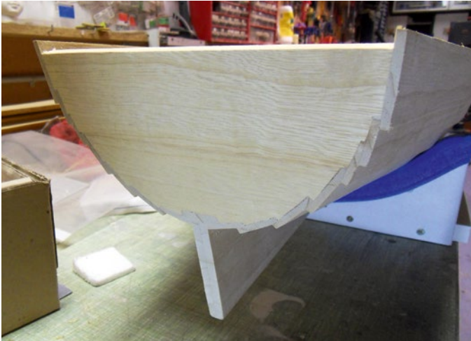
Der Heckspiegel ist eingebaut und verschliffen
