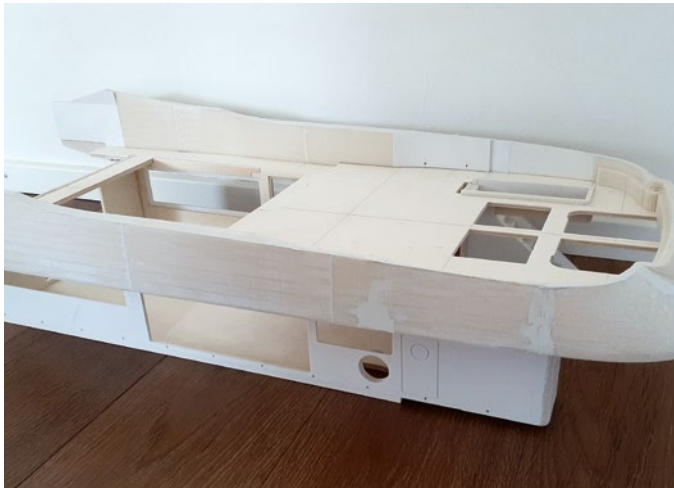
Die geraden Außenflächen sind zur Stabilisierung mit dünnen Polystyrolplatten beklebt
