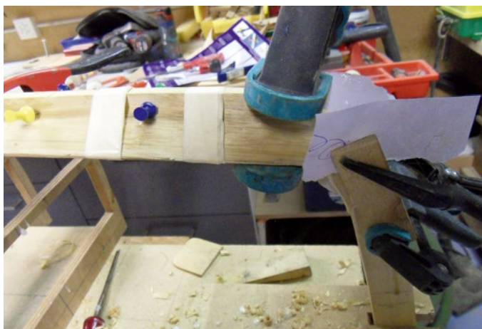
Die erste Planke wird am Rumpf festgeklebt
