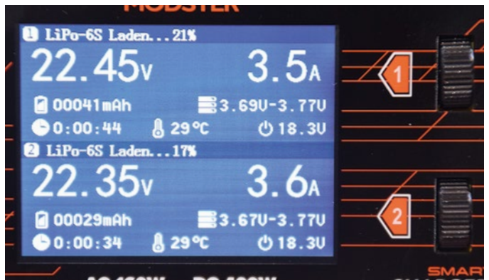
Beide Ladeanschlüsse werden unabhängig voneinander gleichzeitig angezeigt
