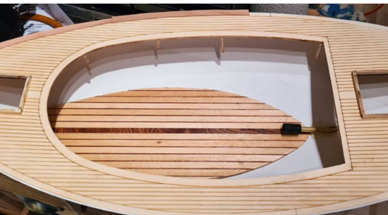
Abweichend vom Bausatz wird der Boden mit Linden- und Mahagonileisten beplankt
