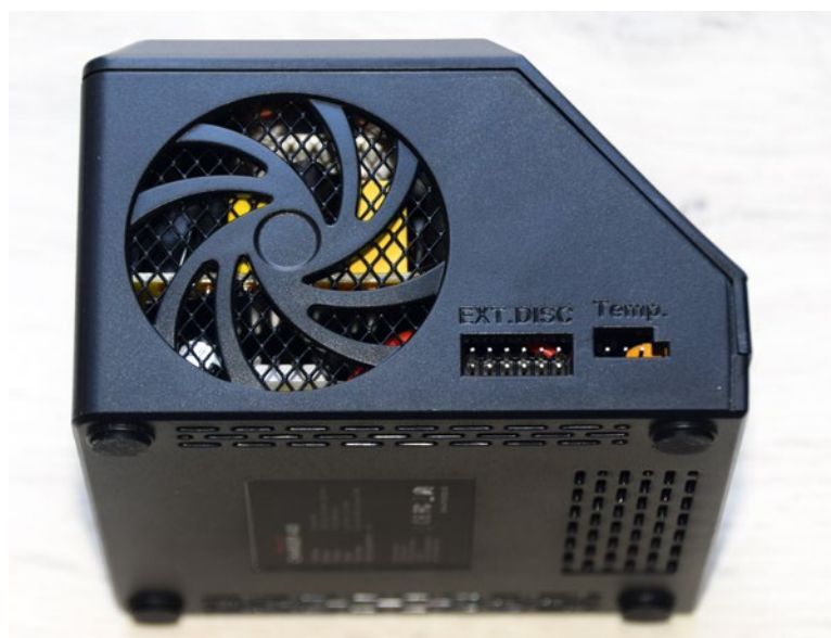
An der linken Gehäusesseite sitzt der Anschluss für einen externen Entlader und einen weiteren Temperatursensor
