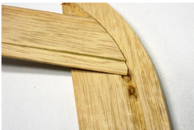
So werden die Planken am Bugsteven angepasst
