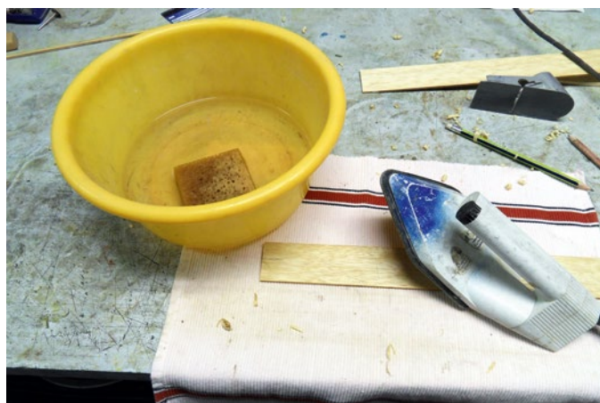
Bei starken Krümmungen werden die Planken mit Wasser und Bügeleisen aufgedämpft
