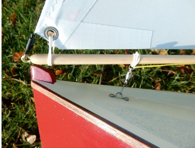
Beschläge werten das Modell auf, wie die Ösen zur Aufnahme von Vor- und Achterstag
