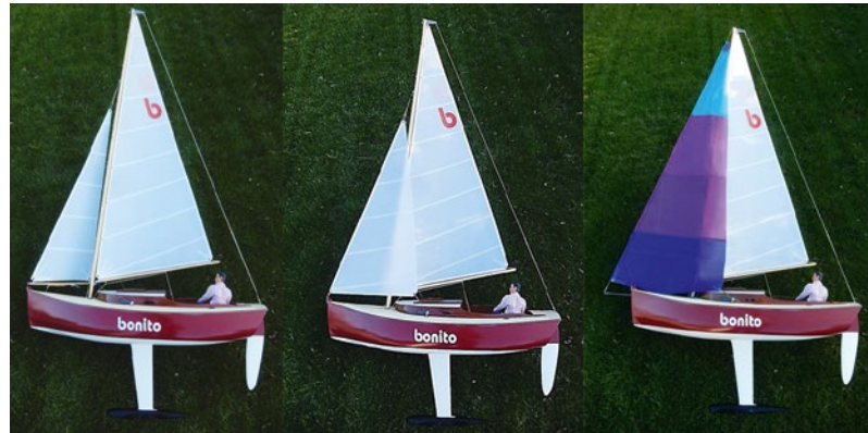
Drei Varianten an Vorsegeln sorgen bei jedem Wind für optimalen Segelspaß, von links nach rechts: Pendelfock, Genua und Code Zero
