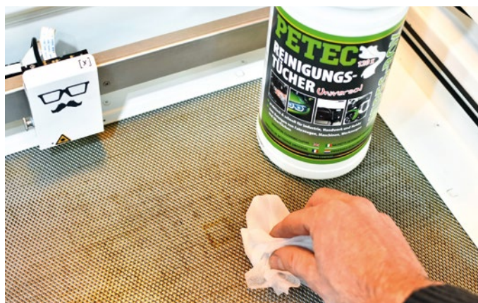
Es ist nur eine Frage der Zeit und der Nutzungshäufigkeit: Der Innenraum muss regelmäßig gereinigt werden und spätestens dann steht auch ein Zerlegen des Laserkopfs auf dem Zettel
