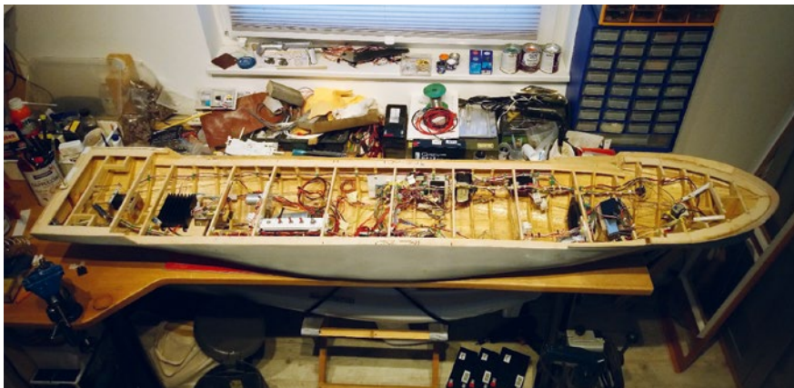
Im Innern des Schiffs werden viele Meter Kabel nach eigenem Schaltplan verlegt
