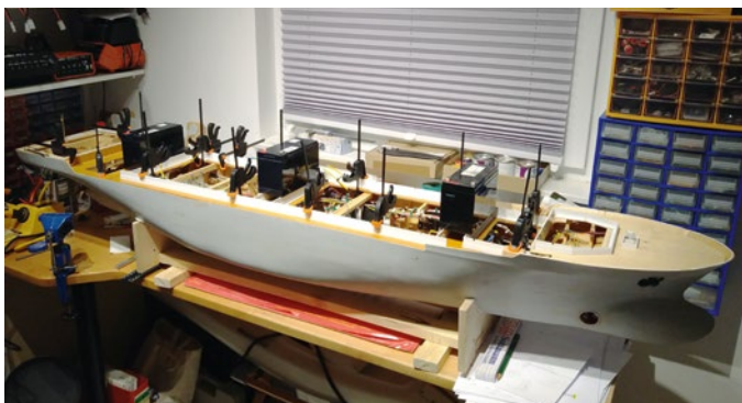
Danach werden die Decks und die Süllränder eingeklebt
