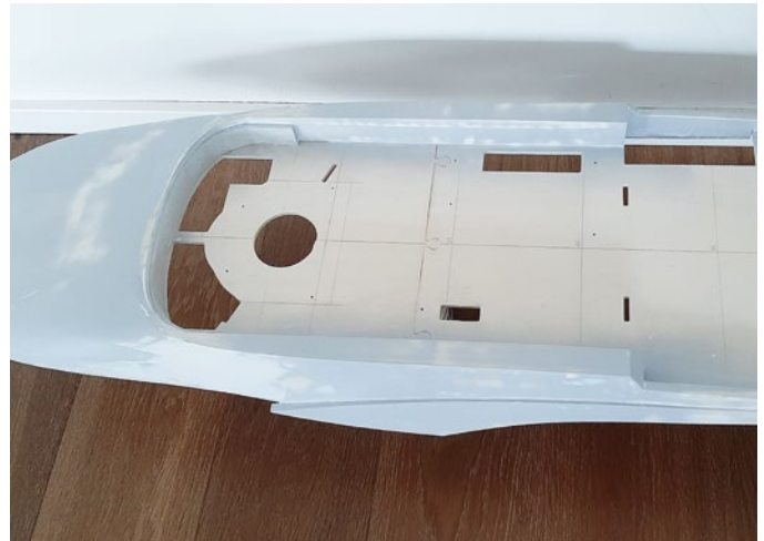
Die geschwungenen Flächen der oberen Brücke bestehen aus 3D-Druck-Segmenten
