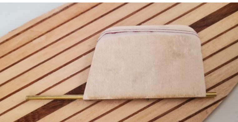
Das Ruderblatt ist mit einem Querstift durch die Achse gegen Verdrehen gesichert
