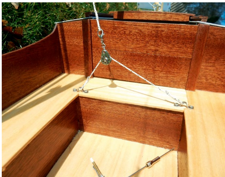
Der funktionierende Traveller mit kugelgelagertem Block im Cockpit
