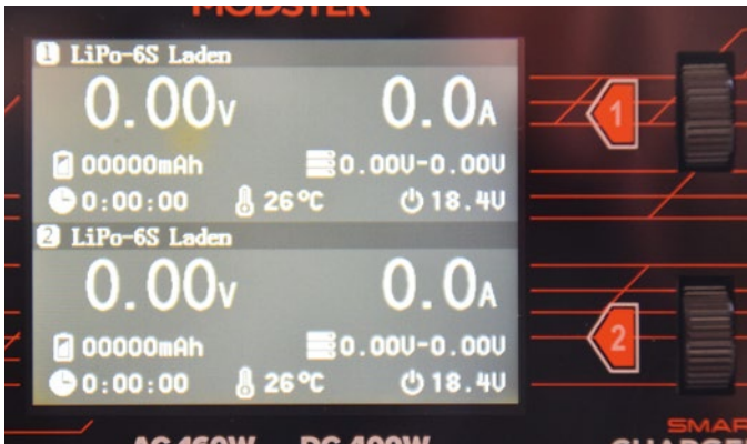
Die beiden Scrollräder sind die einzigen Bedienelemente
