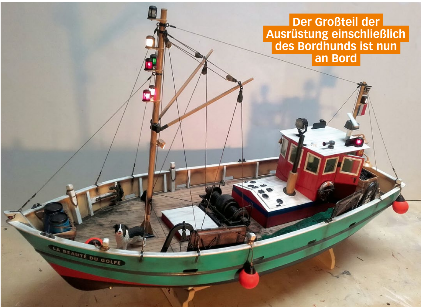
Die Fischkisten wurden aus Alu-Lochblech gebogen und mit Kupferfolie verziert
