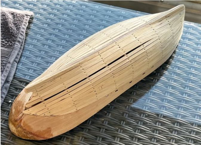
Der Rumpf wurde mit Lindenleisten beplankt, die zusätzlich genagelt sind
