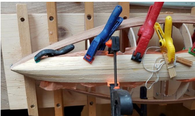
Das Unterwasserschiff wird nicht mit Mahagoni beplankt, da es lackiert wird
