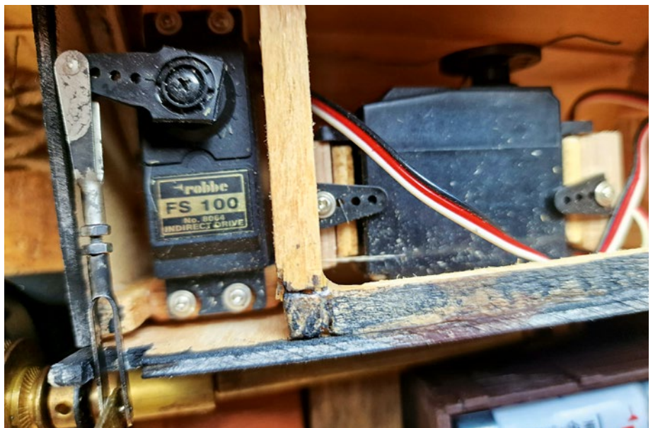
Die Servos für das Ruder und die Dampfpeife wurden geschickt versteckt
