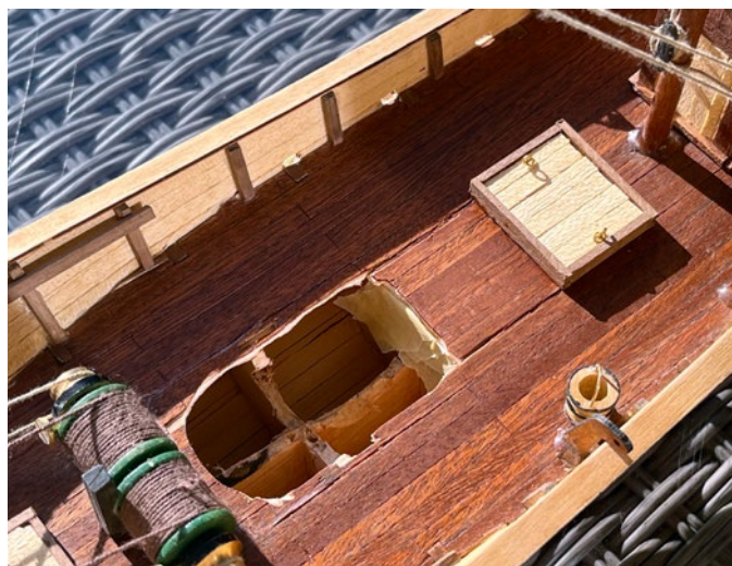
Unter Deck wird mit dem Fräsmesser Platz für die Fernsteuerung geschaffen
