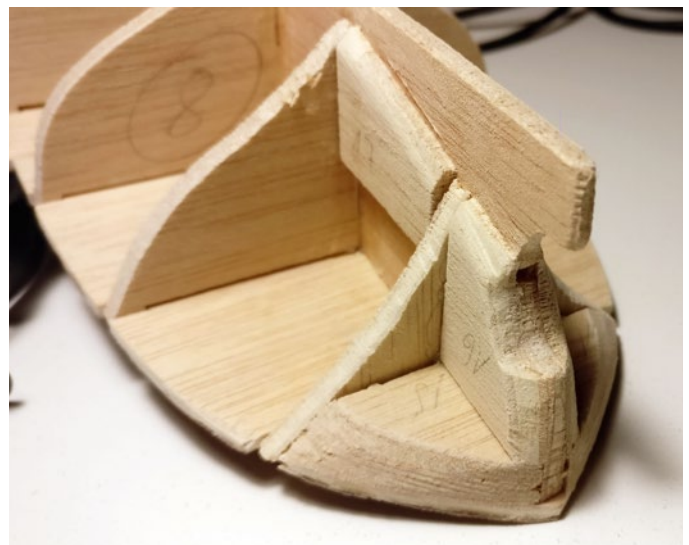
Die Spanten wurden ohne Stringer lediglich nach Augenmaß gestrakt
