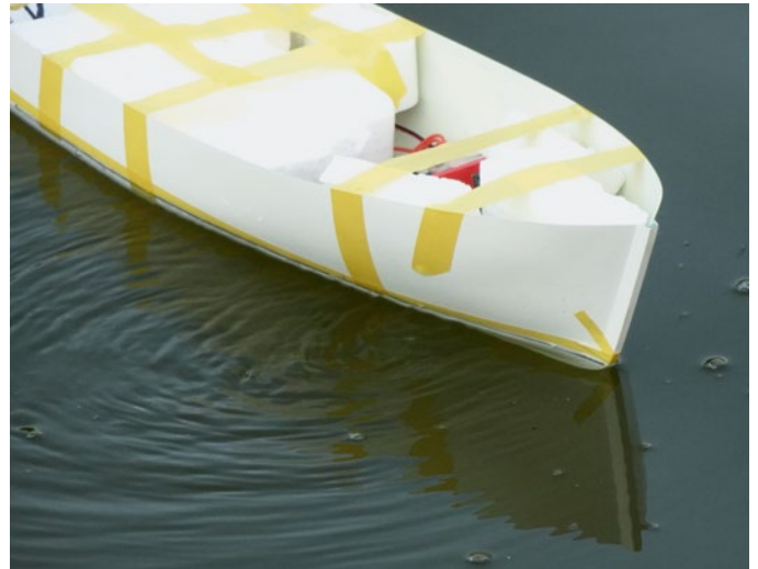
Bei nur zwei Zellen erzeugt der kleine Bugstrahler zu wenig Druck, um das Boot mit Aufbauten bei Wind zu drehen
