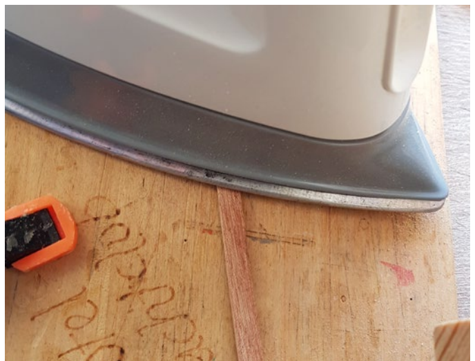
Mit einem alten Bügeleisen werden die gewässerten Planken gebogen
