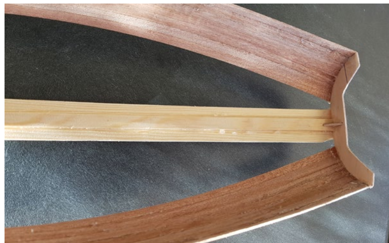
Am Heck erkennt man die eingesetzte Verstärkung zwischen Kieleleiste und Spiegel
