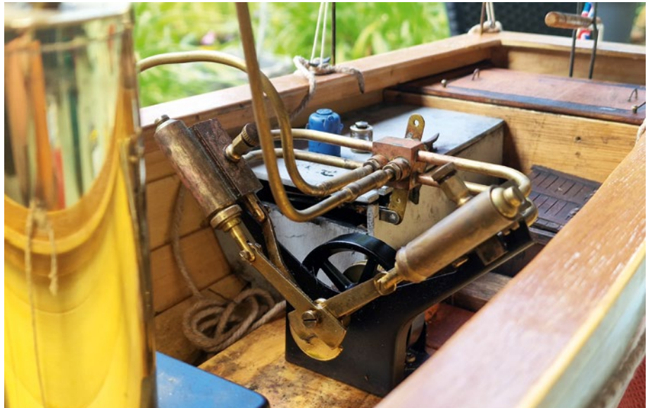
Zuerst wurde der Antrieb gegen eine Zwei-Kolben-Maschine getauscht
