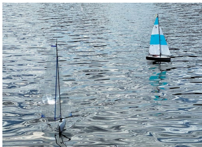
Wo sind die Segel? Die laminierten Profissegel benötigen für die Sichtbarkeit horizontale Streifen
