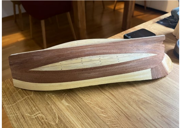
Zusätzlich wurde der Rumpf mit Streifen aus Sapelli-Holz beplankt
