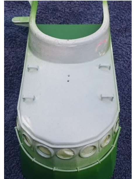
Das Dach des Aufbaus besteht aus dem Kartonrücken eines Wandkalenders
