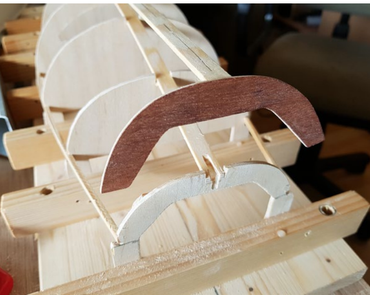
Die Kielleiste und der Spiegel des zukünftigen Rumpfs sind zur Verdeutlichung kurz angehoben
