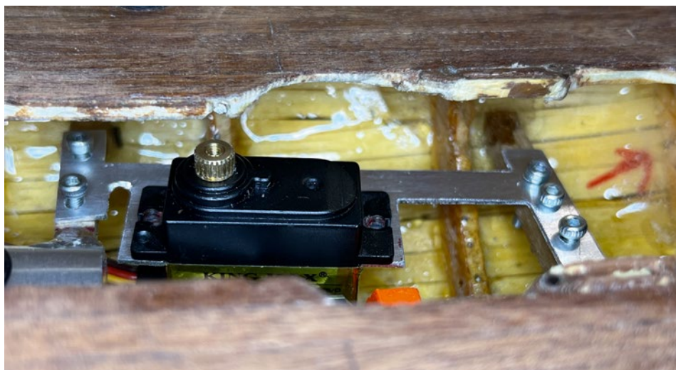
Der Versatz des Ruderservos wird mit einer Halterung ausgeglichen
