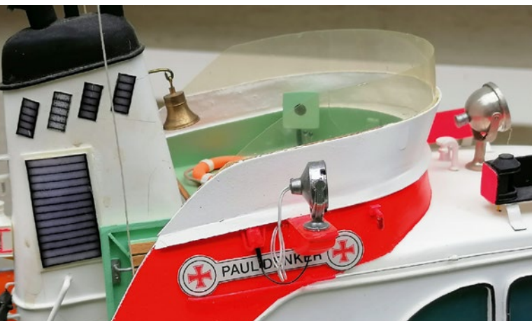
Der durchsichtige Kunststoff eines Schnellhefters wurde für den Spritzschutz verwendet
