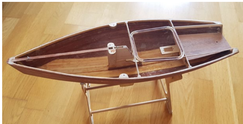
Der fertige Rumpf mit den Einbauten und der Decksauflage
