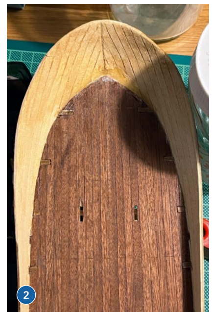
1) Die Lücke im Schanzkleid führte zu einer vierjährigen Baupause. 2) Nach vier Jahren wurde die Lücke endlich mit Modelliermasse geschlossen
