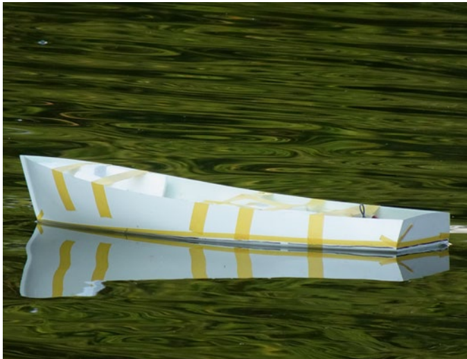
Ohne Fahrt passt die Wasserlinie schon fast perfekt, sowohl in der Seitenansicht als auch, wenn man von vorn auf den Steven schaut
