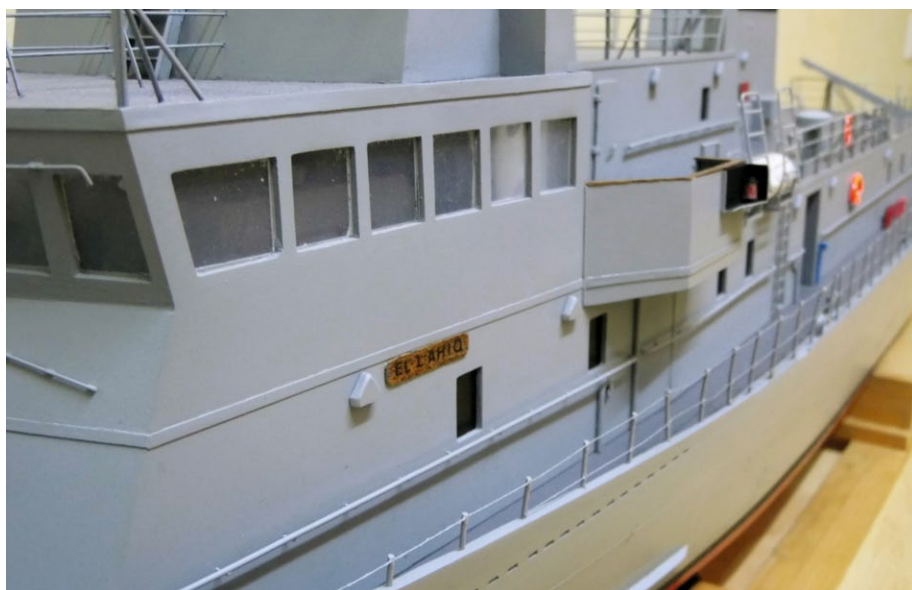
Feine Strukturen oder Elemente ließen sich mit Profilen aus dem Evergreen-Programm realisieren, wie hier am Brückenhaus zu sehen
