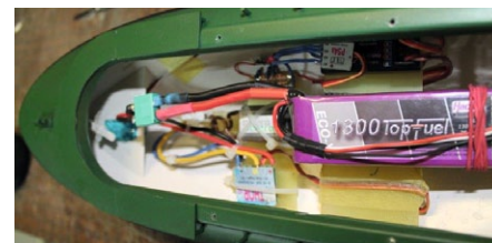
In kleineren, leichten Modellen, hier das Beiboot, sind LiPos die bessere Wahl
