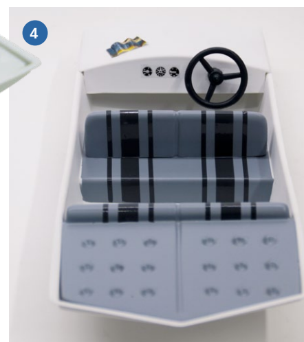
1) Alle Holzteile, besonders die einzubauenden, sind gegen Wasser zu imprägnieren. 2) Ein einfacher Bürstenmotor der 400er-Klasse, wie von Krick empfohlen, ist optimal für die KATJA. 3) Der Deckseinsatz hat ab Werk keinen Spritzwasserschutz – hier lohnt sich etwas Nacharbeit. 4) Auch optisch lässt sich durch Lackieren und Folien einiges beim Deckseinsatz rausholen
