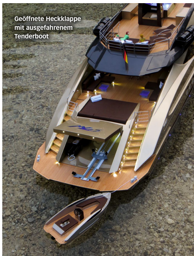
Eingebauter Spindelantrieb für die Heckklappe der PALMER JOHNSON
