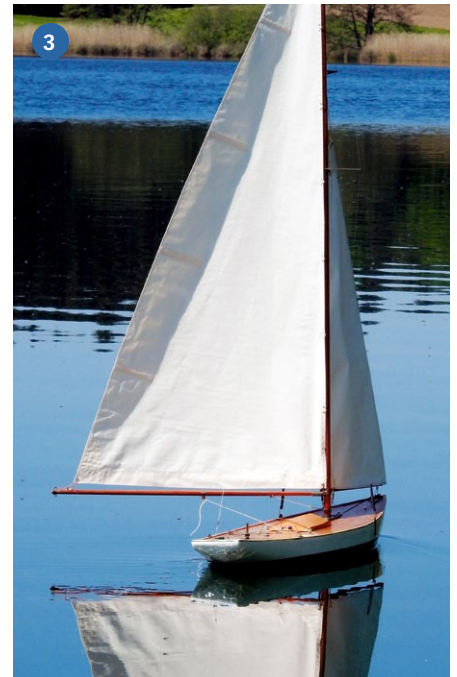
1) Bereit zur Jungfernfahrt, die RC-Anlage ist kaum sichtbar. 2) Die Wasserlinie ist etwas zu hoch angesetzt. Dadurch ist der Freibord höher als gedacht. 3) Die Baumwollsegel passen gut zum klassischen Charakter der Modelljacht
