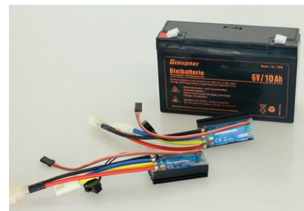
Große Bleiakku bringen das oftmals benötigte Mehrgewicht mit, sind aber nicht automatisch erste Wahl
