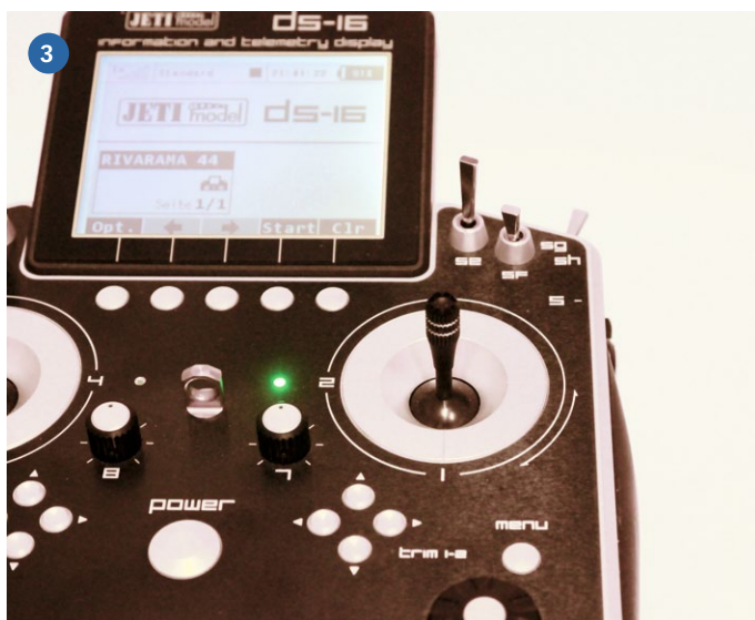
1) Hintergrundbeleuchtetes Display der JETI DS-16. 2) Die DS-16 von der Seite, mit einem der beiden Drehschieber und den Schaltern. 3) Rechter Kreuzknüppel mit den zugehörigen Trimm-tasten links daneben. 4) Die beiden mittleren Drehpotis zwischen den Kreuzknüppeln haben keinen Rastpunkt
