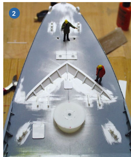
1) Lukendeckel, Kästen und Sockel auf dem Heckdeck im Rohbau. 2) Wie nahezu alle Teile entstand auch der Wellenbrecher auf dem Backdeck aus Polystyrol. Direkt dahinter der Sockel für die Bofors
