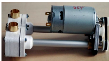
Das gesamte Bugstrahlruder zusammgebaut
