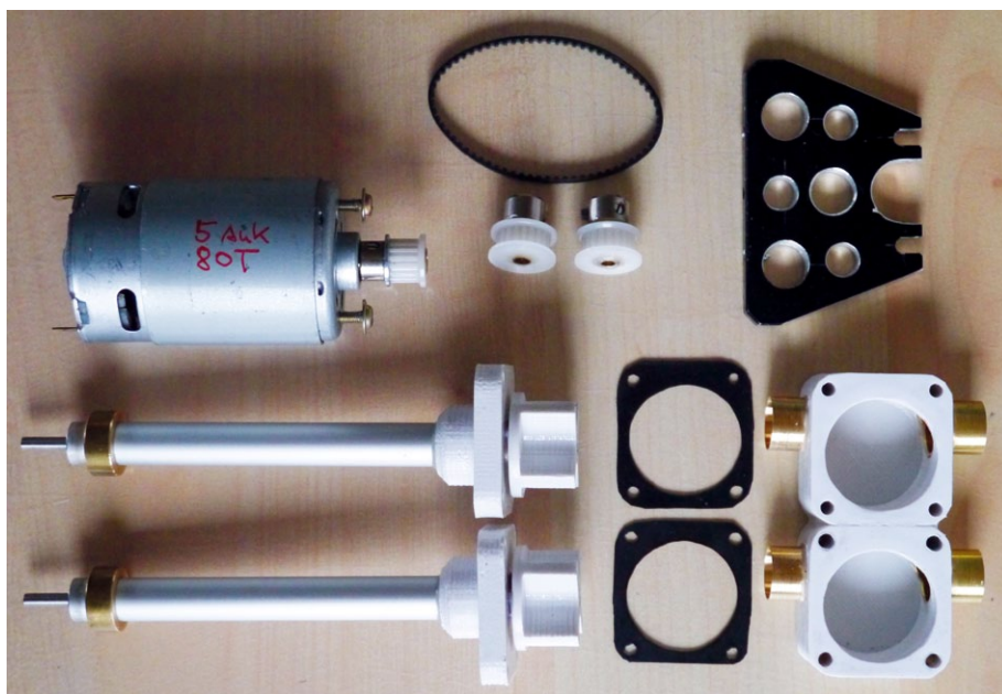
Einzelteile der Bugstrahlruder. Oben der Motor mit Zahnriemenscheibe, die zwei Zahnriemenscheiben und der Zahnriemen. Daneben eine 5-Millimeter-Aluplatte zur Befestigung der Komponenten. Links unten die zwei Stevenrohre mit dem Rotor und dem oberen Deckel. Daneben zwei Gummidichtungen und die beiden unteren Gehäuse
