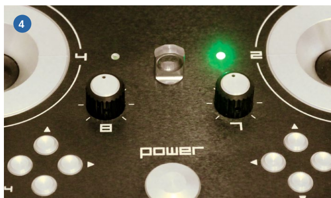
1) Hintergrundbeleuchtetes Display der JETI DS-16. 2) Die DS-16 von der Seite, mit einem der beiden Drehschieber und den Schaltern. 3) Rechter Kreuzknüppel mit den zugehörigen Trimm-tasten links daneben. 4) Die beiden mittleren Drehpotis zwischen den Kreuzknüppeln haben keinen Rastpunkt
