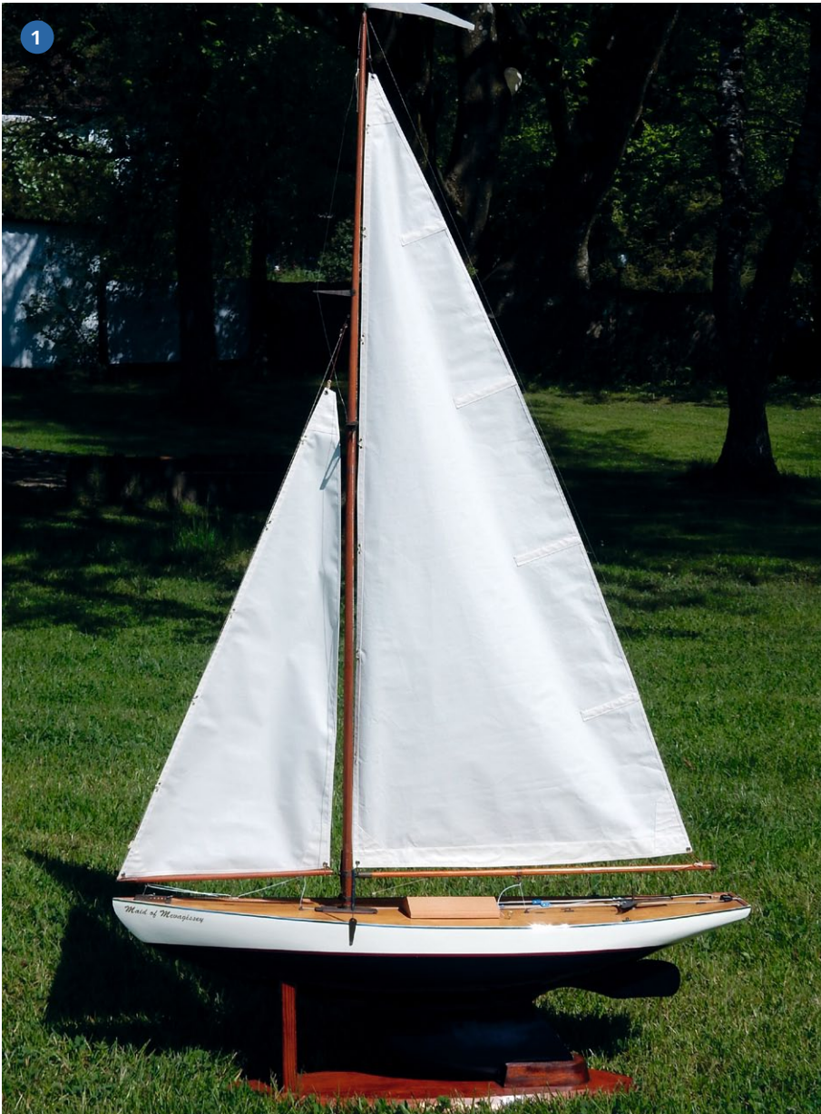
1) Bereit zur Jungfernfahrt, die RC-Anlage ist kaum sichtbar. 2) Die Wasserlinie ist etwas zu hoch angesetzt. Dadurch ist der Freibord höher als gedacht. 3) Die Baumwollsegel passen gut zum klassischen Charakter der Modelljacht
