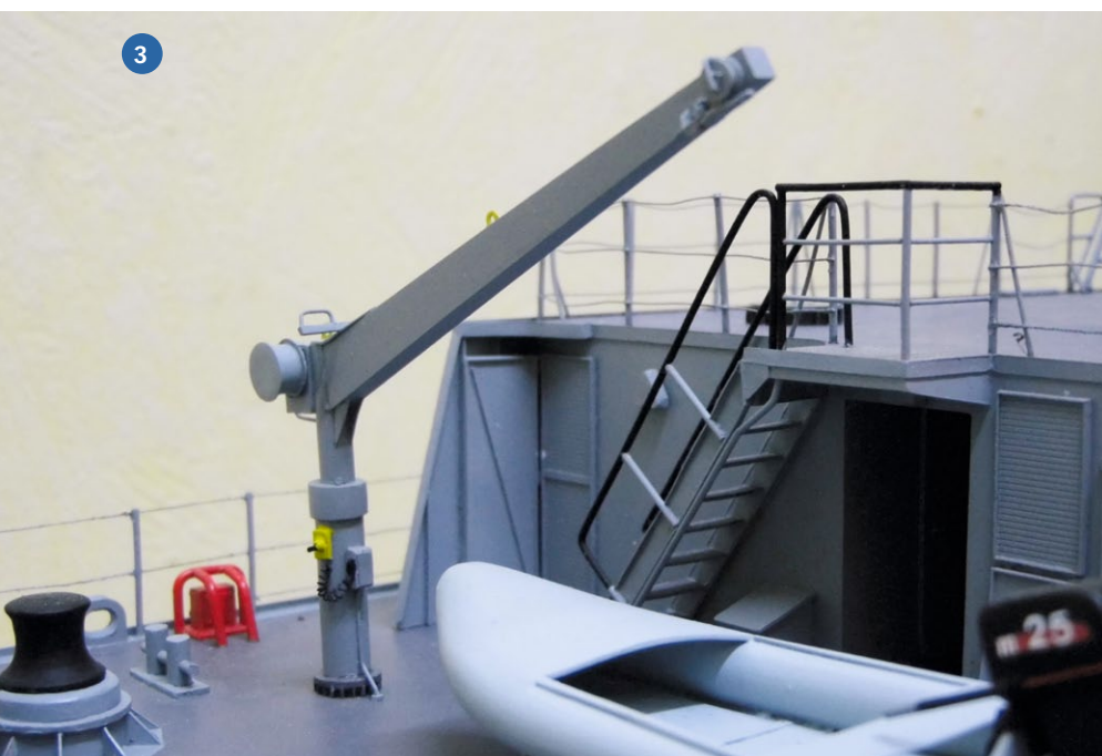
1) Als Basis zum Bau der Rettungsinseln diente Polystyrol-Rohr. 2) Unzählige Details wie die Trossentrommeln, Spill, Kästen, Schlauchboot oder Kran sorgen für ein abwechslungsreiches Bild. 3) Kran und Niedergang – beide aus Polystyrol gebaut – bestimmen neben dem Schlauchboot maßgeblich die Optik auf dem Heckdeck. 4) Profile aus dem Evergreen-Sortiment, hier für den Sockel verwendet, helfen häufig beim vorbildgerechten Bau von typischen Schiffsdetails wie hier der Ankerwinde. 5) Ankerkette und Spills an der Ankerwinde gehören zu den wenigen Teilen aus Metall, die auf der EL LAHIQ zu finden sind
