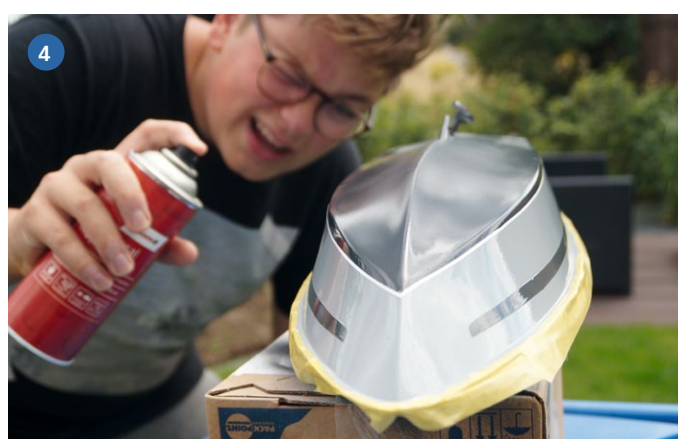
1) Selbst erstellte und geplottete Folie mit Zierstreifen sorgt für mehr Pfiff. 2) Das Verkleben von Rumpf und Aufbau muss verzugsfrei erfolgen – hier zahlt sich Geduld aus. 3) Farbnebel kann unter die Kabine gelangen, darum ist dieser Bereich sorgfältig abzukleben. 4) Ein modernen Yachten nachempfundenes Farbfinish sorgt für eine gefälligen Eindruck
