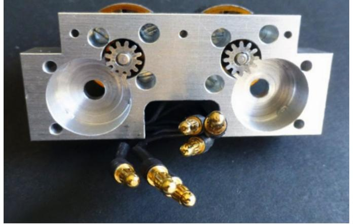
Motorflansch mit Motoren und aufgespressten Antriebsritzeln
