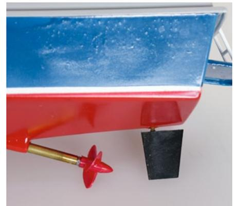
Stevenrohr mit Welle und Schraube gehören ebenso zum Lieferumfang wie das Ruder
