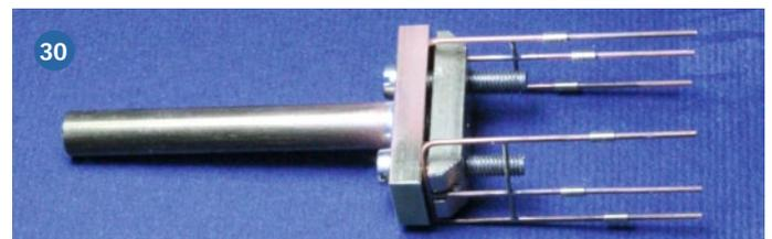
Mit dem gleichen Helling-Bohrständer, bestückt aber nun mit einer Pinole mit einer 4-mm-Spannzange von der Uhrmacherdrehmaschine (Alternative: normales Bohrfutter) am Ausleger (Abbildung 22), werden nun kleine Messing-Buchsen in diese 1,5-mm-Löcher geklebt. Den Kopf der Pinole mit einem 4-mm-
