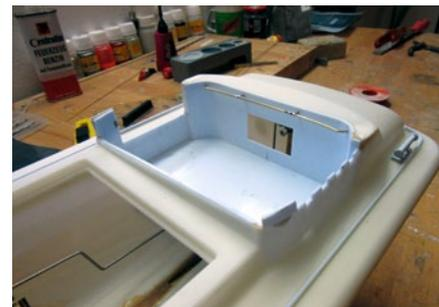
Aus weit vorgefertigten ABS-Teilen ist die Plicht zu erstellen, und zwar vor dem Bau des Aufbaus. Wichtig ist dabei, die Teile immer wieder mit den Gegebenheiten des Rumpfs abzugleichen, damit ein exakter Einbau erfolgt, der keine oder wenig Lücken lässt, die mühsam verspachtelt werden müssten
