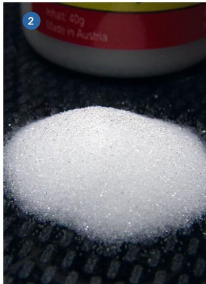
1) Mit handelsüblichem Aktivatorspray lässt sich der Aushärteprozess beschleunigen. 2) Das ist kein CA-Booster, sondern zum Vergleich die Partikel eines konventionellen CA-Fillers. Die Nahaufnahme verdeutlicht, dass es sich um kleinste Kugeln handelt – alle gleichgroß. Das ergibt mit CA-Kleber eine weniger stabile Struktur, die zwar glashart wird, aber auch schneller brechen kann
