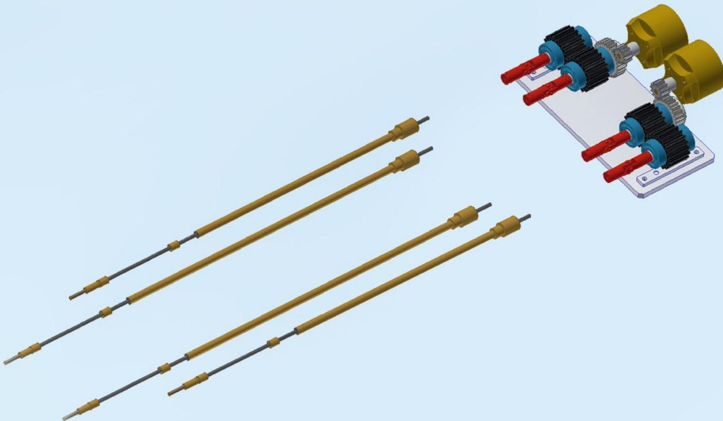
**D**as Besondere an der USS HORNET ist die Lage der vier Antriebswellen. Sie führte zur Konstruktion eines Doppelgetriebes. Das heißt, jedes Wellenpaar ist mit einem zweistufigen Getriebe und Motor ausgestattet. Diese beiden Getriebe sind in einem Zentralgehäuse zusammengefasst und bilden eine Einheit. Das komplette Getriebe ist mit vier Schrauben auf der im Rumpf eingeklebten Grundplatte befestigt.
