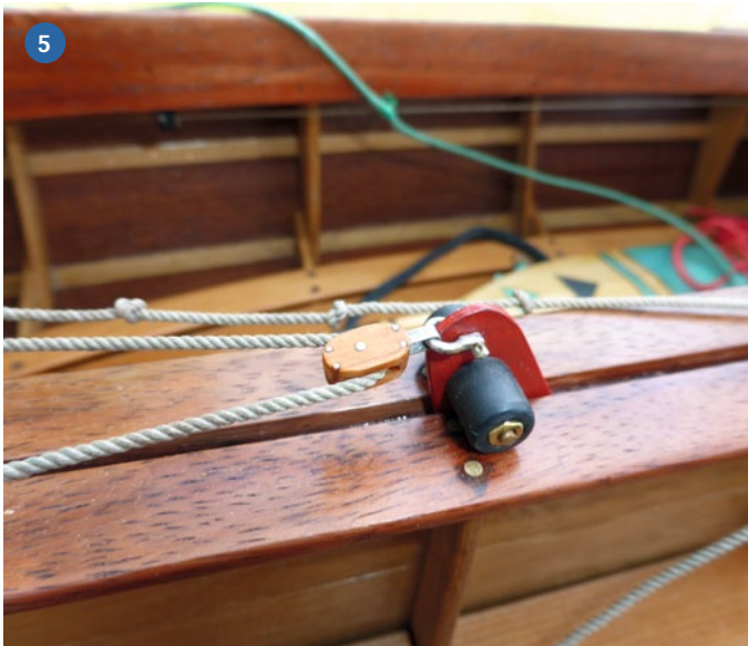
4) Die Namensplakette im Stahlstichlook zeigt den Modellaufbau. 5) An der Schwertlagerung mit Gummirollen erkennt man die liebevolle Detailarbeit. 6) Aufhängung des Ruderblatts, wie beim Original. 7) Filigraner Wantbeschluss
