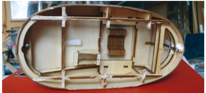
Rohbau mit Motorhalterung, Welle, Ruderkocker und Servo-Halterung
