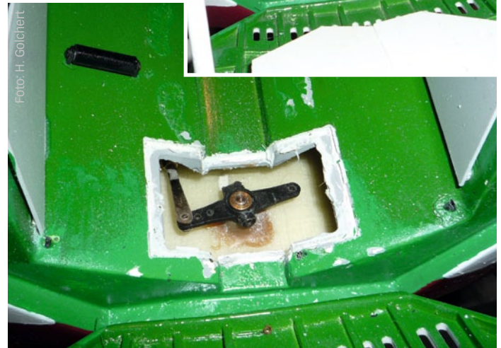
Revisionsöffnung für die Rudermechanik am Modell
