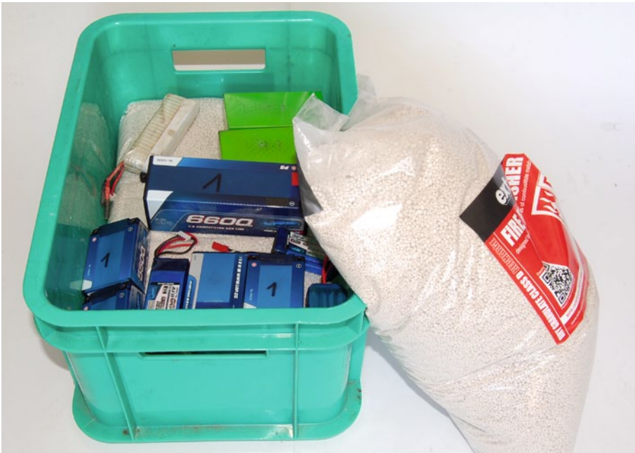
Zwei oder mehr der Extover-Kissen in 5-Liter-Größe sind ideal geeignet, um zwischen ihnen Akkus zu lagern oder zu laden. Gerät ein Akku in Brand, wird die Kissenhülle zerstört, das Granulat verändert seinen Zustand und umschließt den LiPo feuerfest
