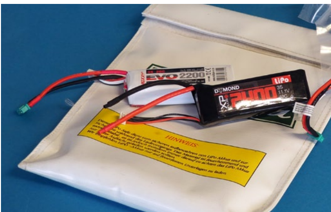
Zum kurzfristigen Lagern, Transportieren oder Laden kleinerer Akkus eignen sich im Zweifel LiPo-Bags
