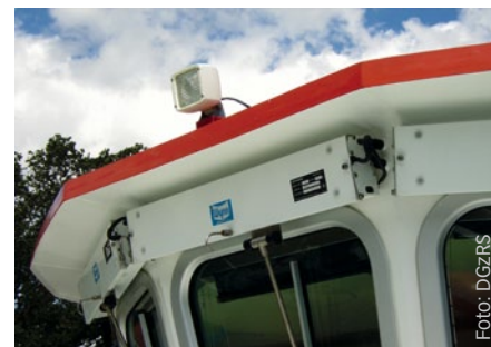
Scheibenwischermechanik am Mittelfenster der EUGEN
