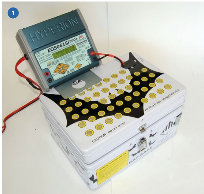
1) So sieht eine sichere Ladestation aus. Der Akku wird im Inneren des Bat-Safe geladen oder aufs Einlagern vorbereitet. 2) Die praktische Halterung fürs Ladegerät besteht aus einem abgewinkelten Alublech. Gehalten wird der Lader durch die Klettbandfixierung
