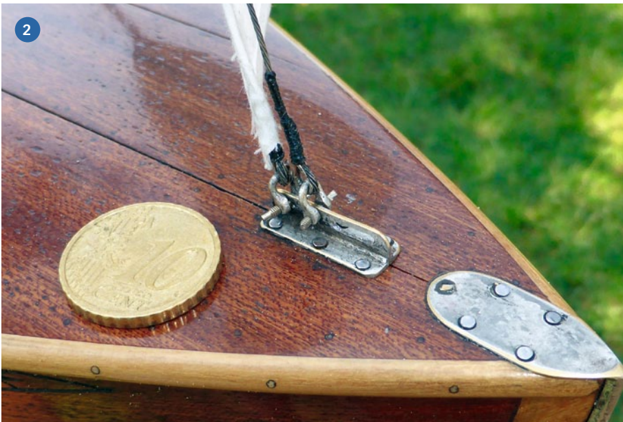
1) Gesamtansicht der MAGGIE MAY an Land. 2) Beschläge wie der Bugbeschlag unterstreichen den historischen Charakter des Boots. 3) Mithilfe des Großschotwagens lässt sich die MAGGIE MAY am Baum reffen
