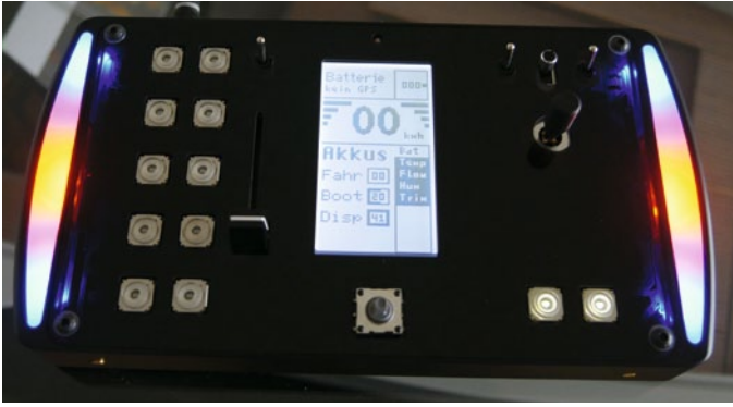
Auch der Sender ist Marke Eigenbau und optisch auf die WALLYPOWER abgestimmt. Er ermöglicht zudem die komfortable Steuerung aller Funktionen
