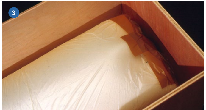
1) Die beiden GFK-Abzüge für das U-Boot sind hier bereits mit Spackel für den letzten Arbeitgang belegt. 2) Das ist das Ziel: Eine Gips-Wanne mit Silikon-Negativform eines Rumpfs. 3) Um eine Silikonform zu erstellen, ist als erstes der Ur-Rumpf in ein Schaumstoffkleid einzupacken und dann ein Kasten um diesen herum aufzubauen
