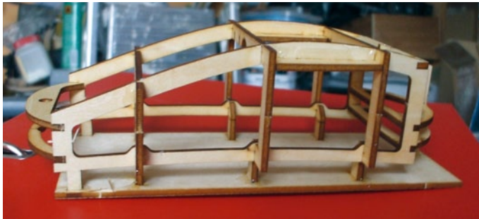
Auf der Sperrholzhelling wurde das Spantengerüst zusammengesteckt
