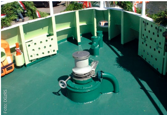
Auf dem Vorschiff des Originals sind Tauen und Bergungsnetze in den Staukästen auf der Innenseite des Schanzkleids untergebracht
