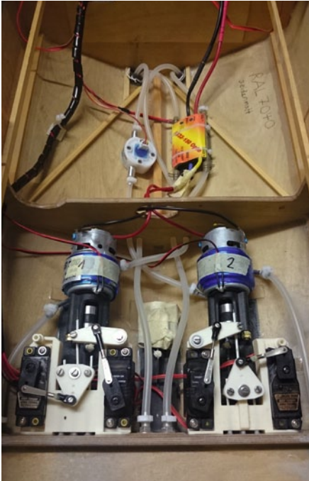
Von Beginn an war der Einbau von drei Kehrer-Jets vorgesehen, wobei nur die beiden äußeren zum Zuge kommen
