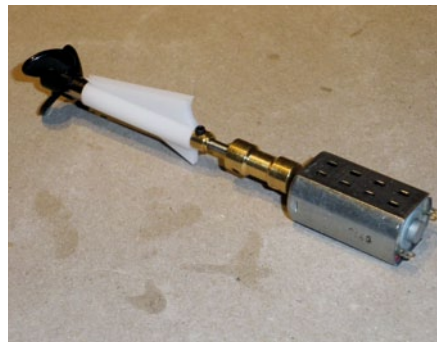
Im Bausatz enthalten ist der komplette Antriebsstrang aus Motor, Welle, Kupplung, Schraube und Stellringen. Der Steven, durch den die Welle läuft, ist ein Druckteil
