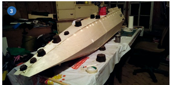
1) Zahlreiche Sonderfunktionen entstanden zunächst als Entwurf am PC und wurden dann in die Tat umgesetzt. 2) So verschwindet die großzügige Treppe im Heck des Schiffs. 3) Obwohl mit 1.800 Millimeter Länge kein kleines Modell, ist der Rumpfbau über allein sechs Spanten möglich. 4) Lange, auf Maß geschnittene Holzplanken bilden die Rumpfaußenhaut
