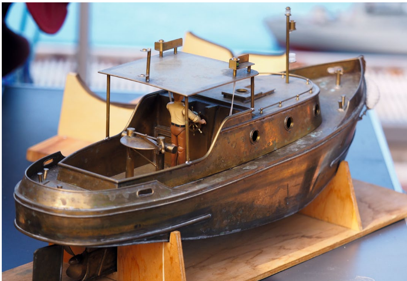
Vollkommen aus Messingblech gebaut ist dieser Nachbau einer älteren Hafengebarkasse oder -schleppers
