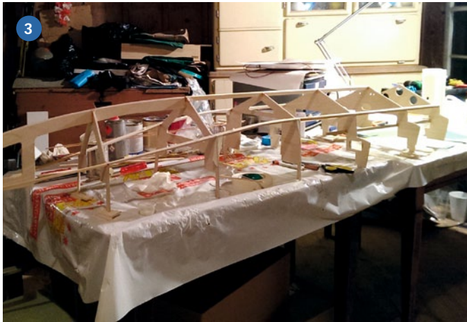
1) Zahlreiche Sonderfunktionen entstanden zunächst als Entwurf am PC und wurden dann in die Tat umgesetzt. 2) So verschwindet die großzügige Treppe im Heck des Schiffs. 3) Obwohl mit 1.800 Millimeter Länge kein kleines Modell, ist der Rumpfbau über allein sechs Spanten möglich. 4) Lange, auf Maß geschnittene Holzplanken bilden die Rumpfaußenhaut
