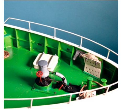
Beim Modell ist auf dem Vorschiff eine Luke backbordseitig neben der Ankerwinde eingebaut
