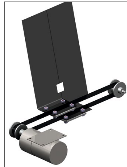
Die Schiebtüren lassen sich über eine Zahnriemenmechanik und Führung ferngesteuert öffnen sowie schließen
