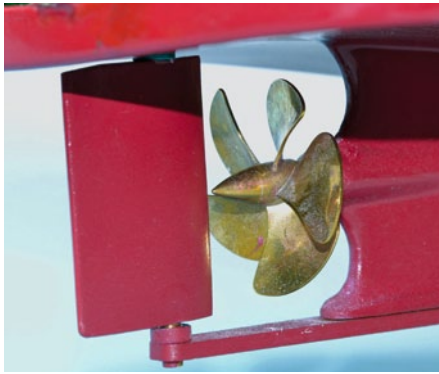
Propeller und Ruder am Modell
