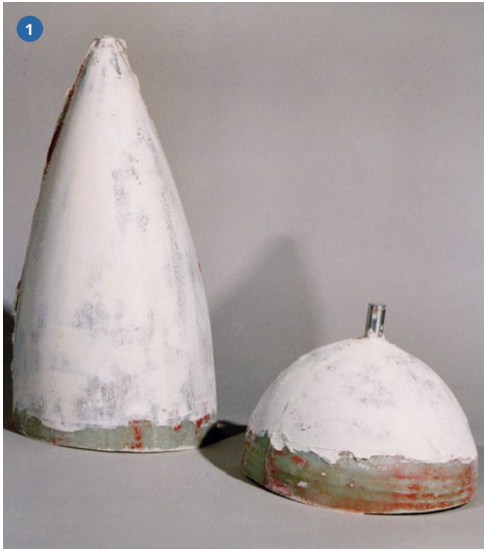
1) Die beiden GFK-Abzüge für das U-Boot sind hier bereits mit Spackel für den letzten Arbeitgang belegt. 2) Das ist das Ziel: Eine Gips-Wanne mit Silikon-Negativform eines Rumpfs. 3) Um eine Silikonform zu erstellen, ist als erstes der Ur-Rumpf in ein Schaumstoffkleid einzupacken und dann ein Kasten um diesen herum aufzubauen
